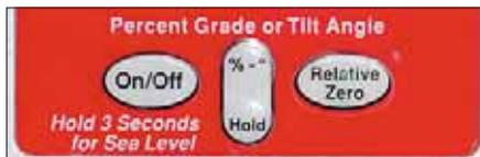
Ein Drücken der mittleren Taste oben bewirkt ein Umschalten von % auf °. Bei „Hold“ wird der gemessene Wert weiter angezeigt.
