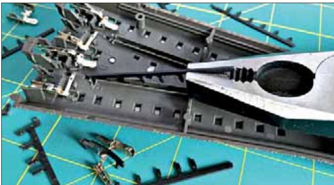
Nach dem Erwärmen lassen sich die Pukos z.B. mit der Spitze einer geschlossenen Kombizange herunterdrücken. Anschließend kann man die kurzen PuKo-Leisten von unten herausnehmen.
