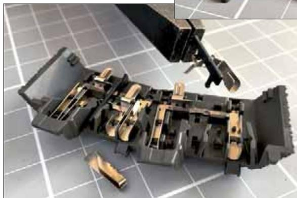
... einer Kombizange nach unten gedrückt. Die elektrischen Kontakte werden zusammen mit dem Mittel-leiter herausoperiert. Dabei sollte die dünne Kunststofffraste in der Mitte nicht beschädigt werden, denn ihr obliegt der für Teppichbahner so wichtige Zusammenhalt der Gleise.
