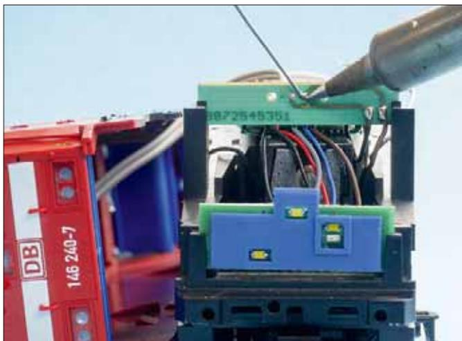
Bevor die neue SMD-LED eingesetzt werden kann, müssen die Lötstellen auf der Platine gesäubert werden. Im nächsten Schritt ist nur ein Kontaktpunkt vorzuverzinne. Die Platine sollte bei dem Austausch unbedingt so fixiert sein, dass sie nicht verrutschen kann.
