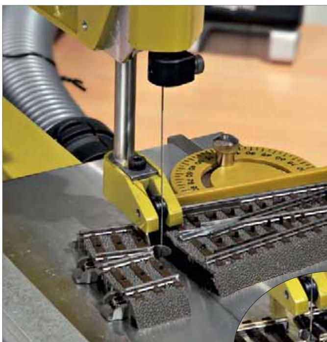
Ein Schnitt in die richtige Richtung! Bevor jedoch das Sägeblatt angesetzt wird, muss die Lage beider Schnitte präzise angezeichnet werden.
