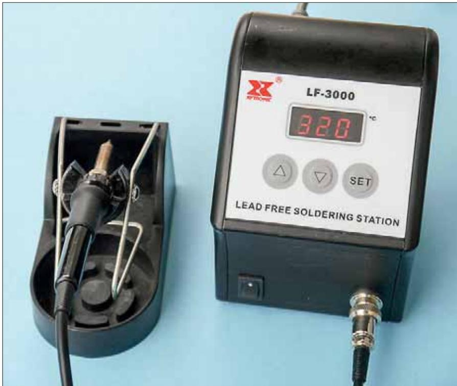
Beim Lötten von SMD-Bauteilen kommt es auf die richtige Temperatur der Lötspitze an. Daher sollte man einen LötKolben mit einstellbarer Temperatur benutzen. Im Beispiel ist ein LF-3000 von Xytronic zu sehen.
