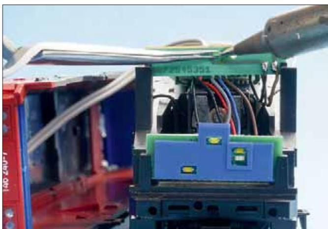
Nun kann mittels der Pinzette die neue LED befestigt werden. Hierzu wird das Lötzinn der bereits vorverzinnten Lötstelle wieder erhitzt, und die LED auf den Kontaktpunkt geschoben. Wichtig: Die LED darf nicht lange nachjustiert werden, um Überhitzung zu vermeiden.
