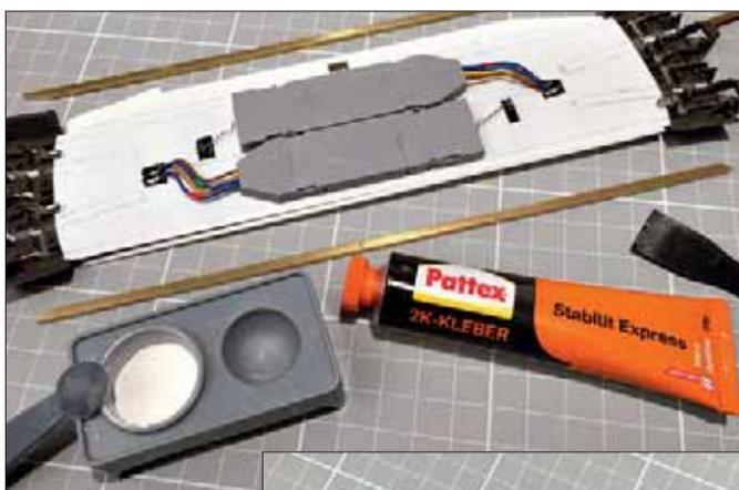
Die notwendige Stabilität erhält die Konstruktion von zwei durchgehenden Messingprofilen (3 x 3 mm). An den Enden sollten die Profile angeschrägt werden.
