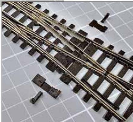
Unten: Damit die Antriebsmechanik im Falle eines Falles auch später noch zugänglich bleibt, wird eine Rastnase prophylaktisch vom Antriebsdeckel entfernt,
