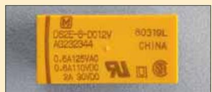
Die beiden Relais tragen auf der Oberseite alle wichtigen Angaben. Links das für 5 A ausgelegte Relais, rechts das kleinere für 2 A. Beide werden mit 12 V/DC betrieben und weisen je zwei Umschalter auf.
