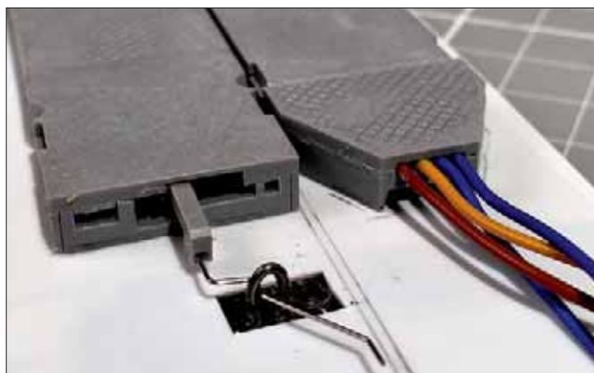
Die beiden Antriebe werden entlang der Bleistiftlinien im Abstand von 1 mm unter die Grundplatte geklebt.
