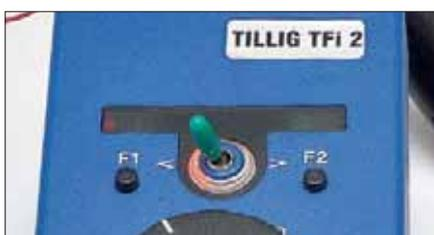
Die Stellung des Polwenders sollte nach Möglichkeit mit der LED-Anzeige korrespondieren ...
