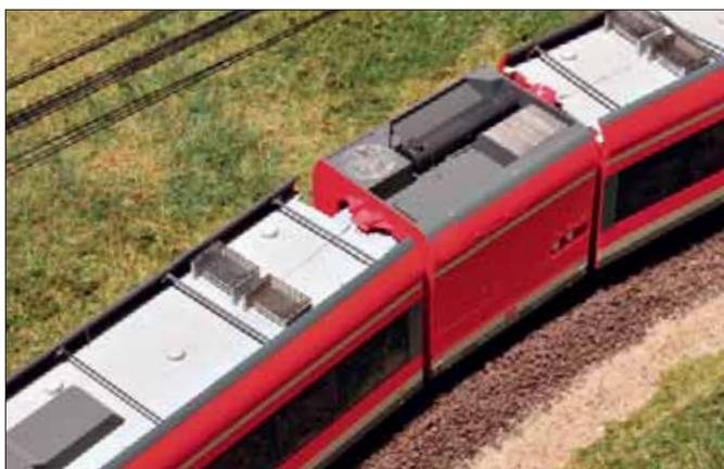
In der Draufsicht sind die feinen Bleche im fertig verbauten Zustand zu erkennen. Die preiswerte Bastelarbeit erhöht die Vorbildwirkung der Dachsektion erheblich.
