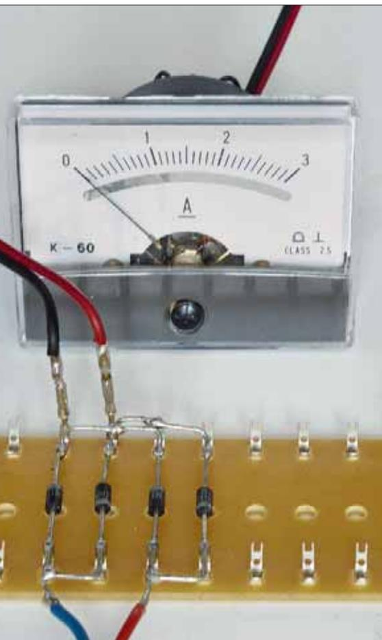
Die mit Dioden aufgebaute Messschaltung ist für einen Maximalstrom von 1 A ausgelegt.
