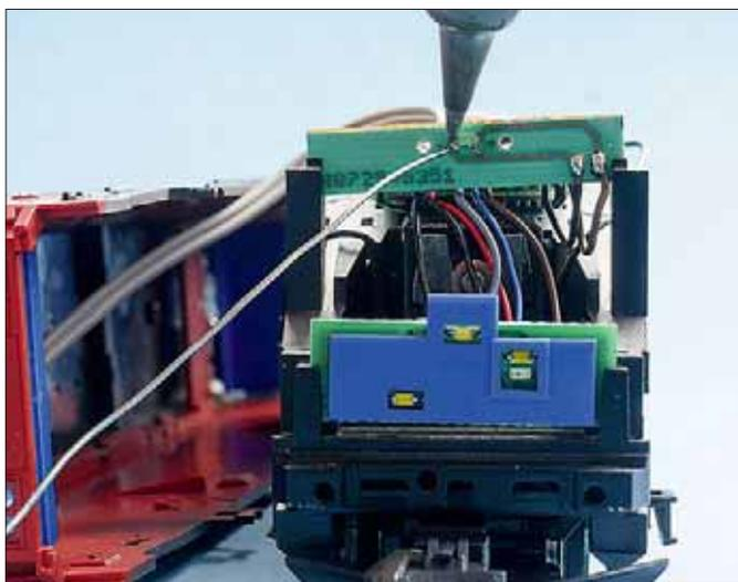
Da die LED nun mechanisch befestigt ist, kann auf einen weiteren Einsatz der Pinzette verzichtet werden. Die andere (hier linke) Kontaktstelle lässt sich nun problemlos verlöten. Der Austausch erfordert sicher etwas Übung, jedoch können Sie dann auf den Kauf teurer Ersatzplatinen bei einem Defekt verzichten.
