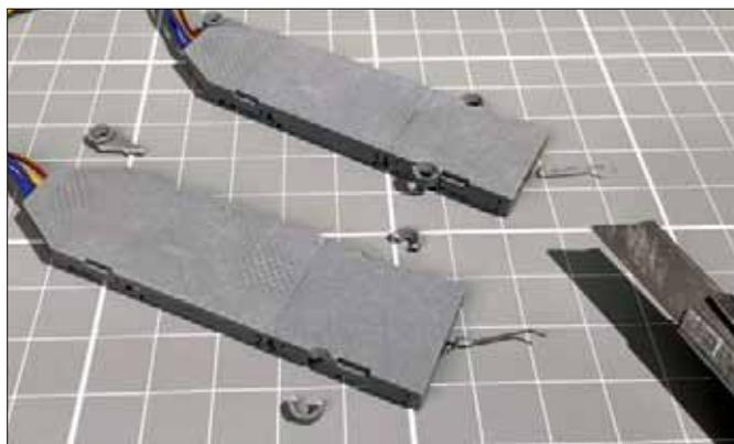
Weil es im Bettungskörper recht eng zugeht, müssen sich die Viessmann-Antriebe einige Änderungen gefallen lassen. Zum einen wird die Planlage durch Abschleifen der waagerechten Flächen herbeigeführt (im Ergebnis nur 0,2 mm, trotzdem wichtig) und zum anderen müssen die Schraubflaschen dran glauben.
