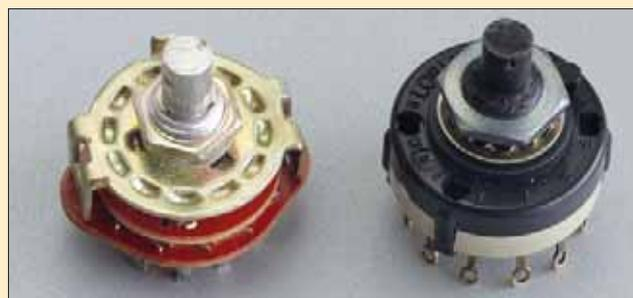
Stufenschalter in zwei Ausführungen. Zum Umschalten der Mehrfachmessung verwenden wir die rechte Bauart.
