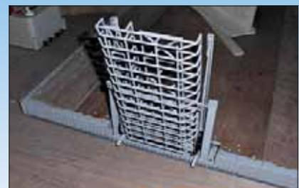
Eine einfache Lehre aus Holz half beim Löten der gleich großen Brückenteile (links). Die einzelnen Teile wurden dann mit Distanzhölzern montiert, so erhielten sie alle denselben Abstand (Mitte). Am Ende muss die Brücke senkrecht und gerade öffnen (rechts).
