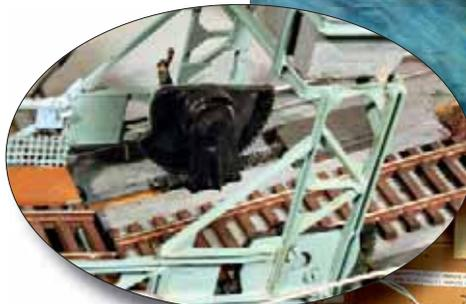
Die mechanische Bewegung wird über ein Zahnrad an der Brücke und eine bewegte Zahnstange im Boden realisiert. Über Schalter am Antrieb erfolgt die Abschaltung (oben).
