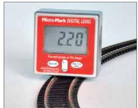
Ob Haupt- oder Nebenbahn – das Ermitteln einer Kurvenüberhöhung bei der Gleisverlegen samt einem sanften Übergang ist mit diesem Gerät bestens möglich.
