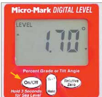
Nach Betätigen der On Taste erscheint diese Anzeige mit „Level“ im Display; der reale Wert ist noch nicht ermittelt.
