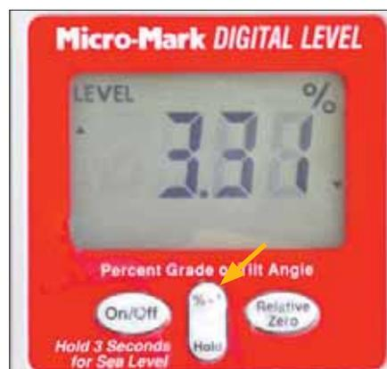
Wird die obere Hälfte der mittleren Taste betätigt, schaltet das Gerät von Grad- auf Prozentanzeige um.
