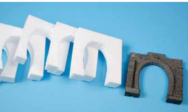
Die Zahl der anzufertigenden Segmente hängt von der Länge der Tunnelröhre ab. Der Heißdrahtschneider von Proxxon würde es auch erlauben, dickeres Material zu schneiden. Auch wäre es möglich, die Segmente konisch zuzuschneiden, um dem Verlauf des ...
