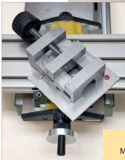
Hier sitzt die Einheit um 45° gedreht mit beiden Führungsrollen in der vorderen Spannnut. Die zentrale Befestigungsschraube ist noch teilweise zu erkennen.
