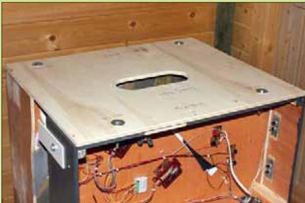
Für eine schnelle Montage der zu transportierenden Module sollten die entsprechenden Bretter und die Bohrungen beschriftet werden. Das Loch zum Tragen ist so anzulegen, dass dahinter nichts zerstört werden kann ...
