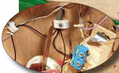
Am Kran existiert ein Antrieb zum Drehen und einer zur Seilbewegung. Die Motoren erhielten Getriebe zur Übersetzung. Über kleine Schalter am Anschlag ist die Bewegung begrenzt.
