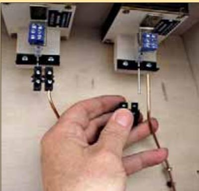
Bei Verwendung des stärkeren Schweißdrahtes müssen Lüsterklemmen mit einer größeren Öffnung verwendet werden.
