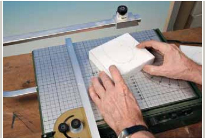
Mit dem Heißdrahtschneider lassen sich die Tunnelsegmente exakt ausschneiden, jedoch sollten die Styroporteile mit gleichmäßiger ...
