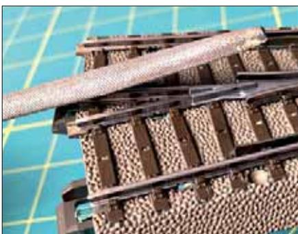
Links: Aufgrund unterschiedlicher Schienenprofilhöhen ist das Märklin-Gleis abzufilen.
