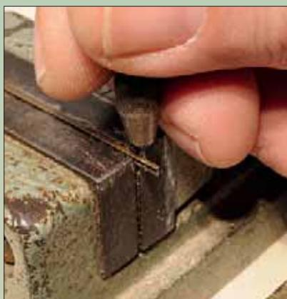
Wenn der Haltestift der Stellstange in der Bohrung sitzt, kann die kleine Lасhe mit einer Zange fest angedrückt werden.
