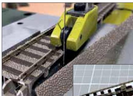
Damit die Konstruktion auch optisch mit dem C-Gleis kompatibel wird, fehlt nun nur noch eine Böschung. Sie wird mithilfe der Säge von einfachen C-Gleisen gewonnen: Während auf der DKW-Seite die Böschung aus mehreren Stücken zusammengesetzt werden ...
