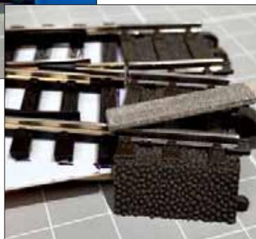
Nach dem Anschluss der Antriebe sind die Fahrstromverbindungen zwischen C-Gleisstücken und die DKW untereinander mit Litze verlötet. Als schwierig erweist sich das Löten an den Schienen der Peco-DKW, die mit dem Lot nicht so recht eine Verbindung eingehen wollen. Da sind schon mal mehrere Versuche notwendig.
