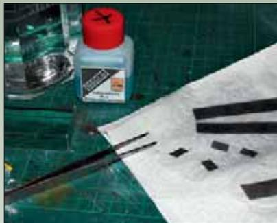
Die Messingätzteile gibt es in verschiedenen Ausführungen (links). Die Bauteile müssen aus den Trägerblechen herausgeschnitten werden. Mit einer Kaltbrünierung färbt man die Bauteile ohne dicken Farbauftrag (rechts).
