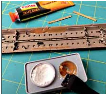
Mit Zweikomponenten-Kleber werden die beiden Hälften stabil verklebt.
