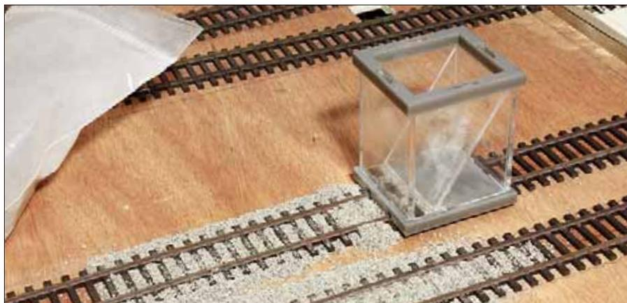
Mit dem Schotterverteiler lässt sich der von oben eingefüllte Schotter wohldosiert, vorbildgerecht und vor allem gleichmäßig zwischen und neben den Gleisen verteilen.
