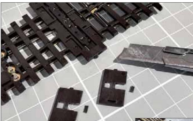
Auch an der DKW sind einzelne Stücke entbehrlich: Die kleinen Bodenplatten unter der Stellschwelle werden dort entfernt, wo der Stellbügel angebracht wird, und die seitlichen Verstärkungen sind verzichtbar, weil ...
