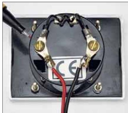
Auf der Rückseite des Messgeräts sind unter den Anschlüssen die Polmarkierungen vorhanden; sie werden hier von den Leitungen teilweise verdeckt.
