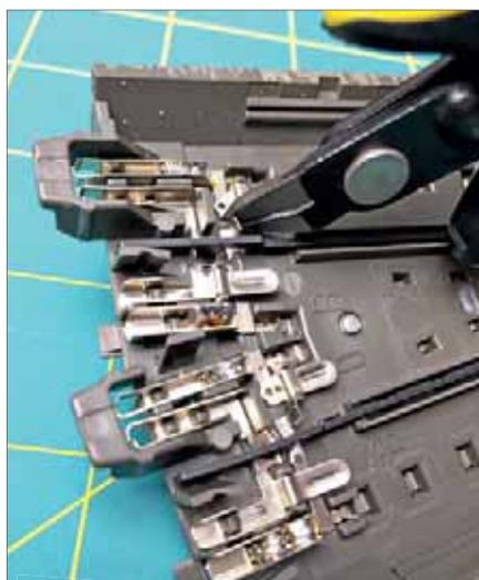
Links: Für den DC-Betrieb sind die kleinen Bleche, welche die beiden Schienen leitend verbinden, zu durchtrennen.
