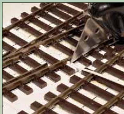
Die fehlenden Kleineisen an den zusätzlichen Schwellen wurden einfach mit Polystyrolstreifchen von Evergreen ergänzt (unten 0,25 x 1,5 mm, darauf 0,4 x 1 mm).
