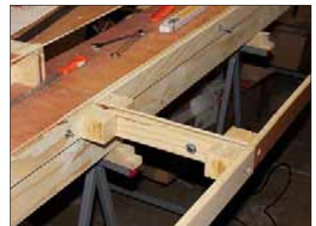
Damit die Anlage noch transportabel bleibt, erhält sie hier zusätzliche Ansatzstücke, mit denen die eigentlichen Segmentkästen auf Vorder- und Rückseite erweitert werden. Bei Ausstellungen können sie auch weggelassen werden, falls der Platz nicht reicht. Die einzelnen Rahmentteile sind stabil ausgeführt und werden über Schrauben mit der Anlage verbunden.
