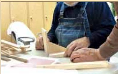
Aus kleinen Holzresten sägt man die Bauteile für die Ablagen zurecht und klebt sie mit Holzleim zusammen (oben links). Die montierten Ablagen erhalten Bohrungen zur Befestigung und für die Anschlusskabel (oben rechts). Nach dem Beschleifen werden die Ablagen lackiert und vermitteln einen ansehnlichen Eindruck (rechts).
