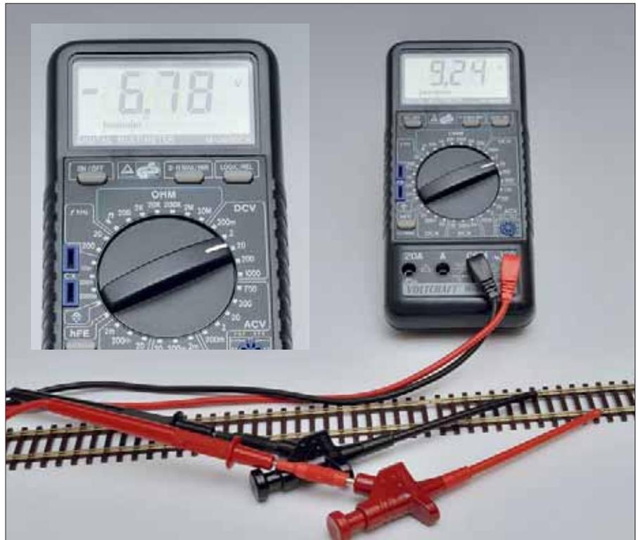
Fahrspannungsmessung mit einem digitalen Multimeter nach einer Polwendung.
