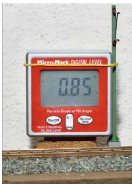
Hier leistet der digitale Gradmesser beim Positionieren von Oberleitungsmasten an den Neigungsstrecken gute Dienste.
