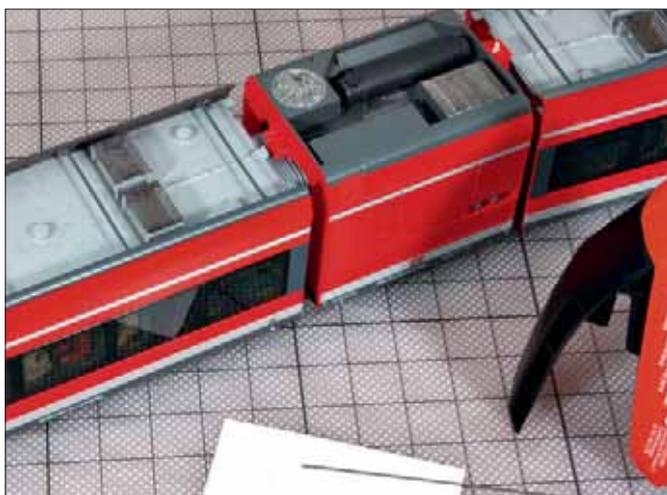
Die kleinen Blechteile erhielten durch Brünieren eine dunkelgraue Farbgebung und wurden mit sehr sparsam dosiertem Sekundenkleber befestigt. Eine dünner Draht eignet sich dabei gut zum Aufbringen des Klebers. Der Kleber sollte dabei nicht die feinen Öffnungen des Lochblechs verschmieren.
