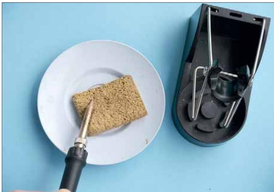
Ein unverzichtbares Werkzeug beim Feinlöten ist der feuchte Schwamm. Überschüssiges Lötzinn an der Spitze und Zunder, der vom Flussmittel herrührt, sollten vor jedem neuen Lötvorgang abgestreift werden, um eine saubere Lötstelle zu erhalten. Fotos: Thomas Wollschläger
