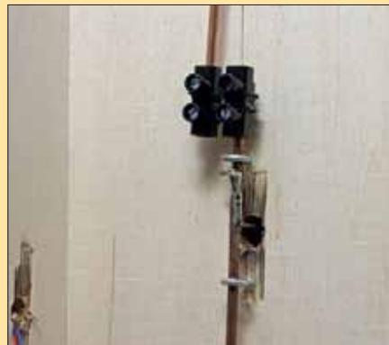
Den Weichen-Stelldraht auf die Stellstange zu löten, ist die schnellste Methode einer Verbindung nach oben.
