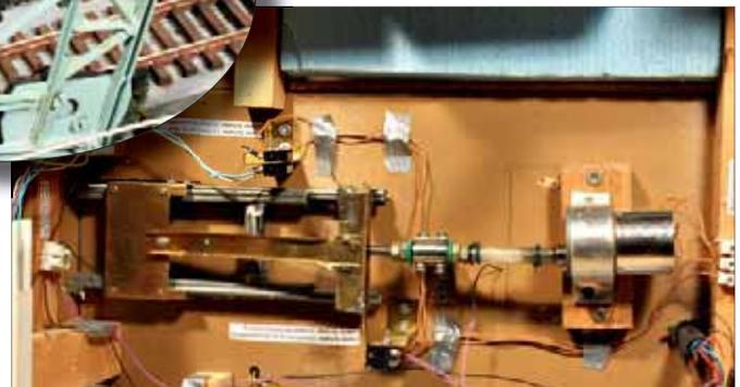
Der Antrieb unter der Anlage besteht aus einem Motor und einer Schnecke, die einen Schlitten mit der Zahnstange langsam bewegt.
