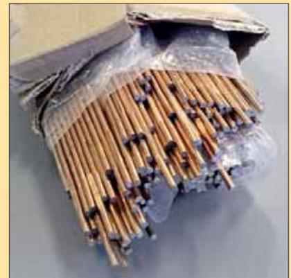
Rechts: Stabilere Stelldrähte gewinnt man z.B. aus 3 mm starkem Schweißdraht.
