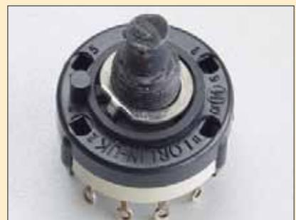
Die Rückansicht der rechten Type mit 2 x 6 Kontakten; mit der kleinen Arretierung auf der Vorderseite läßt sich die Stufenanzahl festlegen.
