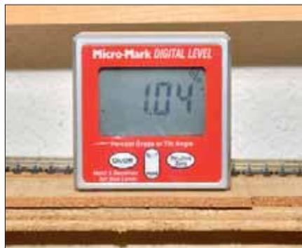
Beim Streckenübergang von der Waagerechten in die Neigung lässt sich eine optimale, kontinuierliche Ausrundung beginnend bei Null bis zum Sollwert überprüfen.
