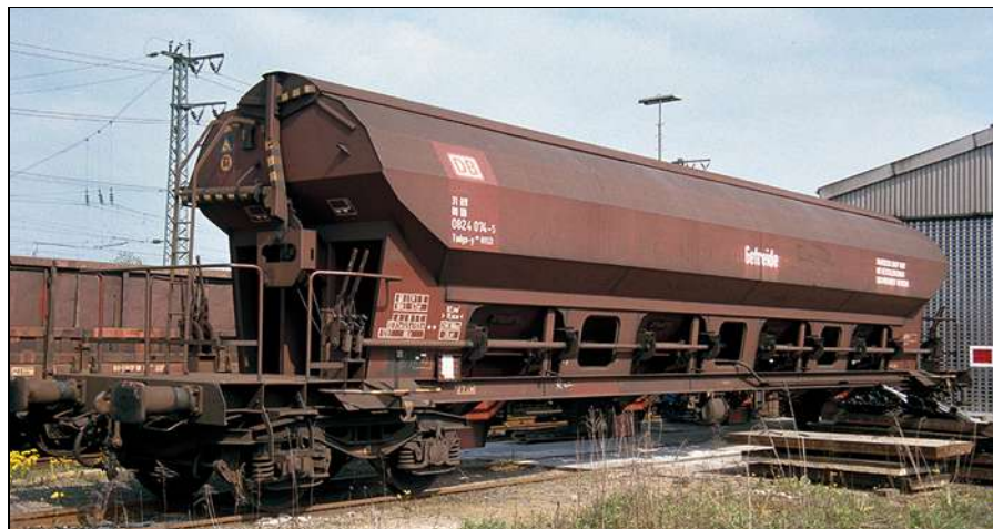
Die modernsten Varianten der Getreidewagen sind die schon bereits ab 1970 gebauten Tads (957, 958, 959). Hier ein Tads-y 957 der ehemaligen DR mit über 80 m³ Laderaum.
