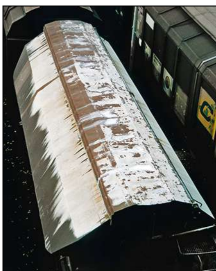
Vorbildstudie eines Schwenkdaches mit den typischen Ladegutrückständen und Verlaufsspuren durch Regen.
