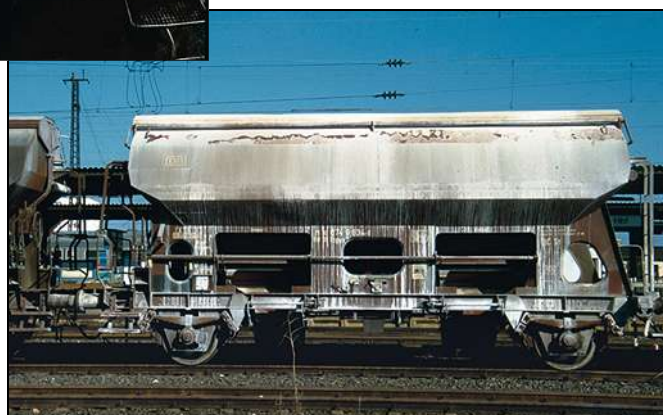
Vorbildstudie eines Schwenkdaches mit den typischen Ladegutrückständen und Verlaufsspuren durch Regen.
