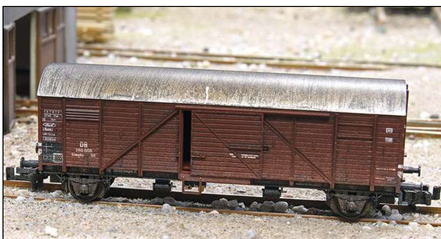
Der Glm(g)hs 36, ein früherer Leipzig, wurde für den Getreideverkehr zwischen Frankreich und Süddeutschland mit Schüttklappen ausgerüstet. Hier erfolgte die Befüllung durch die oberen, seitlichen Luken. Derzeit gibt es nur ein N-Modell von diesem Wagen.
