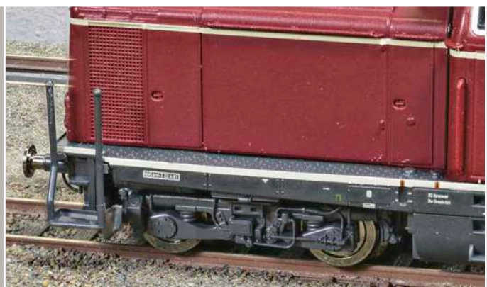
Das Drehgestell unter dem langen Vorbau zeigt die Sifa mit Kardanwellenantrieb, Druckluftleitungen und Geberleitung für den Tacho.
