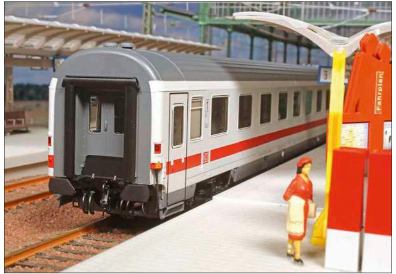
An den Modellen müssen die Trittstufen unter den Türen sowie Luftleitungen, Kupplungen und Steuerleitungen an den Stirnseiten nachgerüstet werden. Je nach Bauform können noch Dachlüfter auf das Dach geklebt werden. Die Stirnseiten der Wagen sind damit vorbildgerecht ausgeführt (rechts).
