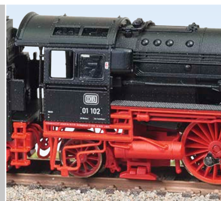
An den Luftkesseln sind auf beiden Seiten auch die Bremsluftleitungen nachgebildet.
