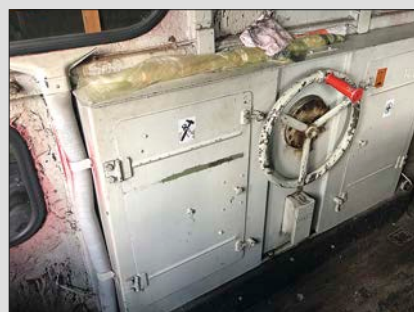
Links: Auch auf der linken Seite gibt es ein Führerbremsventil. Davor angeordnet der Totmann-Taster. Beidseitig vom Mittelpult ist das Fahrschalterhandrad zu erkennen. Darunter der kräftige Hebel für die Wendeschaltung des Getriebes.
