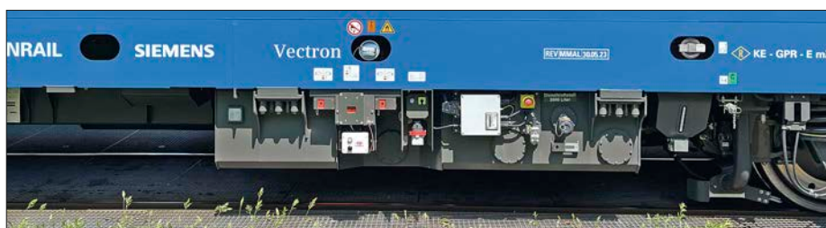
Unter dem Lokkasten sitzen der Tank und der Transformator. Im Lokkasten sind die Einfüllstutzen für Diesel und Sand zu erkennen.
