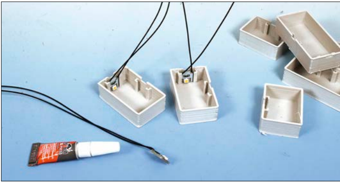
Mit sogenannten Lichtboxen lassen sich einzelne Fenster in Gebäuden beleuchten. Hier kamen Modelle von Austromodell mit winzigen LED-Platinen, die in die Boxen eingeklebt wurden, zum Einsatz.
