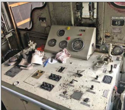
Rechts: Im Führerstand finden sich auf der rechten Seite das Führerbremsventil und – etwas höher gesetzt – der Zusatzbrems-hahn. Am gebogenen Rohr liegt – rot gestrichen! – das Notbremsventil. Unten erkennt man noch den Feuerlöscher.
