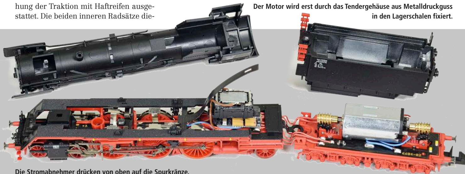
Die Stromabnehmer drücken von oben auf die Spurkränze.
