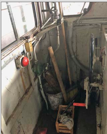
Rechts: An der Rückwand liegt der Werkzeugschrank. Links und rechts daneben die Luftdüsen für die Scheiben und mittig das große Handbremsrad.
