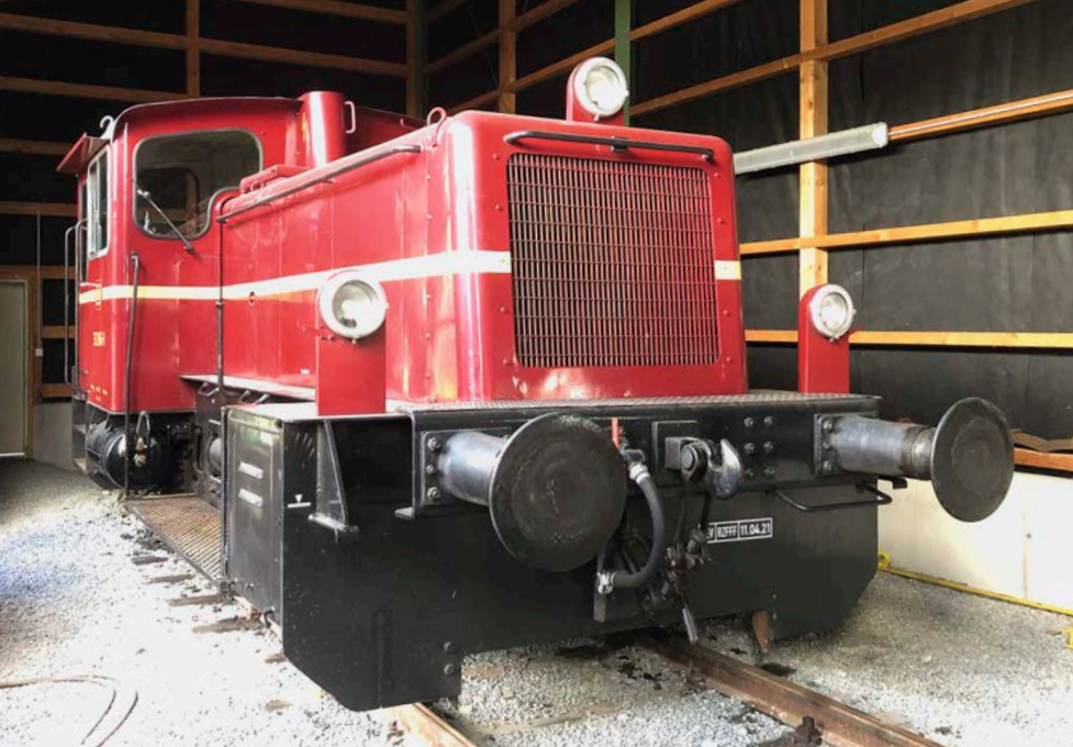
Mithilfe roter Vorsteckscheiben können die Lampen an der Köf III auch den Zugschluss signalisieren. Kleine Winkelchen und ein Riegel dienen als Scheibenhalterung. Links: Auf dem Mittelpult sind rechts und links die Ventile fürs Sanden angebracht. Mittig die sechs großen Lampenschalter
