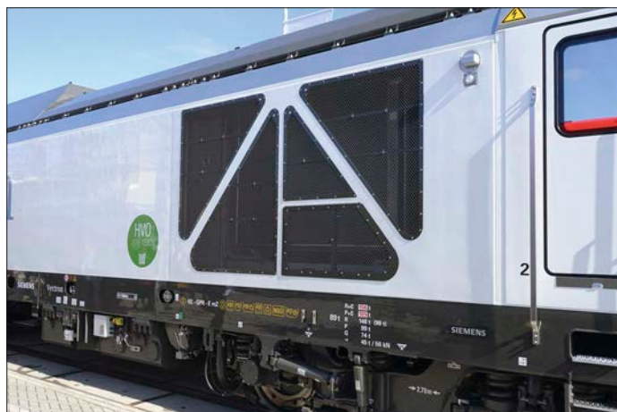
Unter dem Lokkasten sitzen der Tank und der Transformator. Im Lokkasten sind die Einfüllstutzen für Diesel und Sand zu erkennen.
