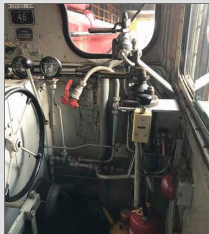
Links: Auch auf der linken Seite gibt es ein Führerbremsventil. Davor angeordnet der Totmann-Taster. Beidseitig vom Mittelpult ist das Fahrschalterhandrad zu erkennen. Darunter der kräftige Hebel für die Wendeschaltung des Getriebes.
