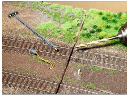
Den kleinen Steckfuß befestigt man in einem 6 mm großen Loch, welches hier mittig zwischen den Gleisen eingebohrt wurde.
