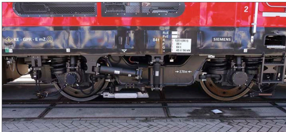
Die Drehgestelle der Dual Mode-Vectrons weichen von den E-Vectrons ab. Die Konstruktion stammt noch von der ER 20. Deutlich ist der Schlingerdämpfer im Vordergrund zu erkennen.
