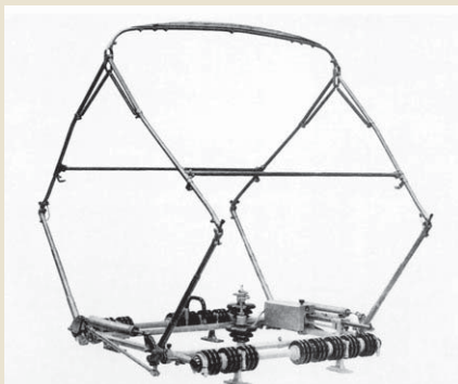
Der SBS 10 mit Rillenisolatoren besaß keinen automatischen Trennschalter mehr. Die Schleifstückbreite (links Aluminium, rechts Kohle) lag ursprünglich bei 2100 mm.
