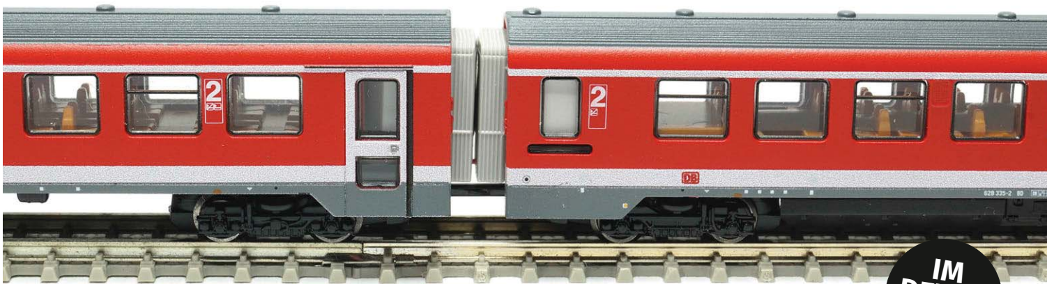
Die Faltenbälge sind federnd gelagert und werden durch Magnete auch bei Kurven- und Weichenfahrten fest zusammengehalten, so dass stets ein geschlossenes Zugbild zu sehen ist.
