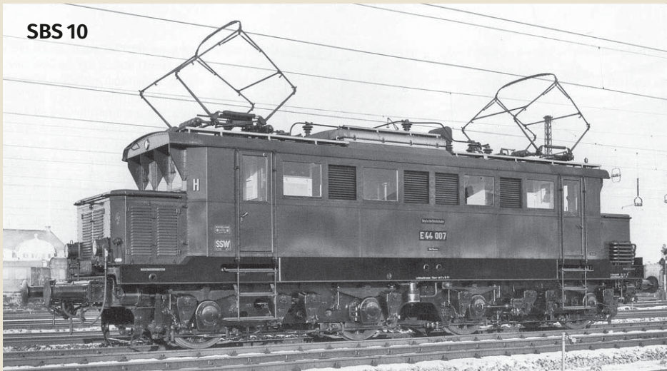
Lokomotiven wie die E44 erhielten ab Werk bereits den SBS 10. Er unterscheidet sich optisch vom SBS 9 durch die Rillenisolatoren, die immer noch quer zur Fahrtrichtung lagen.
