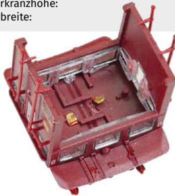
Der Stromabnehmer ist nur über zwei umgebogene Klammern fixiert.
