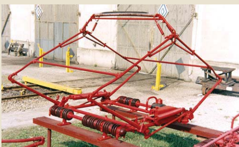
Im Bw Freilassing wurde dieser muster­gültig aufgearbeitete SBS 10 gelagert. Die Rillenisolatoren sind einheitlich mit brauner Glasur versehen. Der Druckluft­antrieb ist identisch mit dem Antrieb des SBS 9. Die Wippe mit 1950 mm Breite trägt ein Kohleschleifstück.
