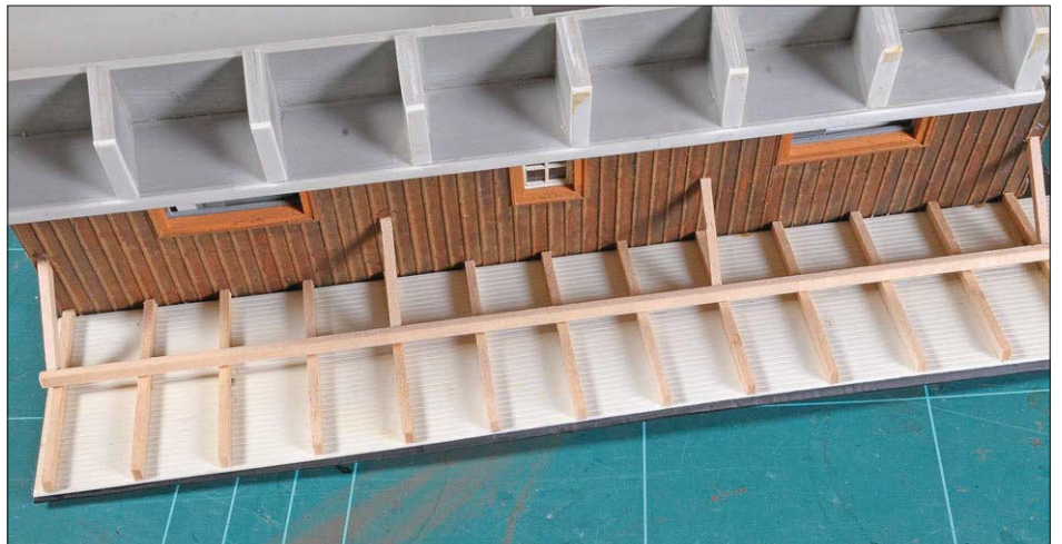
Die Bretter auf der Dachunterseite entstanden aus einer einer 0,5 mm dicken Polystyrolplatte von Evergreen, die Balken wiederum aus Holzleisten. Die Leisten wurden mit Uhu-Alleskleber fixiert, überquellender Kleber lässt sich mit Aceton und einem Pinsel leicht entfernen.
