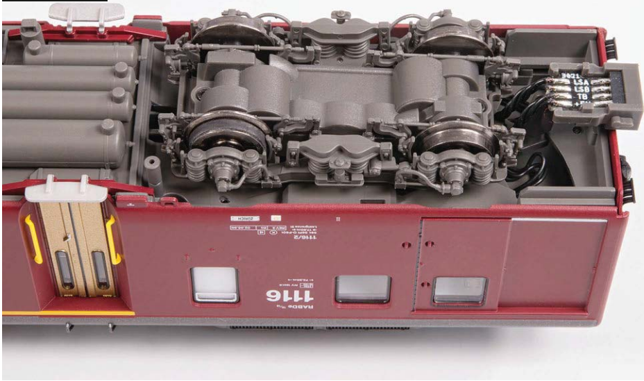
Von unten ist die 8-polige und stromführende Kupplung zu erkennen. Auch die Details an den Drehgestellen und am Wagenboden sind astrein nachgebildet.
