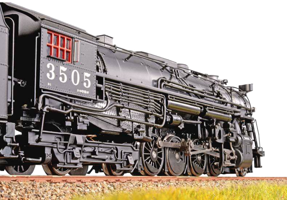
Alles an dieser Lok ist gewaltig: Massive Radsätze und Treibstangen prägen das Bild. Zahlreiche Rohrleitungen laufen entlang des Kessels. Besonders interessant ist das Nachlaufdrehgstell, dessen vorderer Radsatz einen kleineren Durchmesser als der hintere besitzt.
