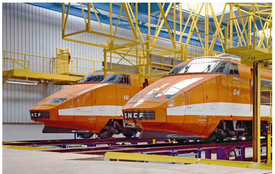
Der Rekordzug No. 16 im Betriebswerk neben dem Serienzug No. 04. Im Bereich des Frontspoilers und des Drehgestells sind die vergrößerten Räder des Rekordzuges gut sichtbar. Die weiteren Modifikationen waren im Vergleich zu späteren Rekordfahrten eher moderat.
