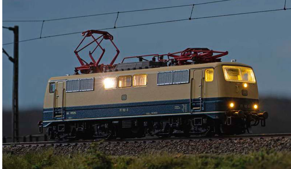
Ein schöner Anblick: Licht an und schnell zurück in die Abstellung. Digital lassen sich neben dem Spitzenlicht und der Zugschlussbeleuchtung auch eine Führer- und Maschinenraumbeleuchtung schalten.
