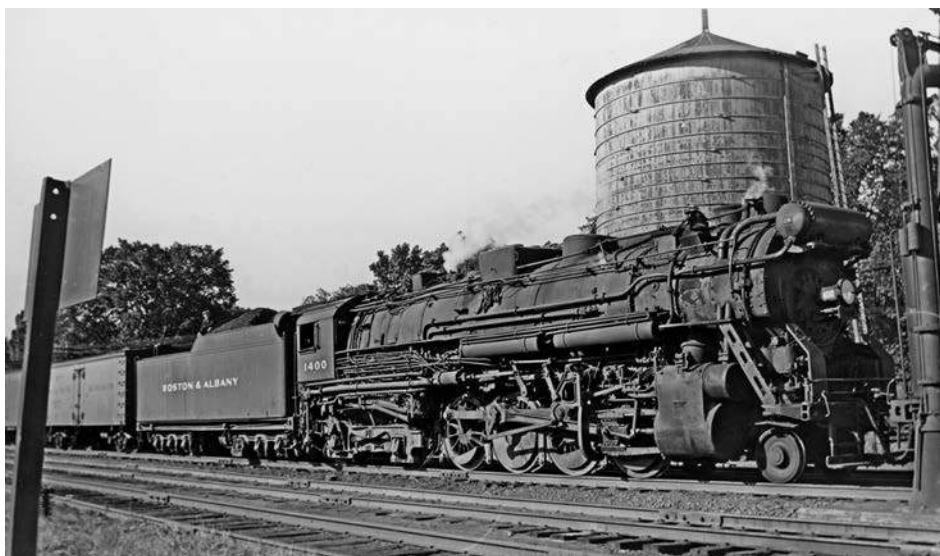
Die A-1a 1400 der Boston & Albany Railroad hält am 28. September 1947 in West Brookfield, Massachusetts, um Wasser aufzunehmen. Sie nutzt den sogenannten Elesco-Mischvorwärmer über der Rauchkammer.
