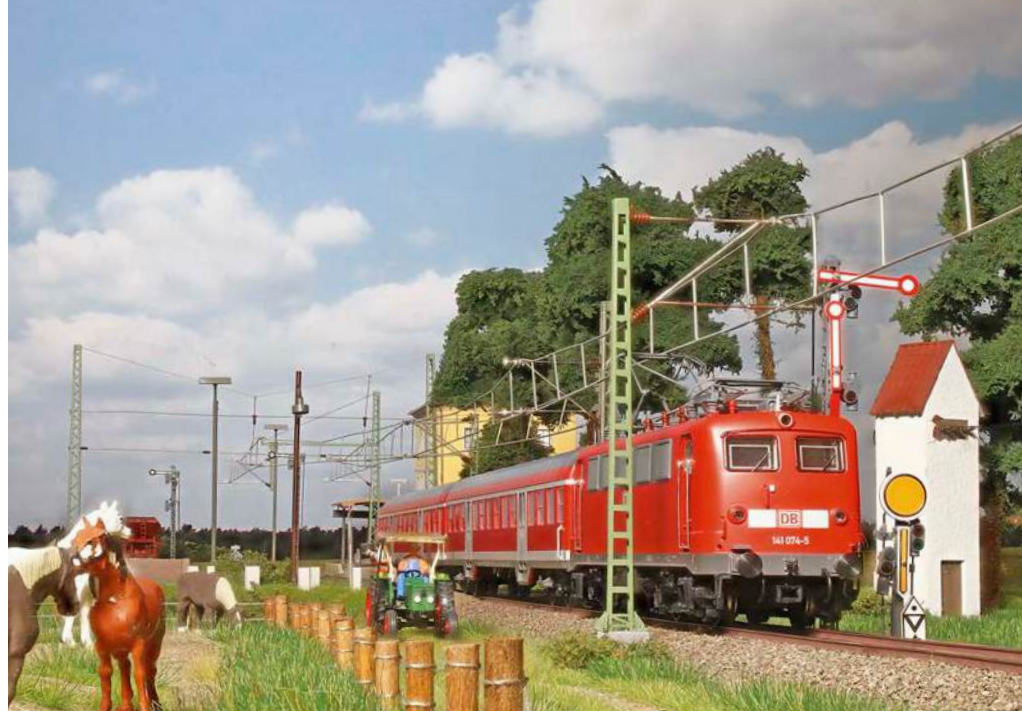
Um die Signalsicht an diesem Einfahrsignal nicht zu beeinträchtigen, wurde der Fahrleitungsmast an der gegenüberliegenden Gleisseite aufgestellt. Die von Märklin vertriebenen Masten besitzen Ausleger mit Fahrdrathalterungen aus Metall. Der Mast steht hier neben einem nachträglich eingeschotterten C-Gleis von Trix.
