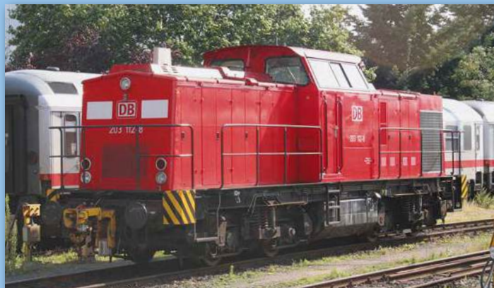
Die DB AG besaß Anfang der 2000er-Jahre die Baureihe 203 und setzte sie für Rangieraufgaben im Raum Nürnberg ein. 203 112 rangiert hier am 14. Juli 2006 in Nürnberg Hbf. Deutlich sind die anderen Geländer an der Lokfront im Vergleich zur jüngeren HVLE-Lok im Bild unten zu erkennen.
