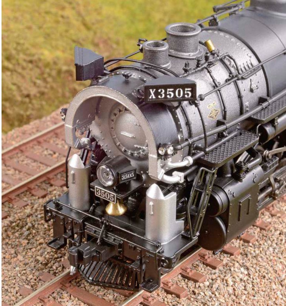
Der sogenannte Coffin-Mischvorwärmer über der Rauchkammer beschert der SP3505 ihren einzigartigen Anblick. Aber auch die zahlreichen angesetzten Details machen die Dampflokfront zu einem absolut faszinierenden Hingucker.
