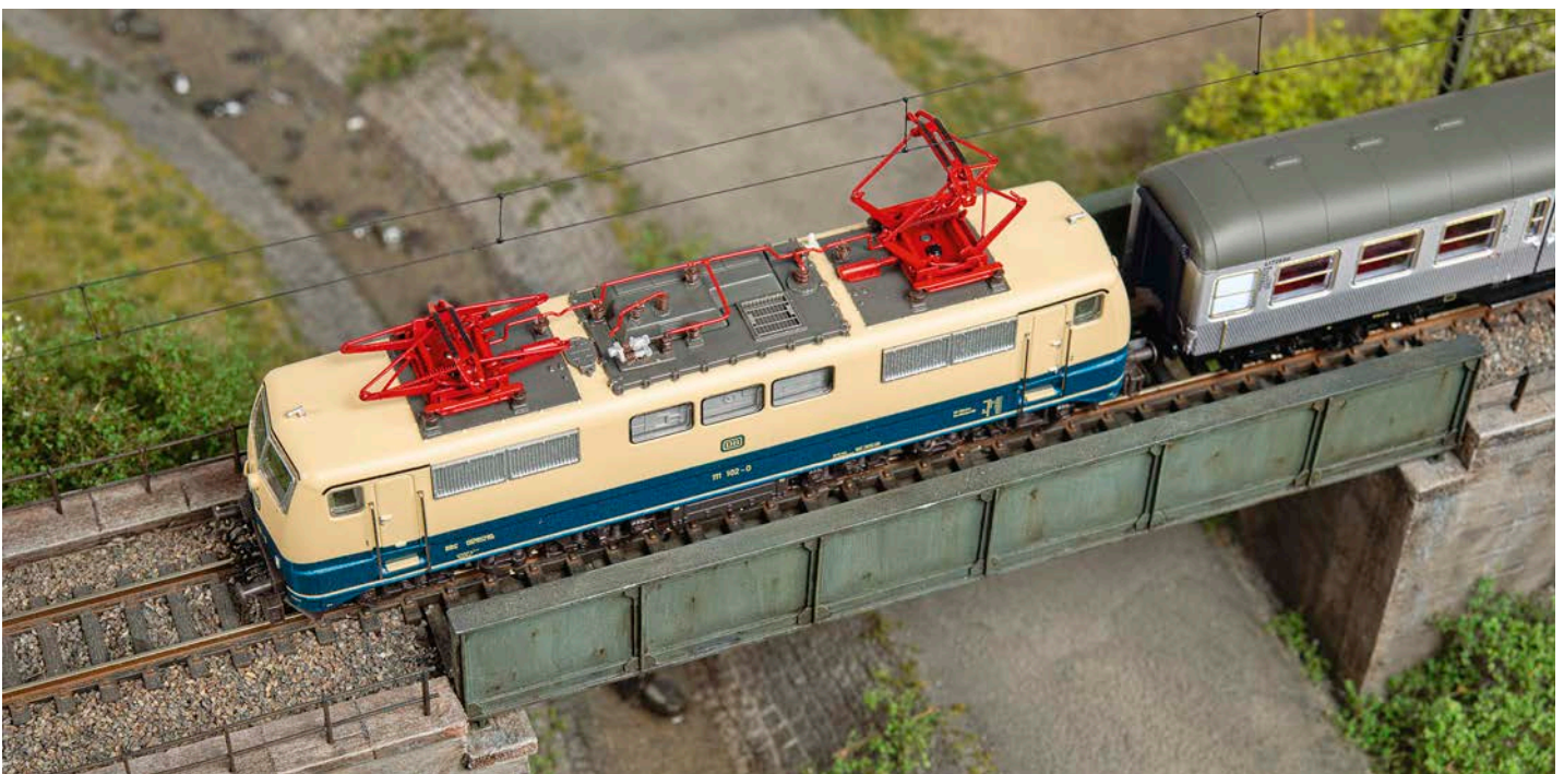
Die Dachgestaltung des Modells ist ein echter Hingucker. Die Leitungen, der Hauptschalter und das geätzte Lüftungsgitter fallen positiv auf. Leider wurden bei den Stromabnehmern nur die Schleifleisten erneuert.
