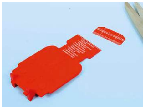
Zur Bestimmung der Position der Ausleger über dem Gleis und somit auch der Maststandorte am Gleis wurde hier die Fahrdraht-Lehre von Märklin genutzt. Die Höhe der Bettung bemisst man durch Kürzen der Lehre in der Höhe (links). An der auf das Gleis gestellten Lehre kann man dann den Fahrdrahtbereich erkennen und die Auslegerposition einstellen.
