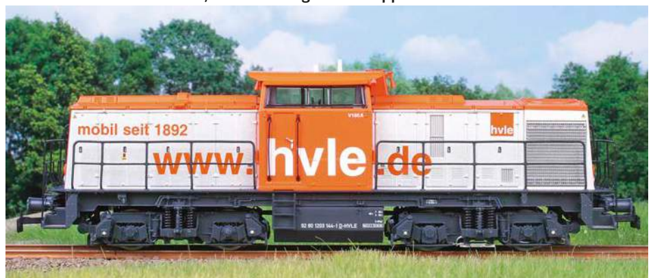
In der Seitenansicht lassen Vorbild und Modell ebenfalls gute Vergleiche zu. Brawa hat das Vorbild hier minutiös nachempfunden und nicht nur eine Farbversion der DR-V 100 auf das Modellgleis gestellt. Das kürzere Geländer links neben dem Führerhaus ist allerdings eine HVLE-eigene Umsetzung, die nur hier zu finden ist. Die HVLE-Lokführer kommen so von der Führerhausleiter der rechten Seite schnell auf den Umlauf, da man häufig an die Klappen im Vorbau muss.
