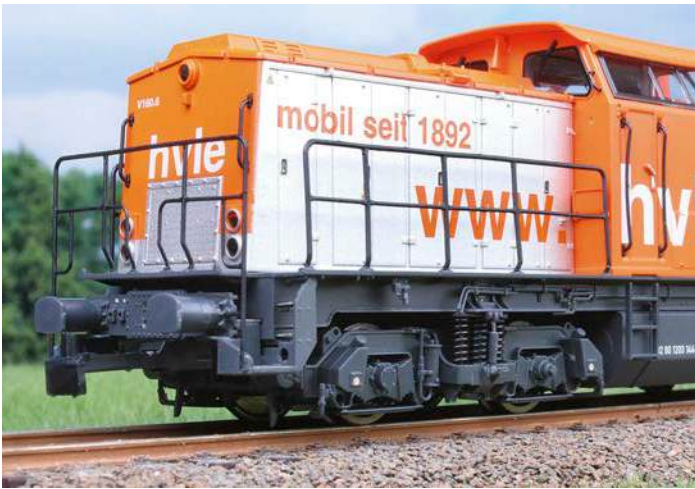
V 160.6 der HVLE im Modell und beim Vorbild. Auch der Vorbau auf der hinteren Lokseite entspricht dem Vorbild. Die schwarzen Griffstangen am H0-Modell sind aus flexiblem Kunststoff. Sie sitzen an den vorbildgerechten Stellen. Auch die Seitenscheiben mit den großen schwarzen Rahmen sind vorbildkonform. An den Drehgestellen wurden die drei Flexicoil-Federn sowie alle Leitungen kleinteilig und korrekt umgesetzt.
