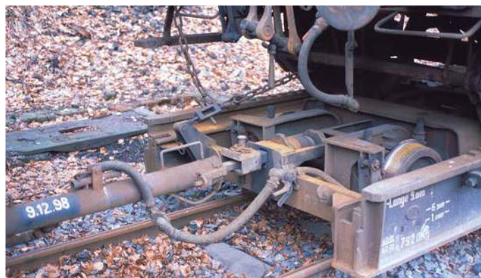
Gekuppelt werden die Rollwagen mit Kuppelstangen und einem kleinen Bolzen an der Kupplungsaufnahme am Rollwagen. An den Kuppelstangen verläuft auch die Druckluftleitung für die Bremse.
