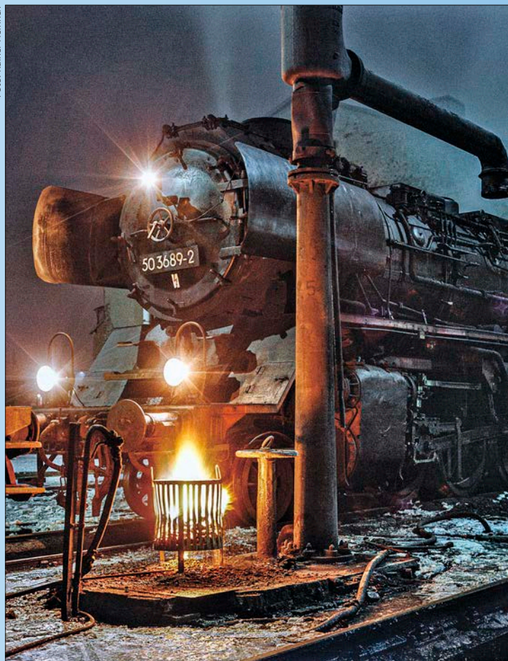
Die Wasserabgabestellen drohen bei Frost einzufrieren. Glühende Kohle sorgt daher für warme Umgebungsluft.
