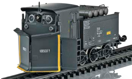
Die DB führte beim Klima-Schneepflug die Front mit gummigefassten Fenstern ein.
