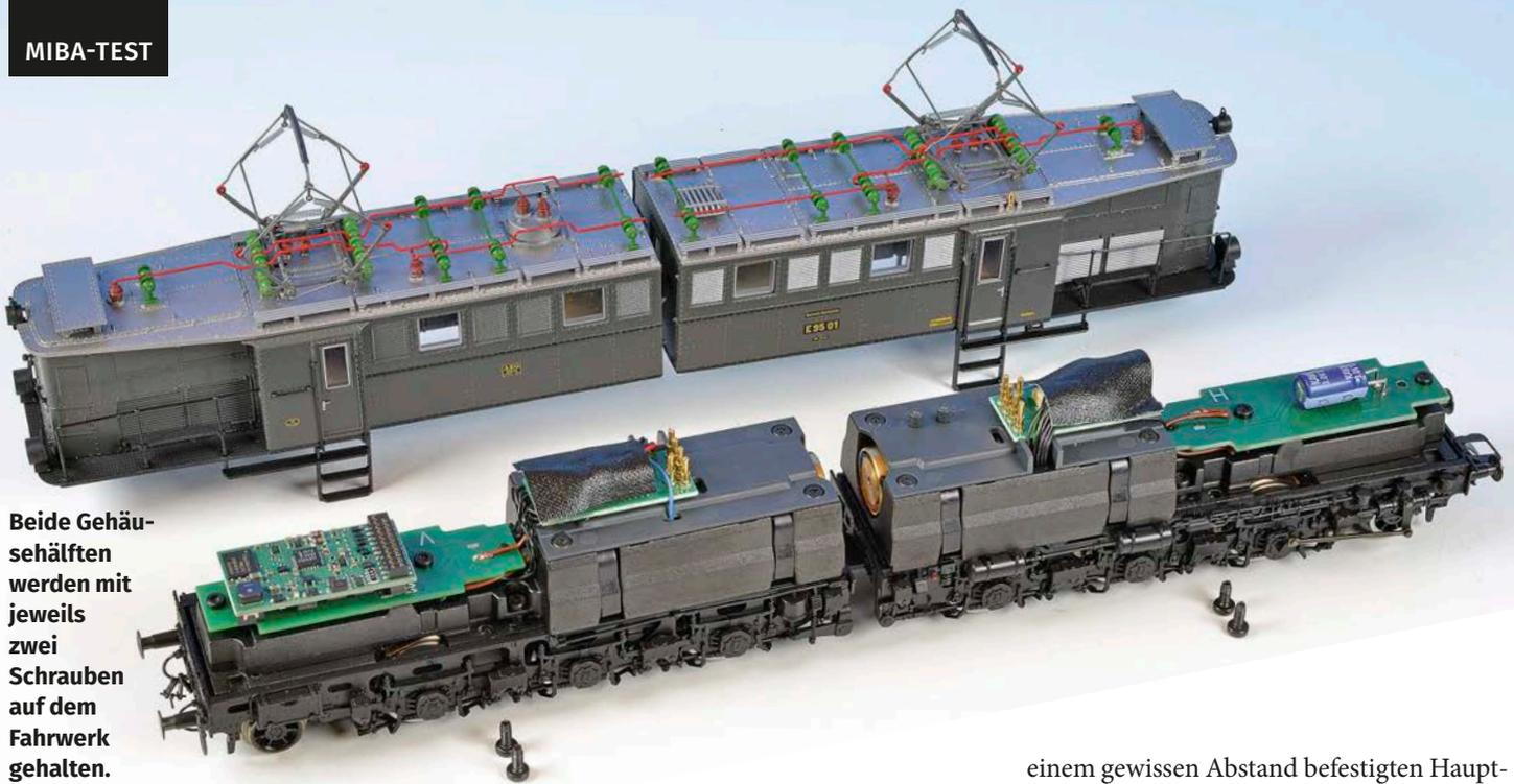
Beide Gehäusenhälften werden mit jeweils zwei Schrauben auf dem Fahrwerk gehalten.
