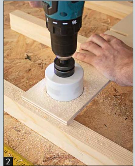
**2** Mittels Lochfräse werden die Spanten mit Bohrungen versehen. Diese sparen nicht nur zusätzliches Gewicht ein, sondern ermöglichen später eine einfachere Verkabelung.
