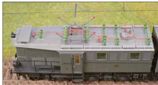
... Dach der hinteren Lok liegt der Zwischenkühler. Die durchgehende Dachleitung endet auch hier im Durchführungsisolator.
