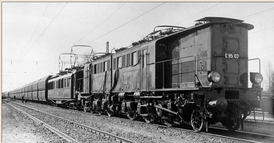
E 95 03 steht mit einem 2568-t-Ganzzug bereit für die Abfahrt (24.3.1928, Ingramsdorf). In den Zug eingereicht ist zudem der Messwagen „A“. Die Lok ist mit Fahrluftpumpen ausgerüstet und hat noch keine in die Geländer integrierte Tritte. Foto: Nachlass E. W. Curtius, Slg. Linke
