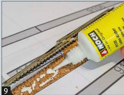
**9** Die Gleise werden mit NOCH-Latexkleber fixiert. Schrauben helfen vorübergehend bei der Justierung.
