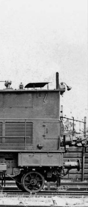
Dieses Bild diente als Vorlage für die Ausführung des Märklin-Modells. Die Lok präsentiert sich im Ablieferungszustand auf dem Werkshof von AEG. Sie hat deutlich erkennbar noch die Fahrluftpumpen, aber noch keine Tritte in den Geländern. Ein Untersuchungsdatum ist zu diesem Zeitpunkt noch nicht angeschrieben. Fotos: Werkfoto AEG, Slg. Linke
