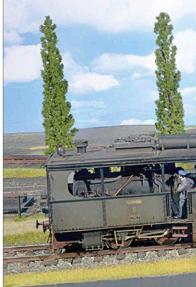
hohen Spurkränze auf 1,5 mm (max. 2,0) abgedreht und insbesondere alle Radsatzinnenmaße auf die erforderlichen 40,9 mm gebracht wurden.
