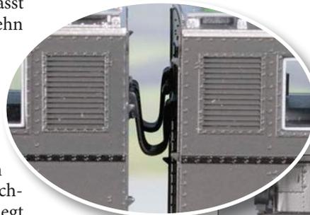
Die Fahrwerke der beiden Lokhälften unterscheiden sich vorbildgerecht. An der hinteren Lokhälfte ist besonders auffällig der Antrieb der Fahrluftpumpe über ein bewegliches Gestänge.
