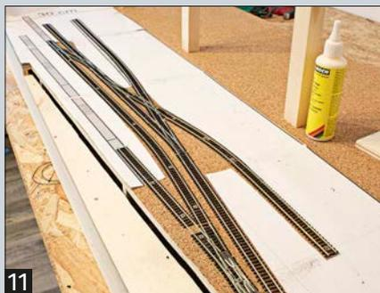
**11** Überblick über die verlegten Gleise im Hafen. Nun kann der Plan entfernt werden.
