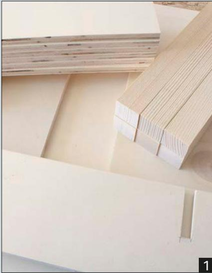
**1** Aufgrund des Gewichtsaspektes wird nur leichteres Holz verwendet. Die einzelnen Spanten sind aus 10-mm-Pappelsperholz zurechtgeschnitten. Fichtenleisten setzen später das Fundament des Schaukastens.
