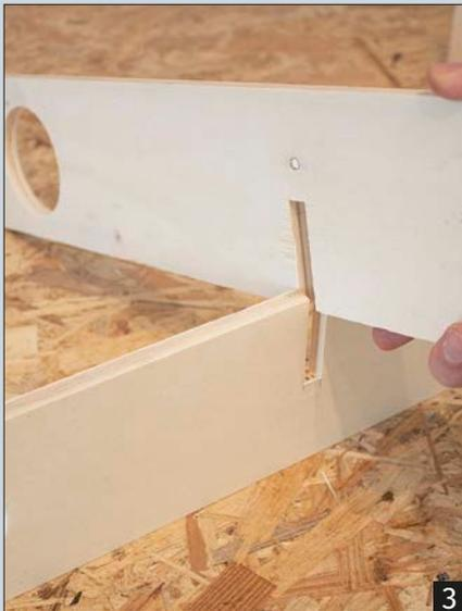
**3 4** Die innenliegenden Spanten werden am Schnittpunkt um die Hälfte jeweils von oben und unten ausgeklinkt. So können sie – mit Leim bestrichen – einfach zusammengesteckt werden und bilden so die erste Grundfestigkeit.
