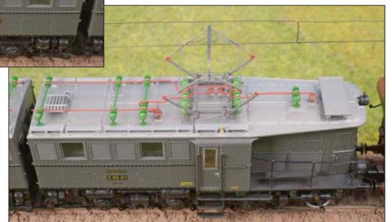
Links: Zwischen den beiden Lokhälften können bei Vitrinenmodellen die Imitationen der elektrischen Verbindungsleitungen eingesetzt werden.
