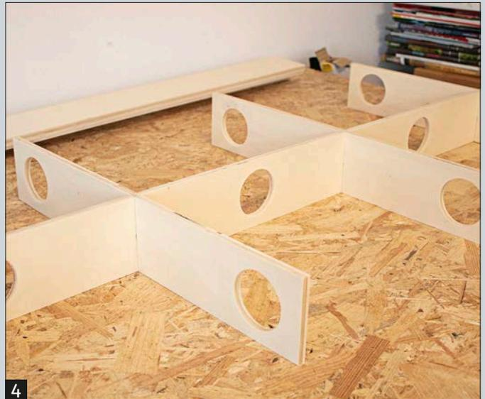
**6** Nach dem Ausschneiden des Hafensbeckens können nun die Querstreben zur Probe gesetzt werden. Sie bilden später die Tragstruktur für den Hintergrund.
