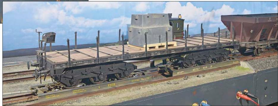
Rechts: Dann werden die Rollwagen auf den Drehzapfenabstand des Regelspurwagens auseinandergezogen.
