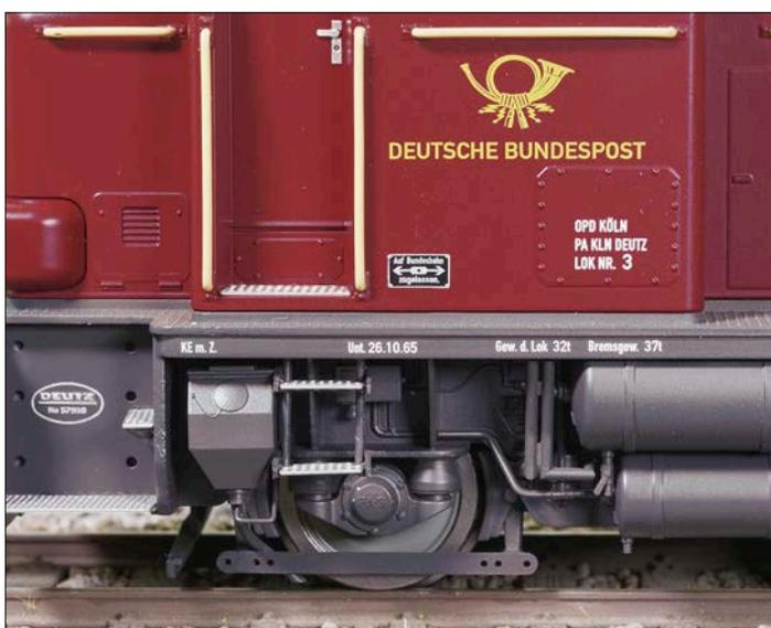
Die graue Farbgebung lässt Details sehr gut in Erscheinung treten. So entdeckt man hier die Luftfederung, Achslagerdeckel mit „FAG“-Schriftzug, Sandbehälter mit Steuerleitung und Sandfallrohr sowie Entwässerungsventile an den Luftbehältern.
