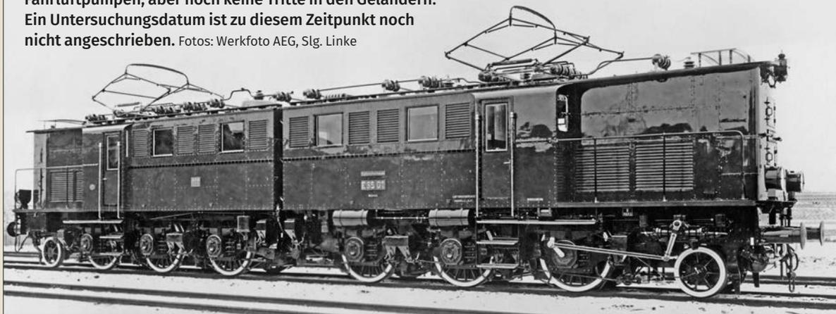
höhe reichenden schmalen Vorbauten vor den Führerständen sind jeweils ein Hauptumspanner als Manteltransformator in Sparschaltung mit Transformatorlüfter sowie die halbe Ausrüstung für die Schützensteuerung untergebracht. Im vorderen Vorbau ist noch der Lichtgenerator verbaut. Durch große Klappen in den Vorbauten sind die Aggregate von außen zugänglich.
