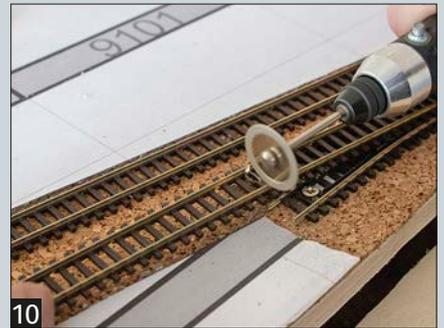
**10** Flexgleise werden angezeichnet und mit einer Diamanttrennscheibe präzise abgelängt.
