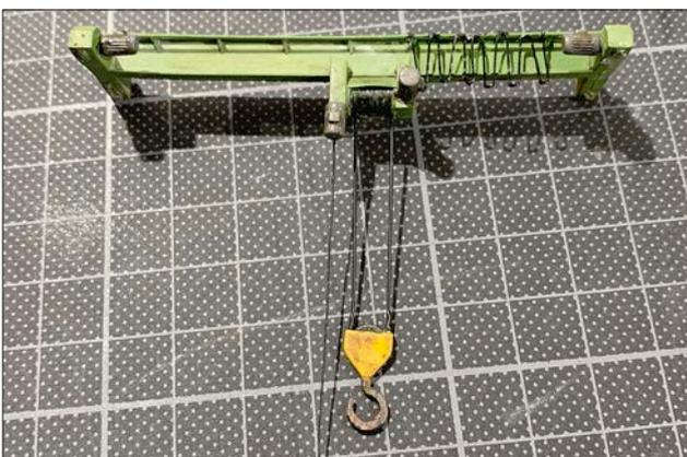
Mithilfe der 3D-Konstruktion und eines Resindruckers eröffnen sich vielfältige Möglichkeiten der Gestaltung von Laufkatze mit detaillierten Elektromotoren, Flaschenzug und der rechts abgebildeten Bedieneinheit. Allerdings muss man sich mit der 3D-Konstruktion und dem 3D-Druck zuvor intensiv beschäftigen. Viele Tipps gibt es in MIBA-Spezial 153.
