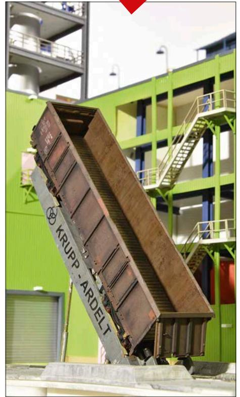
Die verriegelten Entladeklappen öffnen sich in Abhängigkeit vom Winkel der Kippanlage.
