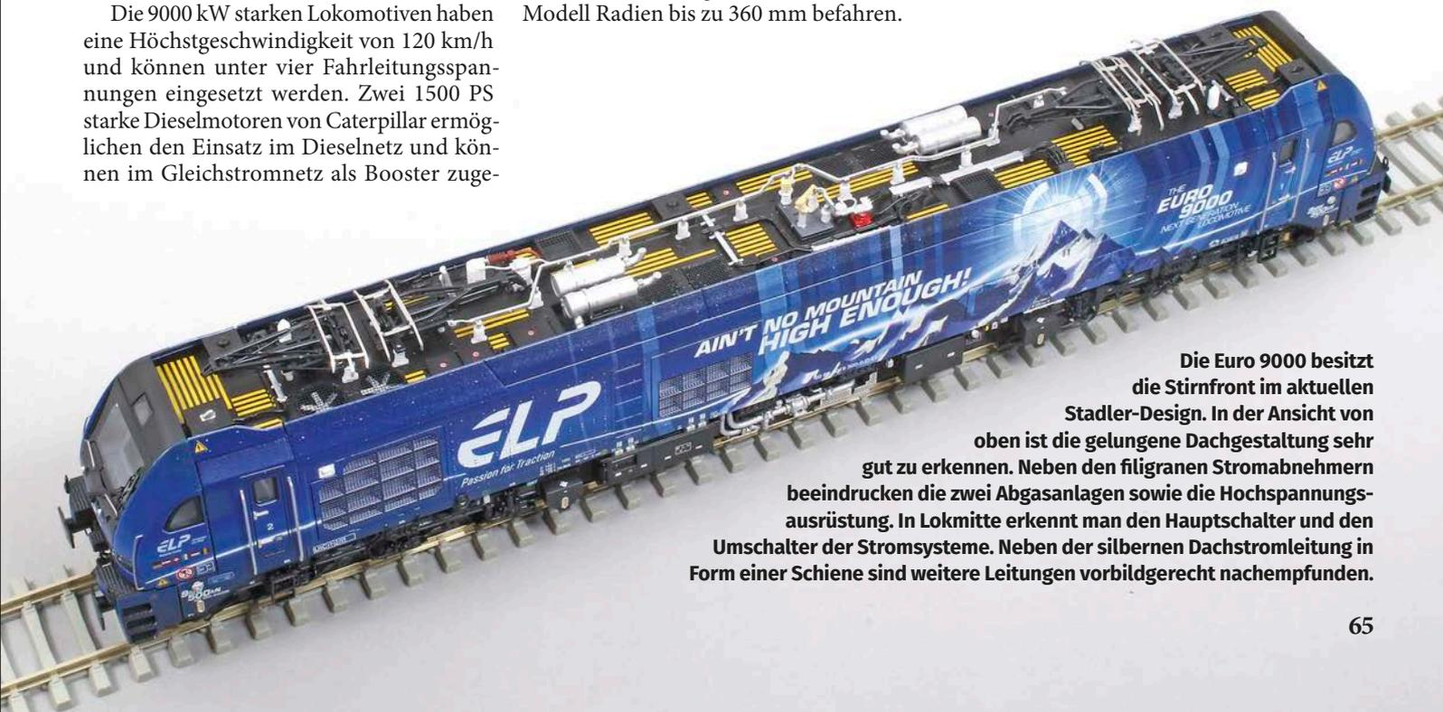
Die Euro 9000 besitzt die Stirnfront im aktuellen Stadler-Design. In der Ansicht von oben ist die gelungene Dachgestaltung sehr gut zu erkennen. Neben den filigranen Stromabnehmern beeindruckt die zwei Abgasanlagen sowie die Hochspannungsausrüstung. In Lokmitte erkennt man den Hauptschalter und den Umschalter der Stromsysteme. Neben der silbernen Dachstromleitung in Form einer Schiene sind weitere Leitungen vorbildgerecht nachempfunden.
