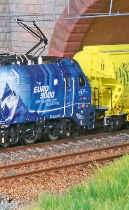
nischen Modellspezialisten. Drehgestelle, Fahrwerk, Formteile und Antrieb der Lok wurden von den bekannten Modellen der Baureihe 159 übernommen.
