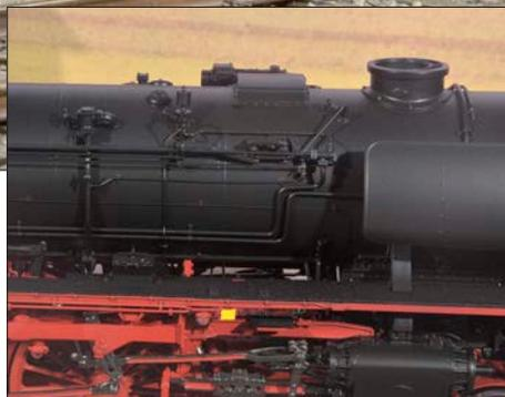
Auf dem Kesselscheitel liegt die flache Erhebung des Heißdampfreglers. Dessen Zugstange mit dem auffälligen Parallelogramm ist ebenfalls minutiös nachgebildet.
