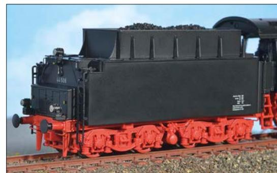
Der Kessel kann nach Lösen von zwei Schrauben vom Fahrwerk abgehoben werden. Zuvor müssen noch Umsteuerstange und Rauchkammertür abgenommen werden. Das Tendergehäuse ist ganz klassisch aufgeklipst.
