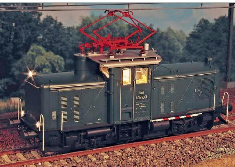
Die digitale Soundversion der 1067 überzeugt durch einen im Modell nicht dröhnenden Sound und einige Lichtfunktionen. Neben dem Spitzen-, Schluss- und Rangierlicht sind auch das Licht im Führerhaus und die imitierten Instrumente des Führerpultes digital schaltbar. Der Blick durch das Führerhaus wird nicht von Antriebsteilen beeinträchtigt.
