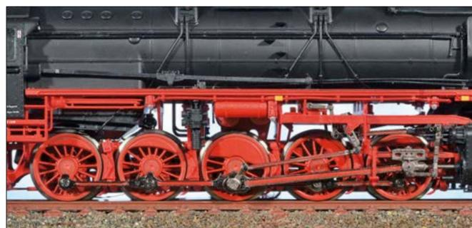
Die Steuerung des Modells besteht bis auf Kreuzkopf, Schwinge und Gegenkurbel aus Metall. Das gilt auch für das vollständig nachgebildete Innentriebwerk. Zwischen den Speichen sind die Durchbrüche des Barrenrahmens zu sehen.
