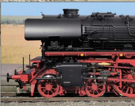
Auf der linken Rauchkammerseite drängen sich Stellstangen, die Leitungen zum und vom Dynamo sowie die Anschlüsse der Speisepumpe.
