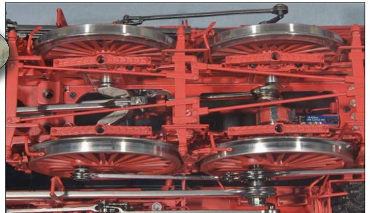
Die erste Kuppelachse ist zugleich die Treibachse, auf die der mittlere Zylinder wirkt. Sie ist vorbildgerecht gekröpft. Die zweite Kuppelachse hat ebenfalls eine kleine Kröpfung für den Antrieb der inneren Steuerung.
