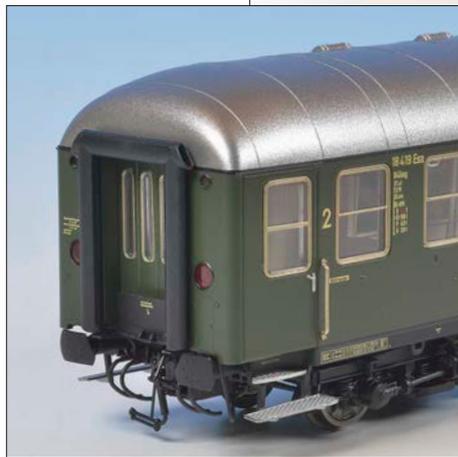
Links: Die Pufferträger können – unter Verzicht auf Modellkupplungen – dem Vorbild noch etwas näher gebracht werden. Hier stehen Bremschläuche, das Kabel einer elektrischen Kupplung und eine Dampfheizung zur Verfügung. (Für Letztere muss das Loch auf 0,7 mm erweitert werden.) Außerdem kann der Kupplungsflansch mit der Imitation einer Schraubekupplung bestückt werden.
