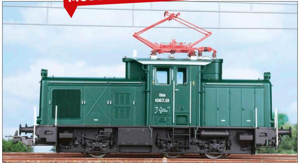
In der Seitenansicht ist der asymmetrische Aufbau der Lok gut zu erkennen. Auch die Radsätze sind im Rahmen nicht gleichmäßig verteilt. Auf der linken Lokseite erkennt man im langen Vorbau das Gitter für den Lufteinlass des Kühlers.
