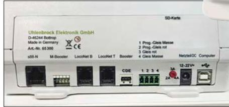
Zahlreiche Anschlüsse erleichtern das Modellbahner-Leben und bieten Möglichkeiten zum Anschluss von Rückmeldern und Handreglern. Neben dem Hauptgleisanschluss ist auch ein Gleis Ausgang für die Decoder-Programmierung vorhanden. Über eine USB-Schnittstelle wird die PC-Welt erschlossen. Eine SD-Karte bietet nahezu unbegrenzte Speichermöglichkeiten für die Lok- und Zubehördatenbank und die Fahrstraßensteuerung.
