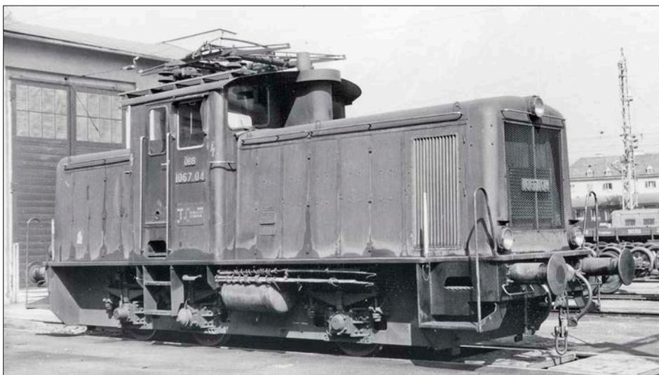
**B**evor verschleißfreie Elektromotoren zum Antrieb von Lokomotiven einsetzbar waren, musste man auf das Prinzip schleifender Kohlenbürsten auf Kollektoren setzen, über die auch ältere Motoren mit Gleich- oder Einphasenwechselstrom betrieben wurden. Unzählige Anwendungen basieren bis heute auf diesem Prinzip. Solange eine gleichbleibende Drehung des Rotors vorhanden ist, funktioniert dieses Prinzip allerdings sehr zuverlässig.
