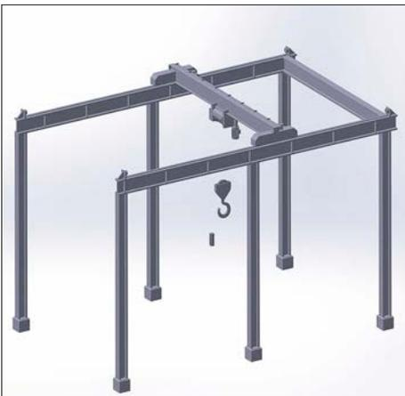
Der Portalkran vor dem Werkstattgebäude ist eine Eigenkreation als 3D-Konstruktion. Mit einem Resindrucker wurden die Teile des Modells hergestellt.
