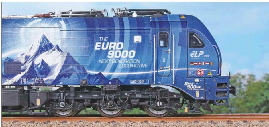
Zwischen Lokkasten und den fein detaillierten Drehgestellrahmen ist ein Durchblick möglich. Die Räder sind mit Bremsscheiben ausgerüstet. An den Lokseiten sind Öffnungen und Schraubverbindungen angraviert, weitere Öffnungen sind mit geätzten Metallgittern verschlossen.
