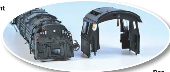
Das Modell ist vorbildgerecht mit zwei Kropfachsen ausgestattet! Die Kropfachse des zweiten Kuppelradsatzes dient dem Antrieb, über die kleine Kröpfung an der dritten Kuppelachse erfolgt die Steuerung des Innenzylinders. (Zur besseren Erkennbarkeit wurde das Bremsgestänge ausgehängt.)
