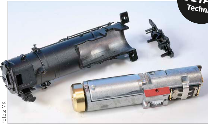
Der schlanke Motor versteckt sich samt Schneckengetriebe im Kessel. Hinten trägt der Motor eine kleine Schwungmasse. Im Bereich des Stehkessels ist der kraftvolle Zuckerwürfel-Lautsprecher zu erkennen.
