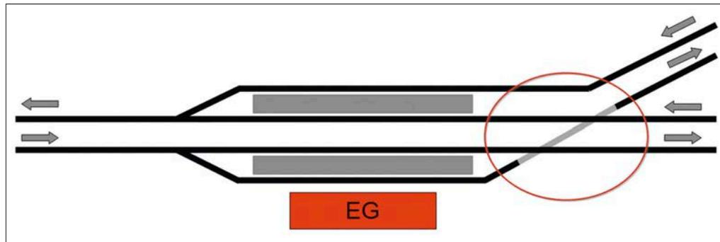
Ein Trennungsbahnhof im Richtungsbetrieb bietet den Reisenden einen erhöhten Komfort beim Wechsel der Züge. Hier liegen die Bahnsteige mittig zwischen den Richtungsgleisen, sodass der Anschlusszug vom gleichen Bahnsteig erreicht werden kann. Um Behinderungen zu vermeiden, erfordern die kreuzenden Gleise im besten Fall ein Kreuzungsbauwerk.
