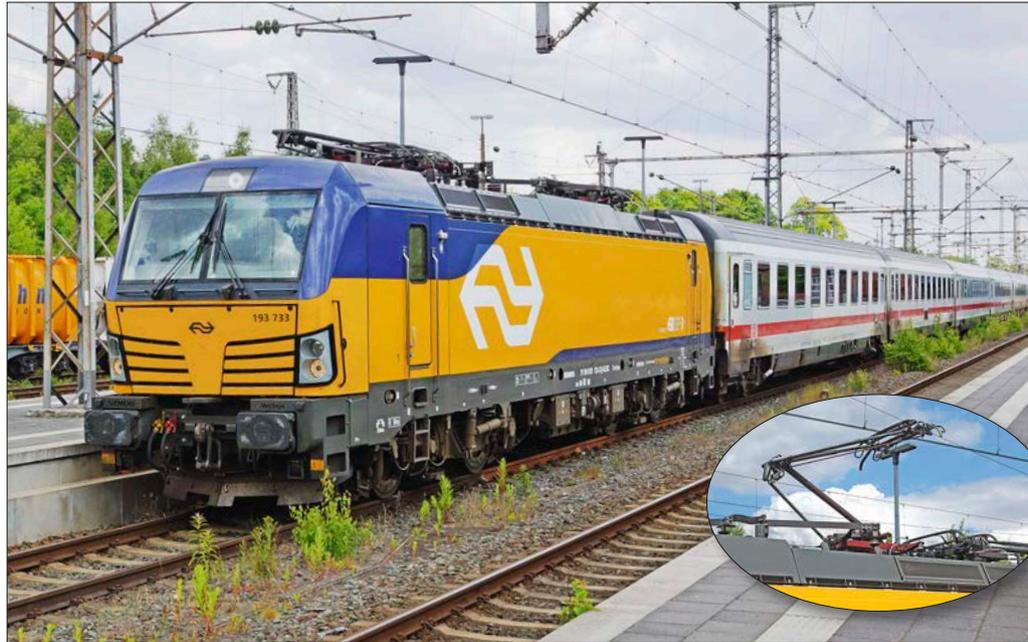
Bei der Einfahrt werden die Pantografen gesenkt und die Loks rollen ohne eigenen Antrieb zum vorgegebenen Halteplatz. Erst nach der Bahnstromumschaltung wird die Fahrt fortgesetzt.
