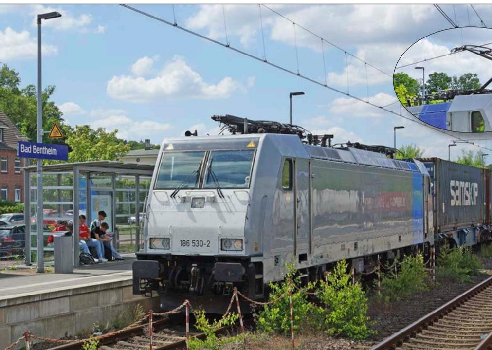
In Bad Bentheim werden die Pantographen vieler Elektroloks bereits während der Einfahrt abgesenkt. Die Lok rollt aus und kommt am vorgesehenen Haltepunkt zum Stehen. Sobald der Fahrstrom umgeschaltet wurde, wird der Pantograph wieder abgehoben und die Fahrt fortgesetzt.
