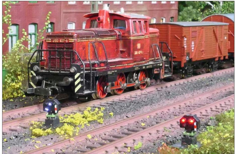
Gleissperrsignale gelten für Zug- und Rangierfahrten und dienen dazu, ein Gleis abzuriegeln, den Auftrag zum Halten zu erteilen oder die Aufhebung eines Fahrverbots anzuzeigen. Die zwei weißen diagonalen Lichter am linken Signal zeigen die Aufhebung des Fahrverbotes an (Sh 1).
