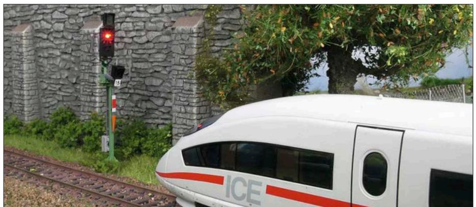
Hp 0 steht für „Halt“. Auch bei den Ks-Signalen wird dieser eindeutige Signalbegriff verwendet. Dass es sich hier um ein Mehrabschnittssignal mit Vorsignalfunktion handelt, erkennt man u.a. an dem nach unten zeigenden Pfeil unterhalb des rot-weißen Mastschildes.
