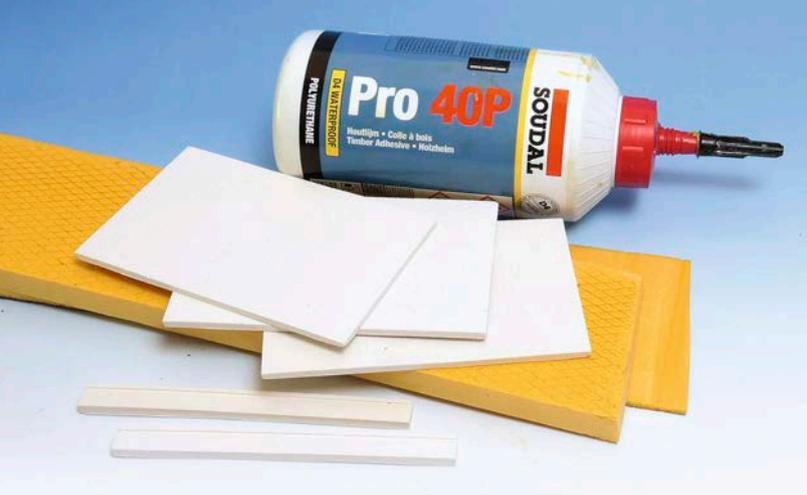
Zum Bau individueller Bahnsteige bieten sich Bahnsteigbeläge und Bahnsteigkanten aus Modellgips oder keramischen Gießmassen an. Eine Unterkonstruktion aus Hartschaum (Styrodur) dient als tragfähige Basis.
