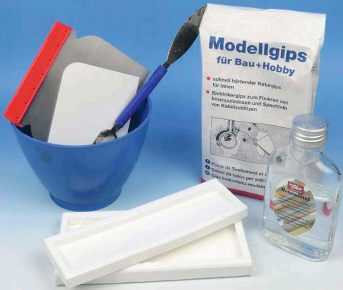
Modellgips ist preiswert und lässt sich einfach verarbeiten. In Verbindung mit Silikonformen lassen sich aus dem Werkstoff fein detaillierte Abgüsse zum Bau von Bahnsteigen, Laderampen und Co. herstellen. Nach dem Bemalen wirken die Abgüsse sehr vorbildnah.
