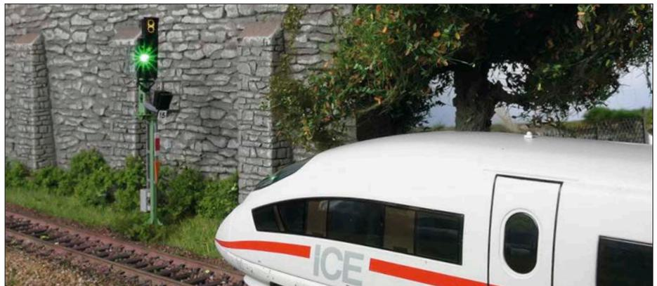
Das Ks-Einfahrtsignal mit Vorsignalfunktion gehört auf die Modelleisenbahn nach dem Vorbild der Epochen V und VI. Die leuchtende Ziffer (Zs 3) gibt die Geschwindigkeit an, die ab dem Signal im anschließenden Weichenbereich nicht überschritten werden darf.
