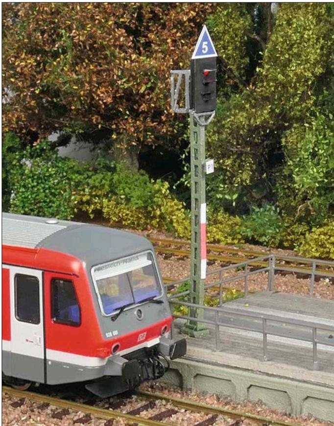
Das Ks-Signal vom Ausweichgleis benötigt zusätzlich den Geschwindigkeitsanzeiger Zs 3 mit der Ziffer „5“ für die reduzierten 50 km/h.
