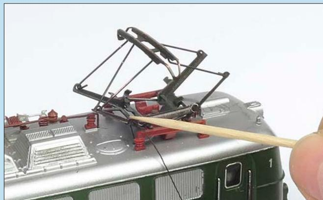
Die mechanische Bewegung des Pantographen erfolgt über einen Stelldraht oder einen kleinen Nylonfaden. Stelldraht oder Faden werden z.B. mit Sekundenkleber am Dachstromabnehmer befestigt.
