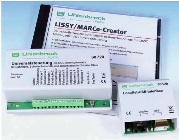
Die Uhlenbrock-Universalsteuerungen lassen sich besonders komfortabel über die hauseigene PC-Software einrichten. Der LISSY/MARCo-Creator muss über einen USB-Port mit dem LocoNet verbunden werden. Falls die Digitalzentrale kein PC-Interface mitbringt, hilft das LocoNet-USB-Interface 63120.
