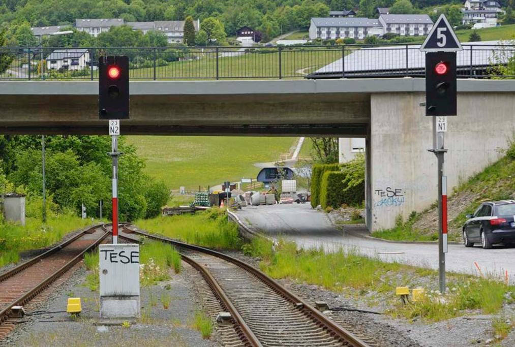
Die beiden Ks-Signale markieren die Ausfahrt im Bahnhof Willingen in Richtung Brilon Wald. Das rechte Signal gehört zum Ausweichgleis 1 und trägt zusätzlich einen Geschwindigkeitsanzeiger, weil die weiter hinten liegende Weiche im Abzweig befahren wird.
