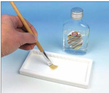
Im ersten Schritt wird die Silikonform am besten mit einem Fließverbesserer ausgepinselt.
