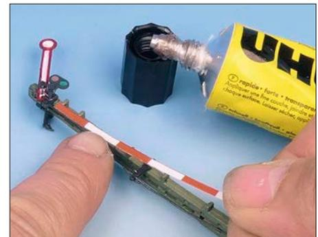
Zu guter Letzt kann das Mastschild mit Alleskleber o.Ä. am Signalmast befestigt werden.
