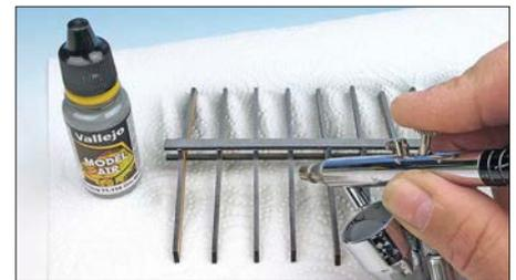
Nachdem der Kleber getrocknet ist, können die montierten Elemente lackiert werden.
