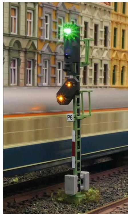
Auch die Kombination mit einem Vorsignal ist bei Ausfahrtsignalen möglich – hier an einem Lichtsignal der Einheitsbauart 1969.
