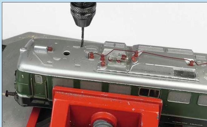
Um den Pantographen einer Lokomotive funktionsfähig zu machen, ist im Dach eine kleine Bohrung für den Stelldraht erforderlich. Dies gelingt am besten in Verbindung mit einer kleinen Mini-Bohrmaschine.
