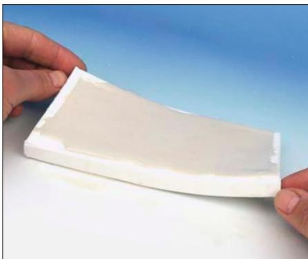
Mit dem Anheben und Zurückschnellen lassen der Ecken werden Luft einschüsse vermieden.
