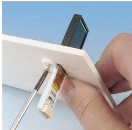
Zur Montage wird in der Grundplatte eine Öffnung von 15 x 5 mm benötigt. Das Display kann danach eingesteckt und befestigt werden.
