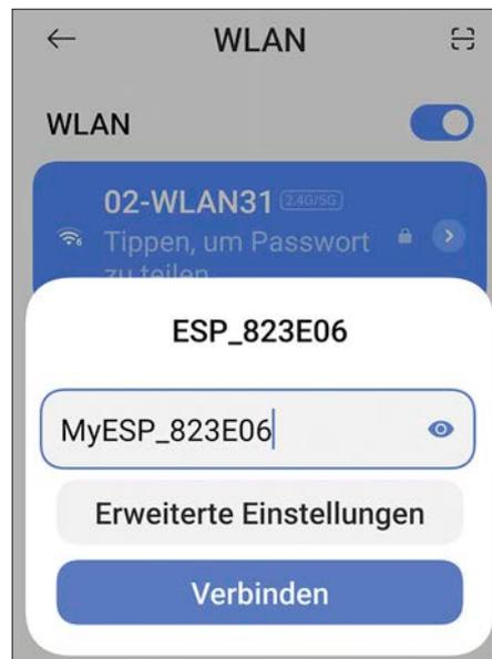
Im Auslieferungszustand spannen die Displays ein eigenes WLAN-Netzwerk auf, mit dem eine Verbindung hergestellt werden muss.
