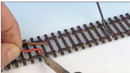
Am besten werden die Kabel für den elektrischen Anschluss verdeckt von unten angelötet.
