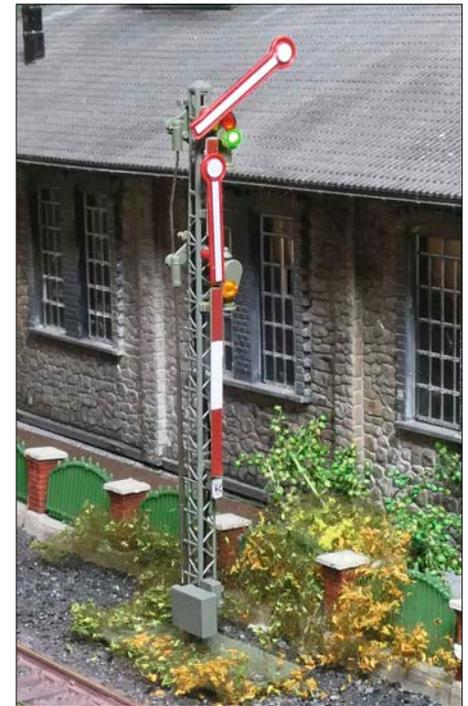
Wenn bei der Einfahrt keine abzweigenden Weichen befahren werden oder keine Geschwindigkeitsbegrenzung gefordert ist, kann das Einfahrtsignal auch Hp 1 „Fahrt“ anzeigen.
