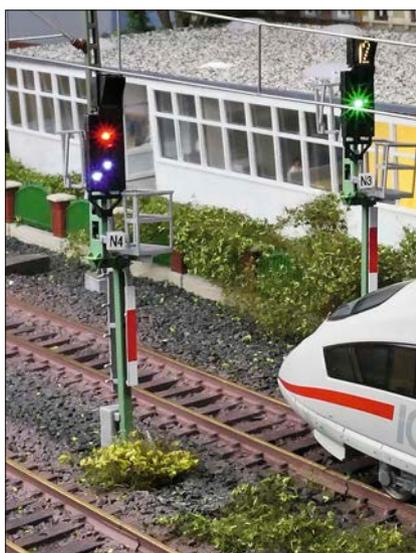
Die Lichtsignale von Viessmann in der Multiplex-Technologie benötigen lediglich vier Anschlusskabel. Was sich hinter dieser Technik verbirgt, wird ab Seite 28 vorgestellt.
