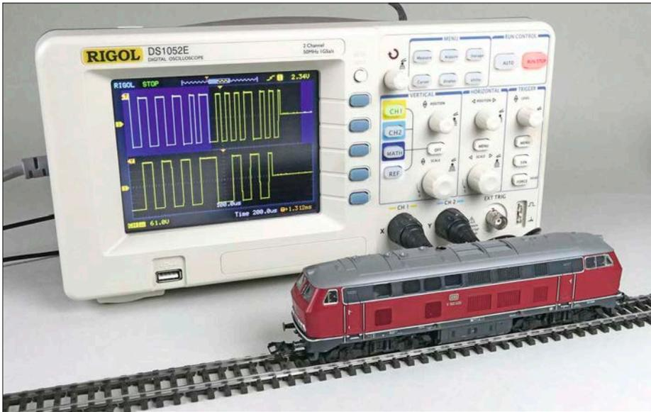
Während bei analogen Anlagen die Zugbeeinflussung durch Abschalten des Fahrstroms erfolgt, bietet sich im Digitalbetrieb eine Veränderung des anliegenden Digitalsignals zum Bremsen an.
