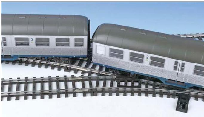
Große Weichenwinkel und kleine Bogenradien wirken im Modell schnell ungläubwüridig. Gerade in Verbindung mit längeren Lokomotiven und Wagen fallen die viel zu eckigen Gleisverbindungen störend ins Auge.
