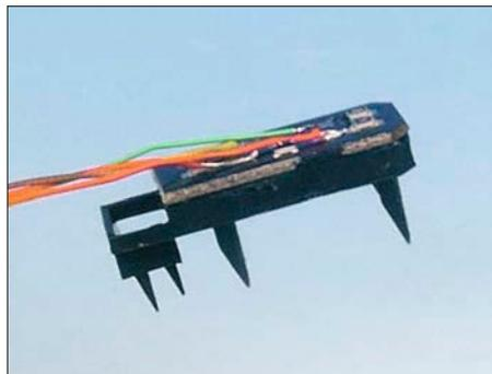
Die verkabelte Platine mit den SMD-LEDs wird auf die Rückseite des Signalschirms geklebt.
