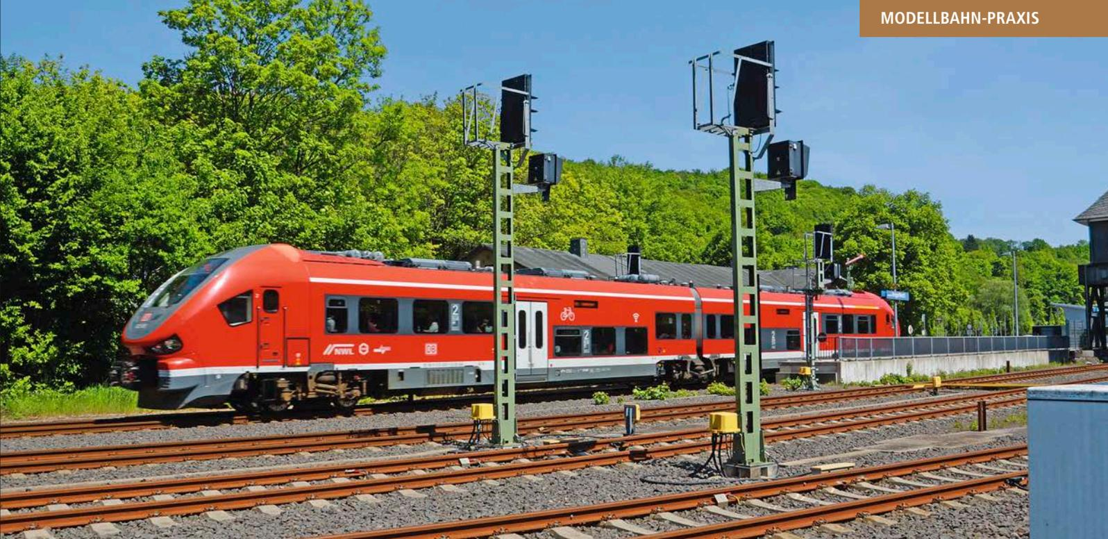
Das Ks-Signalsystem wird seit 1993 bei der damaligen Deutschen Bundesbahn und Deutschen Reichsbahn verwendet. Es kommen Signale zum Einsatz, die Vor- und Hauptsignalfunktion in einem Signalschirm vereinen. Kombinationssignale werden von Andreas Herzog als Bausatz angeboten.
