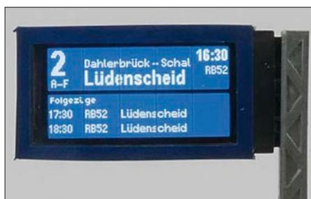
Die Zugzielanzeiger sind in der Lage, die Daten vieler Bahnhöfe innerhalb Deutschlands in Echtzeit anzuzeigen. Im Rahmen der Konfiguration werden die Identifikationsnummer des Bahnhofs sowie das gewünschte Gleis benötigt. Die aktuellen Daten sind der Bedienungsanleitung der Zugzielanzeiger zu entnehmen.
