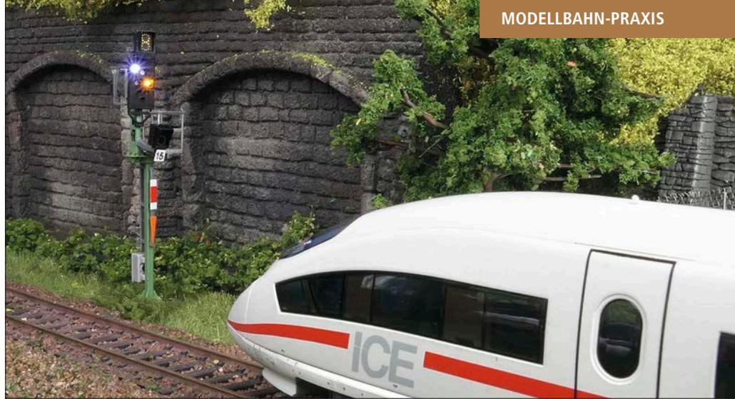
Das Ks-Signal in Multiplex-Technologie passt zu modernen Modellbahnen ab den 1990er-Jahren. Der nach unten gerichtete Pfeil am Mast weist auf die zusätzliche Vorsignalfunktion hin.
