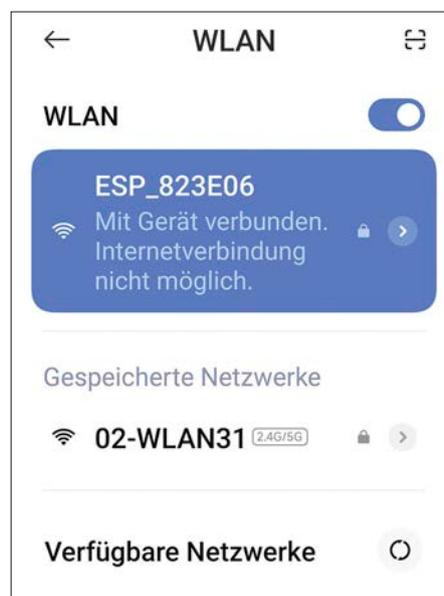
Das Mobilgerät, das für die Konfiguration benutzt werden soll, wird im zweiten Schritt mit dem neuen WLAN des Displays verbunden.
