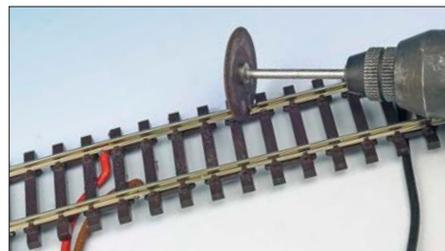
Die Isolierungen für die Pendelstrecke gelingen mit Kleinbohrmaschine und Trennscheibe.
