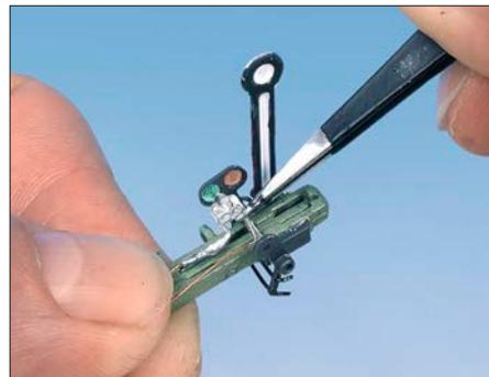
Das Ankleben der LEDs und die Montage der Antriebsmechanik sind durchaus knifflig.
