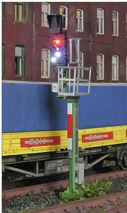
Bei den Licht-Ausfahrtsignalen sind die Signalbilder für den Rangierbetrieb im Signalschirm untergebracht. Das Ks-Signal zeigt Hp 0 / Sh 1.
