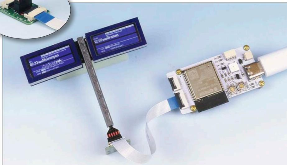
Die Story geht weiter: Hier ein Prototyp mit neuem Controller und abgesetztem Display über Flachbandkabel – dank noch höherer Auflösung sind damit auch Wagenstandsanzeigen möglich.
