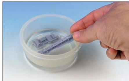
Vor dem Entfernen der Stützstrukturen sollten die Teile in warmes Wasser gelegt werden.
