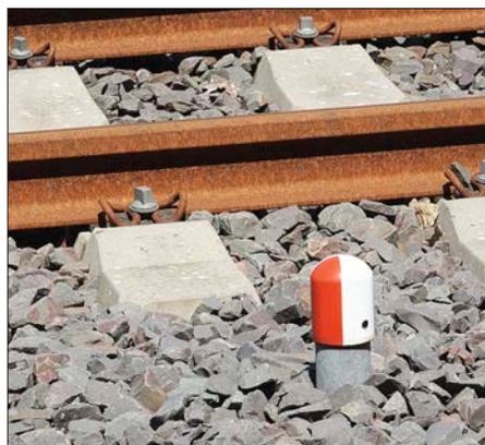
Grenzzeichen Ra12 bzw. So12 sorgen bei zusammenlaufenden Gleisen für die Sicherheit.
