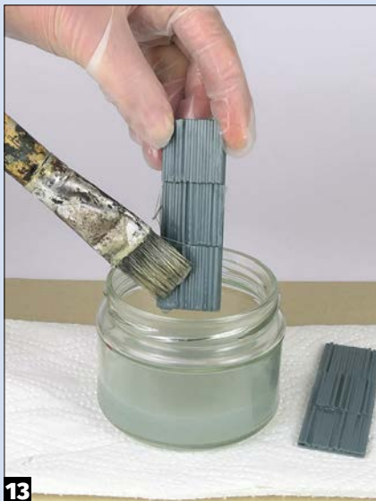
13 Nach dem Druckvorgang müssen die Holzladungen vom restlichen Resin befreit werden.
