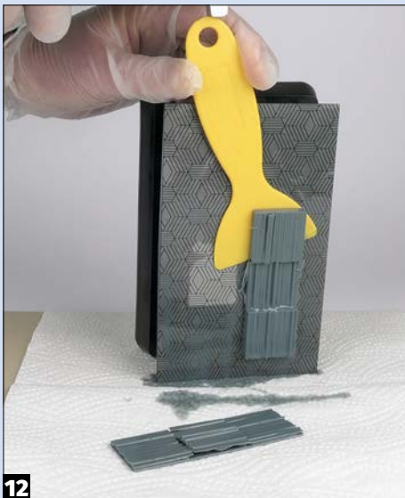
12 Um die gedruckten Ladungen von der Bauplatte zu entfernen ist ein Spachtel oder ein ähnliches Werkzeug hilfreich.
