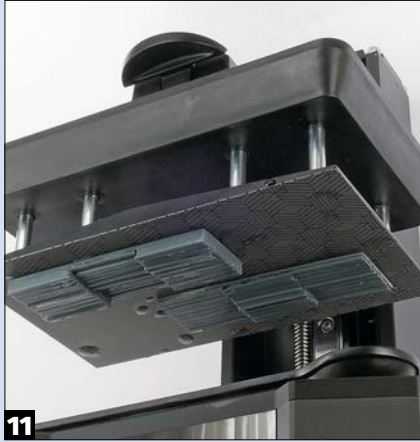
11 Die Bauplatte taucht für jede Schicht immer wieder in den Resintank ein. Auf diese Weise entstehen kopfüber nach und nach die Ladeguteinsätze.
