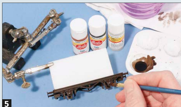
5 Am Wagenrahmen wurde eine Mischung aus „Dark Rust“ und „Engine Black“ auf Rahmen und Fahrgestell aufgetupft. Mit dem Verdünner aus der Solution Box verliert der Farbton seine volle Deckkraft.
