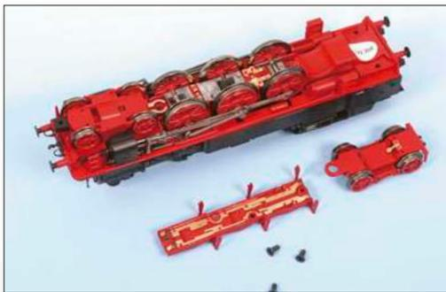
Links: Die Laufdrehgestelle sind an der Innenseite drehbar gelagert. Angetrieben ist der mittlere Kuppelradsatz. Die beiden äußeren Kuppelradsätze werden durch die Kuppelstangen mitgenommen. Die Stromabnahme erfolgt von der Oberseite der Radreifen der Kuppelradsätze. Die inneren Laufradsätze dienen ebenfalls der Stromabnahme.
