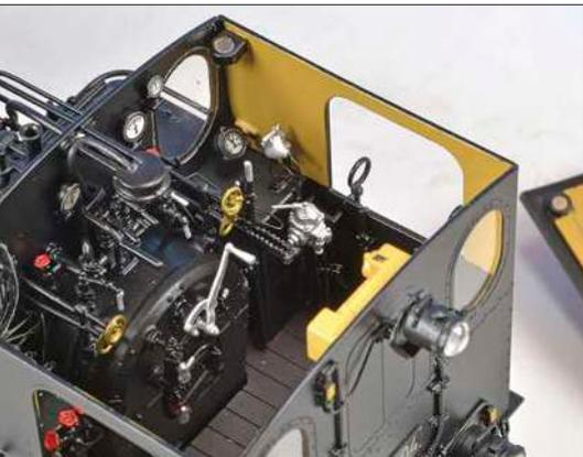
Das Dach wird von Magneten gehalten und lässt sich abheben. Regler, Umsteuerung, etliche Handräder, die bedruckten Manometer sowie der Tacho in der Führerhausercke und die Bremshebel – nichts fehlt!
