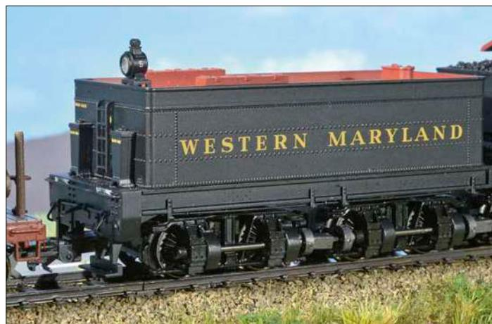
Bei welcher Lok findet man schon einen angetriebenen Tender? Die spezielle Technik gestattet es dem Modellkonstrukteur, trotz der Antriebstechnik im Tendergehäuse wie gewohnt die Hauptplatine mit der Decoderschnittstelle und einen Lautsprecher unterzubringen. Löcher im Tenderboden lassen den Schall austreten.
