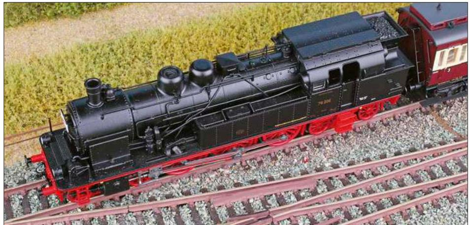
Oben: In der Ansicht von oben ist der Kessel mit fein gravierten Nietreihen, der Leitungsführung und der im Vergleich zum Langkessel breiteren Rauchkammer gut zu erkennen. Die Griffstangen auf den Wasserkästen sind freistehend. Rechts: Das Führerhaus der 78 206 entspricht der Bauserie mit Dachlüfteraufsatz. Auch hier gleichen die winzigen Nieten und die Griffstangen dem Vorbild. Der Kohlenkastenaufsatz ist formrichtig nachempfunden. Die Laternen sind freistehend.
