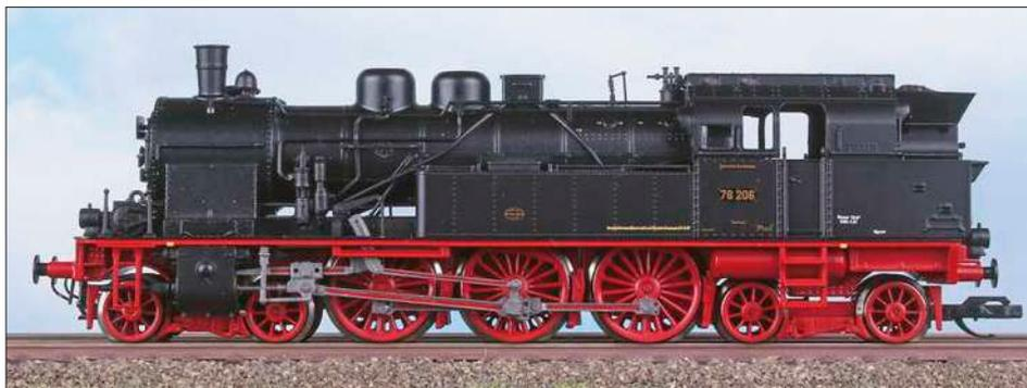
In der Seitenansicht ist die symmetrische Aufteilung des Fahrwerkes besonders gut zu erkennen. Die äußeren Radsätze reichen mit den Schienenräumern bis fast unter die Rahmenendplatten, was den Bewegungsfreiraum nach oben stark einschränkt.
