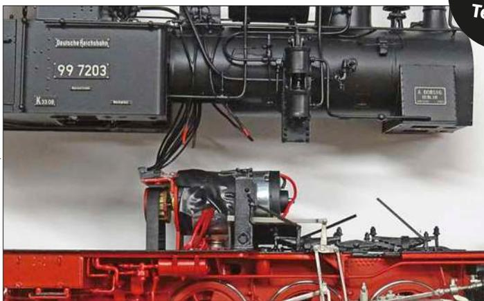
**Der Antrieb läuft angenehm leise über einen kleinen Zahnriemen. Dieser arbeitet auf die im Getriebeblock gelagerte Schneckenwelle.**
