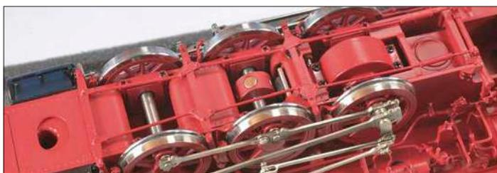
Beim Rahmen sind die Wasserkasten-Mulden ebenfalls nachgebildet. Getriebe und die Achsmanschette für Magneten belegen die Achsen B und C.
