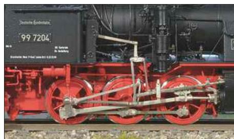
Links: Die Steuerung ist aus Neusilber gefertigt. Sämtliche Gelenke, die Gabeln an der Schwingen und am Schieber sowie die winzigen Schmiergefäße wurden minutiös nachgebildet. Die Kuppelstangen sind vorbildgerecht über ein Gelenk geteilt. Die Exzenter geben im Betrieb ein besonders interessantes Bild ab.
