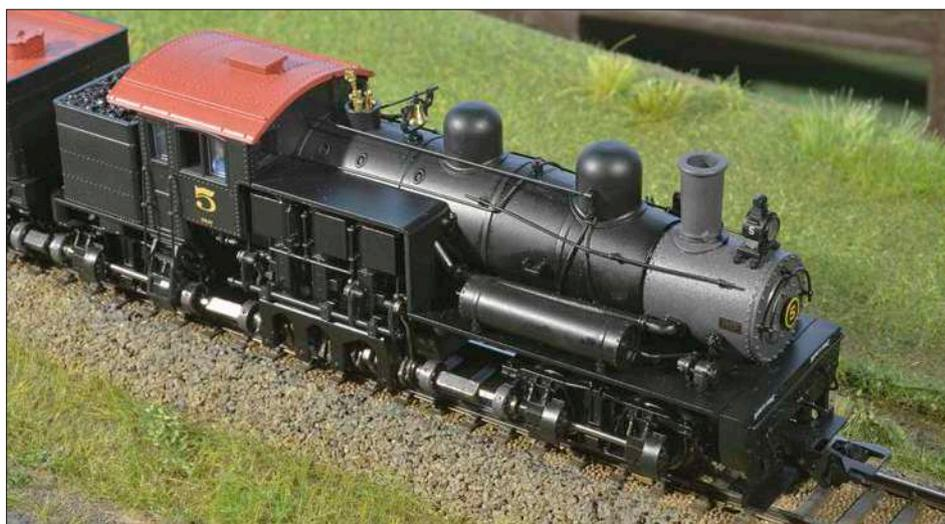
Aus leicht erhöhter Perspektive sind die Leitungen und Griffstangen am Kessel gut zu erkennen. Insbesondere die dicke Dampfleitung hinter dem Luftkessel fällt auf.
