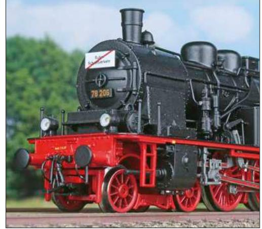
Durch die Seitenverschiebbarkeit des mittleren Kuppelradsatzes von etwa einem Millimeter und der äußeren von 0,5 Millimeter bezwingt die TT-78 auch Mindestradien von 310 Millimeter und enge Weichen-
