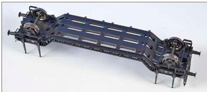
Links: Vorbildgerecht ist nur eine der beiden Achsen gebremst; und zwar über die Handbremse. Eine durchgehende Druckluftleitung ist aber richtigerweise dennoch montiert.
