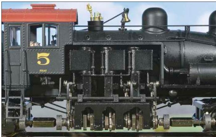
Die Kurbelwelle ist dreifach gekröpft und vierfach gelagert. Sie wird flankiert von Exzentrern, die beim Vorbild über Hubscheiben die Steuerung der Dampfzylinder übernehmen.
