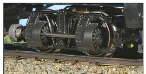
Ein Antriebsdrehgestell von allen Seiten. Von schräg vorn erkennt man die Kegelzahnrad auf der Antriebswelle besonders gut. Unten eines der Drehgestelle von der anderen Seite; hier ist die spezielle Form der Speichen zu erwähnen.
