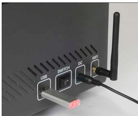
Die Druckdaten werden am besten per USB-Stick übertragen. WLAN ist aber auch an Bord.
