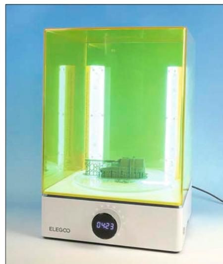
Frische Druckteile aus Resin sind sehr empfindlich und müssen nachgehärtet werden.
