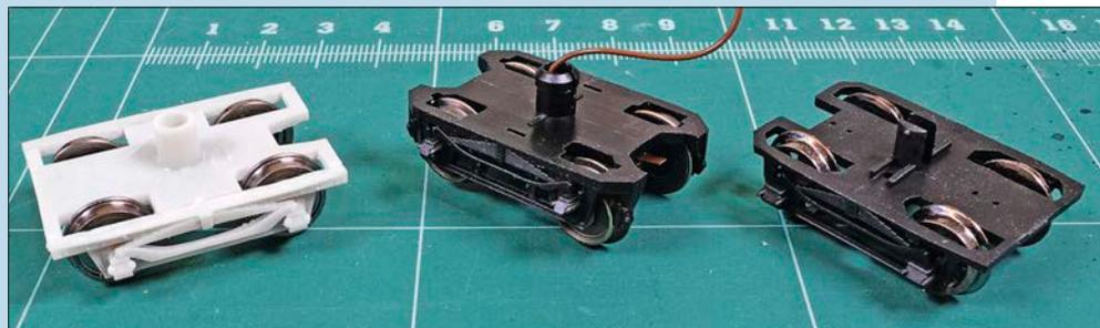
Langenschwalbacher Drehgestelle im Vergleich – links der Eigenbau, in der Mitte das Drehgestell von Märklin und rechts dasjenige von Liliput.
