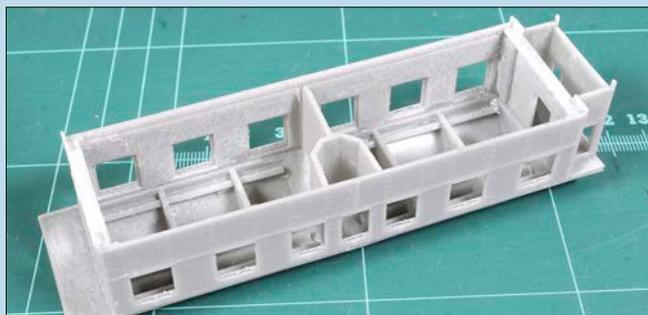
ter, die eine Stärke von gerade einmal 0,2 mm aufweisen. Die hier auf der Rückseite ansetzenden Stützen habe ich gleich nach dem Drucken noch vor dem Aushärten mit einem kleinen watefreien Seitenschneider gekappt. Versucht man dies nach dem Aushärten, geht der feine Lüfter unweigerlich zu Bruch.
