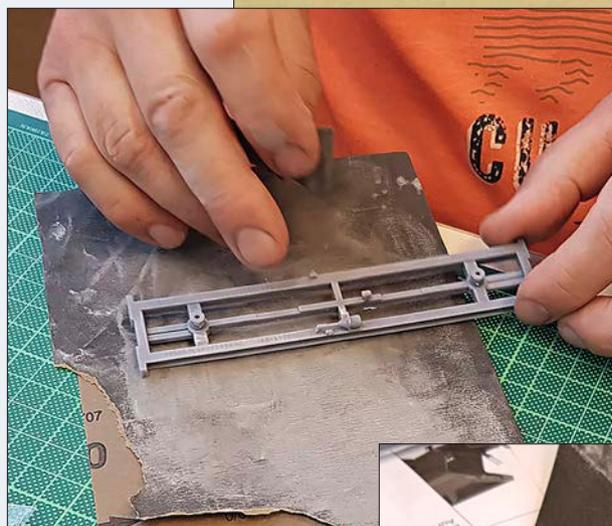
Links und unten: Wenn alle Teile von ihren Stützstrukturen befreit wurden, müssen die einzelnen Flächen plan geschliffen werden. Insbesondere die Stützen hinterlassen dort, wo die Verbindung zum Druckobjekt war, ihre Spuren, die ...
