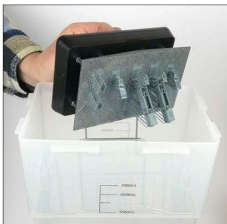
Um die Resinreste zu entfernen wandern die Druckteile am besten in eine Waschstation.
