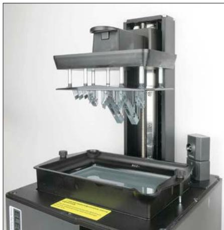
Nach dem Ende des Druckprozesses wird die Bauplatte selbstständig nach oben gefahren.
