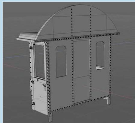
Die Konstruktion der geschlossenen Bühne ist weitgehend abgeschlossen. Auf den ersten Blick mögen manche Details etwas grob erscheinen, dennoch sind sie nach dem Drucken kaum noch zu sehen. So sollten beispielsweise die Deckleisten mindestens 0,15 mm dick sein – sind sie dünner, würden sie sich kaum von der Wandfläche abheben. Die Niete sollten mindestens einen Durchmesser von 0,3 mm aufweisen, damit sie nach dem Lackieren gut sichtbar sind.
