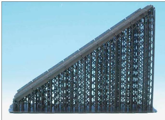
Das hätte eigentlich ein Musterbeispiel werden sollen, wie krumm so ein Modell nach dem Druck sein kann. Frisch aus dem Drucker war es völlig verbogen, bis zum Fototermin hatte es sich aber perfekt gerade gerichtet – ein Beispiel, dass der Zeitpunkt zum Lösen der Stützstruktur auch versuchsweise zu ermitteln ist.
