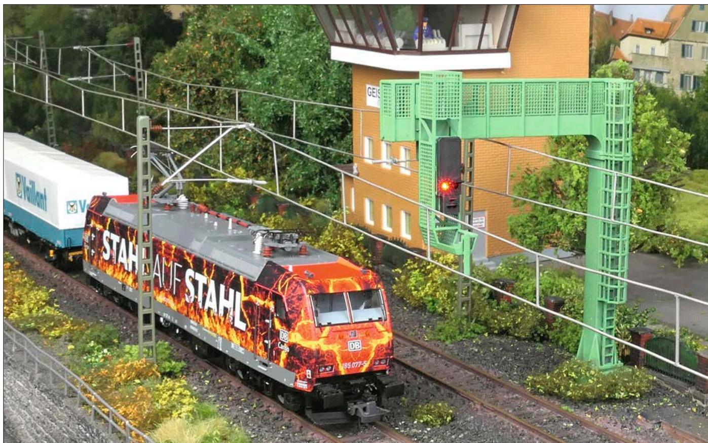
In einer vorbildnahen Modellbahnlandschaft macht die Signalbrücke eine richtig gute Figur. Kaum zu glauben, dass sie in Verbindung mit einem 3D-Resindruker selbst hergestellt wurde. Und dank der kleinen SMD-LED ist auch für eine vorbildgetreue Funktion gesorgt. *Fotos: Susanne Möritz*
