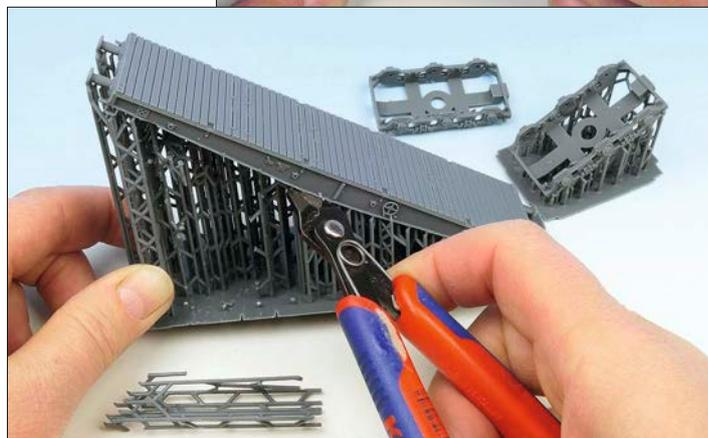
Beim Resin-Druck müssen die fertigen Druckerzeugnisse zunächst gereinigt und von den Stützstrukturen befreit werden. Dieses gelingt im ungehärteten Zustand gut mit dem Seitenschneider. *Fotos: Susanne Möritz*
