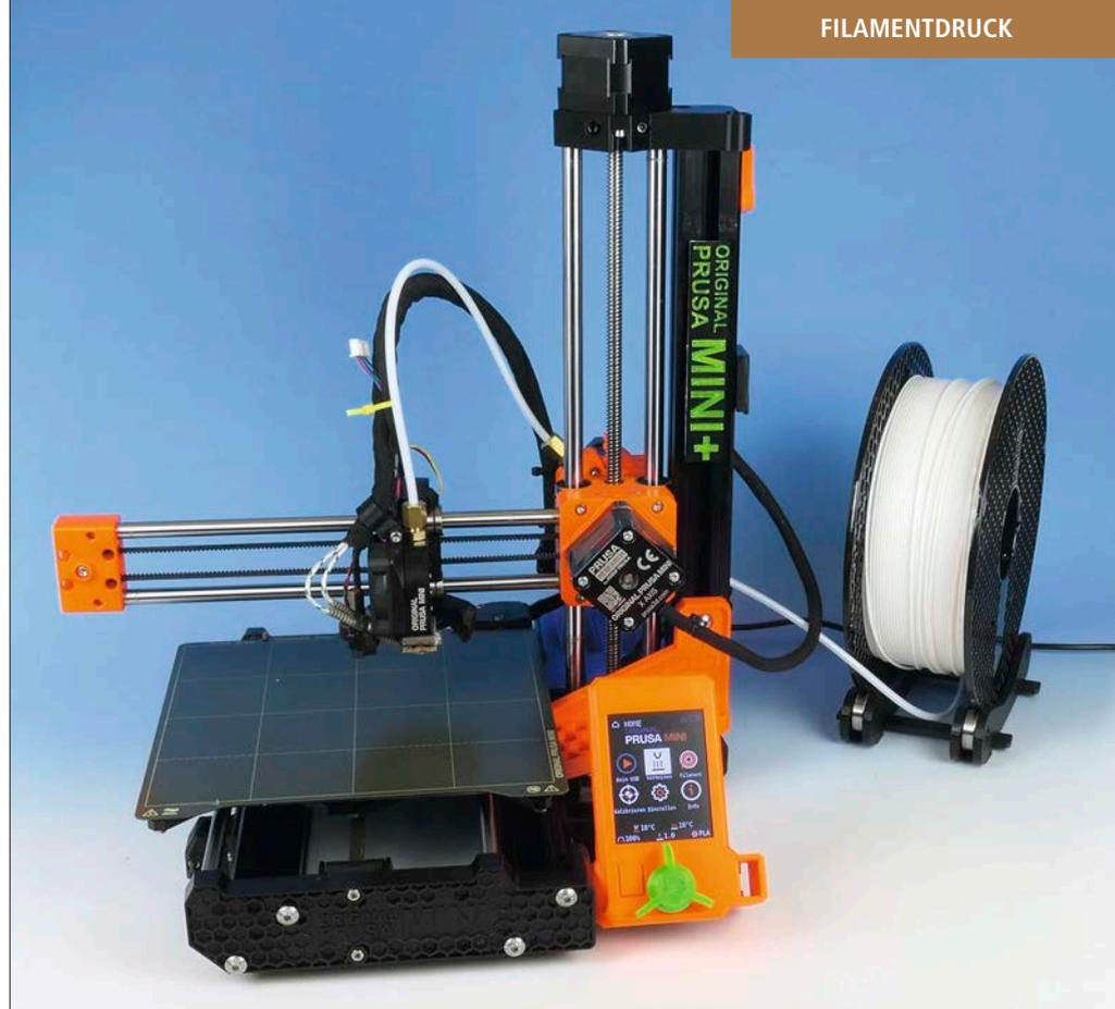
Der MINI+ aus dem Hause Prusa ist ein kleiner Filamentdrucker mit einem nutzbaren Bauraum von 18 x 18 x 18 cm. Der Drucker kann teilmontiert oder als Komplettbausatz bezogen werden und macht in der Praxis eine Menge Freude. Die Bauplatte ist magnetisch und abnehmbar.
