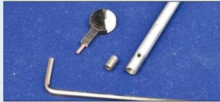
Die 6-mm-Welle ist ein Rohr mit 1 mm Wandstärke. Hier lässt sich ein M5-Gewinde für eine Madenschraube schneiden, die den Stellhebel in einem 2-mm-Querloch klemmt.
