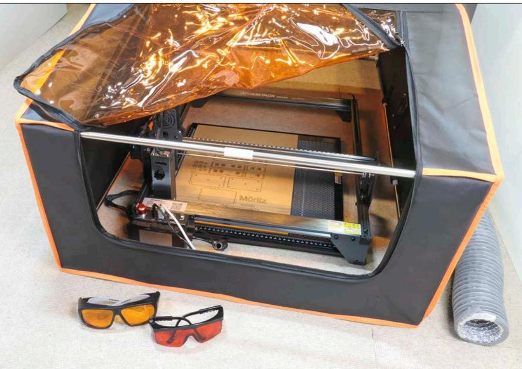
Bei aller Begeisterung muss die Sicherheit stets die höchste Priorität haben. Beim Umgang mit einem Laser ist eine geeignete Schutzbrille Pflicht! Noch besser ist es, wenn die Geräte in einem geschlossenen und feuerfesten Gehäuse mit einem integrierten Luftabzug untergebracht sind.
