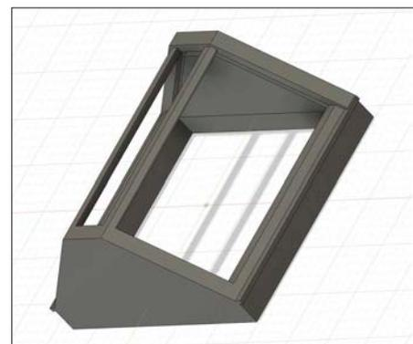
So sehen die Zubehörteile aus. Die Lampe wird mit ihrem Sockel in die Aussparung im Wagenkasten eingesetzt, das Fenster bekommt Scheiben aus Kunststoffolie und passt genau in einen Fensterausschnitt hinein. Gut zu sehen sind die Aufnahmen für die Fensterfolien.
