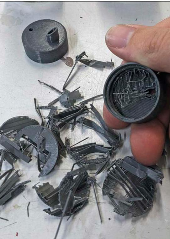
Links Bedingt durch den großen Hohlraum im Innern des Ausgießers war beim Druck eine Stützkonstruktion erforderlich, damit der obere Teil sauber gedruckt werden konnte. Die Stützen lassen sich aber mit etwas Kraft und einer flachen Zange herausziehen und hinterlassen keine Spuren am Gewinde im Innern.
