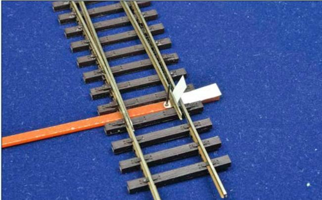
Die Weiche wird nun auf den Pertinaxstreifen gelegt. Der Papierstreifen wird zwischen Backenschiene und Gelenkblech gelegt, das Gelenkblech von der Graphitmine auf dem Pertinaxstreifen gehalten.
