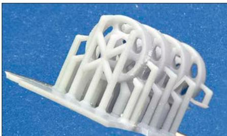
Ein Modellbau-Kollege hatte Probleme mit einem gedruckten Modell, dessen Details kleiner als die angesetzte Stützstruktur waren. Keines der Bauteile ließ sich unbeschadet entgittern. Die Lösung bestand in der Anschaffung eines Ultraschall-Schneidegeräts. Der einzige echte Nachteil ist dessen Preis: Wer die knapp € 400,- ausgeben kann, ist damit aber gut bedient.
