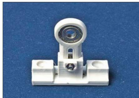
Das Stützlager für die Antriebswelle. Es ist zum Einstellen des Zahnflankenspiels über ein einfaches Langloch und eine geschraubte Klemmhalterung in der Höhe einstellbar.
