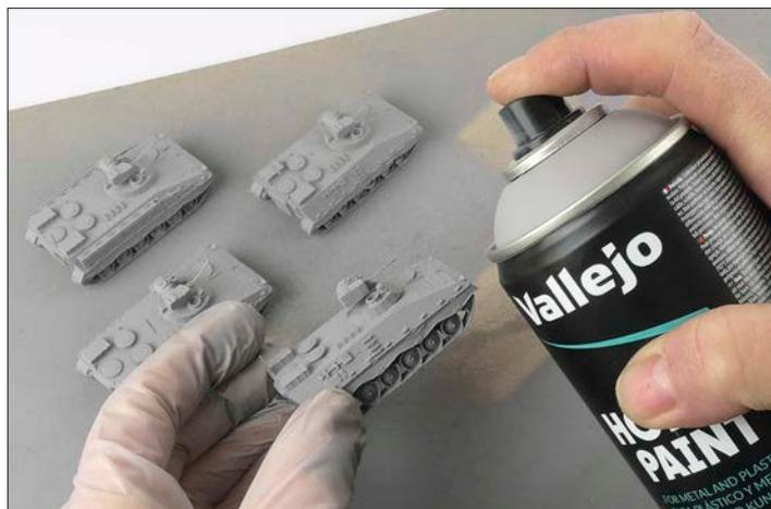
Bevor die gedruckten und gereinigten Resinmodelle ihren Originalfarbton erhalten, sollten sie grundiert werden. Dies kann mit Grundierungen aus der Spraydose oder mit einer handelsüblichen Airbrushpistole erfolgen.
