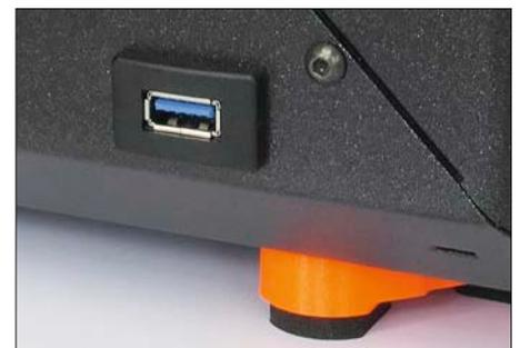
Der USB-Stick zur Übertragung der Daten kann auch außen am Gehäuse eingesteckt werden.
