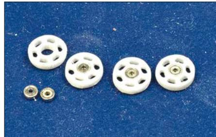
In jedem Stützrad werden zwei winzige Miniatur-Kugellager verbaut. Deren Größe liegt bei nur 1 x 3 x 1 mm.
