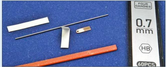
Zum Anlöten der Gelenke benötigt man einen Pertinaxstreifen als Halterung, eine 0,7-mm-Graphitmine, die verhindert, dass das Loch mit Lot zuläuft, und zwei Papierstreifen. Die Papierstreifen werden noch mit einem 0,8-mm-Loch versehen.
