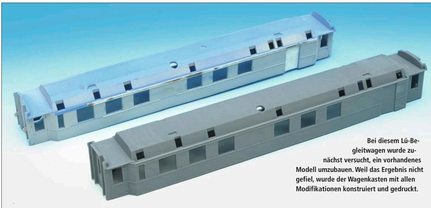
Bei diesem Lü-Begleitwagen wurde zunächst versucht, ein vorhandenes Modell umzubauen. Weil das Ergebnis nicht gefiel, wurde der Wagenkasten mit allen Modifikationen konstruiert und gedruckt.
