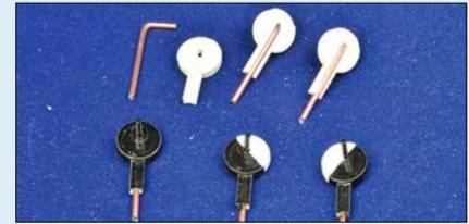
Herstellung der Weichenhebel, von links oben gebogener 2-mm-Draht und Hebel aus Druckteil, daneben eingedrückter Draht und eingeklebter Draht, darunter schwarz lackiert und mit weißer Markierung für die Grundstellung. Bei beidseitiger Bedienung braucht man immer eine „rechte“ und eine „linke“ Variante.
