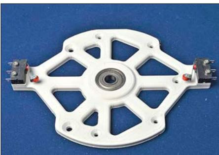
Die Halteplatte mit den beiden Springkontakten zum Umpolen der Fahrspannung beim Drehen und das 6-mm-Hauptlager für die Antriebswelle.
