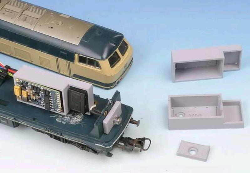
Wer ältere analoge Modelle digitalisieren möchte, kann sich mithilfe eines 3D-Druckers schnell und einfach die passenden Montagehalterungen für den Digitaldecoder oder die neue LED-Beleuchtung konstruieren und drucken.
