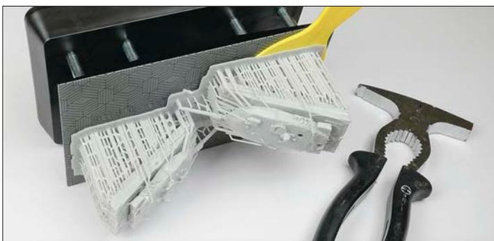
Nach der Reinigung müssen die gedruckten Elemente noch von der Bauplatte entfernt werden. Hierbei haben sich ein Spachtel und ein leichtes Schlagwerkzeug als Hilfsmittel bewährt.
