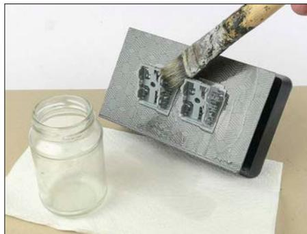
Bei kleineren Teilen reicht auch schon einmal ein Pinsel mit Isopropanol zur Säuberung.
