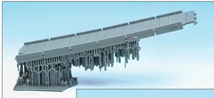
Die Ursache dieses Problems liegt vermutlich im zu flachen Winkel bei der Slicer-Positionierung.
