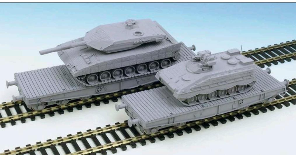
Mit den aktuellen MSLA-Druckern lassen sich erstaunliche 3D-Druckergebnisse erzielen. Die Schwerlast-Flachwagen und die Panzer der Bundeswehr entstanden quasi in einem Stück.
