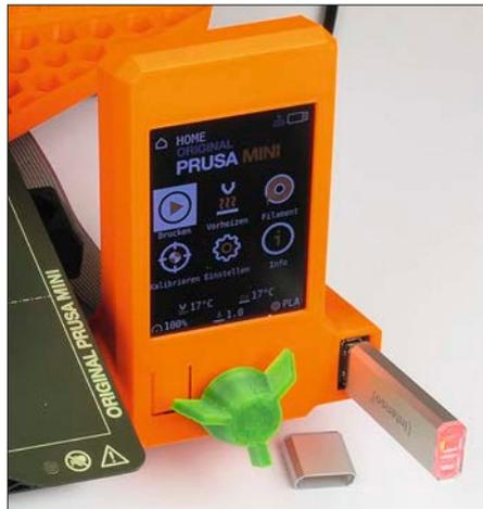
Der 3D-Drucker wird über ein Farbdisplay gesteuert. Die Druckdaten liefert ein USB-Stick.
