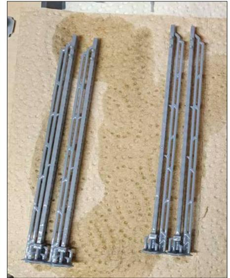
Nach dem Entfernen der Masten von der Druckplatte wurden sie mit Isopropanol gereinigt. Man erkennt jetzt deutlich die Kontur und die Hilfsstützen für den Druck.
