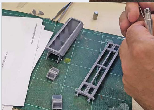
... müssen die Löcher für die Zurrüsteile auf das richtige Maß aufgeweitet werden. Hierfür eignen sich kleine Bohrer, welche man in einen Handbohrer einspannt, oder aber feine Reibahlen.
