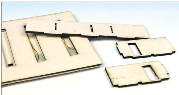
Durchgefärbter Fotokarton bzw. Tonpapier lässt sich wunderbar mit dem Laser schneiden und gravieren. Die vom Laser erfassten Stellen werden bei dunklen Grundfarbtönen aufgehellt.
