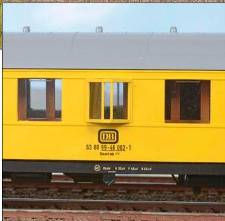
Oben: Die detailgetreuen und filigranen Lampen wurden separat eingesetzt. Nur so ließen sie sich komplett unbeschädigt drucken, aus der Stützstruktur lösen und am vorbereiteten Modell anbringen.
