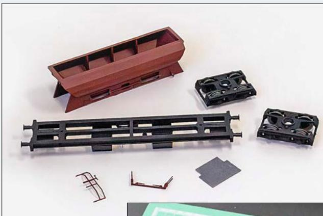
Links: Verschiedene Teile oder zusammengebaute Gruppen werden vor dem weiteren Zusammenbau lackiert, damit erspart man sich eine Menge an lästigen Abklebearbeiten.
