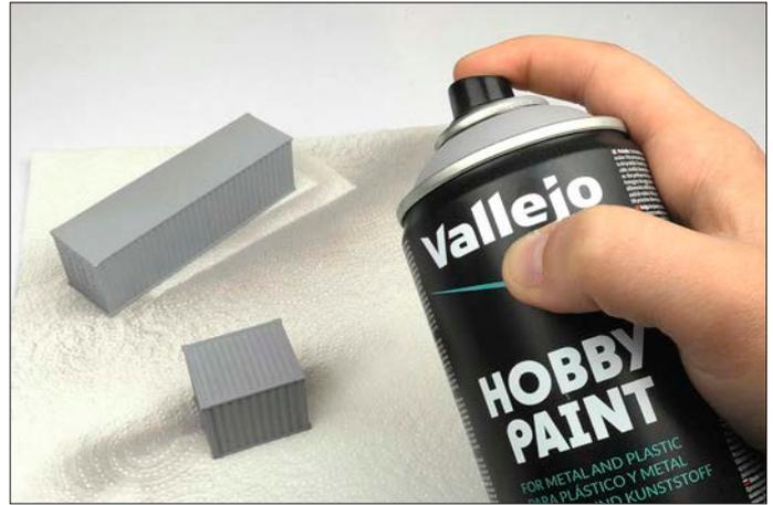
Gedruckte Teile aus dem 3D-Drucker sollten vor der Lackierung unbedingt grundiert werden. Gute Erfahrungen habe ich mit der hellgrauen Grundierung von Vallejo aus der Spraydose gemacht.
