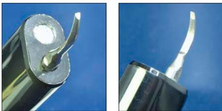
Hier wird nun an der Ober- und Unterseite der Klinge mit einer Schleifscheibe etwas Material abgeschliffen, eine Art Meißel entsteht. Der Winkel beträgt etwa 40°.
