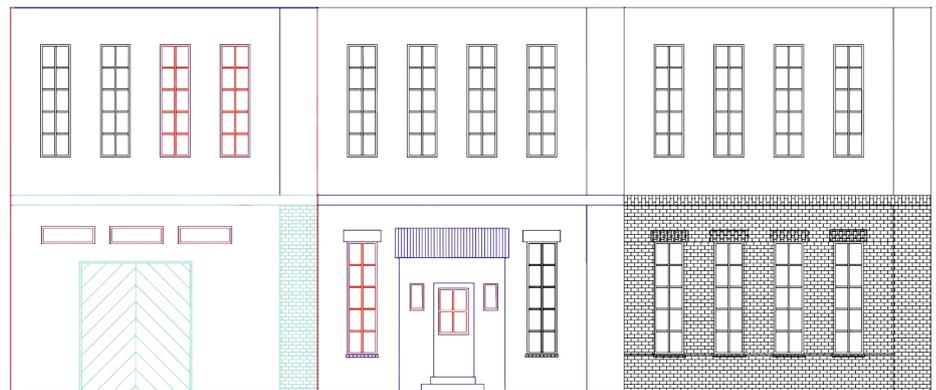
Man kann die Konstruktionszeichnungen aber auch mit einem einfachen Zeichenprogramm wie Paint oder dem etwas anspruchsvolleren CorelDraw erstellen. Man muss nur gerade Linien zeichnen, Überschneidungen entfernen und Linien einfärben können. Hier wurden alle Elemente erst einmal gezeichnet (schwarz) und dann für den Laser umgefärbt: rot für Schneiden, blau und türkis für unterschiedliche Gravuren.
