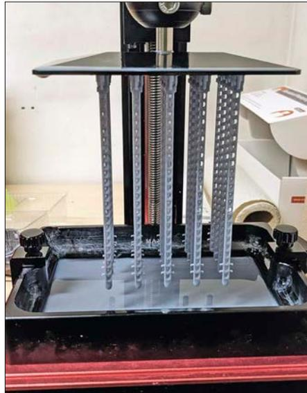
Nach gut zwölf Stunden ist der Druck der Masten abgeschlossen. Sie hängen hier noch kopfüber an der Druckplatte, damit das flüssige Resin abtropfen kann.
