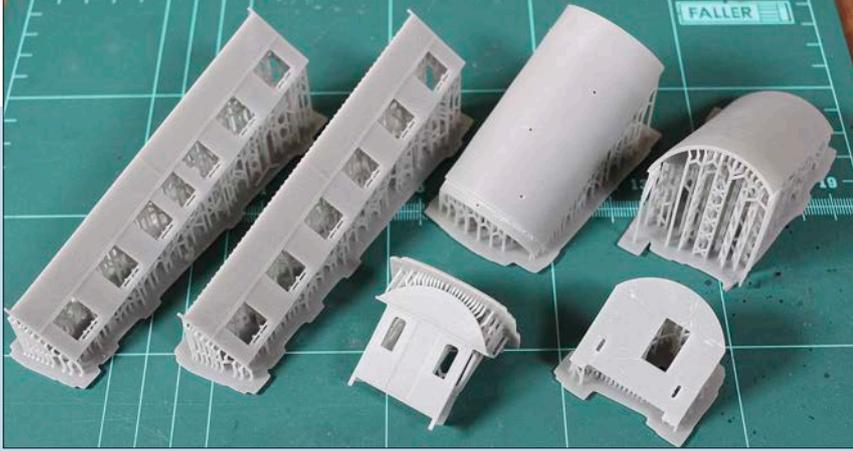
Von der Theorie zur Praxis – so kamen die ersten brauchbaren Teile für den Wagenkasten aus dem Drucker. Das Dach ist hier noch zweiteilig ausgeführt – es wird in der endgültigen Version wieder aus einem Stück bestehen. Gut zu erkennen ist auch die dichte Stützstruktur, sie ist erforderlich, damit sich die Bauteile sowohl beim Drucken als auch beim anschließenden Aushärten möglichst wenig verziehen.
