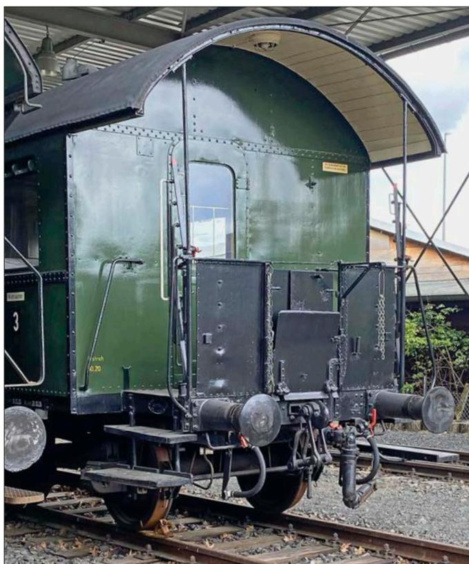
Links: Die offene Bühne des Langenschwalbachers beim „Hessencourrier“. Bei der Modellumsetzung sind noch einige Frage offen – so wird es zwischen Drehgestell und Trittbrettern doch recht eng. Bei einer korrekt maßstäblichen Umsetzung wäre für den erforderlichen Ausschlag des Drehgestells zu wenig Platz. Hier muss noch ein Kompromiss gefunden werden ...
