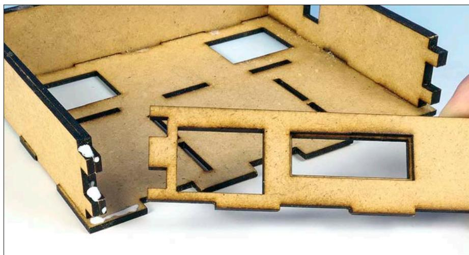
Stumpfe Verbindungen zwischen einzelnen Bauteilen sollten bei der Konstruktion möglichst vermieden werden. Die Verzahnungen an den Seiten und am Boden sorgen für eine einwandfreie Passgenauigkeit bei der Montage und steigern die Stabilität des gesamten Bauwerks enorm.
