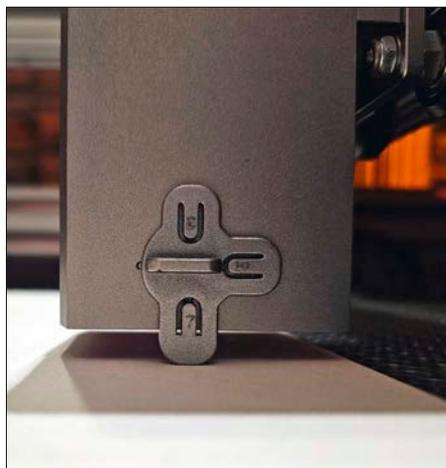
Der Abstandshalter des Lasers (sofern vorhanden) darf nicht auf dem Schneidmaterial aufsitzen, sondern sollte eine Papierstärke Abstand haben, sonst kann er mitunter das Papier verschieben, was – wie im rechten Bild zu sehen ist – zu unbrauchbaren Ergebnissen führt. Mit den Honeycomb-Pins, den Wabenlaserbett-Befestigungen, kann man dies noch weiter minimieren. Man kann das Justierteil aber nach dem Einrichten auch wegdehnen.
