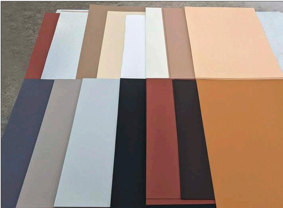
Eine breite Farbauswahl an Fotokarton hilft, die eigenen Projekte zu realisieren. Nicht jede Farbe sieht in natura so aus, wie die Vorschau bei der Internetbestellung vorgibt. In der Prototypenphase lassen sich manche Elemente auch in verschiedenen Farben lasern, somit kann die finale Wahl am fertigen Objekt getroffen werden.
