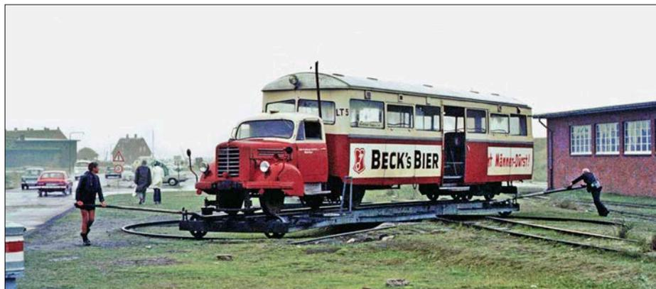
Einer der Leichttriebwagen (LT 5) der Sylter Inselbahn, die 1952-54 in der eigenen Werkstatt aus Borgward-Lkws entstanden. Zum Zeitpunkt der Aufnahme im Sommer 1970 war der Streckenabschnitt nach Hörnum bereits eingestellt, nur die Strecke Westerland–List war noch bis Ende 1970 in Betrieb. Bei Fahrtrichtungswechsel an den Endpunkten mussten die Fahrzeuge auf einer Drehscheibe per Hand gedreht werden, hier am 20.8.1970. Foto: Dieter Junker/Eisenbahnstiftung
