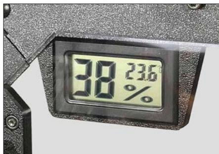
Ein Display zur Anzeige der Temperatur- und Luftfeuchte gehört auch zum Prusa-Gehäuse.
