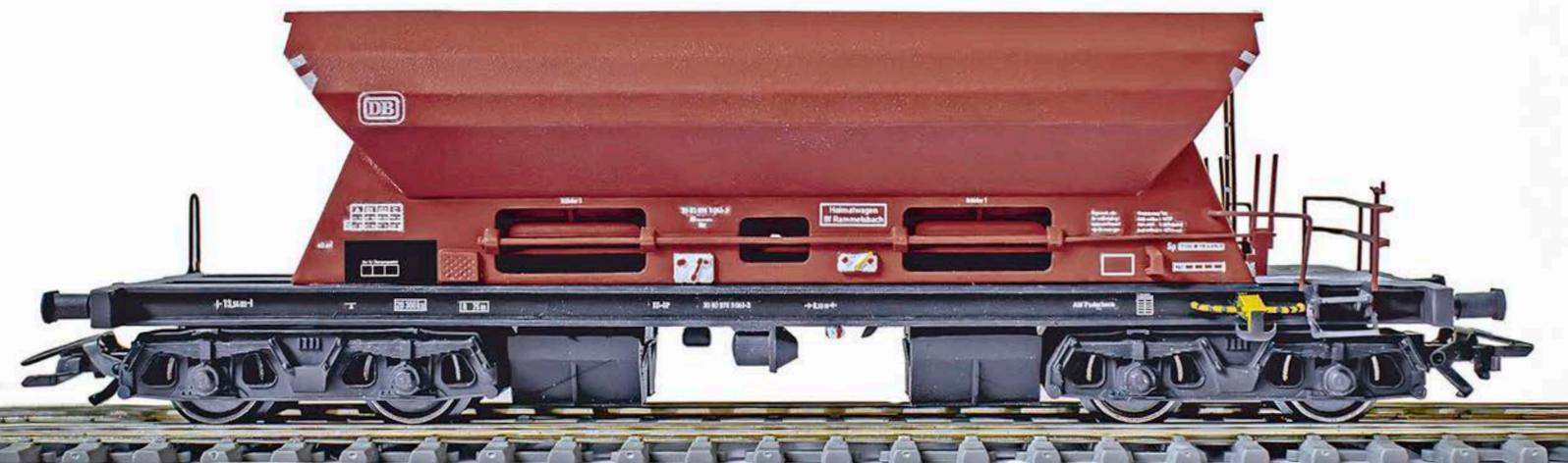
Ein fertig zusammengebauter, lackierter und beschrifteter Wagen. Wenn man einen solchen Eigenbau aus 3D-Druckteilen sauber zusammenbaut und lackiert, können sie durchaus mit Wagen aus der Industrie mithalten.
