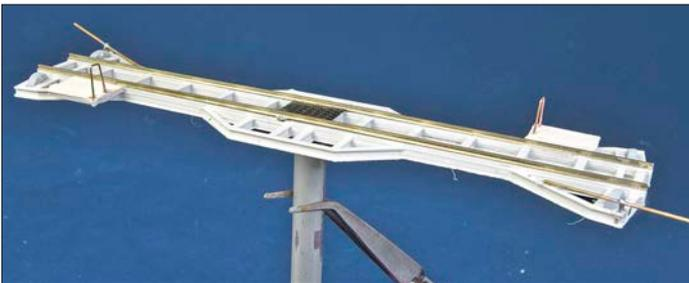
Die ganz filigranen Bauteile wie Geländer und Drehgriffe werden aus 0,7-mm-Messingdraht angefertigt. Damit ist die Bühne fertig zum Einbau.
