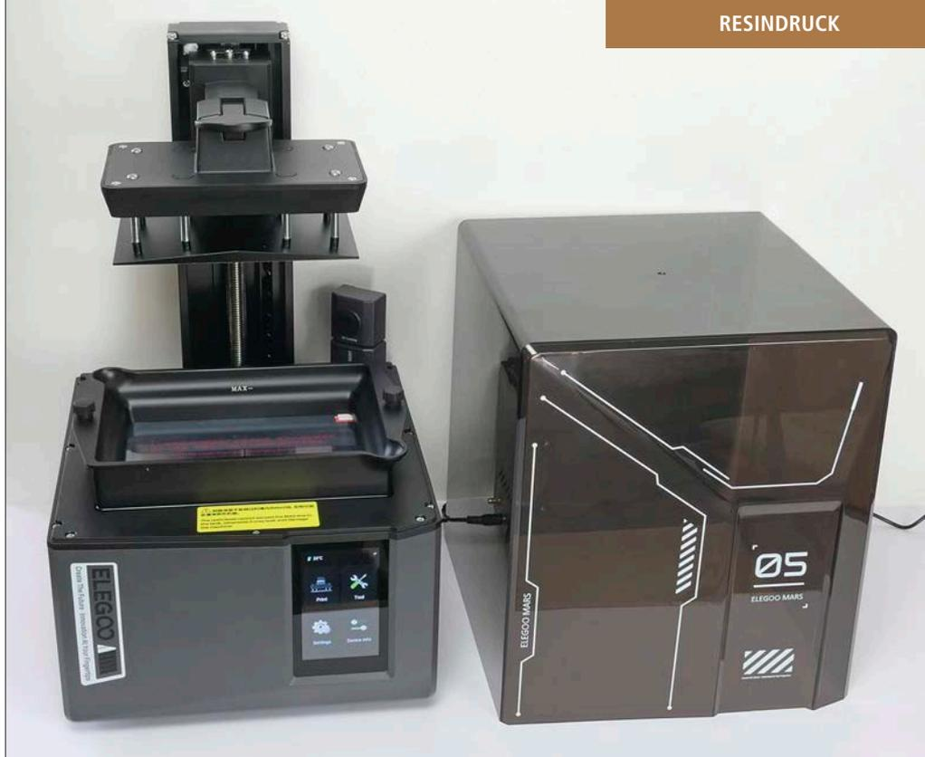
Der Mars 5 Ultra von Elegoo ist ein MSLA-Drucker mit einer COB-Lichtquelle und einem 9K-Mono-LC-Display zur Maskierung. Die Schutzhaube ist bei dem Modell leider nicht kippbar.
