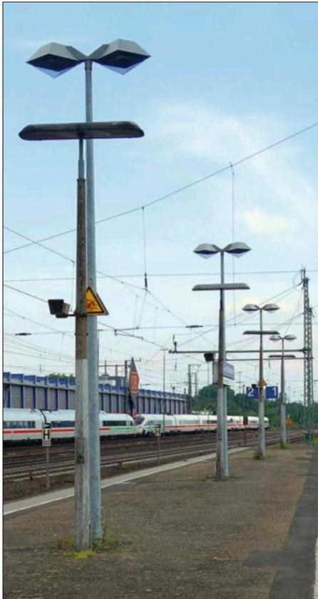
Links: Alt und Neu nebeneinander. Zu sehen die klassische Bauform mit Betonmast und mittiger Befestigung des Schirms. Bis zur Demontage funktionierten sogar beide gleichzeitig.
