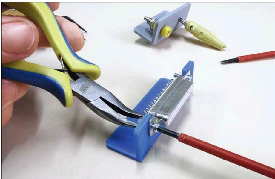
Der große D-Sub-Stecker mit 25 Pins wird mit zwei kleinen M3-Gewindeschrauben und entsprechenden Kontermuttern am gedruckten Halter festgeschraubt – damit hat er genug Halt. Der Halter selbst kann mit zwei kleinen Spaxschrauben im Modulinneren befestigt werden.
