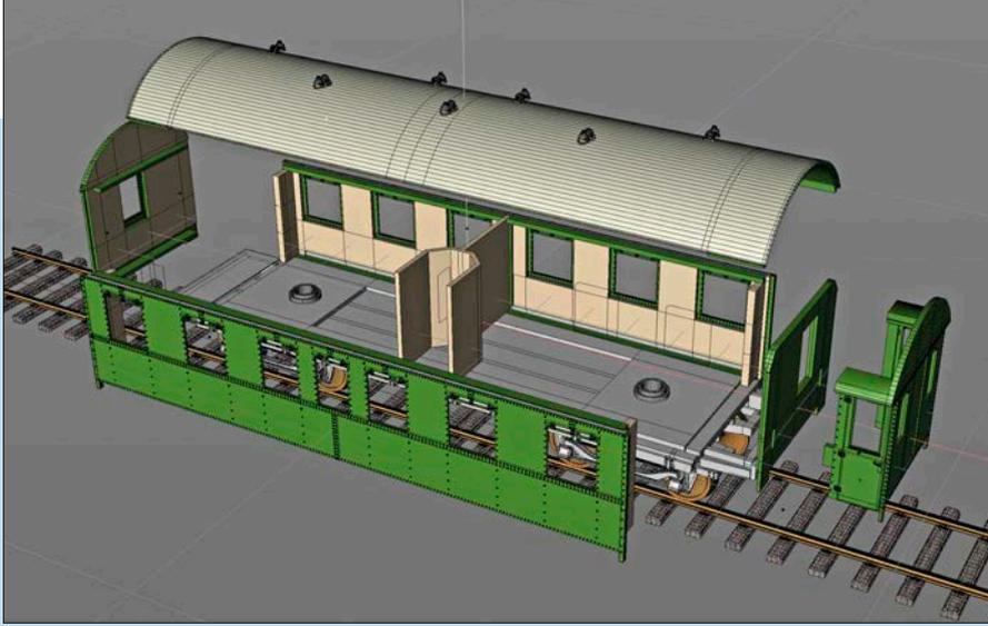
Auch wenn es verführerisch erscheinen mag, den Wagenkasten in einem Stück zu drucken – damit kommt man doch schnell an die Grenzen des Machbaren oder besser des Druckers. Außerdem sollten mit möglichst wenig Aufwand alle Varianten mit offenen und geschlossenen Bühnen gebaut werden können. Daher wurden Seiten- und Stirnwände, Dach und Bodenplatte als Einzelteile angelegt.
