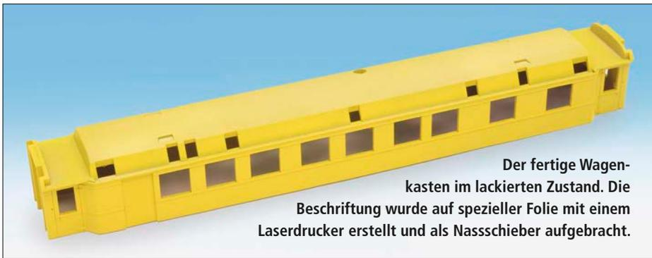
Der fertige Wagenkasten im lackierten Zustand. Die Beschriftung wurde auf spezieller Folie mit einem Laserdrucker erstellt und als Nassschieber aufgebracht.
