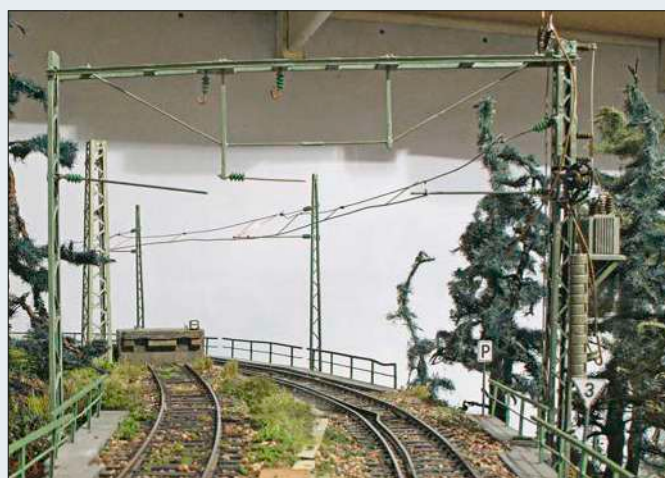
Joch 1 nach dem Einbau auf der Anlage, die Fahrleitung muss noch verlegt werden. An der Strecke im Hintergrund wurde die sogenannte „windschiefe“ Fahrleitung aufgestellt.
