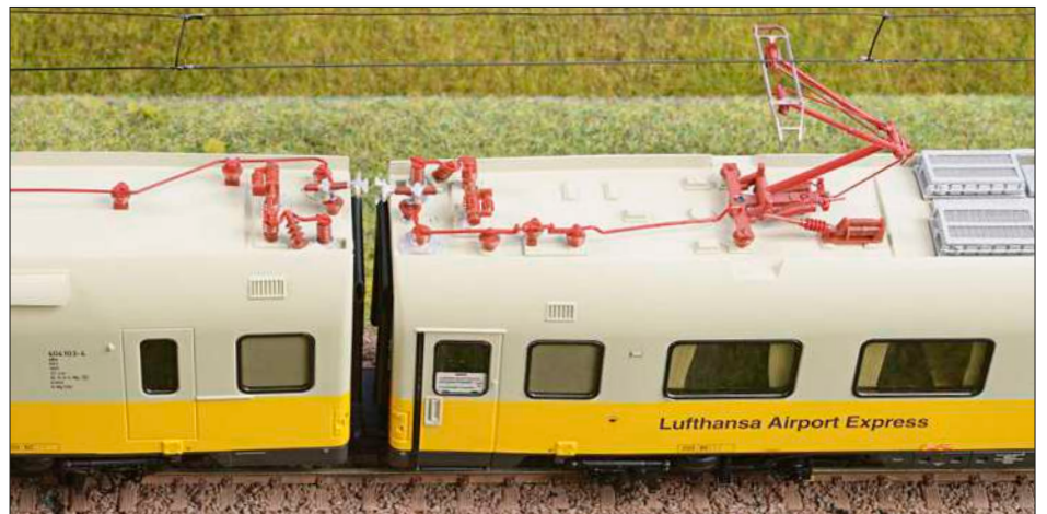
Die Dachausrüstung des Triebzuges 403/404 besteht aus einer durchgehenden Leitung, die über automatische Hochspannungskupplungen an den Übergängen verbunden ist. An den Übergängen sind auch die übrigen Bauteile sehr schön detailliert nachgebildet: Jeder Wagen hat einen eigenen Überspannungswandler, Hauptschalter, Durchführungsisolator und Überspannungsableiter. Die Endwagen haben zusätzlich noch einen Dachtrennschalter.
