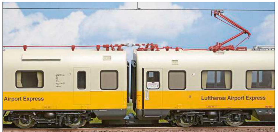
Unten: Der Wagenkastenübergang von der Seite. Man sieht, dass zwischen den Gummiwülsten noch eine etwa 2 mm breite Lücke verbleibt. Unterhalb der Wagenkästen erkennt man die recht massive Modellkupplung. Zum Zusammenkuppeln liegt den Modellen eine Kuppelungshilfe bei, die das Ausweichen der Kupplungen nach unten verhindert.
