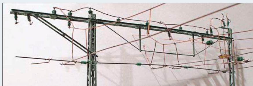
Das Joch 3 für den Standort am Güterschuppen ist bereits fertig zusammengelötet. Der Gittermast links stammt von viessmann, der Flachmast rechts ist wieder ein Eigenbau. Im Bild unten sind schon die ersten Fahrdrähte eingehängt – ohne Abspannung sieht das Ganze noch etwas unordentlich aus ...
