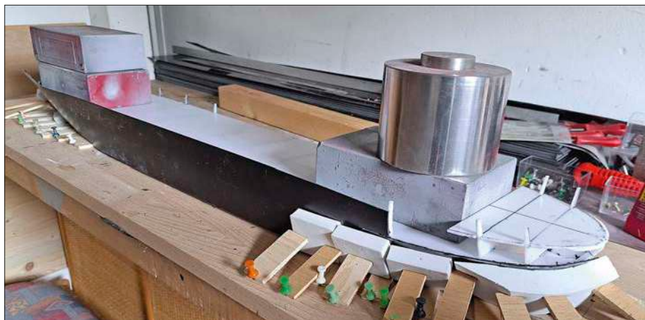
Die „Hans Kröger“ während der Bauphase. Die Polystyrolplatten sind wie die Stahlplatten des Vorbilds auf Maß geschnitten. Verschweißt wird der Kunststoff allerdings mit Lösungsmitteln. Gewichte und Stützelemente halten die Platten bis zum Aushärten des Klebers in Position.
