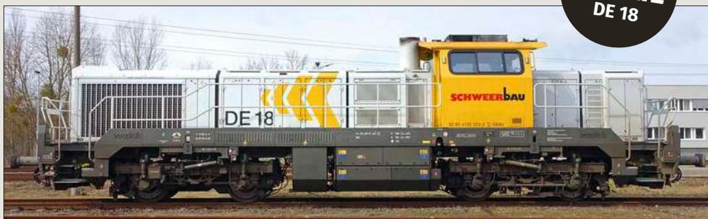
Die DE 18 von Schwerkraft wird im Bahnbau eingesetzt. Hier rechnet sich der Smart Hybrid-Antrieb, den man am Akkumodul anstelle des Zusatztanks erkennt. Der Einfüllstutzen für den Diesel sitzt hier unter dem Führerhaus. In der Seitenansicht ist die unsymmetrische Lokaufteilung gut zu erkennen.
