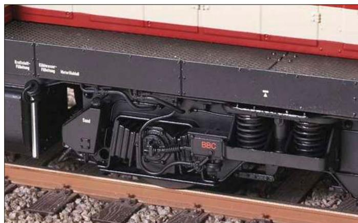
Am Drehgestell unter dem längeren Vorbau ist das BBC-Steuergerät der Sifa mit all seinen Leitungen nachgebildet. Beachtenswert sind die funktionsfähigen Federn, die die Lok auf dem Drehgestell abstützen.
