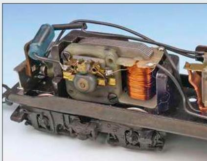
Der Trommelkollektor-Motor mit Feldspule hat ausgedient und soll durch einen Märklin-Hochleistungsmotor aus dem Nachrüst-Set ersetzt werden.
