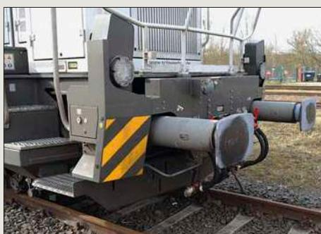
Im Bild oben erkennt man die kombinierten Scheinwerfer und die Leuchten über dem Kupplungshaken und am Aufstieg.
