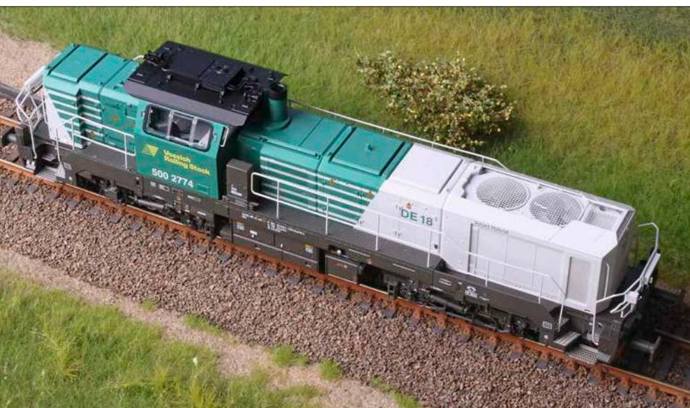
In der Draufsicht ist der vordere Vorbau zu sehen. Im vorderen Bereich ist das Lüftermodul nachgebildet, welches durch die lackierten geätzten Abdeckgitter aus Neusilber besticht. Dahinter die Hauben für Motor und Generator.
