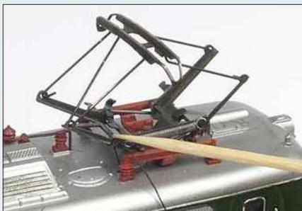
Über das Loch im Dach wird der Nylonfaden des Servos mit dem Pantografen verbunden und mit UV- oder Sekundenkleber fixiert.
