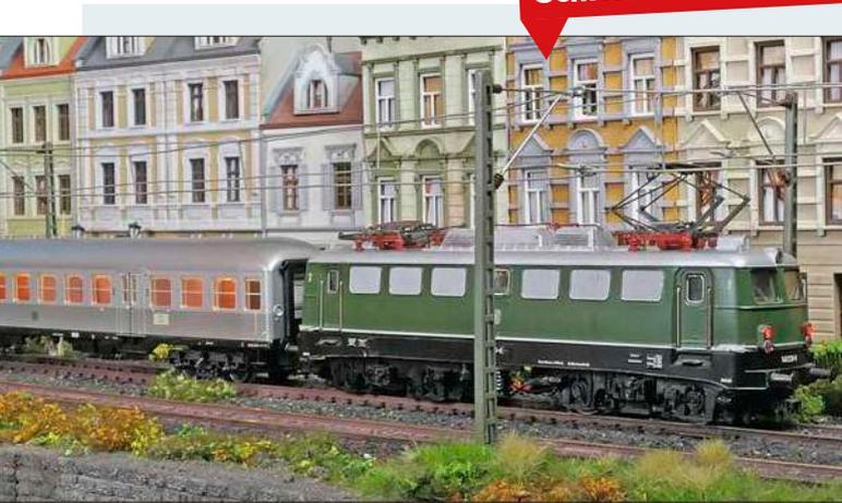
BR 140 im Wendezugbetrieb. Dank der stromleitenden Kupplungen kann die Beleuchtung der Silberlinge digital über den Lokdecoder ein- und ausgeschaltet werden.
