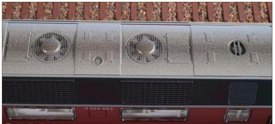
**Die (beim Vorbild elektrisch angetriebenen) Lüfterräder sind unter den hauchfein geätzten Schutzgittern sehr schön erkennbar. Das Grau des Daches zeigt einen feinen Streifen von „Abgasablagerungen“ an der ansonsten nicht gealterten Lok.**
