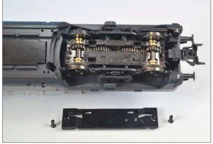
**Die Achsen lagern solide mit Messingbuchsen im ZinkdruckgussDrehgestellrahmen. Auch die Zahnräder bestehen aus Metall, wodurch der Antrieb recht langlebig ist.**
