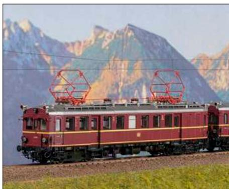
**Durch die kleine Schwungmasse hat der ET 85 von Märklin nur einen geringen mechanischen Auslauf. Im normalen Betrieb regelt der Decoder, nach welcher Zeit und Strecke das Modell zum Stillstand kommt.**
