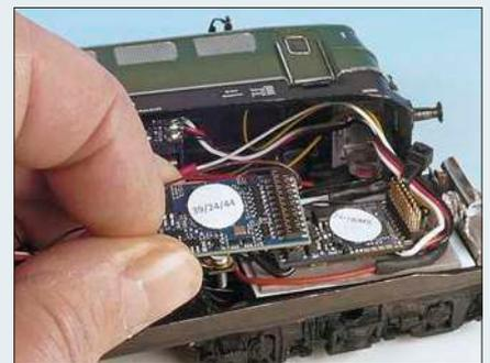
Anstelle des alten mechanischen Fahrtrichtungsumschalters wird eine ESU-Erweiterungsplatine mit 21MTC-Schnittstelle eingebaut.
