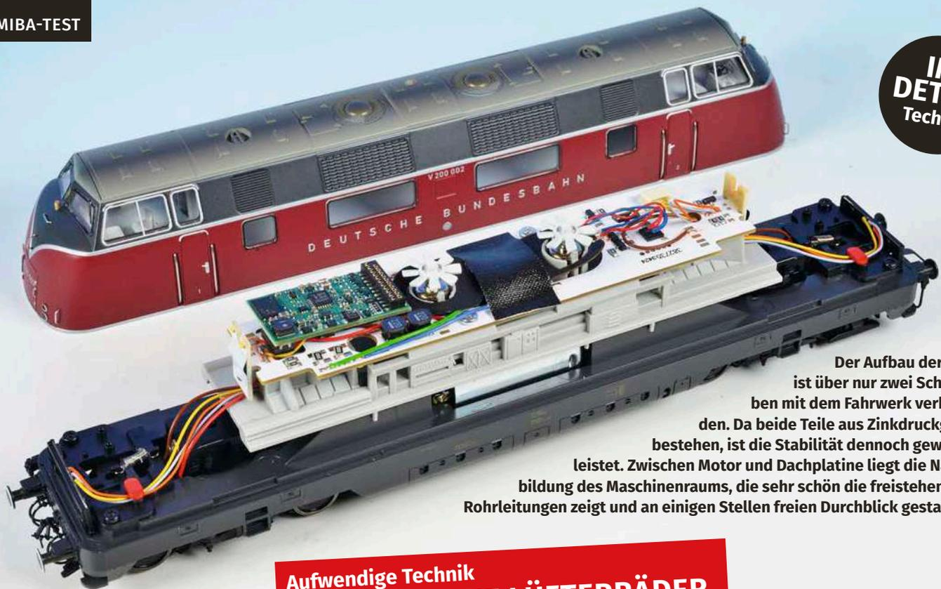
Der Aufbau der Lok ist über nur zwei Schrauben mit dem Fahrwerk verbunden. Da beide Teile aus Zinkdruckguss bestehen, ist die Stabilität dennoch gewährleistet. Zwischen Motor und Dachplatte liegt die Nachbildung des Maschinenraums, die sehr schön die freistehenden Rohrleitungen zeigt und an einigen Stellen freien Durchblick gestattet.
