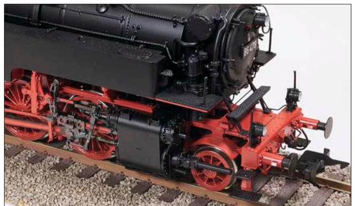
Ein interessantes Detail ist die Nische in der Rauchkammer mit der dort platzierten Luftpumpe. Das Kolbenstangenschutzrohr ist extra zu montieren, wenn die Radien größer als ca. 1200 mm sind.
