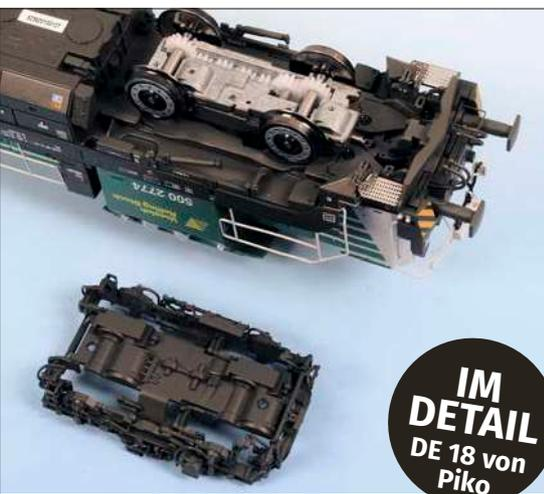
In den Drehgestellen sind alle Radsätze angetrieben. Der innere im hinteren Drehgestell trägt zwei Haftreifen.
