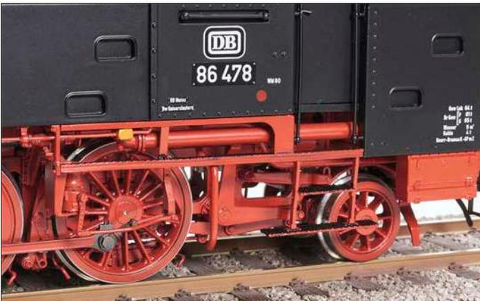
Der Blick auf den Rahmen unter dem Führerstand zeigt die offene Konstruktion, aber auch Details wie das Verbindungsrohr der Wasserkästen und den Schmierpumpenantrieb vor dem Kuppelrad. Der Umlenkhebel der Bremsanlage lässt sich gleichfalls lokalisieren.
