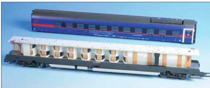
Sehr fein gestaltet sind die Mini-Cabins und die Abteile. An den Doppelstockbetten erkennt man sogar Aufstiegsleitern. Im Dach befindet sich die Lichtplatine.
