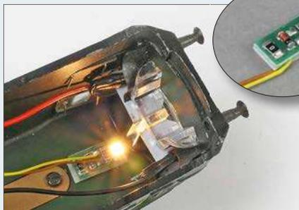
Führerstands- und Maschinenraumbeleuchtung entstehen in Verbindung mit den warmweißen LED-Platinen von Viessmann.
