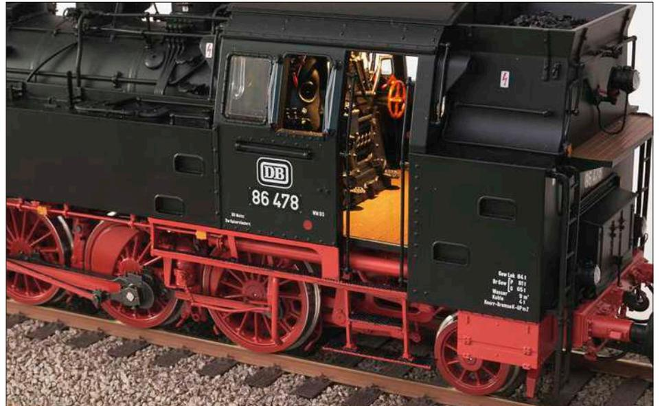
Die Stehkesselrückwand ist mit allen wichtigen Einrichtungen nachgebildet. Öffnet man die Tür, sieht man auch die Klappe der Feuerbüchse und den im Holzton lackierten Fußboden. Die Tür wird übrigens durch eine Feder zugeedrückt.
