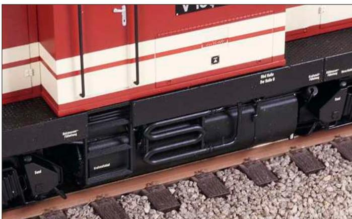
Die Tritte der Aufstiegsleiter sind mit einem Rautenmuster strukturiert. Die Kühlschlange, auf beiden Seiten der Lok neben dem Dieseltank, ist dem Kompressor nachgeschaltet und kühlt die erzeugte Druckluft.
