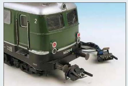
Die stromleitende Krois-Kupplung wird einfach in den Kupplungsschacht eingesteckt.
