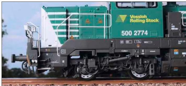
Die Drehgestelle bestehen durch eine filigrane Gestaltung und freistehende Teile. Die Schlingerdämpfer vor den Drehgestellen sind oben am Rahmen befestigt.
