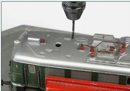
Zur Anlenkung der Scherenmechanik des Dachstromabnehmers mit einem Nylonfaden oder Stelldraht wird ein 1,5-mm-Loch gebohrt.
