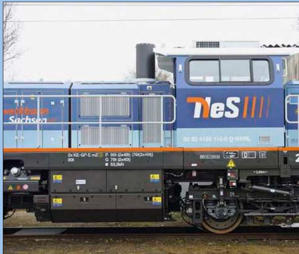
Die DE 18 der Netzwerkbahn Sachsen (NeS) verfügt über den normalen Dieselantrieb, der an dem Zusatztank mit Einfüllstutzen links neben dem Haupttank zu erkennen ist. Führerhaus und Vorbauten entstanden in modularer Bauweise und gleichen anderen Vossloh-Loks wie der G 6.
