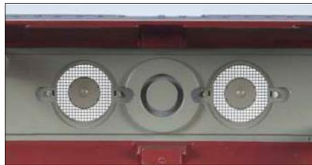
realistisch wirkt. Die Nachbildung des Maschinenraums nimmt mittig auch den Lautsprecher auf, der nach oben abstrahlt. Der Akustikwirkung kommen die durchbrochenen Lüfter-Öffnungen entgegen, unter denen sich die motorisch angetriebenen Nachbildungen der Lüfterräder befinden.
