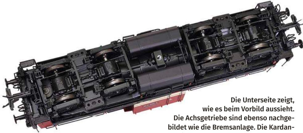
Die Unterseite zeigt, wie es beim Vorbild aussieht. Die Achsgetriebe sind ebenso nachgebildet wie die Bremsanlage. Die Kardanwellen sind nur angedeutet. Hervorzuheben sind die etwas schmaleren Radsätze.
