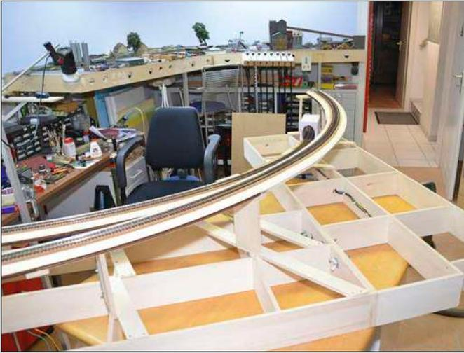
Das Segment mit der Talsperre und der Tunnelleinfahrt in den Schattenbahnhof im Bau. Die Trassenbretter liegen auf Stützen und man erkennt die nach unten führende Strecke in den Schattenbahnhof. Im Hintergrund steht der im Bau befindliche Bahnhof Maroldsfürst.
