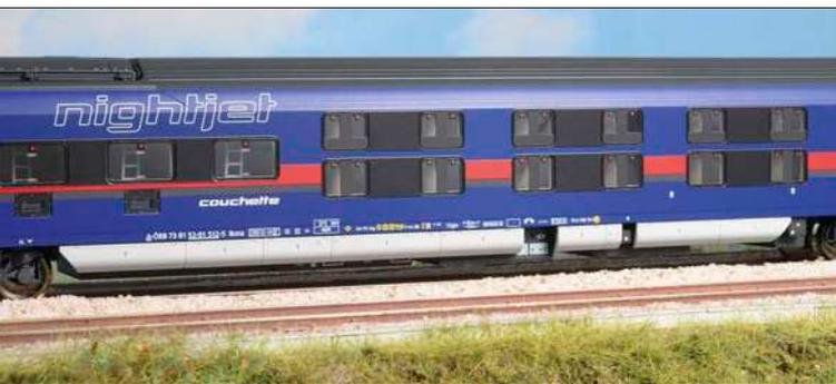
Neu bei Nachtzügen sind kleine Mini-Cabins, die nur über einzelne Betten verfügen. Die eine Seite dieser Bcmz-Wagen besitzt dazu kleine Fenster der Cabins, die übereinander angeordnet sind. Auf der Gangseite, sind große Fenster angeordnet.
