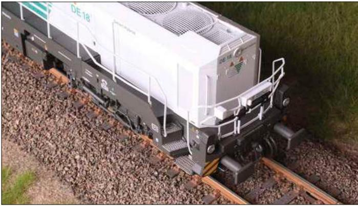
Die Tritte des Aufstieges bestehen aus geätztem Neusilberblech. Zusätzlich wurde eine Riffelblechoberfläche auf dem Umlauf nachgebildet. Die filigranen Geländer bestehen aus geätztem Blech, sind lackiert und von oben in den Umlauf gesteckt.
