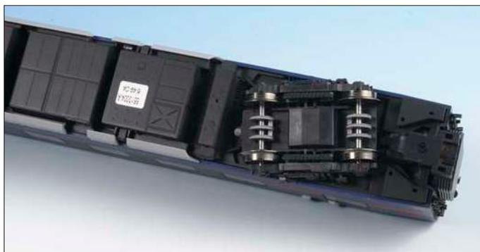
Die neuen Siemens-Drehgestelle hat Roco korrekt umgesetzt. Die Bremscheiben sind Steckteile, die in den Drehgestellrahmen gesteckt sind. Auch die Schlingerdämpfer und die Magnetschienenbremsen sind extra angesteckte Teile.
