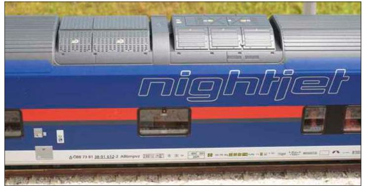
Neben den aufwendig gestalteten Innenräumen der H0-Züge überzeugen auch die Dächer der Wagen. Die Sicken im Dach sind genauso vorbildgerecht wie die Klimageräte und Lüftungen. Um die Unterschiede auf den Wagen nachbilden zu können, sind Dachkomponenten gesteckt. Die glasklaren Scheiben sitzen in einer Ebene in den Seitenwänden und ermöglichen den Blick ins Innere der Wagen.
