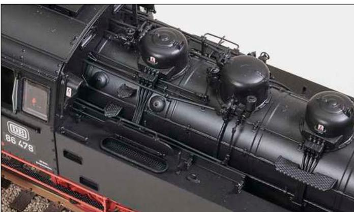
Unter den Wasserkastendeckeln ist das Schutzgitter angedeutet. Stellstangen, Handräder, Dampfleitungen, Sandfallrohre und die Tritte mit Rautenstruktur laden zur Betrachtung ein.
