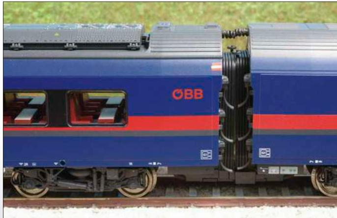
Die Wagen der Nightjet-Garnituren sind fest miteinander verkuppelt. Im Modell sind dazu Kupplungen vorhanden, die Strom und den Datenbus übertragen. Im gekuppelten Zustand erkennt man die Leitungen zwischen den Wagenkästen und die druckdichten Wagenübergänge.
