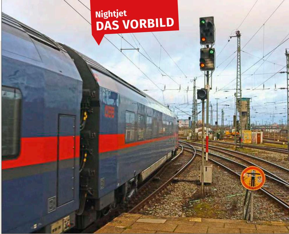
Die Wagenkästen basieren auf den bekannten Siemens-Konstruktionen, die anhand der gesickten und abgekannteten Dächer zu erkennen sind. Foto: Jens Brüggemann
