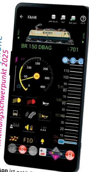
Die **ZIMO App** ist natürlich mehr als eine „normale“ Modellbahn-App. Sie übernimmt Elemente der ZIMO Fahrpulse, z.B. die Datenstruktur, nützt andererseits auch die Größe des Bildschirms: daher ist ein ETCS-Tacho Standard.
