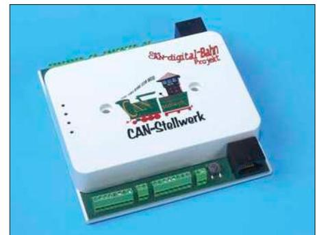
**CAN-Stellwerk von CAN-digital-Bahn mit Ein- und Ausgängen, die jeweils dem Bedarf entsprechend konfiguriert werden können.**
