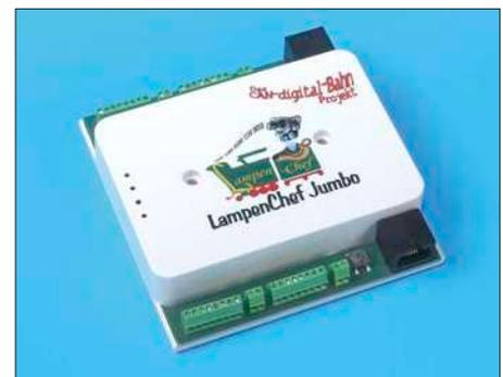
**LampenChef Jump mit 32 Schaltausgängen von CAN-digital-Bahn**
