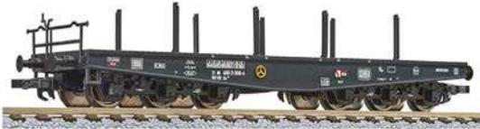
**H0/N:** Die Schwerlast-Transportwagen werden u. a. als sechssachsige Sa 705 der DB in H0 und als vierachsige SSys 45 in N gefertigt.
