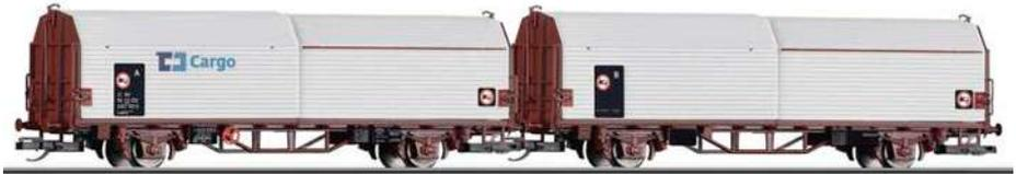
TT/H0: Haubenwagen-Einheit Laails der CD als Variante und in H0 als Neukonstruktion von Tillig
