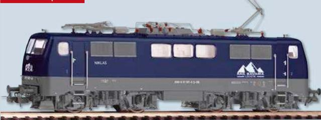
Durch die glasklaren Fenster an der Lok-Seitenwand ist die detailliert nachgebildete Maschinenraumeinrichtung erkennbar. Mit feingliedrigem Metall-Stromabnehmer und scharf gravierten Drehgestellen. Verfügt über eine digital schaltbare Beleuchtung im Führerstand und Maschinenraum.
