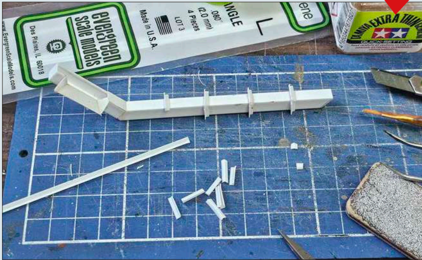
Die Kohleförderung wurde aus Evergreen-Profilen selbst gebaut. Dabei erhielt ein dickeres Vierkantrrohr Verstärkungen aus Winkelprofilen.
