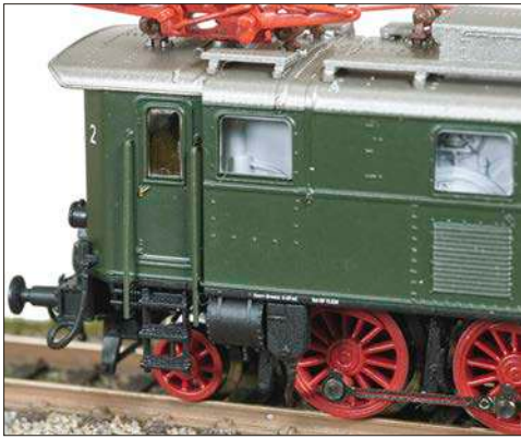
Sandbehälter mit Sandfallrohr neben dem Druckluftbehälter mit umlaufender Nietreihe
