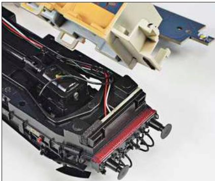
Die unteren Lampen für die Signalisierung der Zugspitze haben separate LED-Platinen. Kleine Moosgummi-streifen an Fahrwerk und Inneneinrichtung maskieren eventuell vorhandene Lichtspalte.
