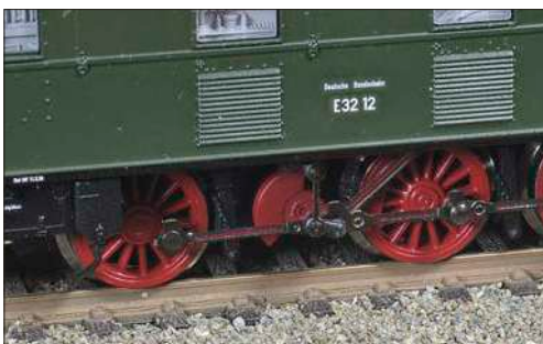
Fein umgesetzt ist der Schmierpumpen-Kurbeltrieb an der Blindwelle.
