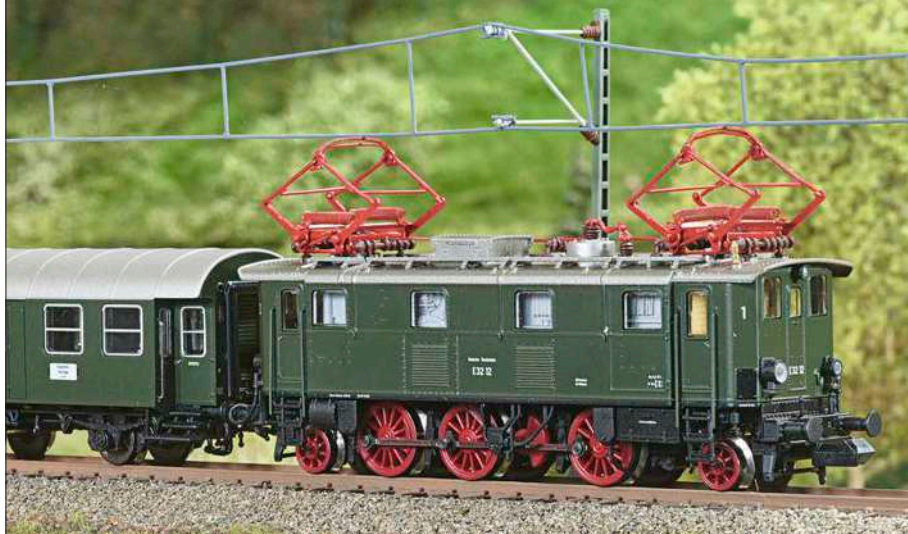
Im Zusammenhang mit dem SBS-9-Stromabnehmer wird die E 32 immer mit zwei Pantos am Fahrdrabt gefahren, da diese nur über jeweils ein Schleifstück verfügen.
