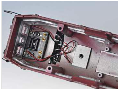
Die freistehenden Rücklicht-Laternen sind über Federstiftkontakte mit der Hauptplatine verbunden. Für das dritte Spitzenlicht liegt die LED ebenfalls auf der Hauptplatine; sie gibt ihr Licht über einen Lichtleitkörper ab, der in der Mitte der Kontaktplatine erkennbar ist.
