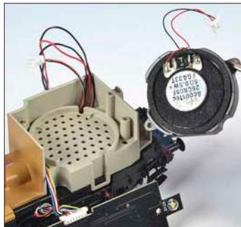
In der Trafokammer wurde der große Lautsprecher sehr gut versteckt. Auch er ist über eine Steckverbindung angeschlossen.
