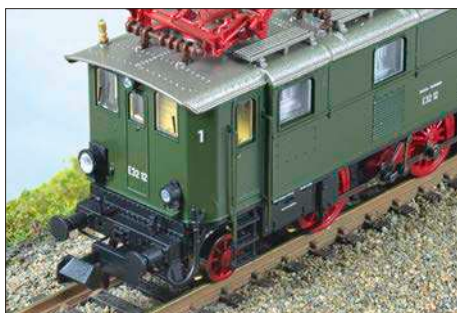
Frontpartie ohne Zurüstteile mit serienmäßiger N-Standardkupplung
