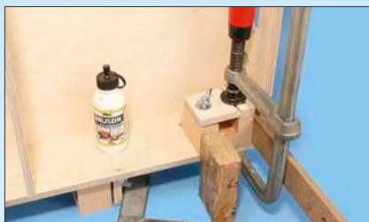
Die Beinhalter werden zunächst verklebt. Eine genaue Positionierung ist nicht vorgegeben. Ich habe sie bündig zur Unterkante der Längsrahmen, aber mit Abstand zu den schmalen Rahmen verklebt.
