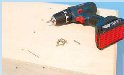
Jetzt sollte die Deckplatte einwandfrei passen. Es wird wieder durchgebohrt, gesenkt, verklebt und geschraubt.
