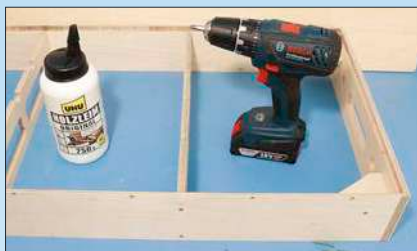
Zu guter Letzt wird auch die zweite Längswange verklebt und verschraubt.
