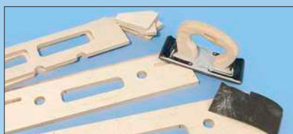
Sämtliche Kanten der Bauteile werden vor der Montage noch mit Schleifpapier ver säubert.
