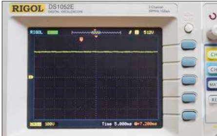
Erst mit einem nachgeschalteten Elko wird aus der pulsierenden Gleichspannung eine nahezu glatte Kurve ohne lästige Flimmereffekte
