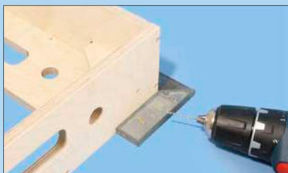
Die Eckwinkel werden unter Zuhilfenahme eines Metallwinkels und eines Rahmenteils ausgerichtet.
