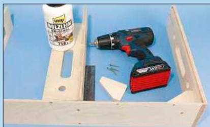
Natürlich müssen auch die beiden Spanten exakt rechtwinklig ausgerichtet und dann verklebt und verschraubt werden.
