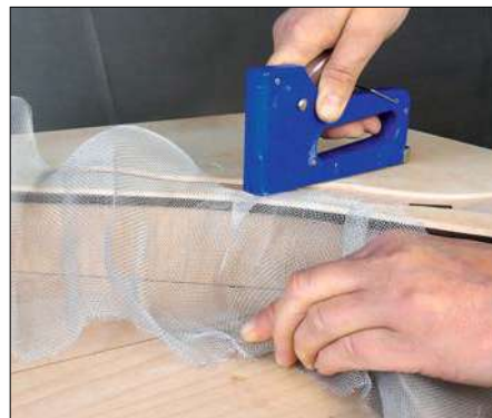
Mit einem Tacker wird das Alugewebe an den Trassen und Spanten befestigt. Erst dabei entstehen Berge, Hügel und Täler.
