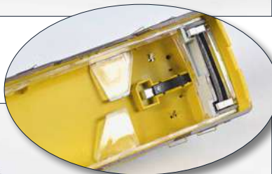
Sollte man mal die Inneneinrichtung vom Fahrwerk trennen wollen, muss man insgesamt acht Schrauben lösen. Rechts die Lichtleitkörper im Wagenkasten
