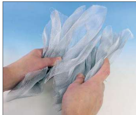
Vor der Verarbeitung des Aluminiumgewebes sollte dieses kräftig zusammengeknüllt und dann wieder auseinandergefaltet werden.
