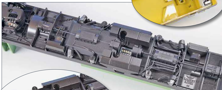
Das Fahrwerk ist mit sämtlichen Leitungen und Rohren hochdetailliert. Der DIP-Schalter verbirgt sich zwischen den Tanks.
