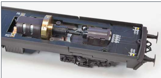
Der Motor hat eine große, dynamisch gewuchtete Schwungmasse. Er überträgt seine Kraft mit einer kurzen Kardanwelle auf das Schnecken-Stirnradgetriebe.
