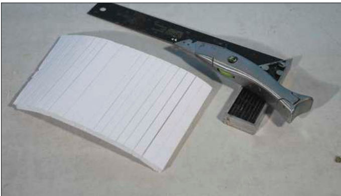
Die Staumauer entsteht aus einem KAPA-Hartschaumplatten-Abschnitt. Zum Biegen sind im Außenbogen Einschnitte gesetzt worden.
