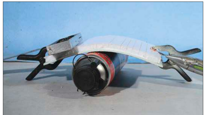
Hier sieht man, wie die Platte ganz leicht gebogen werden kann. Der Innenbogen erhielt eine Ziegelverblendung aus Heki dur.
