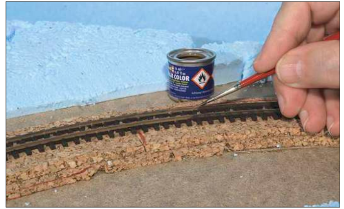
Nach dem Aufkleben und Zuschneiden des Korkunterbaus und des Flexgleises folgt das Lackieren der Schienenprofile mit einem Rostton.
