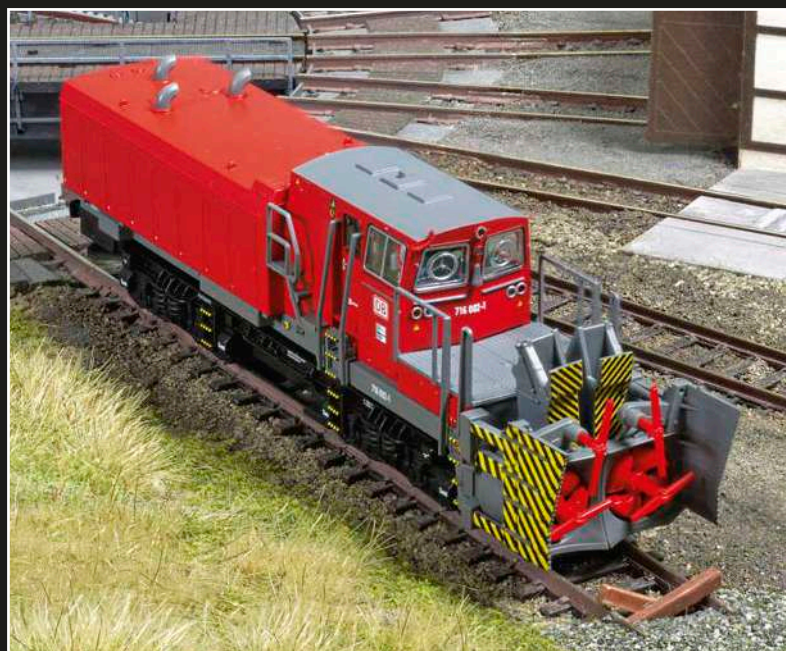
Das Räumschild kann beim Vorbild in der normalen Räumstellung von 293 cm bis auf eine Räumbreite von 554 cm ausgefahren werden.
