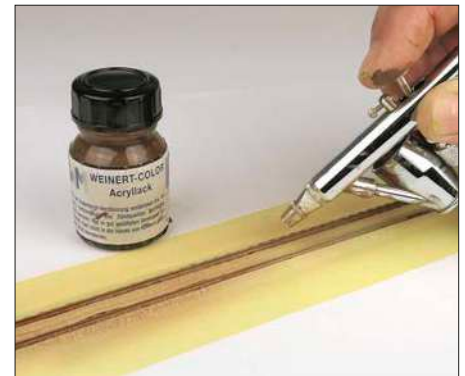
Die Schienenprofile erhalten einen eigenen Farbauftrag in einem typischen Rostfarbton.
