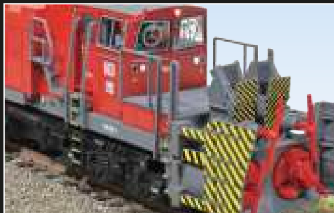
Markant sind die angeformten und silbern bedruckten Rotationsscheibenwischer der Stirnfenster.
