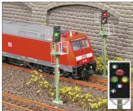
In der Bahnhofsausfahrt kommen Ks-Signale zum Einsatz, die auch Sh 1 anzeigen können.
