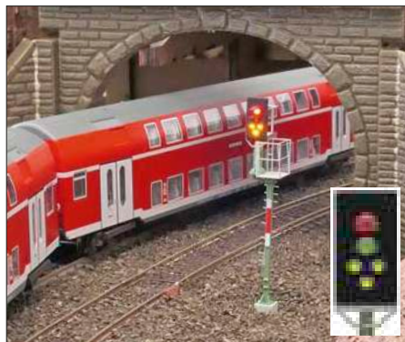
Für den Betrieb auf der freien Strecke eignen sich einfache Ks-Hauptsignale (hier mit Zs 7).
