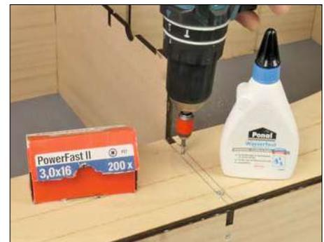
Nachdem die Spanten gesetzt sind, werden im letzten Arbeitsschritt die Trassen für die Gleise und den Geländebau eingesetzt.
