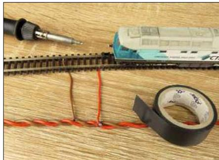
Die Stickleitungen der Schienen werden (unter der Anlage) mit der Ringleitung verbunden.
