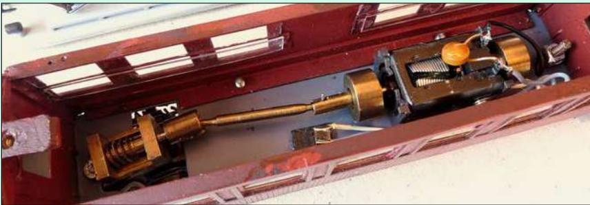
Im Fahrgastraum konnte der Motor weitgehend unsichtbar unterhalb der Fenster eingebaut werden. Über eine Kardanwelle erfolgt die Kraftübertragung auf das Schneckengetriebe im Drehgestell.
