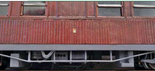
Die Bretterfugen am Wagenkasten wurden in das Messingblech mit einem scharfen kleinen Beitel eingraviert.
