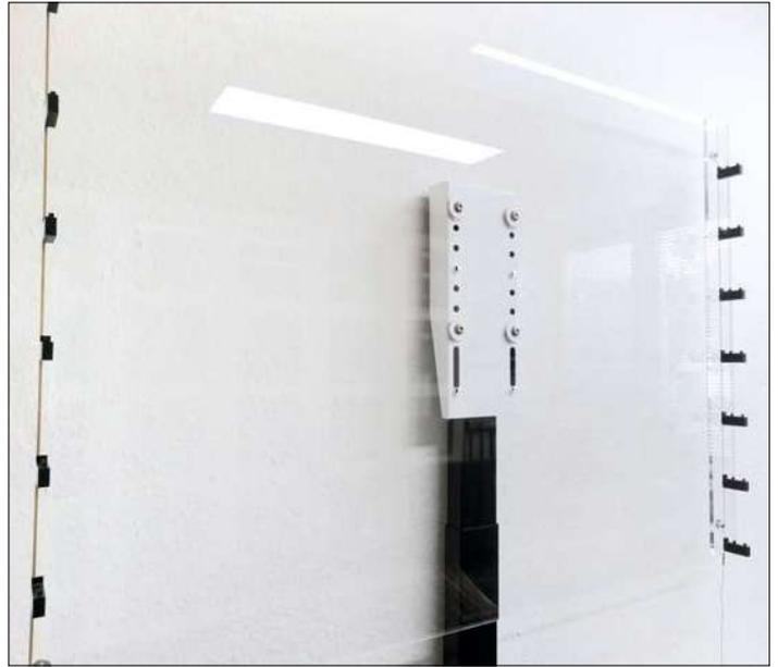
Einfach ist zunächst, die Position der Bohrlöcher für die Vitrinenhalter zu ermitteln. Die vier Bohrungen kommen symmetrisch auf die Plexiglasplatte. Die Abstände zwischen diesen Bohrlochern lassen sich der Train-Safe-Anleitung entnehmen.
