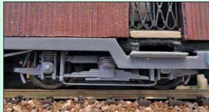
Die Drehgestelle wurden aus Messingprofilen und -streifen zusammengesetzt. Beim Bau sorgten Schablonen dafür, dass alle Teile gleich ausfielen.
