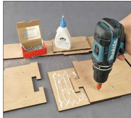
Längere Spanten und Trassen müssen vor der eigentlichen Endmontage aus mehreren Holzelementen zusammengesetzt werden.
