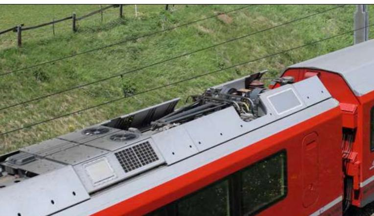
Die Hochspannungsausrüstung ist auf dem motorisierten Endwagen untergebracht und besitzt zwei Stromabnehmer. Im Bild ist vor dem Stromabnehmer das Klimagerät für den Fahrgastraum zu erkennen. Die Aggregate sind durch Bleche verkleidet, sodass sich eine einheitliche Fahrzeugsilhouette ergibt.
