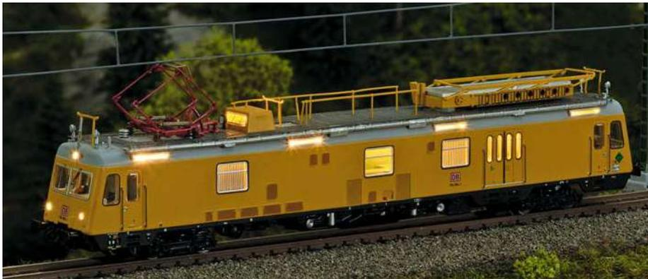
Im Analogbetrieb lässt sich die Beleuchtung über einen DIP-Schalter wahlweise schalten, im Digitalbetrieb über den Decoder und die entsprechenden Funktionstasten.
