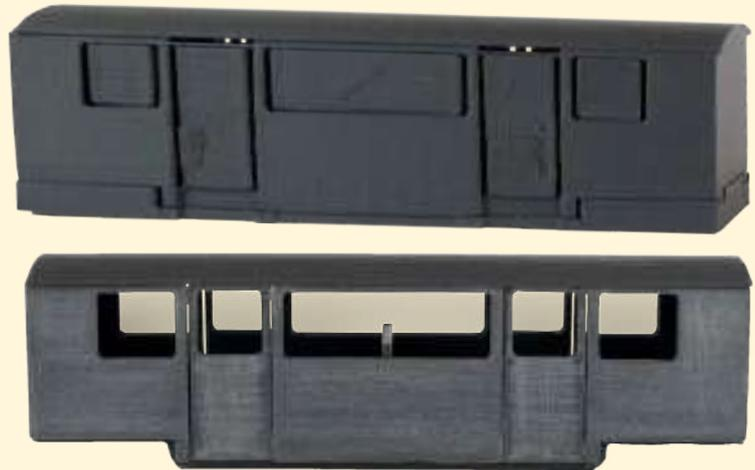
Ein Wagenmodell in seinen drei Entstehungsstufen. Oben der Rohbau, der noch Fenster- und Türfüllungen enthält, damit sich der Wagenkasten nicht beim Drucken verzieht. Darunter der Wagenkasten mit herausgelösten Füllstücken, eingesetzten Türen und bereits geschliffener Oberfläche.
