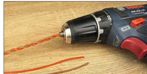
Für einen störungsfreien Betrieb können die beiden Kabel der Ringleitung verdreht werden.
