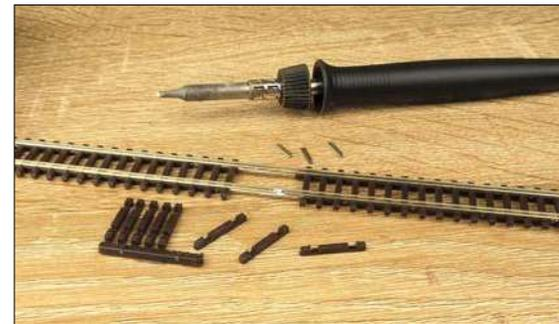
Mit oder ohne Verlöten der Flexgleise: Trennstellen sollten stets versetzt angeordnet sein.
