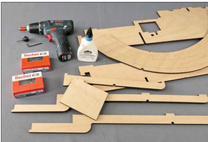
Der Lasercutbausatz von Konzept-Bahnen besteht aus 6-mm-Buchensperrholz. Senkkopfschrauben und Holzleim werden zusätzlich benötigt.
