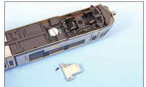
Der Decoder für die Lichtsteuerung im Steuerwagen liegt unterflur unter einer angeschraubten Abdeckung.
