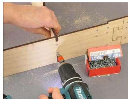
Zusätzlich zum Verleimen sollten alle Verbindungen vorgebohrt und geschraubt werden. Alle Schraubenköpfe am besten versenken!
