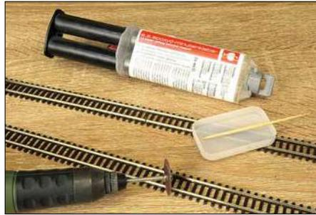
Gleistrennungen gelingen mit der Trennscheibe. Ein Verfüllen der Lücke ist empfehlenswert.
