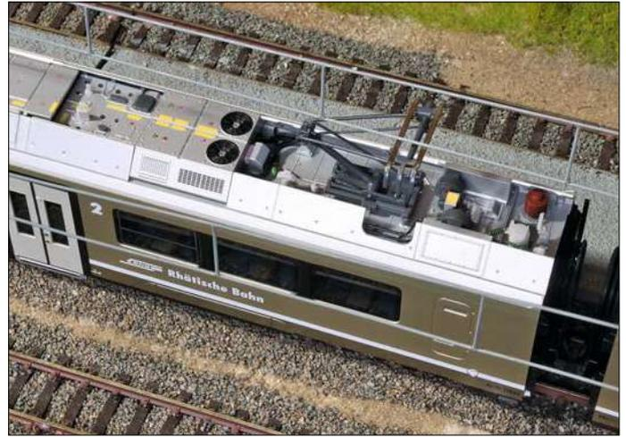
Über der Front des Triebzuges ist das Klimagerät für den Führerstand nachgebildet. Dahinter folgt ein Stromabnehmer und die aus Ätzblech gestalteten Gitter für die Bremswiderstände. Die seitlichen Abdeckungen sind freistehend und die Aggregate dazwischen bedruckt.
