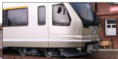
Die Wagen sind mit den typischen Bemo-Kupplungen verbunden. Für die bei Schmalspurbahnen üblichen engen Gleisradien wurde ein Abstand zwischen den Faltenbälgen von etwa 2 mm gewählt. Die Abdeckungen der Stecker für die Steuerleitungen sind angeformt.
