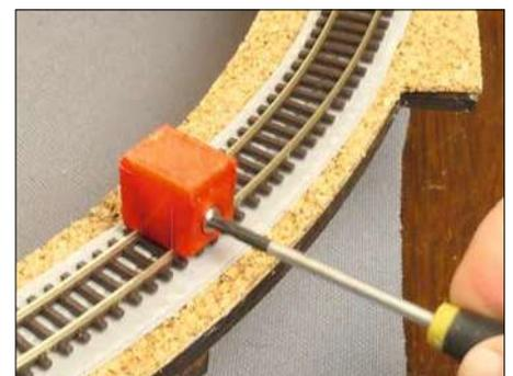
Beim Verlegen der Peco-Code-55-Flexgleise sind Spur-N-Flexgleispanner eine gute Hilfe.
