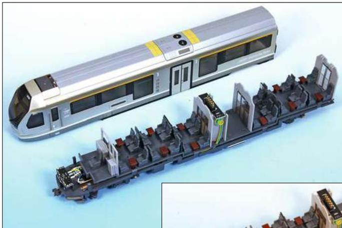
Vom Steuer- und den Mittelwagen können die aufgesteckten Wagenkästen durch Spreizen nach oben abgezogen werden. Die Inneneinrichtung besteht aus gesteckten Tischen, Zwischenwänden und Schaltschränken.
