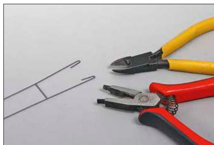
Die Fahrdrähte wirken optisch etwas filigraner, wenn sie dunkel lackiert werden. Auch entspricht eine dunkle Farbgebung eher dem Vorbild als ein heller Metallglanz – ein kupferglänzender Fahrdraht ist beim Vorbild eher die Ausnahme. Hier wurden die Fahrdrähte nach dem Biegen der Ösen und vor dem Einbau mit matter dunkelgrauer Farbe aus der Spraydose lackiert.
