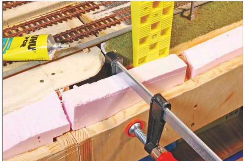
Die Böschung vor den Gleisen entstand aus passend zugeschnittenen Styrodur-Stücken. Diese klebt man mit UHU-Por ein; während der Kleber aushärtet, fixiert man sie mit Schraubzwingen.
