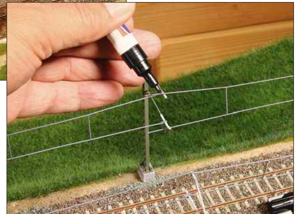
Von Viessmann erhält man für dessen Fahrdrachtsystem eine Biegezange, mit der kleine Ösen gebogen werden können. Diese Ösen biegt man an der Markierung und schneidet das überstehende Stück etwa 5 mm hinter der Biegestelle mit einem Seitenschneider ab.
