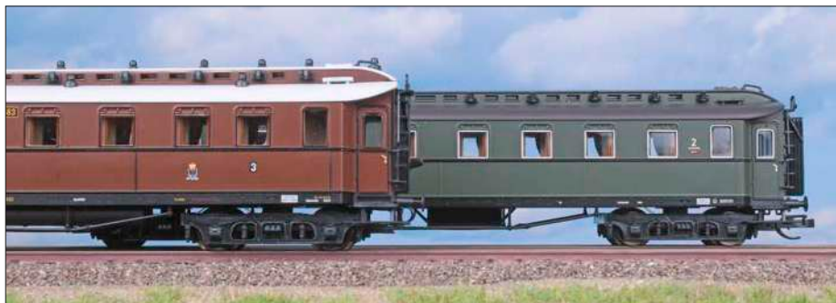
Vorne ist ein Wagen der Epoche I und dahinter ein Wagen der Epoche III der DR zu sehen. Die Fensterrahmen sind unterschiedlich bedruckt und am Dach sind die Unterschiede besonders deutlich. Der Tillig-Formenbaukasten ermöglicht die Umsetzung unterschiedlichster Vorbilder.
