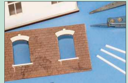
Rechts: Die Fensterstürze im Erdgeschoss können wieder aus dem Bausatz entnommen werden. Für die Fensterbänke wird ein Stück Kunststoffprofil verwendet.
