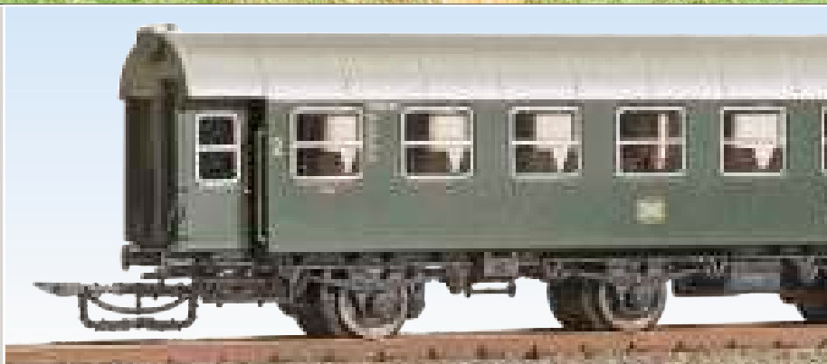
Die 3yg-Pärchen werden über eine Deichsel verbunden, die von der Seite die Illusion einer vorbildgerechten Verbindung mit Schraubenkupplung, Brems- und Heizleitung erzeugt. Fotos: gp
