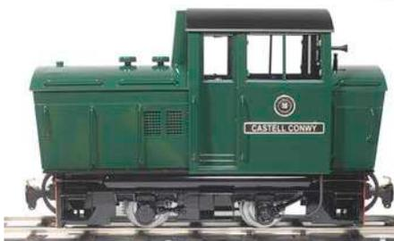
G/0: Auch die akkubetriebene Conway Castle, 1958 für das Royal Naval Armament Depot in Ernesettle in Devon erbaut, kann umgespurt werden. Für den gemischten Betrieb auf stromführenden Gleisen sind die Radsätze der Loks isoliert.
