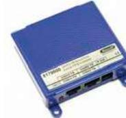
**G:** Neu im Massoth-Sortiment für die Anlagensteuerung ist der DiMAX-FB-Bus-Verteiler.
