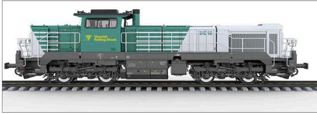
**H0:** Die dieselelektrischen Lokomotiven DE 18 von Vossloh können sowohl im schweren Rangier- wie auch im Streckendienst eingesetzt werden. Piko bringt die Lok mit allen Details.
