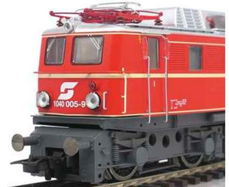
**H0:** Mit dem Scheinwerfer-Upgrade von fineWerk erhält das Modell der ÖBB-Reihe 1040 von Rivarossi ihr charakteristisches Aussehen – hier die Ausführung mit hohen Scheinwerferkästen. Der Gepäckkarren wird im 3D-Druck hergestellt, die Deichsel ist ein Ätzteil aus Neusilber.
