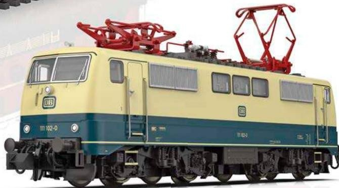
**N:** Mit einem Gehäuse aus Zinkdruckguss ist bei Minitrix die BR 111 angekündigt. Standardmäßig wird sie digitaltechnisch auch mit Sound ausgerüstet.
