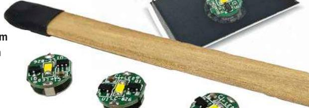
Per Magnet schaltbare MagnoLED von Tramfabriek als Innenbeleuchtung, auch im Dreier-set mit Magnetstab zum Schalten
