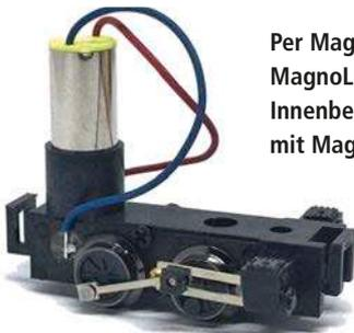
H0e: Fahrwerke für den Selbstbau von 9-mm-Schmalspurfahrzeugen mit 12-V-Motor von Tramfabriek
