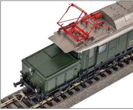
**H0:** Um beim Besteigen des Vorbaus die möglicherweise spannungsführenden Gelenke des Stromabnehmers nicht zu berühren, wurden bei der E 94 die Dächer verlängert.
