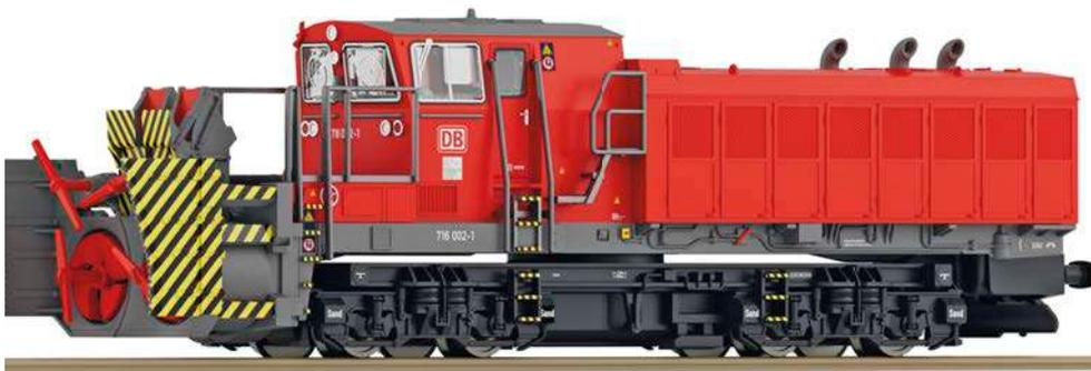
**N:** Eine komplette Neukonstruktion ist die Beilhack-Schneeschleuder von Fleischmann. Das Oberteil kann gedreht werden, auch die Schaufelräder lassen sich einschalten.
