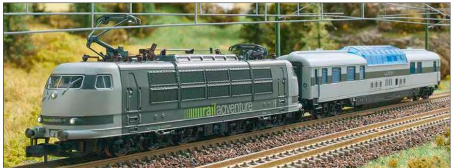
**N: BR 103 mit heb- und senkbaren Pantographen und Aussichtswagen mit Innenbeleuchtung der RailAdventure von Minitrix**
