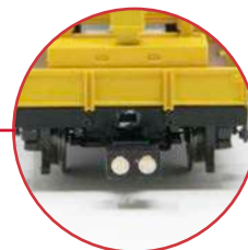
Stromführende Magnetkupplung zwischen KLV und Anhänger
