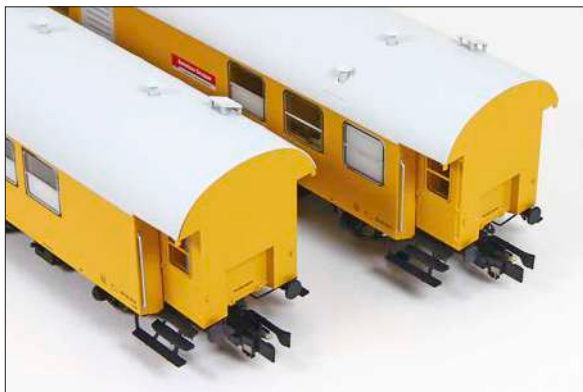
Die Wagenenden sind verschlossen. Zwischen den beiden Wagen befindet sich eine zweipolige elektrisch leitende Kupplung.
