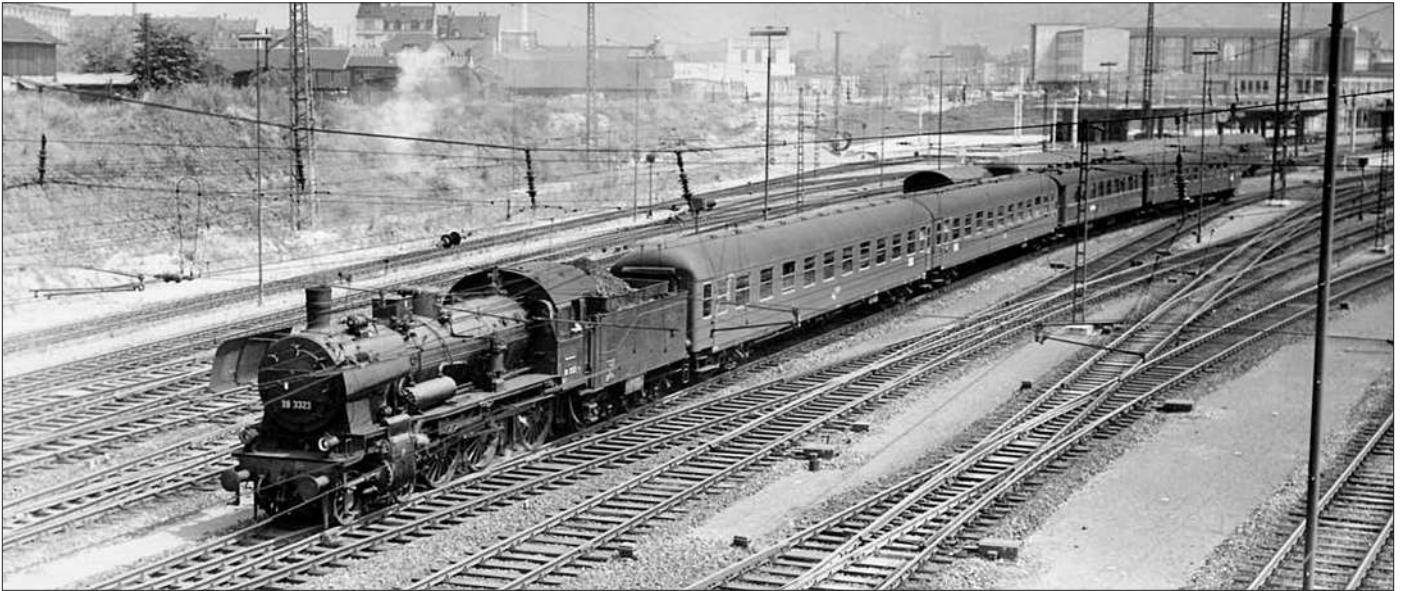
In den 50er-Jahren kam die P 8 hin und wieder auch zu Schnellzug-Ehren. 38 3323 dampft hier mit dem F 3 „Merkur“ (Stuttgart–Köln–Hamburg-Altona) durch den Heidelberger Hauptbahnhof. Der Zug besteht aus drei neuen Aüm und einem Speisewagen der Vorkriegsbauart.
