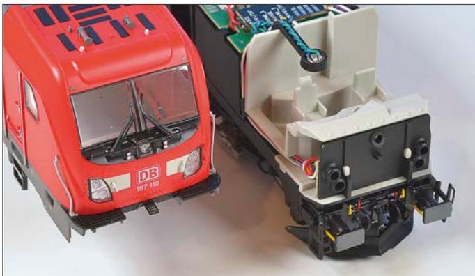
Die Frontbeleuchtung erfolgt über separate Platinen, die wirkungsvoll maskiert sind. In der Lokfront sind die Scheinwerfer-Einsätze sogar mit einer Andeutung von LEDs graviert. Die Trittstufe an der Front ist sehr fein aus Kunststoff nachgebildet.
