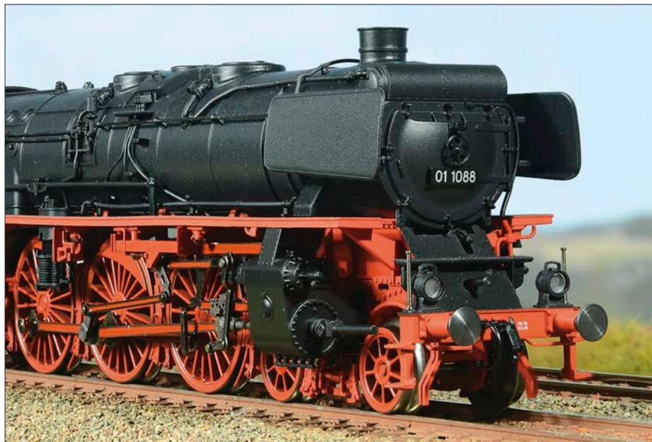
Die oben abgeflachte Rauchkammertür und der direkt darüber platzierte Vorwärmer geben dieser frühen Nachkriegsversion der 01.10 ein charakteristisches Aussehen.
