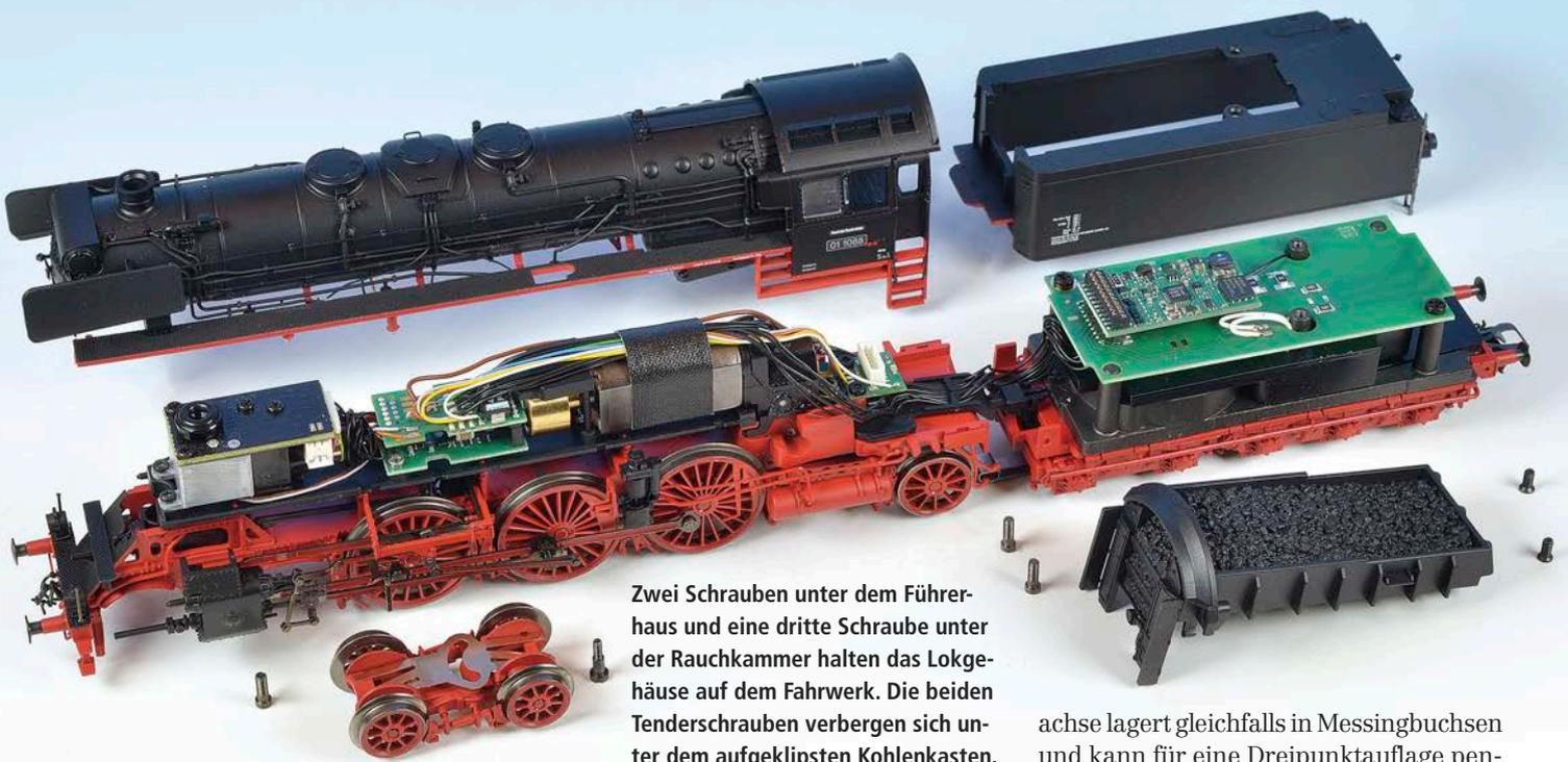
Zwei Schrauben unter dem Führerhaus und eine dritte Schraube unter der Rauchkammer halten das Lokgehäuse auf dem Fahrwerk. Die beiden Tenderschrauben verbergen sich unter dem aufgeklipsten Kohlenkasten.
