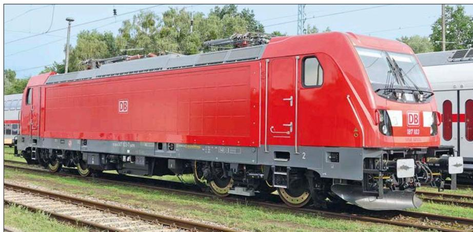
An 187 103 war ein rotes Flex-Panel mit DB-Logo verbaut. Deutlich ist die äußere Abdeckung der Plane zu erkennen. Da die DB-Loks ohne Dieselmotor bestellt wurden, fehlen Tank und Einfüllstutzen.
