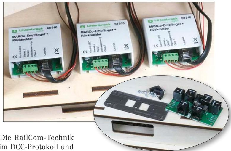
Ganz wichtig: Die RailCom-Technik funktioniert nur im DCC-Protokoll und natürlich auch nur dann, wenn sowohl die Decoder in den Fahrzeugen wie auch die eingesetzte Digitalzentrale bzw. die Empfängerbausteine RailCom-fähig sind und den existentiell wichtigen „Cut Out“ im Datenstrom unterstützen.
