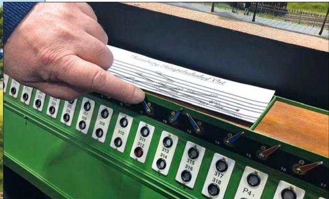
Das Elektromechanische Stellwerk Siemens & Halske Bauart 1903 in Funktion, siehe rote Störscheibe. Die Anlage wird tatsächlich mit diesem Stellwerksnachbau bedient. Solange die Weichen umlaufen, erscheint im Sichtfenster die rote Scheibe.
