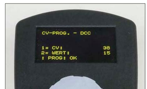
Mit einem Wert von 15 in CV 38 definieren wir die Funktionen der beiden Schaltausgänge.
