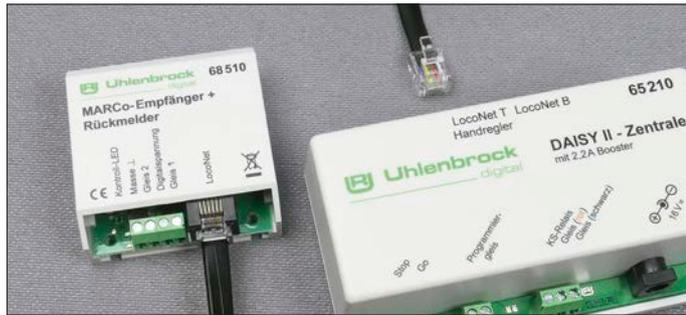
Die LocoNet-Module werden über spezielle Systemkabel mit dem LocoNet-T-Anschluss verbunden. Dazu gehören neben dem Schaltmodul auch die MARCo-Empfänger.
