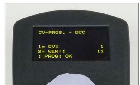
In CV 1 tragen wir direkt die kurze DCC- Adresse ein, mit der das Tor gesteuert wird.
