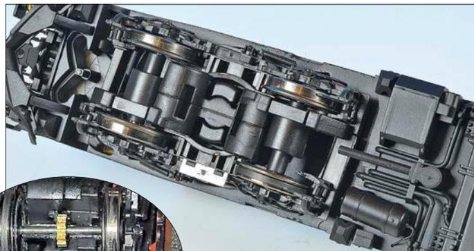
Auch die Unterseite des Rahmen und der Drehgestelle ist vorbildgerecht gestaltet. Zum Haftreifenwechsel lassen sich die Lagerschalen abklipsen. Fotos: MK, bz (1)
