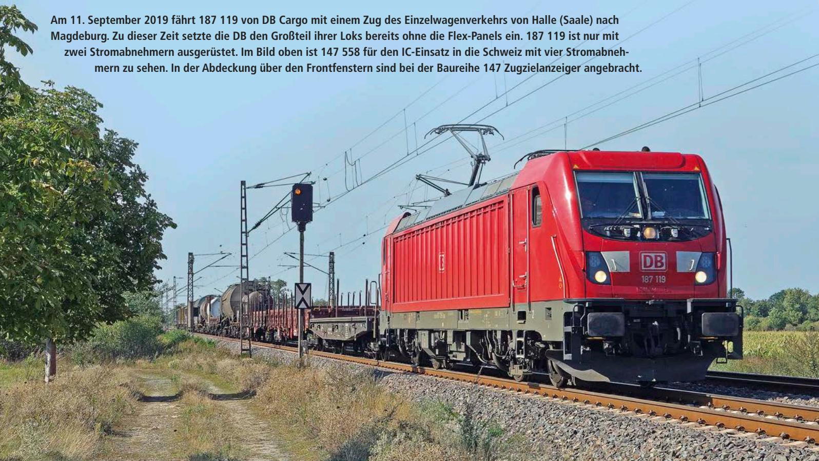
Dieselmotor und angeflanschem Generator mit zusätzlicher Pufferbatterie versehen werden. Dies ermöglicht es, Züge im Rangiermodus in nicht elektrifizierte Anschlüsse zuzustellen. Den Betreibern im Güterverkehr erspart man so zusätzlich benötigte Dieselloks. Der Dieselantrieb hat eine maximale Leistung von 290 kW. Der Tankinhalt von 400 Litern reicht im Rangiermodus für etwa 10 Stunden. Bei Bedarf kann für den Dieselmotor auch eine Funkfernsteuerung geordert werden.
