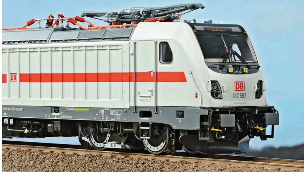
die halbversenkt angeordneten Handstangen wurden als sauber bedruckte Gravur durchgebildet – zum Vorteil für die Nachbildung ihrer Befestigungselemente. Die gekrümmten Griffstangen im Frontbereich sind wieder Extrateile. Fehl am Platz sind bei der 187 die Rückschaukameras zur Zugbeobachtung, denn es gibt an deren Stelle nur ein rundes Abdeckblech. Bei der 147 sind die Kameras hingegen korrekt.
