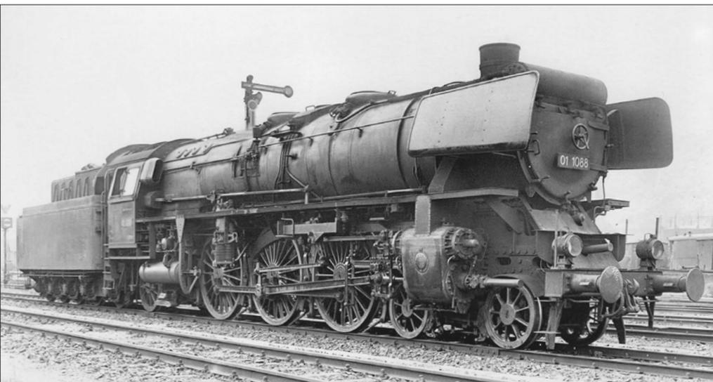
**16** Der Vorwärmer der Bauart Knorr über der Rauchkammertür gab den Loks der Baureihe 01.10 ein besonderes „Gesicht“. Martin Knaden skizzierte die Geschichte dieser Maschinen und hat zusammen mit Bernd Zöllner das soeben erschienene Modell von Märklin in der Baugröße H0 ausführlich getestet. *Foto: Carl Bellingrodt/Archiv Michael Meinhold*
