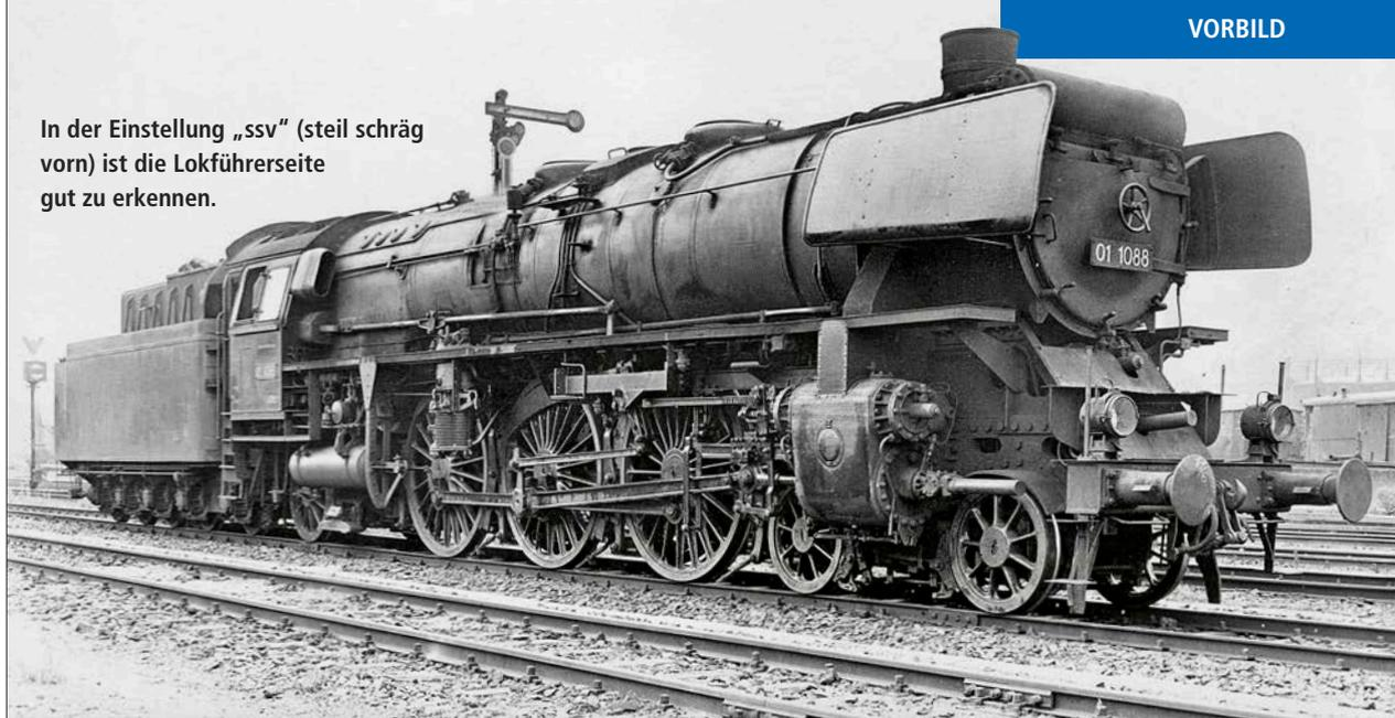
Maschinen 01 1100 bis 1105 hatten versuchsweise Rollenlager, die aber kurz nach Indienststellung wieder gegen Gleitlager ausgetauscht wurden.
