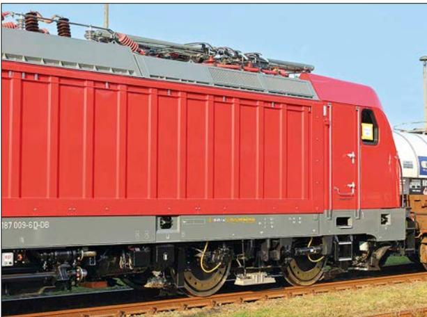
Die Baureihe 147 setzt man im Regionalverkehr bei der DB AG und beim Metronom ein. Sie verfügt über der Frontscheibe über einen Zugzielanzeiger und eine LED-Beleuchtung (oben, Berlin-Ostbahnhof am 27. Februar 2020). Im Bild links sind die gesickten Seitenwände an 187 009 zu erkennen. Die Befestigung der Flex-Panels ist mit einem Blech unterhalb der Seitenwand verdeckt.
