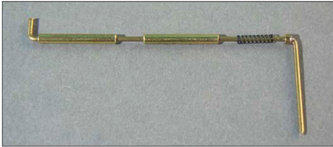
Die Entriegelung wird gemäß der Zeichnungen unten angefertigt. Für die sechs Wagen waren zwölf identische Teile anzufertigen.
