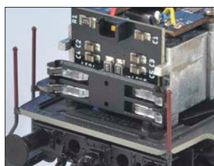
Im langen Vorbau verbirgt sich die Schnittstelle mit dem Piko-SmartDecoder XP 5.1.
