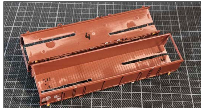
Gemäß der ganz links stehenden Zeichnung werden zwei Schlitzte in den Wagenboden gesägt.
