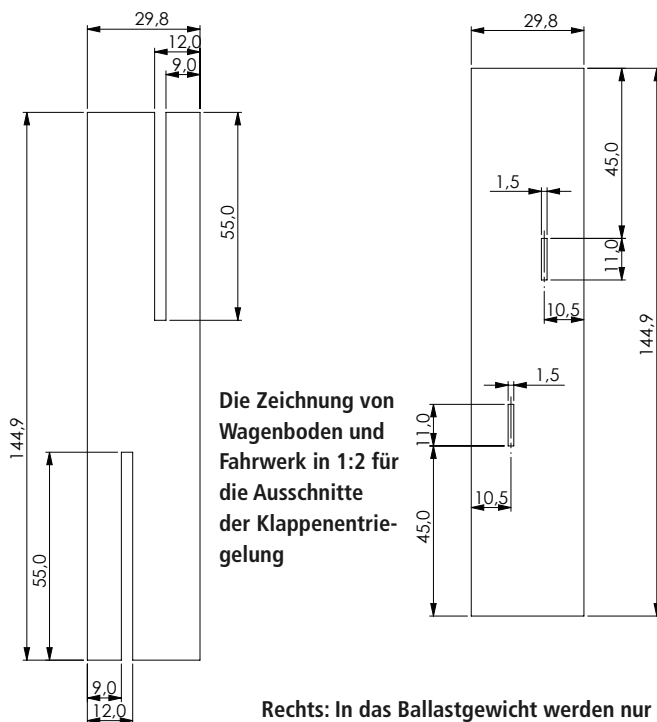
Gemäß der ganz links stehenden Zeichnung werden zwei Schlitzte in den Wagenboden gesägt.
