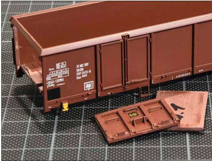
Eine knifflige Aufgabe ist das Heraustrennen der Stirnklappen mit der scharfen Klinge eines Cuttermessers.
