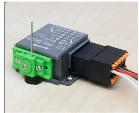
Weichen-Walter bietet u.a. auch motorische Weichenantriebe an – im Bild der Typ MP6. Die Umschaltung der Stellrichtung erfolgt bei dieser Variante über elektrische Impulse.
