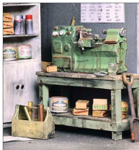
Eine solche Werkstatt dürfte Modellbauern bekannt vorkommen – die beiden Livesteamer sind jedenfalls für den Bau ihrer Loks nicht schlecht ausgestattet. Die Nachbildungen der Ständerbohrmaschine und die Drehbank wurden als stl-Dateien aus dem Internet heruntergeladen und im passenden Maßstab mit dem 3D-Drucker erstellt.
