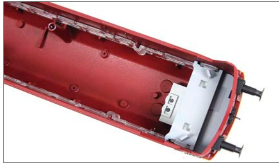
Nach Lösen von zwei Schrauben lässt sich das Gehäuse nach oben abheben. Auf der Platine befindet sich die 21MTC-Schnittstelle mit dem Sound-Decoder. Die seitlichen Lichtleiter dienen der Illumination des Maschinenraums.
