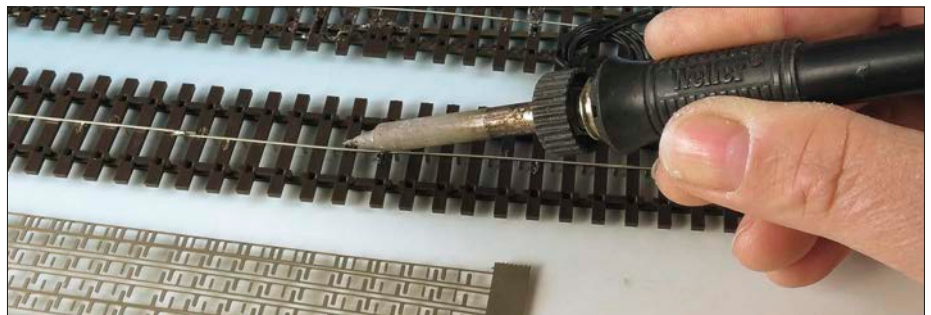
Die Punktkontakte für den Mittelleiter werden von unten mit dem LötKolben in die Kunststoffschwellen eingeschmolzen. Anschließend müssen noch die Anschlusskabel angelötet werden.
