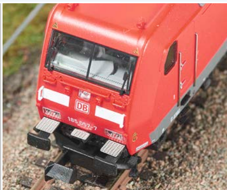
Gestalteter Führerstand, detaillierte Scheibenwischer und feingeätzte Tritte an Pikos 185er
