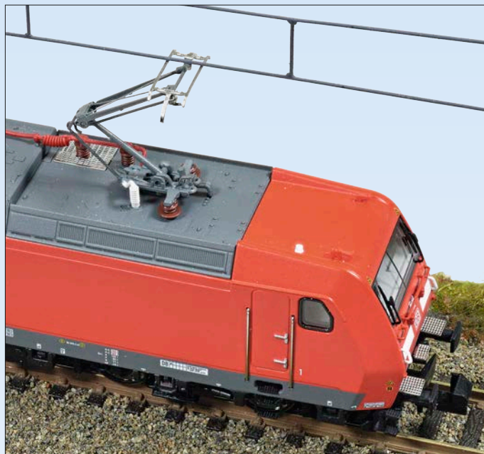
Die Stromabnehmer stehen auf Isolatoren und werden von Klammern unterm Dach fixiert. Zu erkennen sind auch zwei durch das Dach führende Druckluftleitungen. Korrekt steht einer der Isolatoren der Dachleitung auf dem Gitter der Kühlluftansaugöffnung. Fotos: gp
