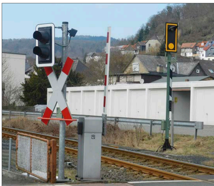
Links: Die heute gebräuchliche Bauform im kompletten DBAG Netz zeigt das Signalbild der Ex DR auf der Mastbauform der ex DB.
