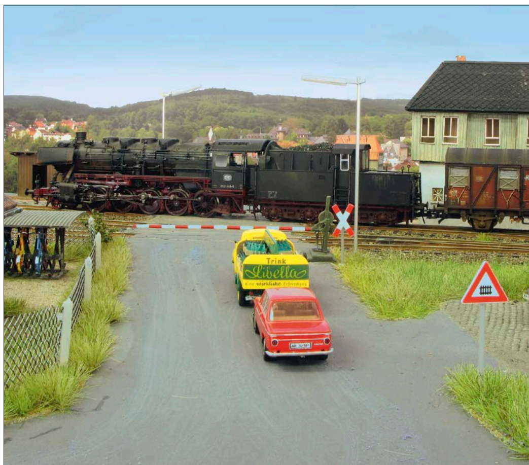
In Lantal wird der dortige BÜ mit Vollschraken ohne Behang gesichert. 052 440-5 passiert mit ihrem Ng gerade den mehrgleisigen Übergang. Das Stellwerksgebäude im Hintergrund ist sicherungstechnisch sowohl für die Schranken als auch stelltechnisch für die Weichen zuständig. Der Schrankenbaum wurde mit dem passenden Verlängerungssatz prolongiert.
