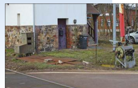
In Alt-Ranft stand die Schrankenkurbel ebenfalls vor dem Fahrdienstleiteranbau, um den entfernt liegenden Bahnübergang beobachten zu können (links). In Gommern ersetzte man die Seilzüge zur Schrankenkurbel durch einen Elektroantrieb, der kurze Seilzüge direkt an der Schranke bewegte (unten).
