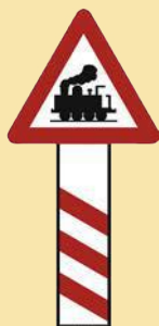
Überwachungssignal Bauart 1958: Die mit den lokführerüberwachten Bahnübergängen entwickelten Überwachungssignale wurden 1958 standardisiert und mit Rauten-tafel am Einschaltkontakt angekündigt.
