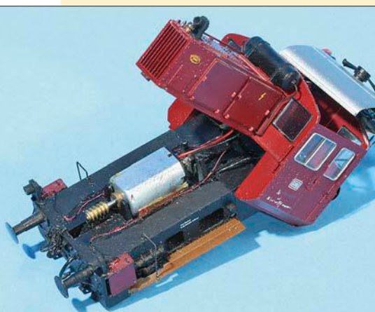
Links: Unter der Motorhaube verbirgt sich der neue Gleichstrommotor von Sol Expert – dieser ist für eine Betriebsspannung von nur 3-6 V ausgelegt.
