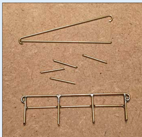
Aus Messingdrahtstücken wurde auf einem Holzstück das Geländer gelötet. Kleine Nägel fixieren als Lehre die Drahtstücke beim Löt.
