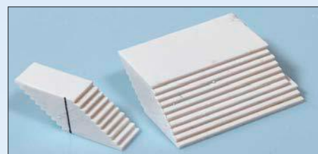
Mit einer Kleinkreissäge wurde der Block in treppenbreite Abschnitte gesägt. Der letzte Schnitt entlang des schwarzen Strichs vollendete den Treppenbau.
