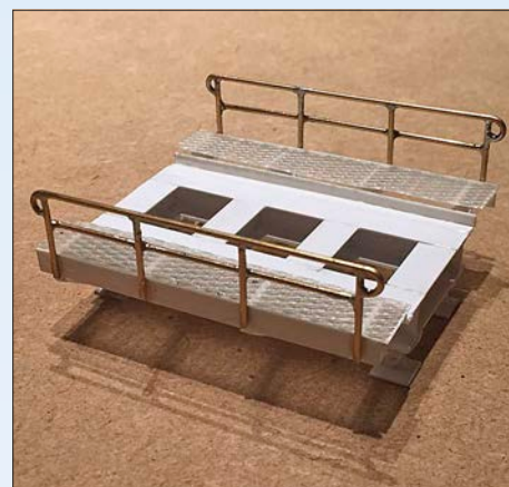
Die Geländer sind seitlich an die Träger geklebt. Vor dem Lackieren muss die Brücke noch mit einer Lauge entfettet werden.
