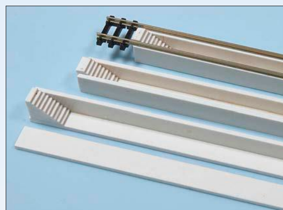
Die Grube setzt sich aus den zuvor angefertigten Treppen, einer Bodenplatte und zwei Seitenwänden zusammen.
