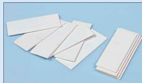
Gleichbreite Polystyrolzuschnitte wurden jeweils mit 1 mm Versatz zu einem Treppenblock aufeinandergeklebt.
