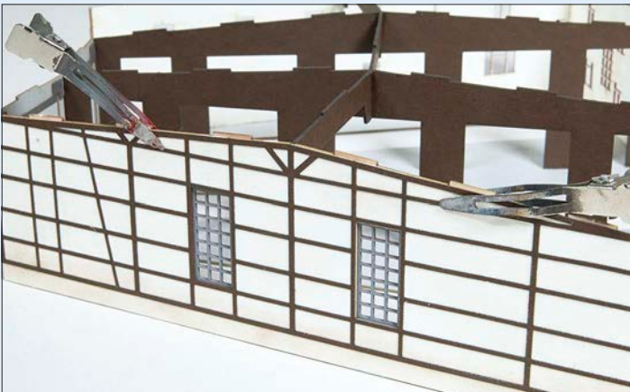
Die Außenwände wurden mit punktuell aufgetragenen Weißbleimtropfen auf die Wände des Rohbaus geklebt und mit Metallhaarklammern fixiert.
