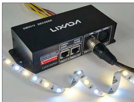
Die Tag-, Nacht- und Wetterbeleuchtung erfolgt mit LED-Streifen und einem DMX-Decoder.
