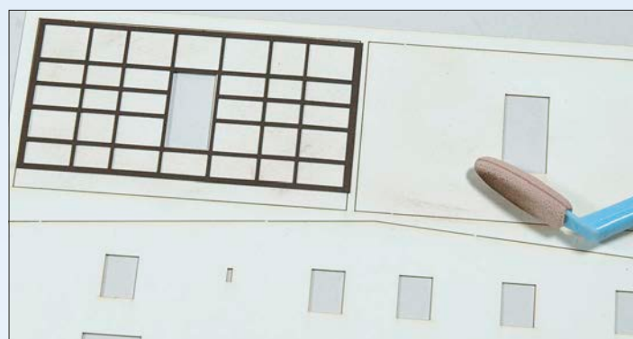
Die Bauteile des Lokschuppens sind aus eingefärbtem Architekturkarton exakt ausgelasert.
