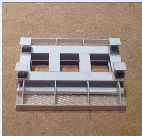
Als Laufsteg wurde Kunststoffpackband mit einer Rautenstruktur zugeschnitten und auf die Träger geklebt.
