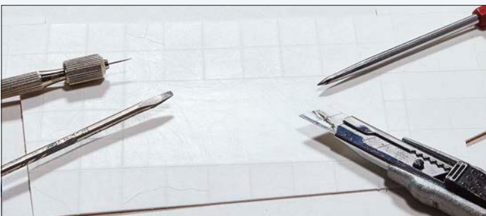
Zur Darstellung der Betonfläche wurden Fugen mit diversen Werkzeugen eingeritzt und ausgearbeitet.
