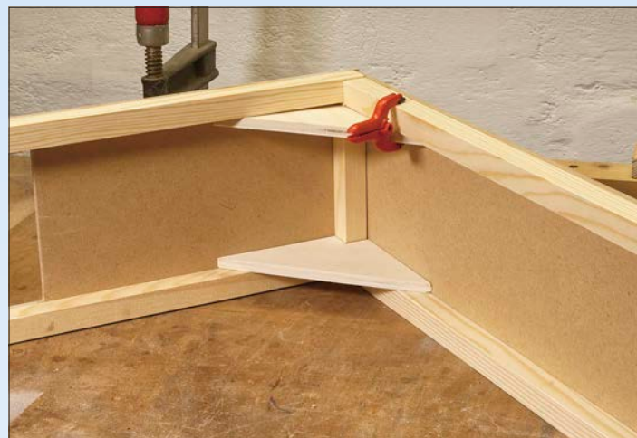
Nach dem Auftragen des Weißleims werden die Dreiecke mit Leimklammern fixiert. Die Rechtwinkligkeit ist über einen Winkel zu kontrollieren.
