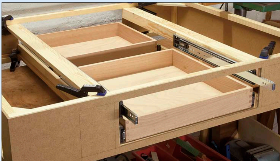
Die Vollauszüge sind an den L-förmigen Traversen verschraubt. Bei der Montage der Auszüge war die noch aufzuleimende Schubladenblende zu berücksichtigen.
