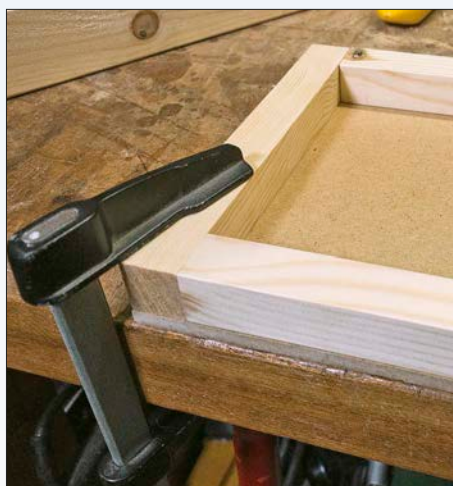
Die Leisten wurden mit Weißbleim bündig auf die MDF-Zuschnitte geleimt und fixiert.
