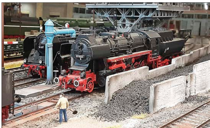
In Bahnbetriebswerken reichen einfache Wasserkräne ohne Gelenke aus, denn bei Bedarf kann man hier noch ein wenig hin- und herrangieren.
