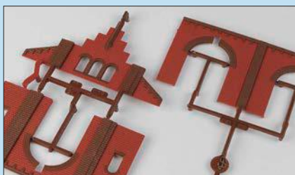
Das Zweifarben-Spritzgießverfahren bietet schon ab Werk eine saubere Farbtrennung.
