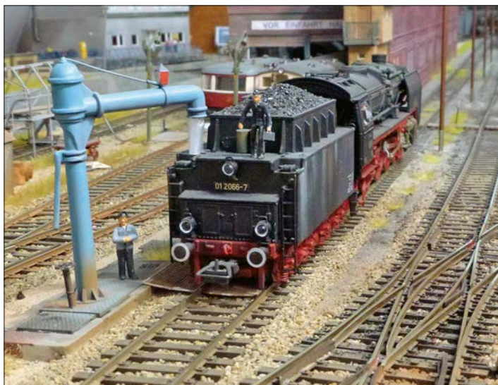
In Bahnbetriebswerken reichen einfache Wasserkräne ohne Gelenke aus, denn bei Bedarf kann man hier noch ein wenig hin- und herrangieren.
