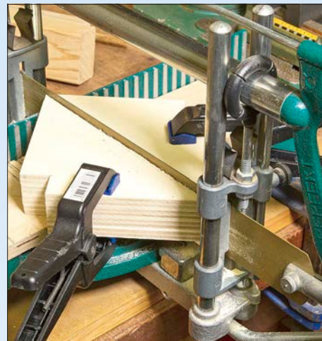
Die quadratischen Zuschnitte werden wiederum als Block mit der Gehrungssäge geteilt.
