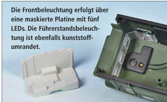
Der sehr effektive Lautsprecher hat eine besonders schmale Bauform und passte daher noch neben den Decoder. Vorn rechts der Lichtleiterrahmen für die Anfahrleuchte. Die zugehörige LED liegt auf der Unterseite der Hauptplatine.
