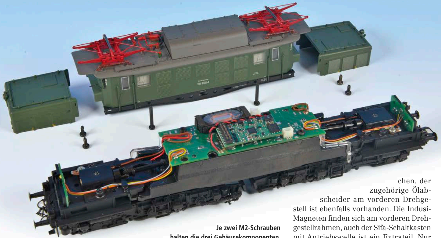
Der sehr effektive Lautsprecher hat eine besonders schmale Bauform und passte daher noch neben den Decoder. Vorn rechts der Lichtleiterrahmen für die Anfahrleuchte. Die zugehörige LED liegt auf der Unterseite der Hauptplatine.
