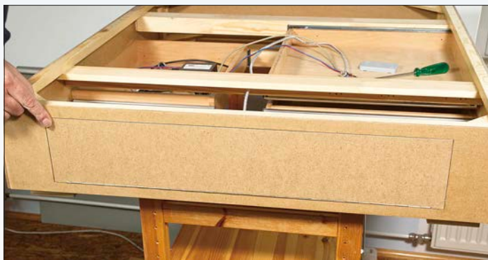
Die Klappe ist mit einem Klavierband eingebaut und schließt bündig ab. Magneten halten sie verschlossen. Sind Kinder im Haus, sollte die Klappe mit einem Einbauschloss gesichert werden.
