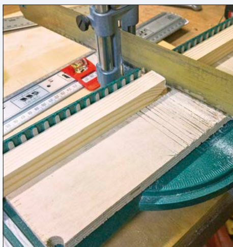
Mit einer Gehrungssäge und feinem Sägeblatt wurden die Leisten auf Maß gesägt.
