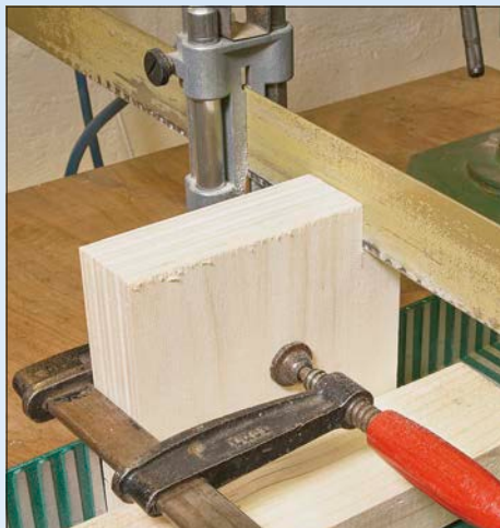
Die quadratischen Zuschnitte werden zu einem Block zusammengefasst und die Ausschnitte für die Rahmenecken mit der Gehrungssäge gesägt. Man kann die Zuschnitte auch einzeln bearbeiten.
