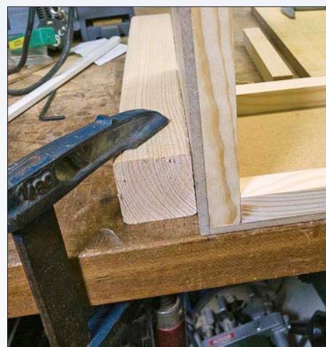
Der Blick auf die Rahmenecke zeigt, wie Leisten und MDF-Platten ineinandergreifen.
