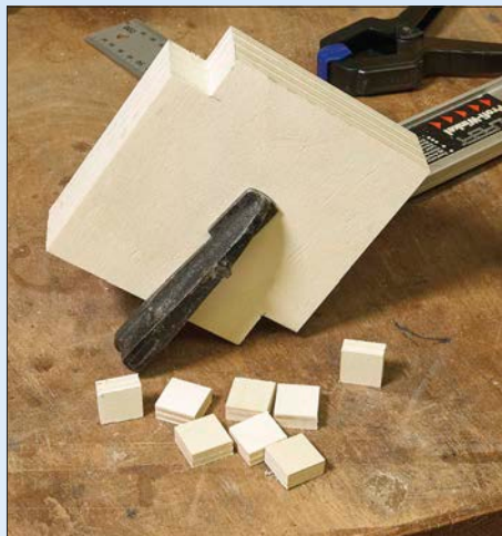
Die quadratischen Zuschnitte werden zu einem Block zusammengefasst und die Ausschnitte für die Rahmenecken mit der Gehrungssäge gesägt. Man kann die Zuschnitte auch einzeln bearbeiten.
