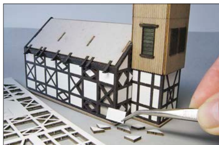
Ausgewählte Lasercut-Bausätze bestehen zum Teil aus Pappe und zusätzlichen Echtholzelementen. Sie wirken dadurch sehr vorbildnah.
