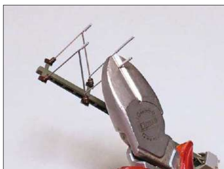
Die Ausleger für die Fahrdrahtaufnahme können je nach Aufstellort und Bedarf recht einfach mit dem Seitenschneider gekürzt werden.
