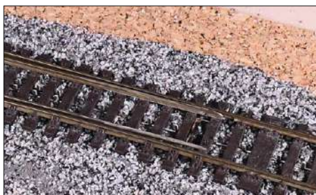
Im eingeschotterten Zustand deutet kaum noch etwas auf den unterirdischen Antrieb hin. Wie beim Vorbild bleibt das Schwellenfach mit dem Antrieb frei von Schotter!
