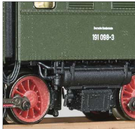
Druckluftbehälter mit Befestigungsbändern und darunter montiertem Batteriekasten
