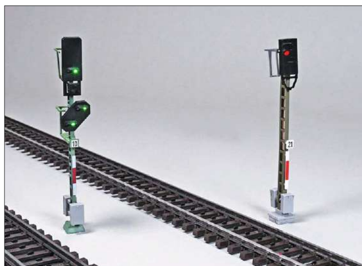
Für die Epoche IV-Modellbahn kommen die Lichtsignale der Bauart 1969 von Viessmann (links) in Frage. Ab Mitte der 80er-Jahre setzte die DB auf ihren Neubaustrecken dann vermehrt Kompaktsignale ein. Passende Modelle dazu gibts u.a. von Busch (rechts).
