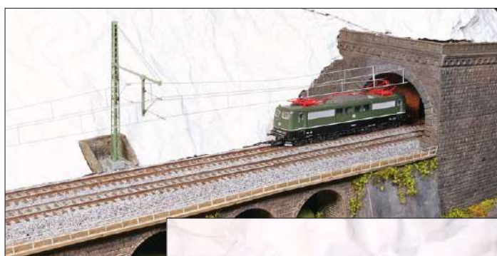
Auf der Parallelgleisstrecke des linken Teilstücks installieren wir Streckenmasten mit Doppelauslegern sowie Radspannwerke zum Nachspannen.
