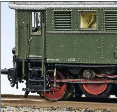
Hinter der Aufstiegsleiter verbirgt sich der bewegliche Schmierpumpenantrieb.
