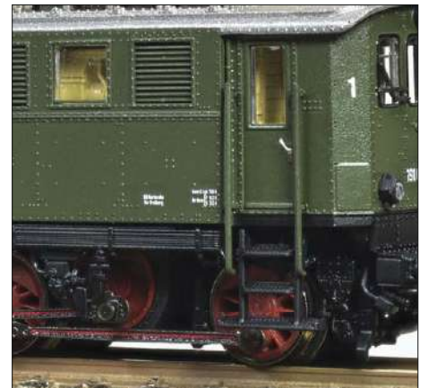
Feine Details: BBC-Sifa vor Blindwelle, Heizkabelanschluss und DB-Reflektorlampen
