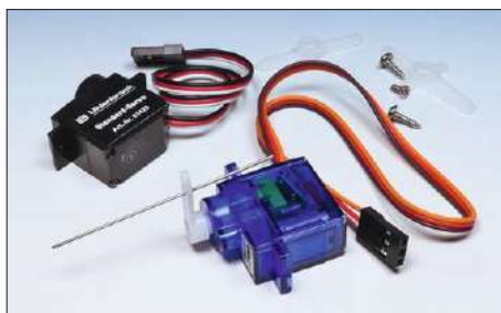
Auch der Einsatz von klassischen Modellbau-Servos als präzise Weichenantriebe ist möglich. Der kontinuierliche Anpressdruck für Federzungen erfolgt dabei über den Stahldraht.
