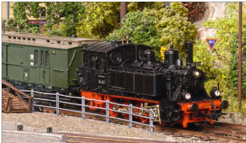
Während das Ergebnis von Motortausch und Decodereinbau nur im Fahrbetrieb erkennbar ist, präsentieren sich die mit LEDs beleuchteten Loklaternen sehr auffällig. Das Entfernen der Lampeneinsätze verbesserte den Lichtaustritt. Fotos: Gerhard Peter
