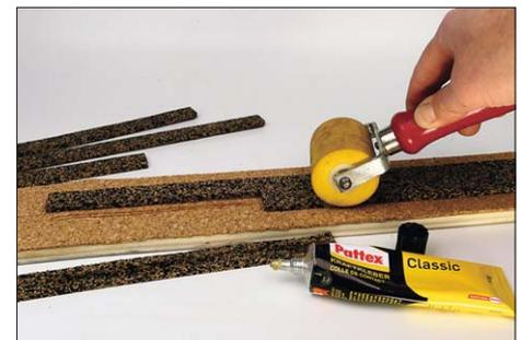
Auf diese Grundfläche kommen zwei weitere 4 mm dicke und knapp 20 mm breite Korkstreifen als Füllstoff zur Formung des Oberbaus.
