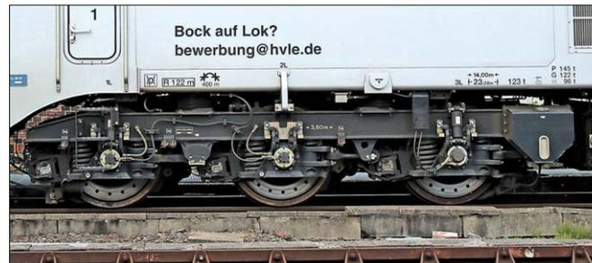
Diesel- und Adblue-Tanks sind mittig unter der Lok angeordnet. Hier sind außerdem Transformator und Batteriekästen angebracht.
