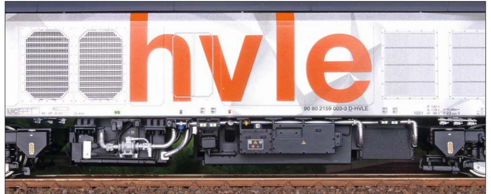
Der Transformator der Lok und die Tanks für Dieselkraftstoff und AdBlue befinden sich zwischen den Drehgestellen unter dem Lokkasten. Die Bedruckung und Lackierung der vielen angesetzten Bauteile am Modell geben das Vorbild äußerst realistisch wieder.
