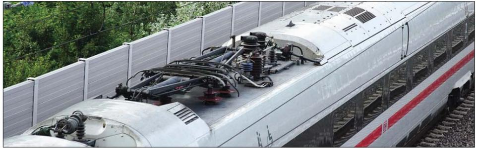
Die zwölf- und dreizehnteiligen ICE 4 sind für den Einsatz in der Schweiz zugelassen und daher mit einem Stromabnehmer mit schweizerischer Wippe ausgerüstet. Unten links ist der Wagenübergang der Hochspannungsleitung zu sehen. Im Wagen selbst ist die Leitung unsichtbar im Dach verlegt.
