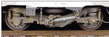
Die Triebdrehgestelle mit Außenlagerung der Radsätze sind mit Schraubenfedern für die Primärfederung und Luftfedern für die Sekundärfederung ausgerüstet. Jedes Rad wird über eine Radbremsscheibe pneumatisch abgebremst.
