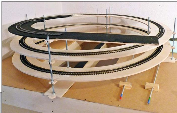
Über die beiden Gleiswendeln geht es vom Schattenbahnhof hinauf zur oberen Ebene. Sie liegt rund 25 cm höher, sodass die am hinteren Anlagenrand liegenden Gleise noch gut mit der Hand zu erreichen sind.
