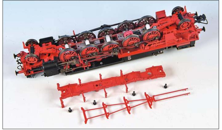
Das Getriebe wirkt auf die vierte Kuppelachse. Die sonstigen Kuppelachsen werden über die Kuppelstange mitbewegt. Vier von fünf Kuppelachsen liegen leichtlaufend in Kunststoffhülsen. Fotos: MK
