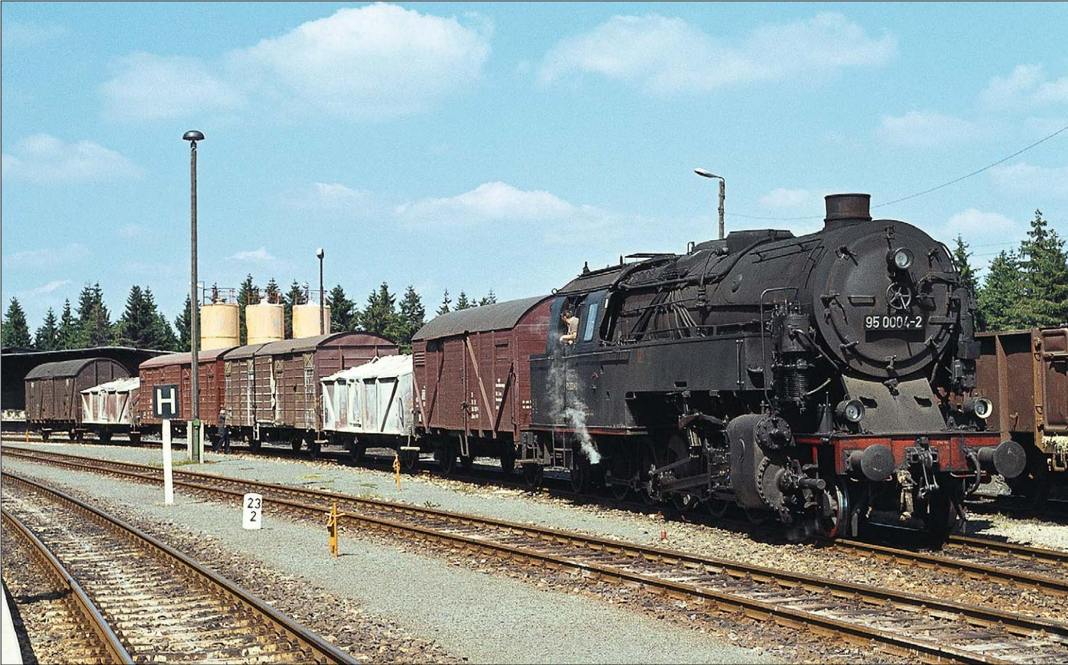
Na endlich!“ entfuhr es dem Lokführer Wolfhard Bätz, als im November 1964 mit 95 004 die erste ölgefeuerte Lok dieser Baureihe in Sonneberg auftauchte. Sie wurde dringend gebraucht. Kessel und Fahrwerk erschienen unverändert. Nur anstelle des Kohlenkastens mit Aufsatzbrettern saß jetzt ein hoher kantiger Heizölbehälter hinterm Führerhaus.
