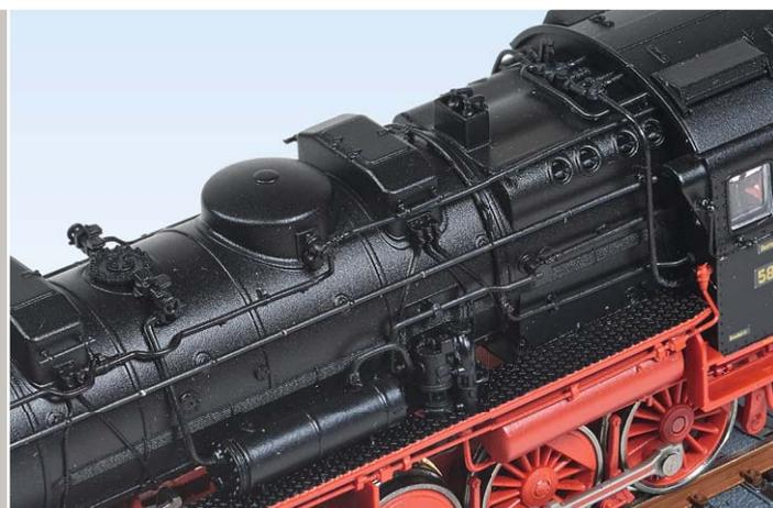
Extra montierte Leitungen zieren das plastisch nachgebildete Tenderfahrwerk. Der Regler im Führerstand ist farblich abgesetzt. Fotos: gp
