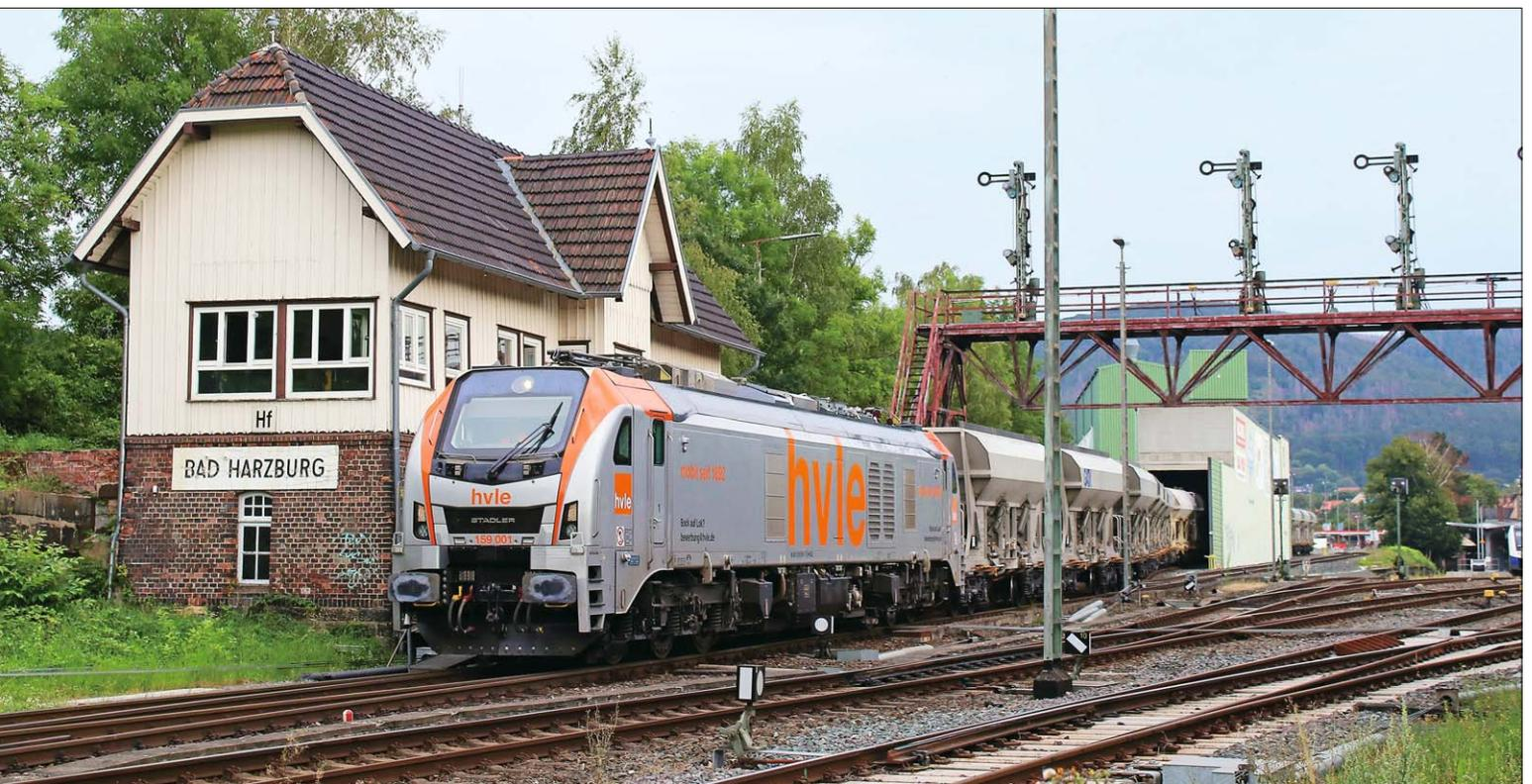
schnelle 159 eine Nennleistung von 2800 kW, im Elektromodus 7,1 MW (25 kV) bzw. 6,2 MW (15 kV). Pro Drehgestell ist ein Fahrmotorkühler vorhanden.
