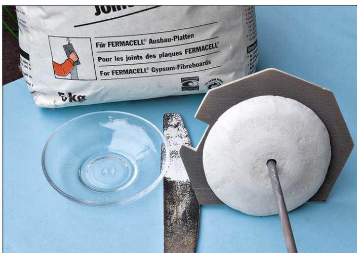
Der Hängeboden des Wassertanks wurde in einer Glasuntertasse mit Gips gegossen und nach dem Aushärten zu einer Kalotte geformt.
