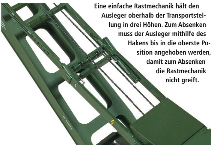
Eine einfache Rastmechanik hält den Ausleger oberhalb der Transportstellung in drei Höhen. Zum Absenken muss der Ausleger mithilfe des Hakens bis in die oberste Position angehoben werden, damit zum Absenken die Rastmechanik nicht greift.
