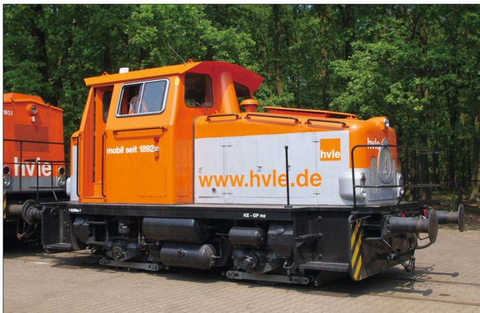
Auch bei der HVLE ist seit 2009 ein Deutz-Rangierer im Einsatz, und zwar die stärker motorisierte Variante als KG 275 B. Die Lok – im Betriebsjargon nur „Drehgestell“ genannt, weil sie kürzer ist als so manches Drehgestell der großen HVLE-Maschinen – wird mit ihrer Funkfernsteuerung für Rangierarbeiten in der Werkstatt Berlin-Johannesstift eingesetzt. Foto: Sebastian Koch
