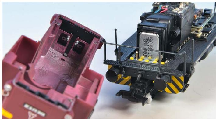
Ganz vorn im langen Vorbau liegt der winzige Lautsprecher, der trotz seines geringen Volumens einen kräftigen Klang – insbesondere beim Typhon – abstrahlt. Der Klang ist auch deshalb gut zu vernehmen, weil vorn ein hauchfein geätztes Lüftungsgitter eingesetzt ist.
