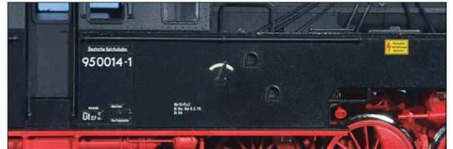
pische Schutzgitter über der Lichtöffnung, welches hauchfein geätzt ist. Die Anschriften sind inhaltlich und typografisch korrekt aufgedruckt – einschließlich der gelben Warnschilder. Wer möchte, kann sein Modell noch mit den beiliegenden Ätzschildern aufwerten. *MK*
