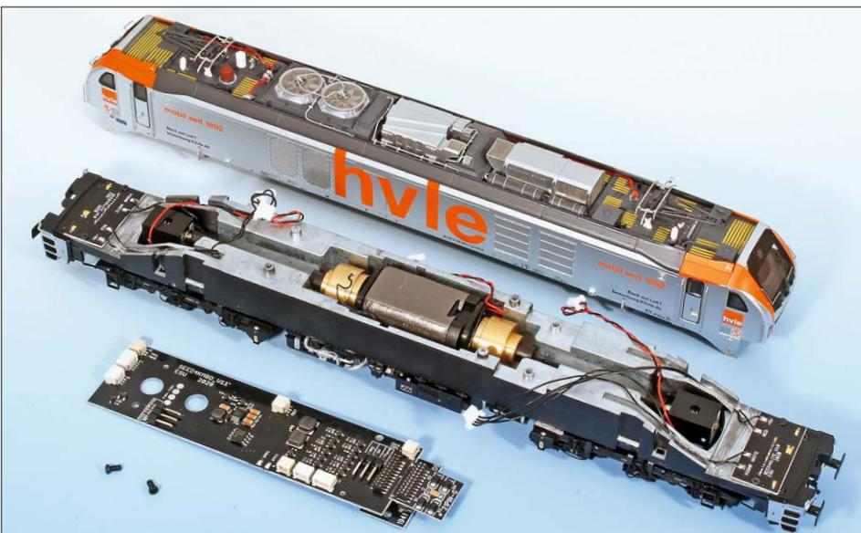
Unter der mit zwei Schrauben befestigten Platine verbirgt sich ein robuster fünfpoliger Motor, der ruhig läuft und der Lok ein sehr hohes Drehmoment verleiht. Die beiden Schwungmassen sorgen für einen langen Auslauf. Über Kardangeln werden die Schnecken in den Getriebekästen über den Drehgestellen angetrieben.
