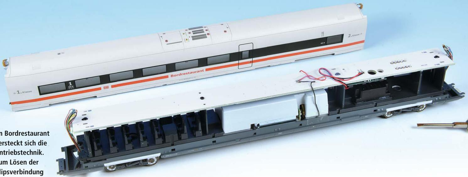
Im Bordrestaurant versteckt sich die Antriebstechnik. Zum Lösen der Klipsverbindung zwischen Gehäuse und Fahrwerk empfiehlt Märklin einen feinen Schraubendreher. Tatsächlich reicht das Abnehmen der Faltenbälge und Stirnplatten (rechts), wonach sich die Gehäuse ohne Werkzeug spreizen und abheben lassen.
