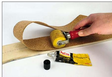
Die Holztrasse versehen wir nach der Trocknung zur Schalldämmung auf der gesamten Breite mit einer 2-3 mm dünnen Schicht Korktapete.
