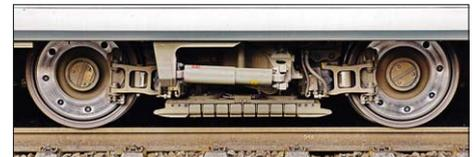
Die nicht angetriebenen Wagen des ICE 4 verfü-gen über innengelagerte Drehgestelle. Sie sind mit Magnet-Schienenbremsen, Radbremsschei-ben und einer Wellenbremsscheibe pro Radsatz ausgerüstet. Fotos: Matthias Maier
