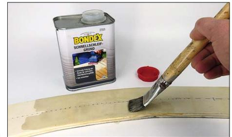
Das Trassenbrett wird zunächst mit einem Tiefgrund beidseitig ordentlich imprägniert und gegen eindringende Feuchtigkeit geschützt.
