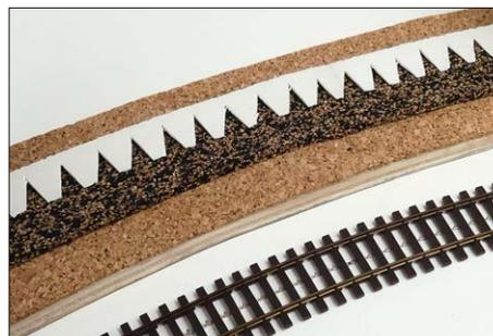
In Kurven legen wir zur Überhöhung der äußeren Schiene vor der Gleisverlegung einen keilförmig geschlitzten 2-mm-Schaumstoffstreifen unter.
