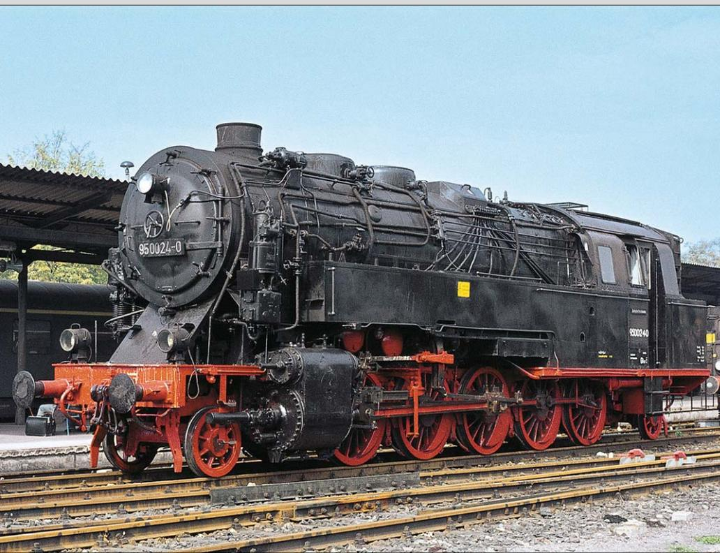
*Der Umbau von Lokomotiven der einst preußischen Gattung T 20 auf Ölhauptfeuerung brachte der Deutschen Reichsbahn in der DDR nicht nur eine spürbare Leistungssteigerung dieser wichtigen Maschinen, sondern auch eine erhebliche Verbesserung der Arbeitsbedingungen für die Heizer. Vom Einsatz profitierten vor allem die Steilrampen im Thüringer Schiefergebirge, berichtet Franz Rittig.*
