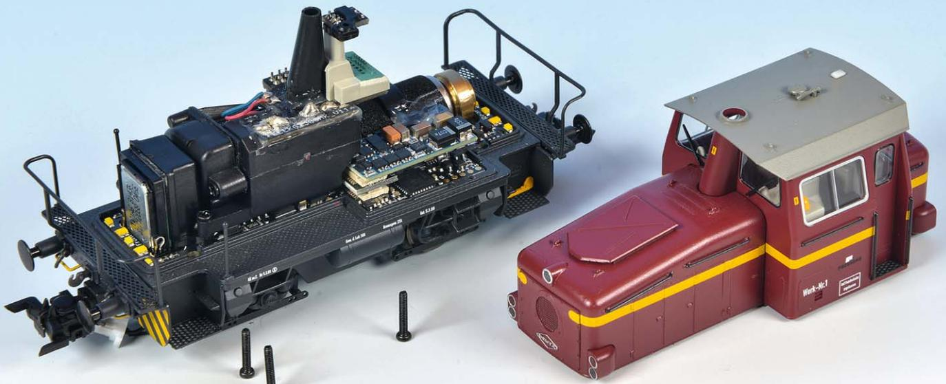
Bevor man die drei Schrauben lösen kann, muss man zuerst die Bahnräumer-Traversen und die Steckverbindungen der Kupplungsmagneten lösen. Anschließend lässt sich das Gehäuse ohne jegliches Hakeln abheben.
