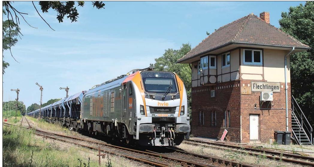
gungen für den Triebfahrzeugführer. Die HVLE-Loks sind mit Seitenfahrshaltern ausgestattet. Sie erlauben es dem Lokführer, beim Blick aus dem Seitenfenster bequem zu rangieren.
