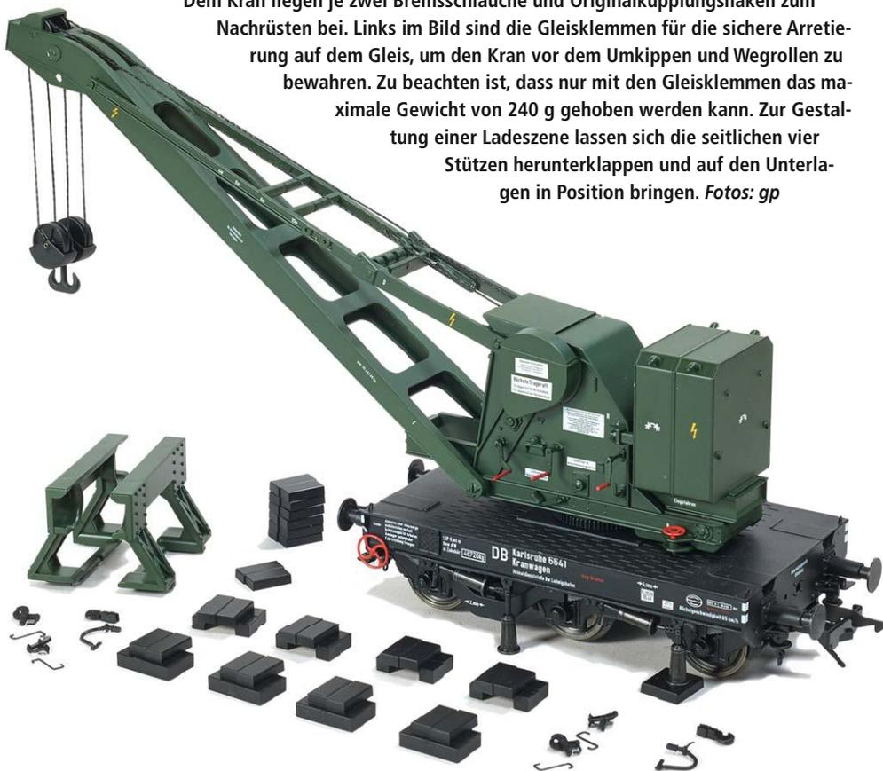
In der Spitze des Kranauslegers sind drei Umlenrollen für den funktionsfähigen Flaschenzug untergebracht. Die Achsen der Rollen werden durch Hülsen auf den Achsen mit einer Madenschraube gesichert.
