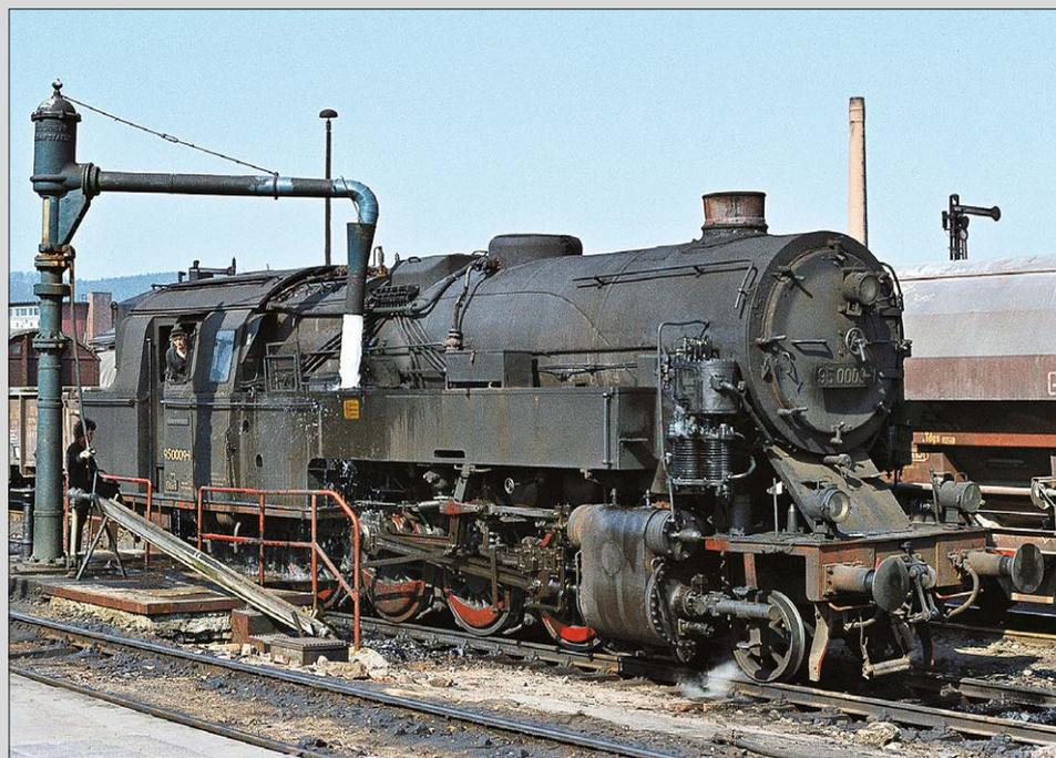
An 95 0009-1 (hier im Frühjahr 1980 am Wasserkran im Bahnhof Saalfeld) fiel auf, dass der Speisedom fehlte. Bereits wenige Monate später, Anfang Januar 1981, wurde die Maschine abgestellt.
