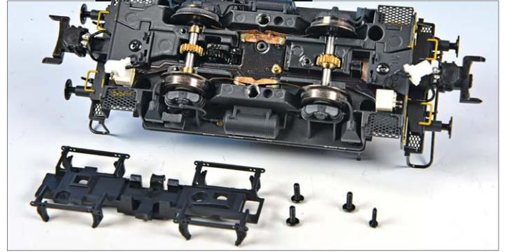
Darauf muss man erstmal kommen! Der Motor liegt außermittig neben dem Decoder und treibt die Schnecke über eine Kardanwelle an. Die Schnecke selbst liegt schräg (!) über dem Getriebe; der Eingriffswinkel zwischen Schneckenrad und Schneckengängen stimmt dennoch. Eine Kunststoffkappe sichert die Schneckenwelle in ihrem Lager.
