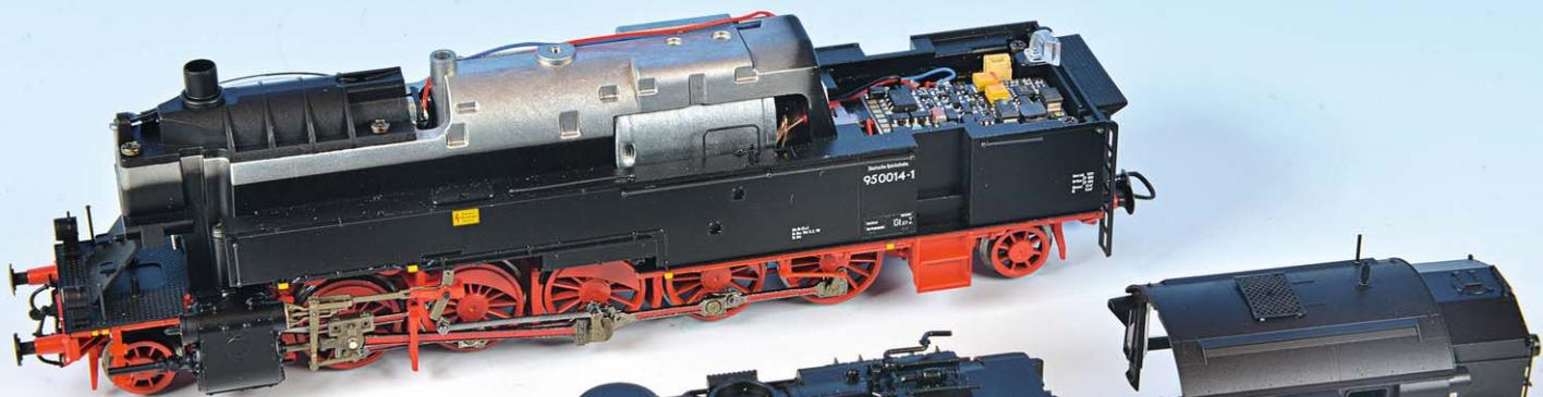
Die obere Hälfte des Führerhauses kann abgeklipst werden. Unter dem Sandkasten verbirgt sich die Halteschraube für den Kessel. Der Wasserkasten wird von vier weiteren Schrauben auf dem Fahrwerk gehalten.
