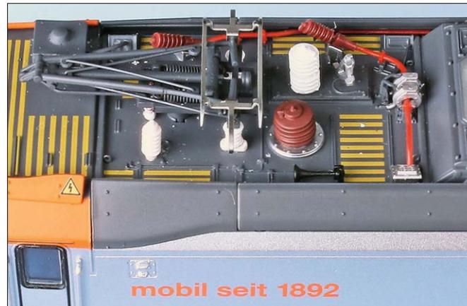
Der Dachbereich besitzt alle beim Vorbild vorhandenen Baugruppen der Hochspannungsausrüstung. Neben dem Stromabnehmer befindet sich der 25-kV-Überspannungsableiter, rechts daneben der Hauptschalter und darunter der Spannungswandler. Ganz rechts vor dem Lüfter liegen die Stromwandler.
