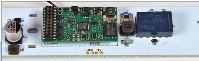
... Relais, das immer nur den in Fahrtrichtung vorn liegenden Schleifer für die Stromversorgung zuschaltet.
