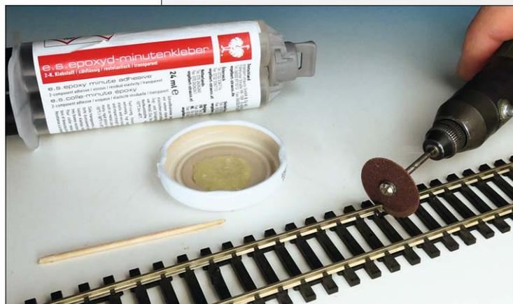
Zur Trennung der Boosterkreise und für die Belegtmeldung einzelner Strecken werden die Schienenprofile diagonal mit einer Trennscheibe eingeschnitten und die Schnitte mit Kleber aufgefüllt.
