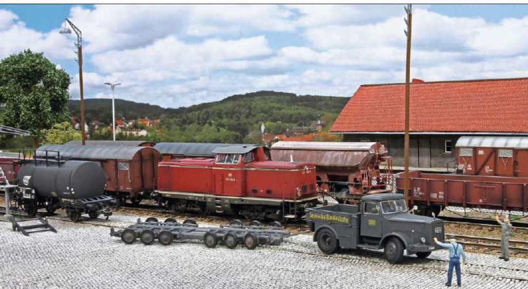
Der Straßenroller R 42 kann mit beweglicher Lenkung gebaut werden, was einer Modellbau-Meisterprüfung gleichkommt. In jedem Fall hilft es, alle Löcher vor der Montage per Hand aufzubohren, damit die Lenkbolzen in der Bohrung nicht klemmen und andererseits nicht zu viel Spiel haben.
