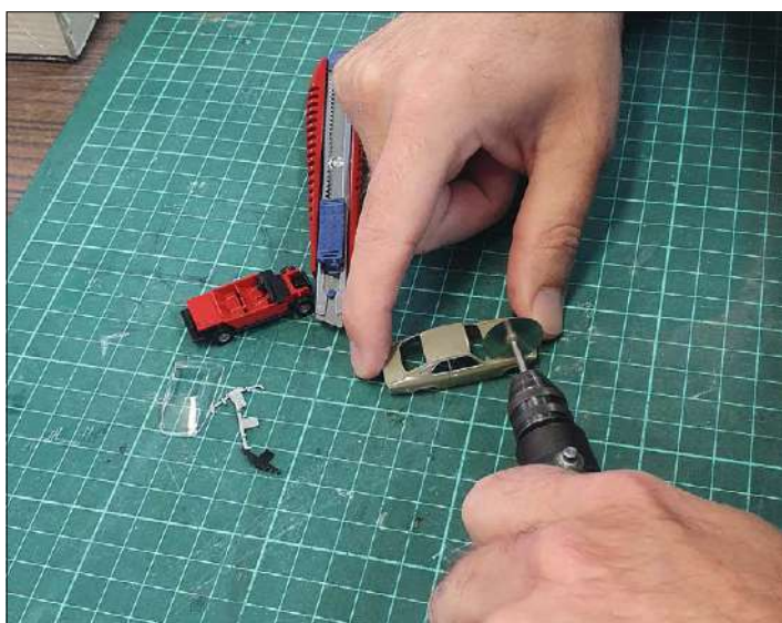
Gut fixiert geht es dem Manta an den Kragen – vielmehr an die Haube. Die Gravuren der Motorhaube werden mit einer Kleinbohrmaschine von Proxxon so weit wie möglich geöffnet. Das finale Rausschneiden erfolgt mit dem Cutter. In beiden Fällen sollte man gut auf seine Finger aufpassen und eine ruhige Hand haben.
