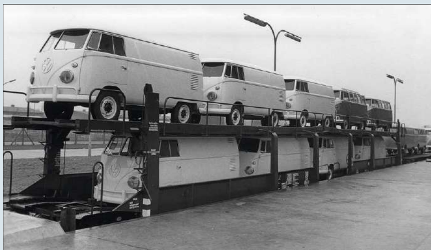
Je nach Größe der Autos waren pro Ebene vier oder fünf Wagen verladen. Kurze Käfer fanden zu fünft auf einer Ebene Platz, wobei die mittleren die Lücke zwischen den Wagenhälften überbrücken mussten, wie das Detailbild mit Off 52 zeigt. Große Fahrzeuge wie die VW-Busse konnten unten nur zu viert, oben hingegen zu fünft transportiert werden. Im Bild oben ein Offs 55, das Bild unten zeigt einen Offs 60. Fotos: Archiv Michael Meinhold
