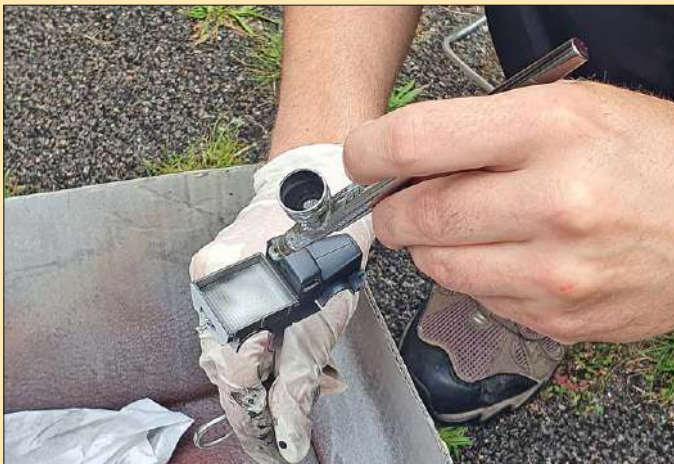
Nach dem Verdünnen werden die Weinert-Farben mit der Spritzpistole in zwei Schichten auf die grundierten Modelle gesprüht. Auch die Felgen sollten in der Wagenfarbe lackiert werden. Die Räder werden anschließend mattschwarz bemalt. Zum besseren Halt während des Sprühens sind die Felgen auf Klebeband befestigt. Tipp: Solche Kleinteile lassen sich auch gut auf Zahnstocher spießen und zum Trocknen in Styroporblöcke stecken.
