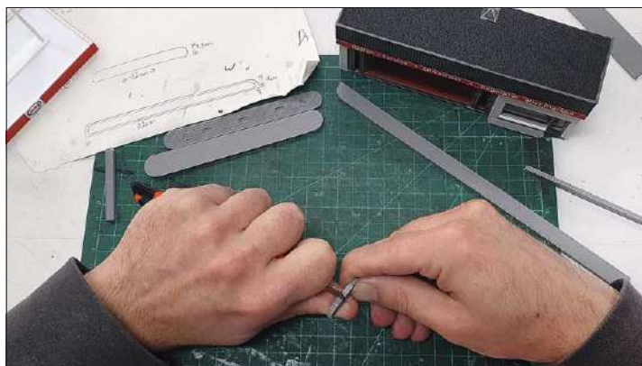
Die Tankinsel und auch der Bereich vor dem Gebäude werden aus 3 mm dicken PVC-Platten aus dem Baumarkt passend ausgeschnitten.
