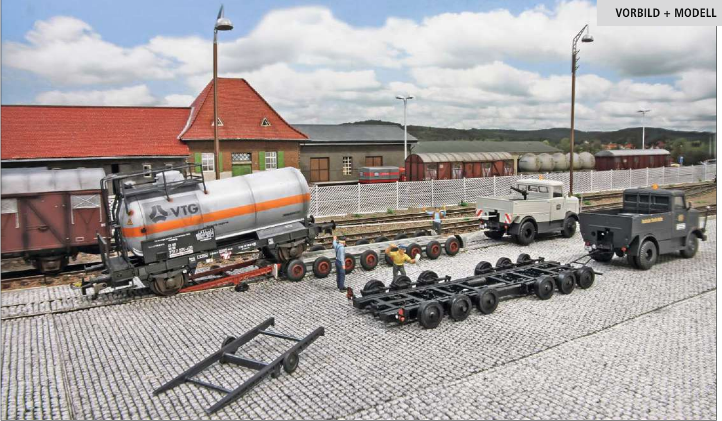
So könnte es sich in Hanau 20 Jahre später abgespielt haben. Hier wird ebenfalls ein Kesselwagen über die Auffahrrampe auf einen Straßenroller der Bauart Culemeyer LR 40/9 gezogen. Im Vordergrund wartet schon der nächste Straßenroller samt Zugmaschine auf den kommenden Einsatz. Fotos: HM
