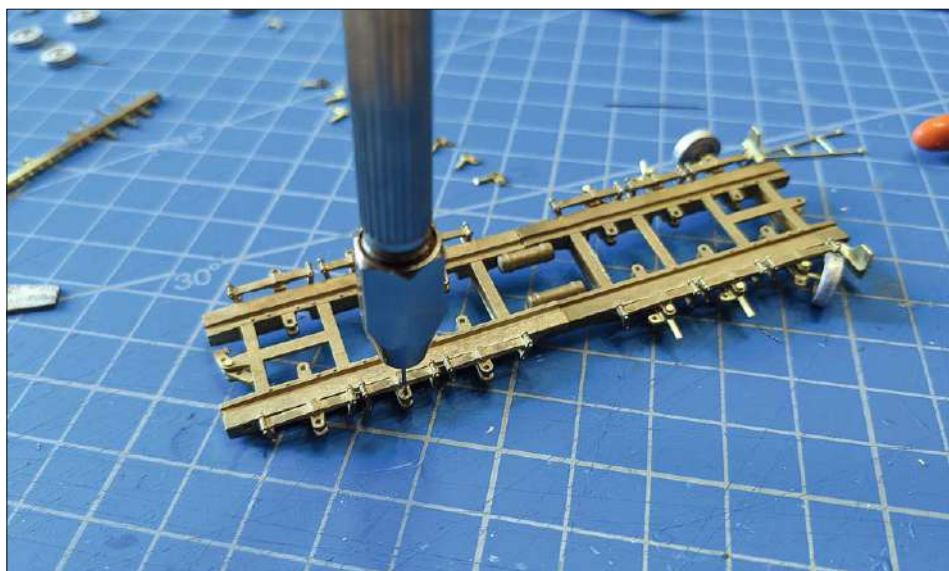
Der Straßenroller R 42 kann mit beweglicher Lenkung gebaut werden, was einer Modellbau-Meisterprüfung gleichkommt. In jedem Fall hilft es, alle Löcher vor der Montage per Hand aufzubohren, damit die Lenkbolzen in der Bohrung nicht klemmen und andererseits nicht zu viel Spiel haben.
