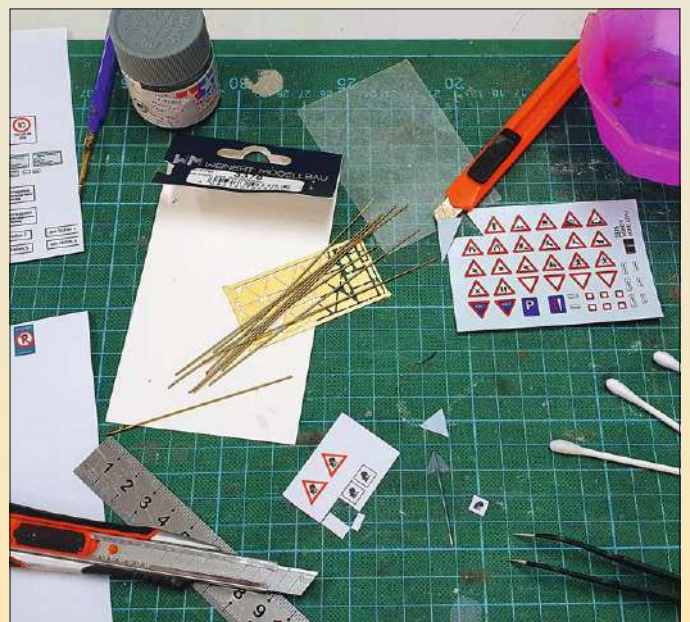
Das Gefahrzeichen vor eingeschränktem Lichtraumprofil vor allem für hohe Lkws gibt es in keinem Schildersatz der einschlägigen Hersteller. Man muss das Gefahrzeichen selber ausdrucken und ankleben.
