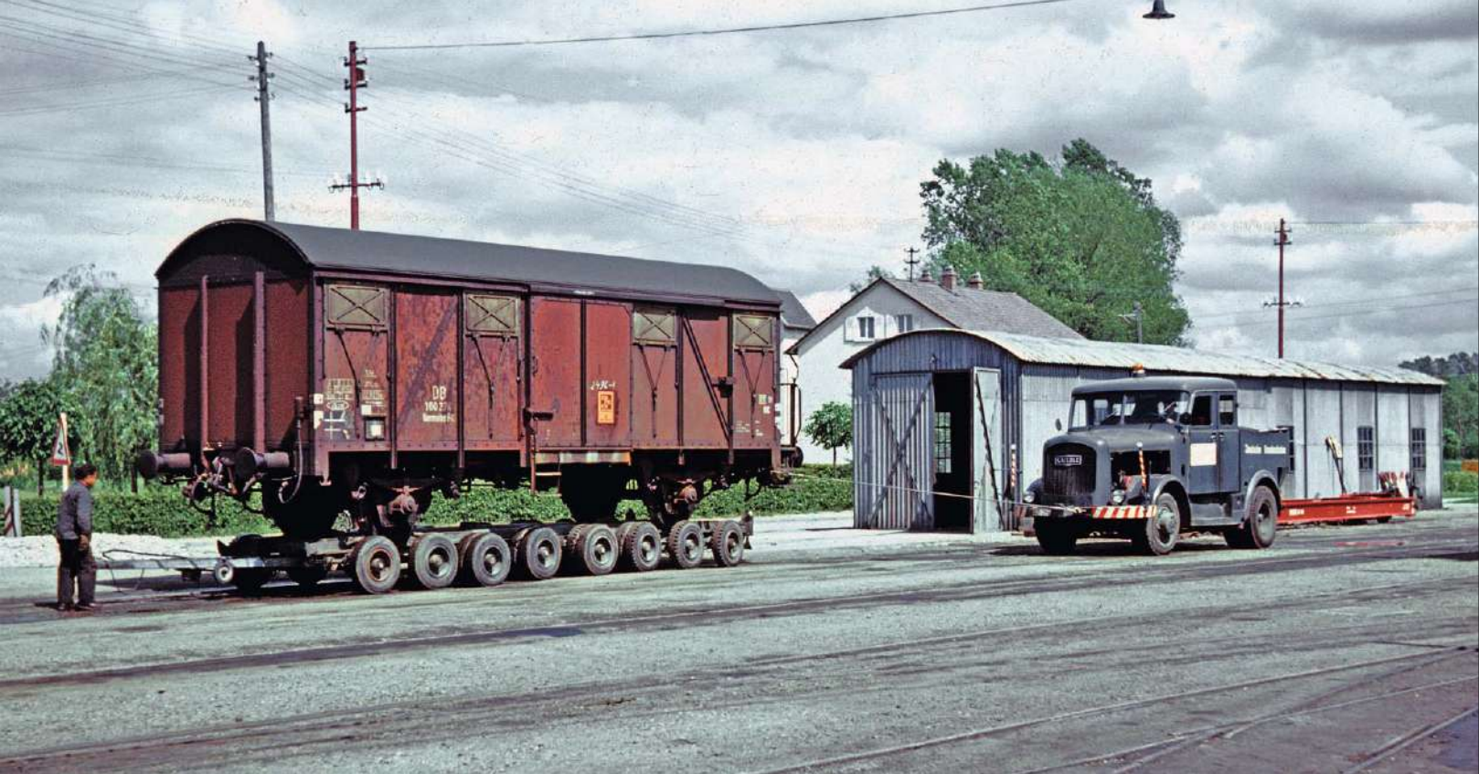
Im Bahnhof Schwarzach/Baden der Mittelbadischen Eisenbahnen wurde dieser gedeckte Wagen im Jahr 1970 rangiert. Ein Kaelble KV 631 zieht hier Wagen und Roller an den roten Rollwagen – das „fahrbare Absetzgleis“ – im Hintergrund. Foto: Dieter Junker, Sammlung: Eisenbahnstiftung
