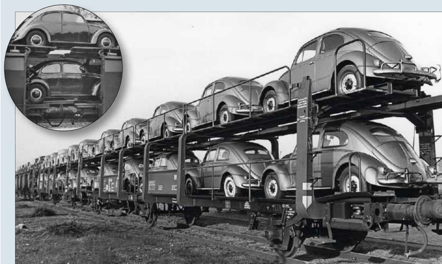
Je nach Größe der Autos waren pro Ebene vier oder fünf Wagen verladen. Kurze Käfer fanden zu fünft auf einer Ebene Platz, wobei die mittleren die Lücke zwischen den Wagenhälften überbrücken mussten, wie das Detailbild mit Off 52 zeigt. Große Fahrzeuge wie die VW-Busse konnten unten nur zu viert, oben hingegen zu fünft transportiert werden. Im Bild oben ein Offs 55, das Bild unten zeigt einen Offs 60. Fotos: Archiv Michael Meinhold
