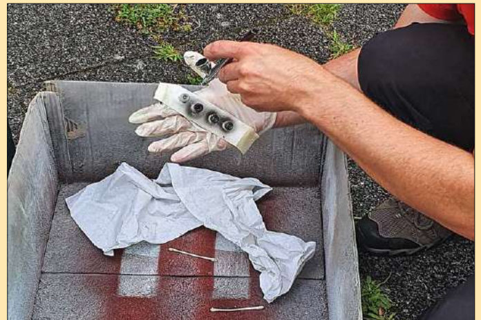
Nach dem Verdünnen werden die Weinert-Farben mit der Spritzpistole in zwei Schichten auf die grundierten Modelle gesprüht. Auch die Felgen sollten in der Wagenfarbe lackiert werden. Die Räder werden anschließend mattschwarz bemalt. Zum besseren Halt während des Sprühens sind die Felgen auf Klebeband befestigt. Tipp: Solche Kleinteile lassen sich auch gut auf Zahnstocher spießen und zum Trocknen in Styroporblöcke stecken.
