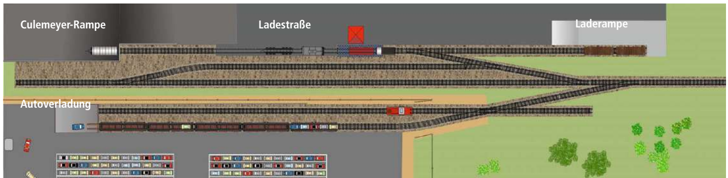
Der Übersichtsplan des gesamten Gleisfeldes zeigt, wie das Umfeld der Verladung aussieht und über welche Gleise die Rangiervorgänge später laufen werden. Zeichnung: Horst Meier
