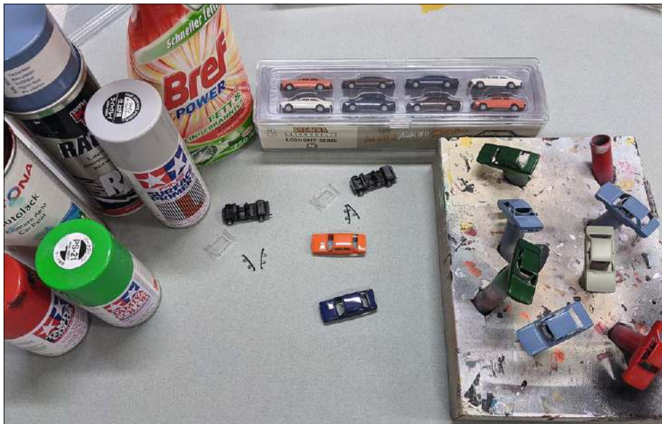
Die Mischung macht's. Die zerlegten Modelle werden nach gründlichem Entfetten mit den Farben von Tamiya gesprüht. Die Karosserien können auf dünne Röhrchen gesteckt gut trocknen.
