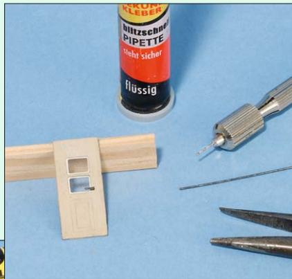
Die Verglasung aus Kunststoff muss passend zugeschnitten werden. Als Verbindung der unterschiedlichen Werkstoffe dient ein Alleskleber.
