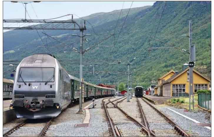
Der alte Hausbahnsteig vor dem Empfangsgebäude ist heute noch existent und dient als Ausstellungsgleis für das Museum im Empfangsgebäude. Der Bahnhof ist mit robusten Fahrleitungs-Quertraversen überspannt. Der Betrieb wird mit Sechs-Wagenzügen und je zwei El 18 abgewickelt.
