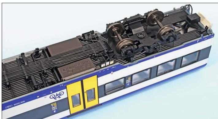
Unter dem Wagen sind Luft- und Steuerleitungen durch Stahldrähte freistehend nachgebildet. Auch die quer zur Wagenlängsachse verlaufenden Stellstangen der Bremsarmaturen findet man korrekt am ASM-Modell. Die Drehgestelle sind angeschraubt.
