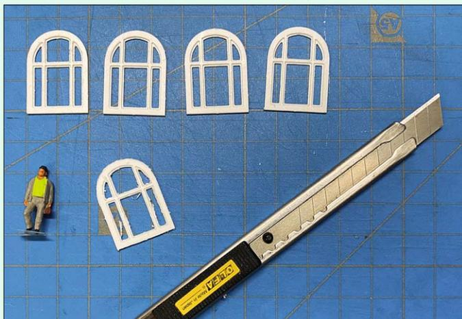
Die gefrästen Fenster sind sehr filigran. Nach dem Fräsen müssen die vielen stehengebliebenen Grate sorgfältig mit Kunststoffbürsten und einem Cutter entfernt werden.
