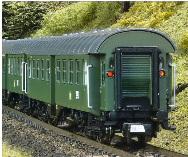
Die Ausstattung mit einer LED-Inneneinrichtung bringt es mit sich, dass mit korrekter Zugschluss-signalisierung gefahren werden kann.
