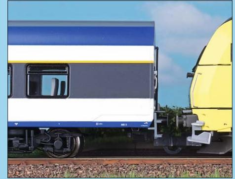
Zum Kuppeln der Wagen untereinander liegen unterschiedlich lange Kupplungsdeichseln bei. Bei Verwendung der kürzeren Deichseln bleibt ein kleiner Spalt zwischen den Wagenübergängen (links). Den Endwagen kuppelt man über einen Normschacht mit der Lok. Am Endwagen sind Federpuffer verbaut. Gut zu erkennen sind die spaltenfrei sitzenden Fenster mit ihrem schwarzen Rahmen.
