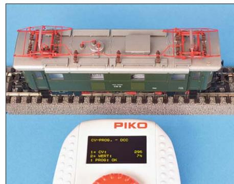
Pikos SmartBox light besitzt einen Programmiergleis-Anschluss. Mit dem Handregler SmartController light lässt sich dieser Anschluss nutzen, um Konfigurationsvariablen (CVs) zu lesen und zu schreiben. Fotos: Heiko Herholz
