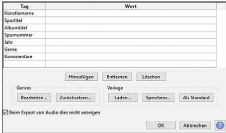
Keine Metadaten! Beim Exportieren der WAV-Dateien muss unbedingt der Haken unten links gesetzt werden, damit die Datei für das IntelliSound-4-Modul nutzbar ist. Audacity merkt sich diese Einstellung.
