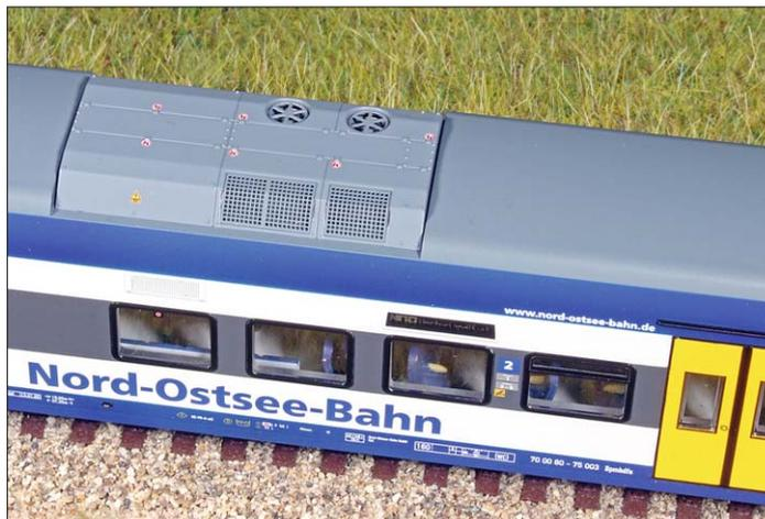
Mittig auf den Wagen sind die bedruckten Klimageräte nachgebildet. Korrekt ist dazu die Einbaumulde im Dach vorhanden. Lüfterabdeckungen und Gitter in den Klimageräten bestehen aus lackiertem Messingätzblech. Unter den Klimageräten sind in den Seitenwänden die Luftsaugungen fein eingraviert.
