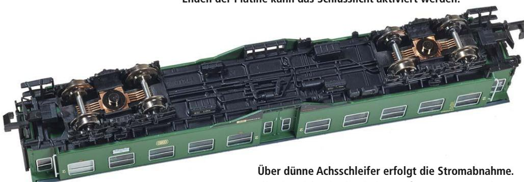
Über dünne Achsschleifer erfolgt die Stromabnahme. Das Untergestell zeigt sich mit plastisch angeformter Bremsanlage.
