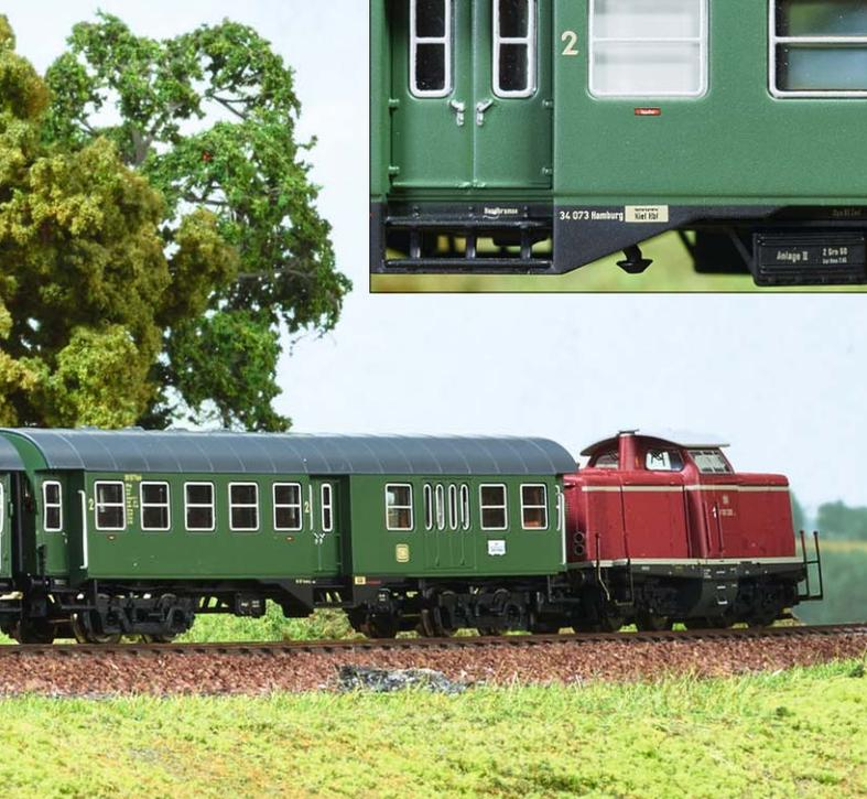
Beachtenswert sind auch die in die Einstiege gedruckten Hinweisanschriften für die Handbremse. Die Langträger mit den daran befestigten Kästen für die Bordelektrik befinden sich korrekt in Verlängerung der Puffer. *Modellfotos: gp*
