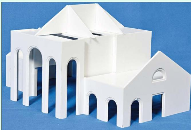
Das Grundgerüst des neuen Gebäudes wird aus den gefrästen Teilen mit Kunststoffkleber fixiert und mit Zwischendecken stabilisiert.
