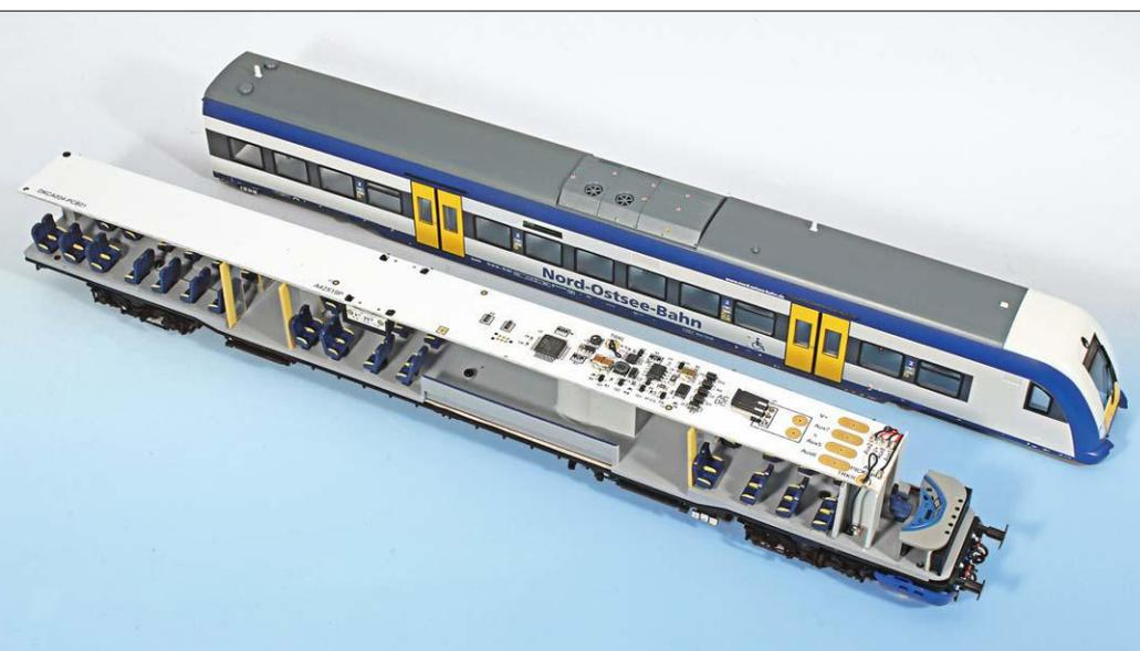
Durch Spreizen von sechs Rastnasen lassen sich die Wagengehäuse abheben. Im Inneren sind Böden, Raumteiler und Sitze lackiert. Die Beleuchtung ist auf einer Platine untergebracht. Mit Kontakten werden die LEDs über dem Führerstand unter der Gehäusedecke versorgt. Fotos: Sebastian Koch
