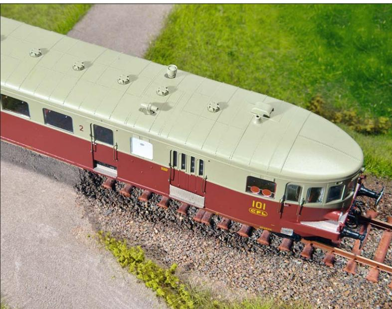
Aus der Vogelperspektive ist das Dach mit der Blecheindeckung und den Nietreihen, den Lüftern und sonstigen Details gut zu erkennen. Der aus der elliptischen Kopfform hervorstehende Rahmen ist mit Riffelblech als Rutschschutz belegt. Fotos (4): MK
