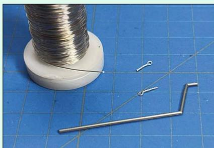
Die Regenfallrohre und Dachrinnen stammen aus einem Set von Auhagen. Die Fallrohre können prinzipiell direkt an die Fassade geklebt werden. Besser sieht es jedoch aus, wenn man auch die Rohrschellen nachbildet. Dazu eignet sich beispielsweise 0,4 mm dicker Silberdraht; mit etwas Sekundenkleber werden die Schellen in Bohrungen in der Fassade fixiert.
