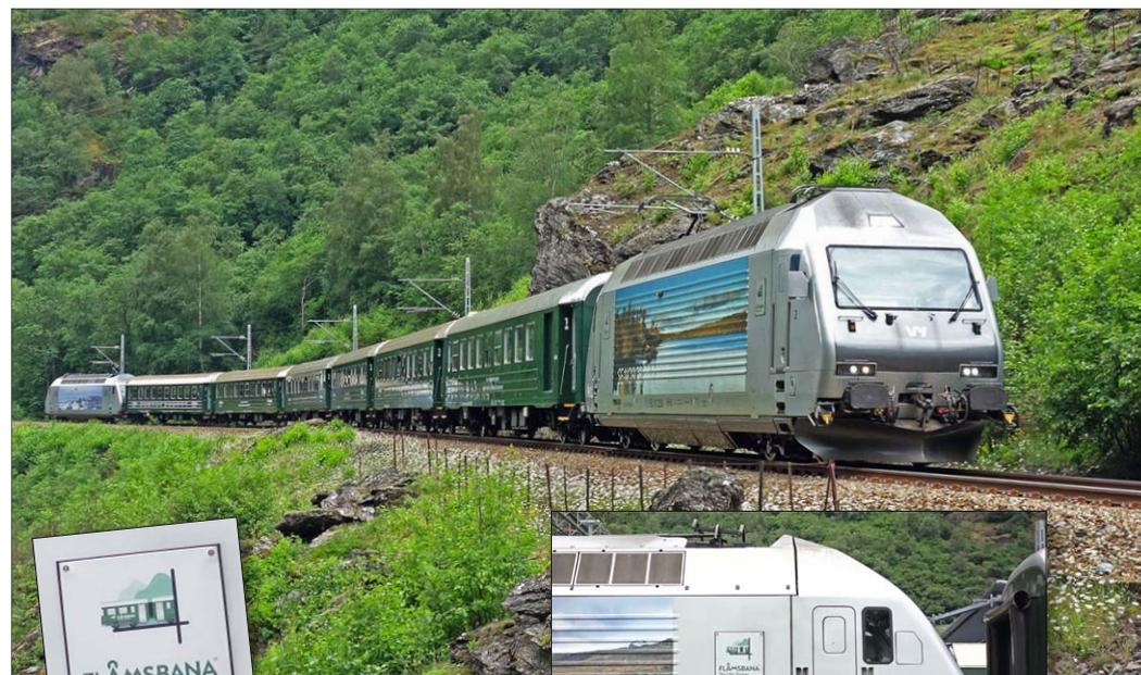
Heute wird die Flåmbahn mit Elloks vom Typ EL 18 aus schweizerischer Produktion betrieben. Die Züge sind beidseitig mit einer Lok bespannt. Für ihren Einsatz auf der Flåmbahn tragen die Loks auf den Seitenflächen neben den Türen anschraubbare Tafeln mit dem Logo der Bahn. Seit April 2019 firmiert die Personenverkehrssparte der Norwegischen Staatsbahn unter dem Markennamen Vy, der an den Loks auch angeschrieben ist.
