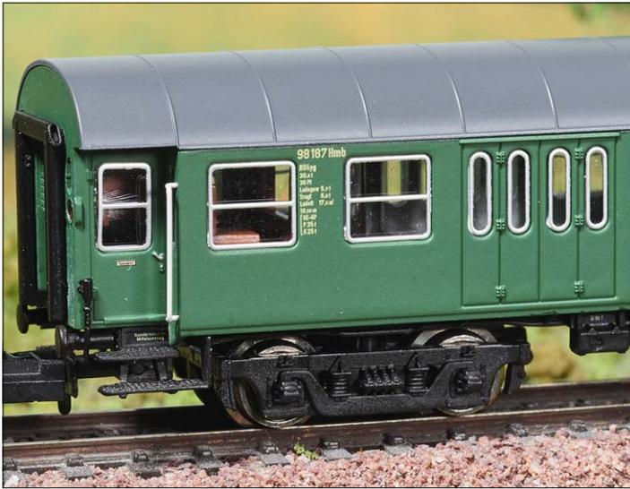
Nur der Halbgepäckwagen BD4yg-56 ist im Modell korrekt mit den amerikanischen Schwanenhalsdrehgestellen ausgerüstet.
