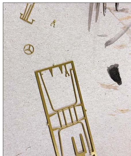
Die Ätzteile werden mit dem Cutter vorsichtig aus dem Rahmen gelöst und die Reste der Haltestege mit einer feinen Feile entfernt.
