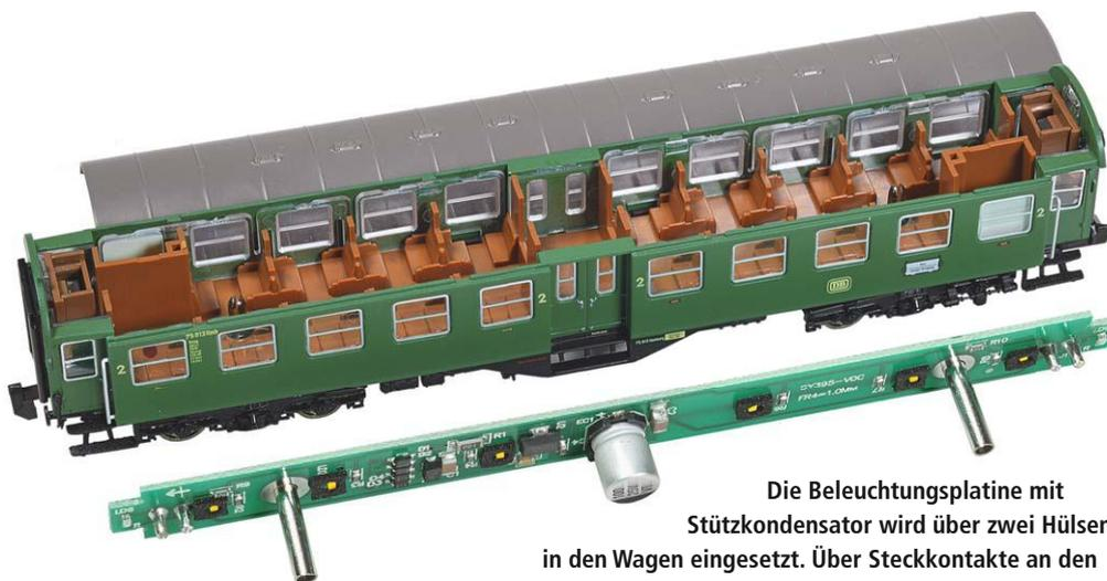
Die Beleuchtungsplatine mit Stützkondensator wird über zwei Hülsen in den Wagen eingesetzt. Über Steckkontakte an den Enden der Platine kann das Schlusslicht aktiviert werden.
