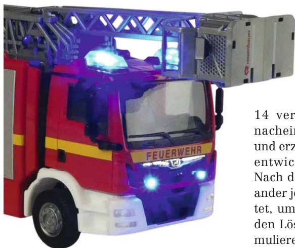
Mit dem Tams-Lichtcomputer LC-NG-06 lassen sich auch moderne Einsatzfahrzeuge mit funktionierenden Blaulichtern und Frontblitzern bzw. „Straßenräumern“ ausrüsten. Fotos: Maik Möritz
