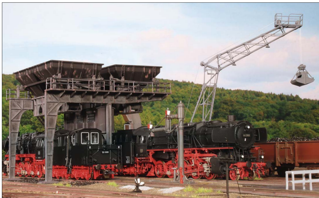
Zentrales Element der Behandlungsanlage ist der Kohlenhochbunker. Hier ein Modell von Faller. Aus den vier Bunkertaschen werden die Loks durch Schwerkraft bekohlt. Die Befüllung der Bunkertaschen erfolgt hier durch einen Weinert-Eisenbahngleiskran mit hohem Gitterausleger.
