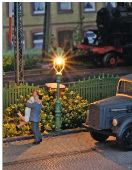
Nicht nur moderne Straßenleuchten sind mit dem LC-NG-04 ansteuerbar. Auch für nostalgische Gaslaternen ist ein Ablauf vorgesehen.
