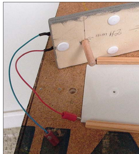
Den Drehpunkt bildet ein 6-mm-Holzdübel mit passendem Loch in der Grundplatte.
