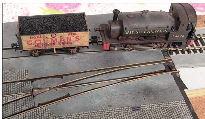
Bei der Pflasterung im Bereich der Weiche muss besonders sorgfältig gearbeitet und immer wieder getestet werden, damit die Fahrzeuge ohne Zwängen der Spurkränze rollen können.
