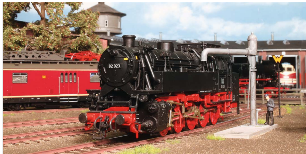
Von der Drehscheibe führt ein Gleis direkt in den Bahnhof, sodass ausfahrende Loks nicht die Behandlungsgleise im Bw durchfahren müssen und die Arbeiten dort behindern. An diesem Gleis steht ein Wasserkran, sodass die bei der Abstellung verbrauchten Wasservorräte ergänzt werden können.
