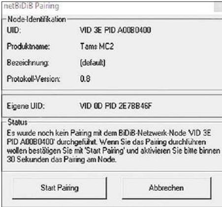
Bei netBiDiB muss ein Pairing zwischen Software und Zentrale erfolgen, um die Verbindung herzustellen. An der Zentrale wird dafür die Go-Taste gedrückt.
