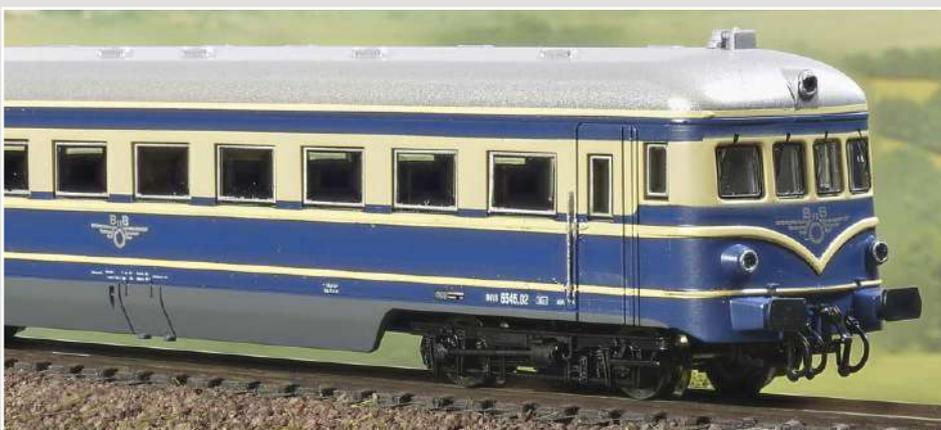
Die Griffstangen neben den Türen wirken freistehend, da sie in die Lackierung einbezogen und silbern bedruckt sind. Bremsluftschläuche und Schraubenkupplung sind bereits montiert. *Fotos: gp*
