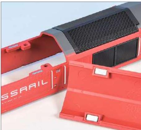
Rechts: Die elektrische Verbindung zwischen Fahrwerk und Lokkasten erfolgt über Federstiftkontakte. Für die unteren Lampen und für die obere Lampe samt Führerstandsbeleuchtung gibt es separate Platinen.
