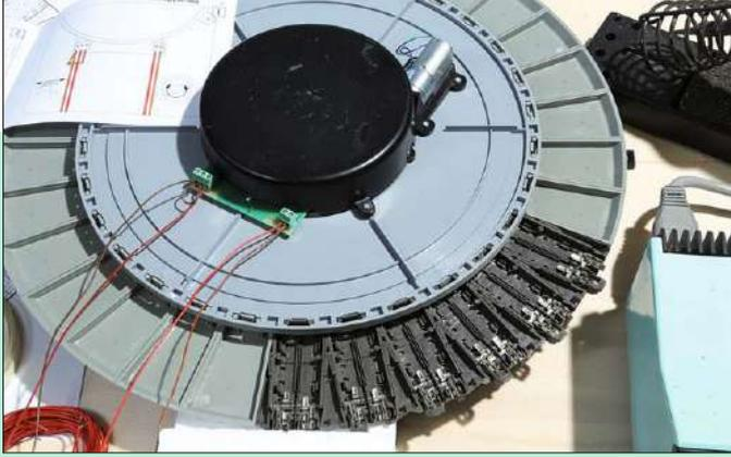
Vor dem Einsetzen in den Ausschnitt sind auf der Scheibenunterseite noch die Anschlüsse für den Bühnenfahrstrom und die Steuerung anzubringen.
