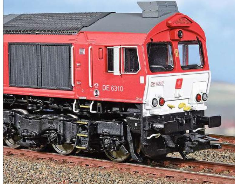
Die darüber befindlichen Sandkästen für die inneren Radsätze mit den freistehenden Sandrohren sind ebenso Vorbildgerecht ausgeführt wie die als separate Teile hinter der Frontplatte angeordneten Sandkästen für die äußeren Radsätze. Deren Sandfallrohre können vom Käufer als Zurüstteil angesteckt werden – wegen des Drehgestellausschlags ist dies allerdings nur bei Vitrinenmodellen sinnvoll. Alle Sandfallrohre enden kurz über der Schienenoberkante, jedoch nicht in Radenebene.
