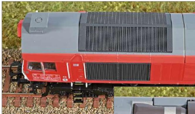
Rechts: Abgasführung und Schalldämpfer auf dem Dach sind farblich korrekt abgesetzt und als Einzelteil mit dem Dachstück verschraubt.
