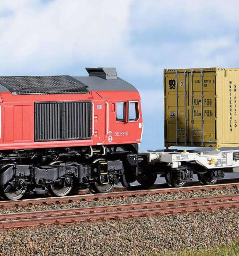
Im Lieferzustand trägt die Lok auf beiden Seiten Modellkupplungen. Diese können entfernt werden, sodass die Pufferträgerdetails aus dem Zurüstbeutel montiert werden können.
