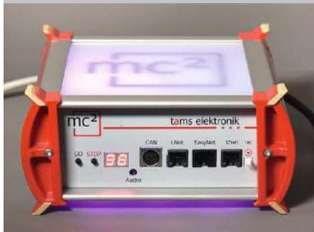
Die integrierte Beleuchtung der Zentrale besteht aus RGB-LEDs. Beim Update lässt Tams es so richtig krachen und stellt einen bunten Farb-Ventilator an.
