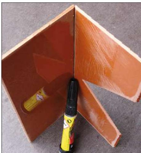
Als Alternative werden mit Sekundenkleber verbundene Resindachplatten verwendet.
