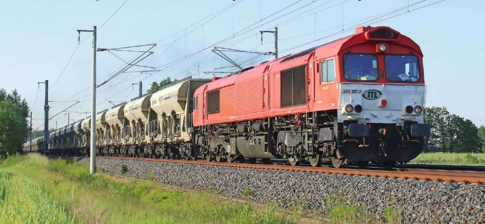
satz auf dem britischen Schienennetz musste das Lichtraumprofil entsprechend klein gehalten werden, was zum typischen Erscheinungsbild der Loks führte.
