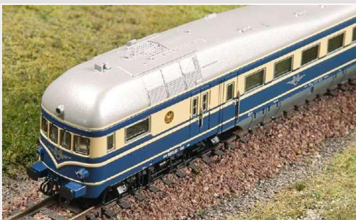
Die erhabene Zierlinie zieht sich V-förmig um die Stirn herum. Auf dem Buckel sind die Einrichtungen der Motorkühlanlage auszumachen.
