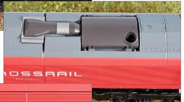
Die Kühleranlage ist mit einem äußerst feinen Gitter abgedeckt. Die beiden Lufteinlässe sind als separates Kunststoffteil in die Seitenwand eingelassen. Merkmal der Class 77 sind die Klimaanlage über den Führerständen.
