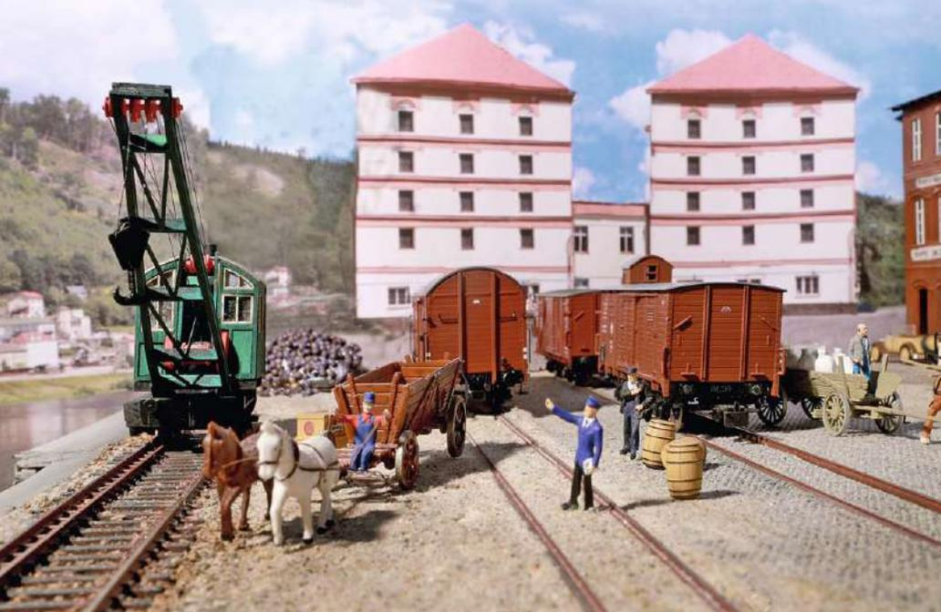
Der Güterumschlag auf dem oberen Ladebereich. Das Gleis unmittelbar am Kai besitzt zum Abstützen der Dampfkrane mit ihrem erweiterten Radstand eine dritte Schiene.
