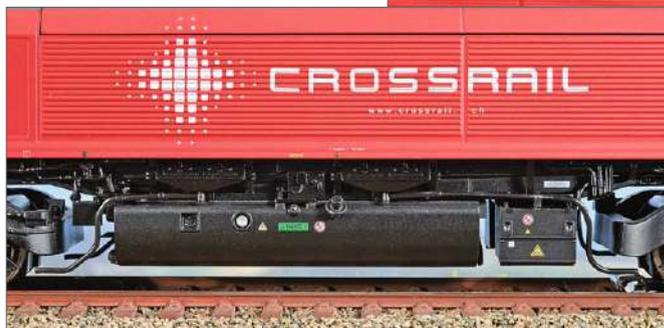
Mittig hängt unter dem Rahmen ein vergleichsweise riesiger Tank. Im Modell ist er ebenso korrekt mit Warnhinweisen bedruckt wie die Batteriekästen daneben. Darüber die Sandkästen, von denen aus ...
