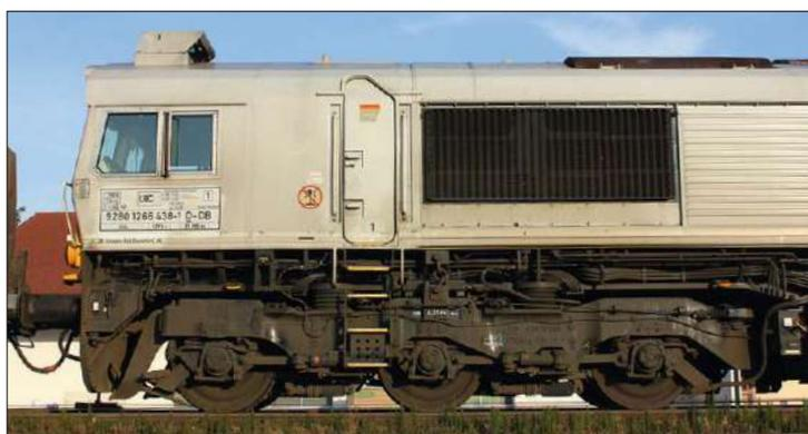
Bei den zweiteiligen Seitenfenstern kann der hintere Teil geöffnet werden. Die bei DB-Cargo eingesetzten Loks von ECR verfügen über Rückspiegel an den Seitenfenstern. Über dem Führerstand erkennt man das aufgesetzte Klimagerät.
