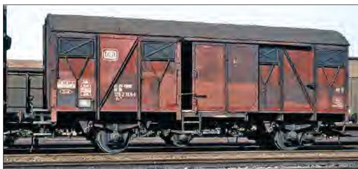
Der Gmmhs 56 290 445, aufgenommen im Januar 1958 in Volkmarsen, repräsentiert die Bauform ohne elektrische Heizleitung und mit Handbremsbühne. Foto: Reinhard Todt, Slg. Eisenbahnstiftung
