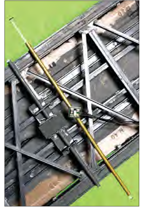
Für die Illuminierung dient eine Beleuchtungsplatte für beide Brückensignale.
