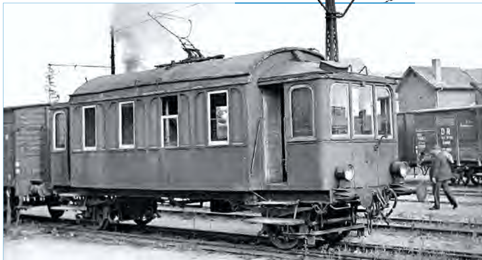
Anfang der 1950er-Jahre fotografierte Wilfried Biedenkopf den ET 40 im Bahnhofsvershub auf dem Stumpfgleis am Güterschuppen des Bahnhofs Wiesloch Stadt. Die ehemals dreiteiligen Abteifenster besitzen nur noch ihren halb herablassbaren Mittelteil, während die drei Frontscheiben auf dieser Fahrzeugseite noch ihre ursprüngliche Form besitzen. Foto: Slg. Andreas Christopher
