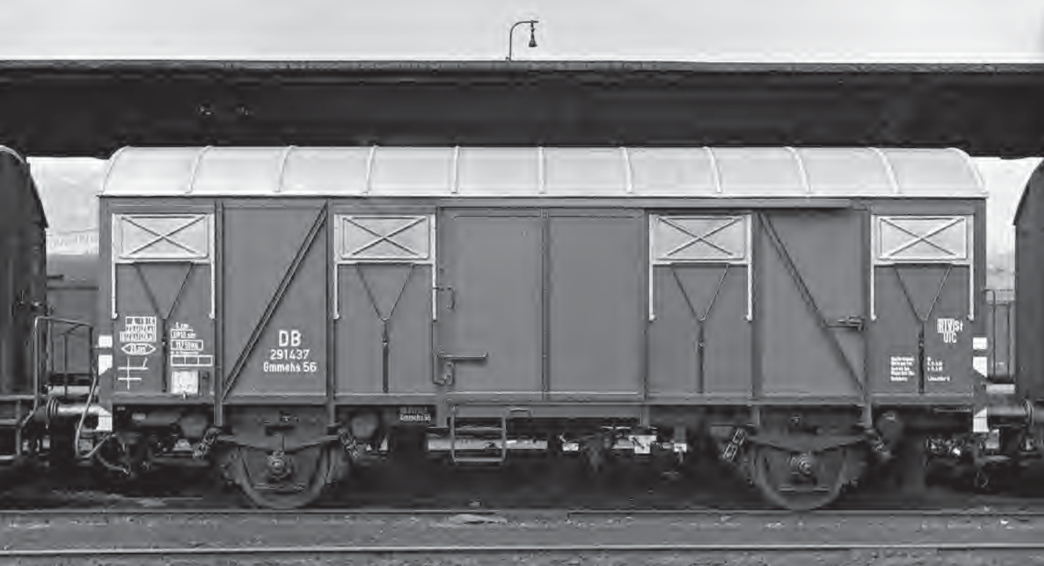
Den Gmmhs 56 291 437 hatte DIW am 12.3.58 an die DB geliefert. Zum Zeitpunkt der Aufnahme in Stuttgart Hgbf war er erst wenige Tage alt. Gut sind die unterschiedliche Farbgebung des Kastengerippes und der Wandplatten sowie die Steckdose für die E-Kupplung zu erkennen. Foto: Fritz Willke
