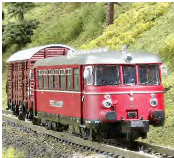
Die zweimotorigen MAN-Triebwagen dienten auch als Schlepptriebwagen und konnten bis zu zwei, drei vierachsige Güterwagen mitnehmen.
