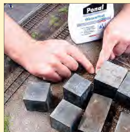
Die Auflagehölzer klebt man mit Weißleim auf. Wegen des unebenen Untergrundes empfiehlt sich eine Beschwerung.
