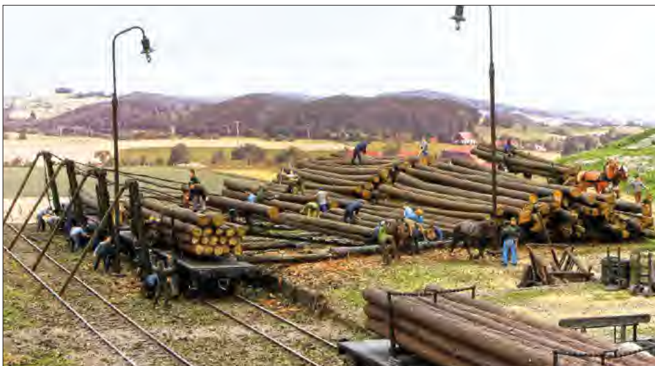
Auf einem Brawa-Diorama wurde die Verladung ganzer Baumstämme überaus realistisch dargestellt. Der etwas erhöht angeordnete Holz-lagerplatz ist mit senkrecht zum Gleis liegenden Rundhölzern belegt, auf denen die Stämme über eine schiefe Ebene mit viel Muskelkraft auf die Wagen gezogen werden.
