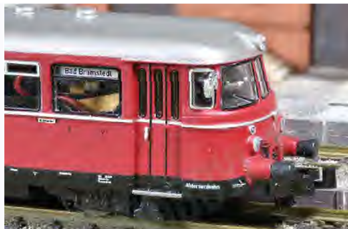
Die Rundung der Schürze ist ebenso bedruckt wie der Zugzielanzeiger. Wegen der Schürze empfiehlt sich die Fleischmann-Profi-Kupplung.
