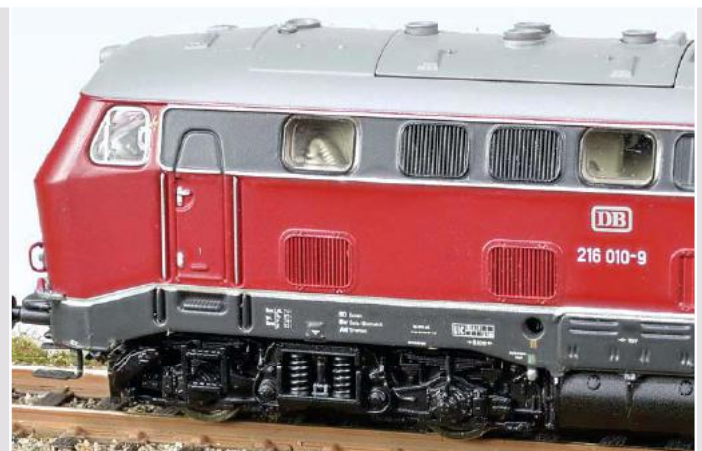
Hinter den Seitenfenstern ist der jeweilige Bereich des Maschinenraums nachgebildet. Das Drehgestell zeigt sich mit feinstrukturierten Details.
