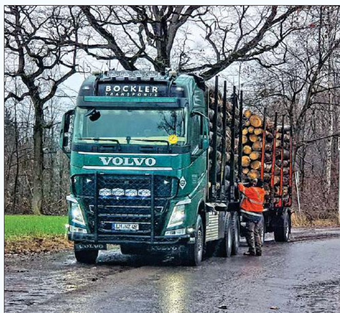
Oben: Heute erfolgt das Umladen meist mit dem bordeigenen Ladekran, der einen ganzen Stamm mit einem „Griff“ umsetzen kann. Links: Bei moderneren Holztransportern werden die Stammabschnitte mit hohen, ausfahrbaren Rungen und Spanngurten aus extrem reißfestem Kunststoffgewebe gesichert.
