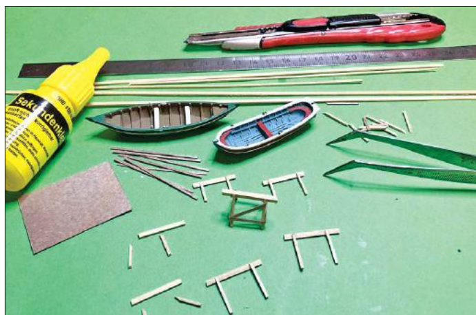
Die passenden Holzböcke werden aus Streifen von Flugzeugsperrholz angefertigt. Die Bauteile werden mit Sekundenkleber verklebt.
