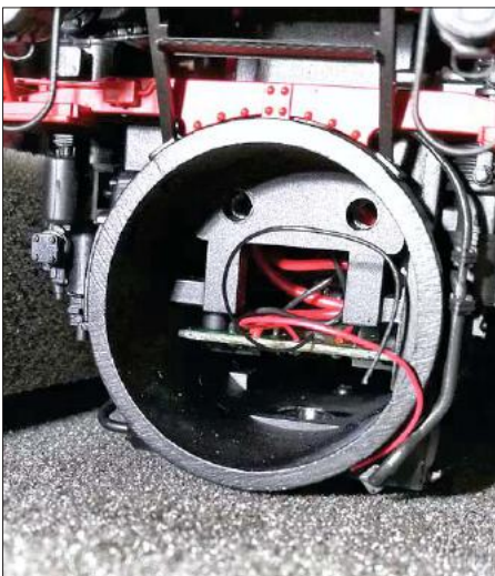
Hinter der Rauchkammertür verstecken sich zwei Schrauben zur Lokdemontage.
