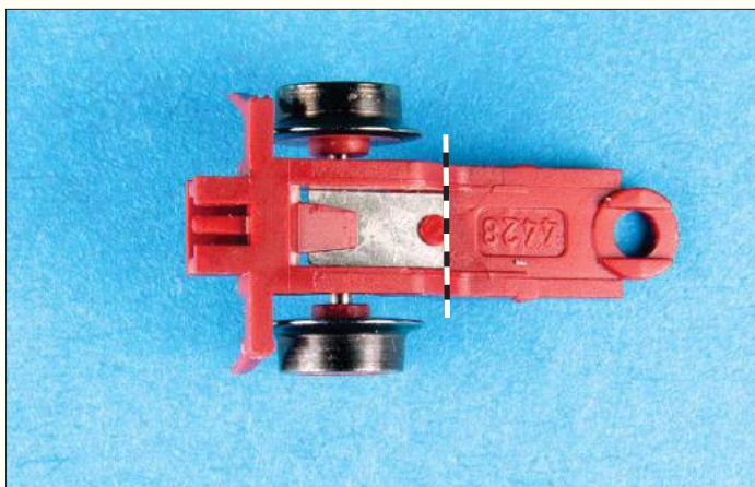
Bilder 14 und 15: An den schwarzweißen Linien sind die Bleche unterm Schneckenrad und im Vorlaufgestell aufzutrennen. Dazu eignet sich beispielsweise eine Minibohrmaschine mit Trennscheibe. Das Auftrennen ist erforderlich, um den Fahrzeugrahmen potenzialfrei zu schalten.
