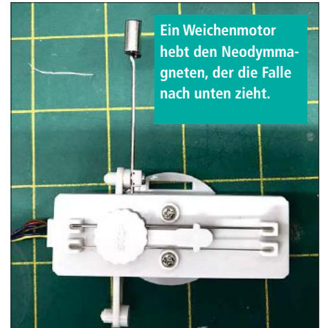
Ein Weichenmotor hebt zum Entkuppeln den Kuppelbaum an.
