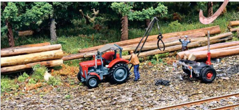
Oben: Über die heruntergeklappten Rungen werden die Stämme mithilfe von Umlenkrollen und einer Seilwinde am Traktor hochgezogen. Als Fixpunkt für das Seil dient ein Baum.
