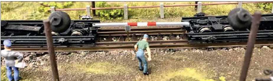
Über einen Stempel wird der Kuppelbaum angehoben und die Rollwagen können zusammengeschoben werden.
