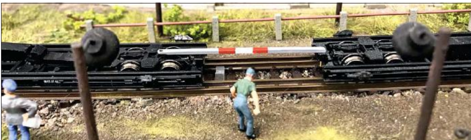
Sobald sich der Kuppelbaum über den Kuppelzapfen schiebt, wird der Stempel wieder nach unten gefahren. Der Rollwagen kann nun über den Stempel geschoben werden.
