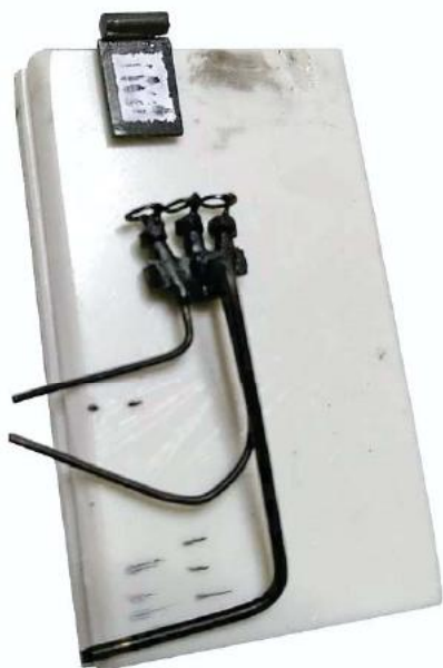
Links: Der Fahrplanhalter entstand aus dünnem Messingblech. Auch das Dreifachventil entstand aus diversen Materialresten.
