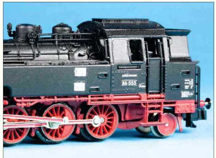
Bild 10: Das umgebaute Modell besitzt einen Griff am Wasserkasten und das ÜK-typische verschlossene Seitenfenster sowie einen Scheibenradsatz.
