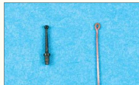
Bild 6: Anstelle der Griffstangen mit Kugelkopf treten selbstgebogene aus gehärtetem Bronzedraht, der bei Kuswa erhältlich ist.
