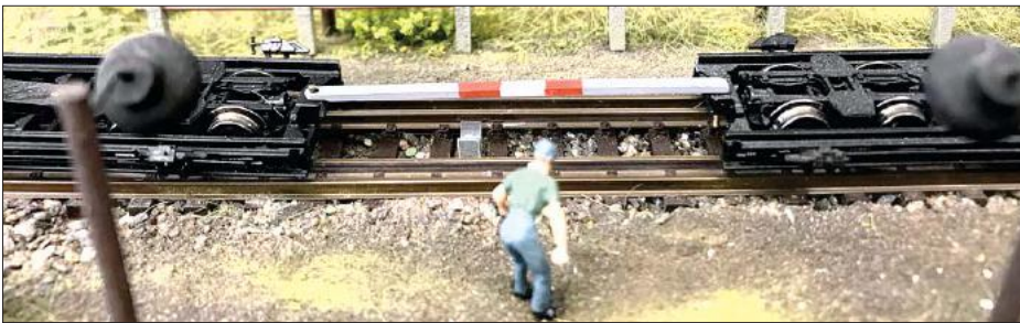
Der Kuppelbaum verbindet die Rollwagen für die Fahrt mit Regelspurgüterwagen.
