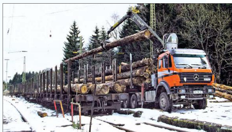
Oben: Heute erfolgt das Umladen meist mit dem bordeigenen Ladekran, der einen ganzen Stamm mit einem „Griff“ umsetzen kann. Links: Bei moderneren Holztransportern werden die Stammabschnitte mit hohen, ausfahrbaren Rungen und Spanngurten aus extrem reißfestem Kunststoffgewebe gesichert.
