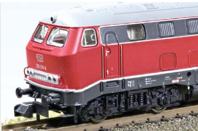
Die Stirnfenster liegen passgenau und bündig in der Lokfront und bieten Einblicke in die gestalteten Führerstände.
