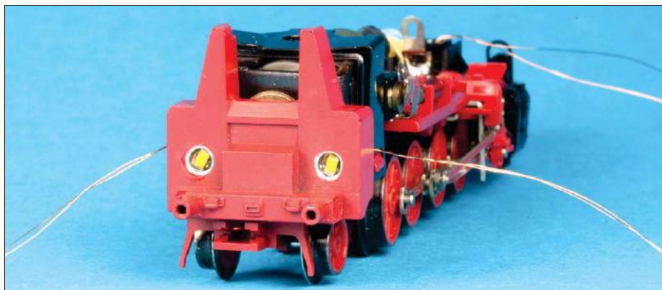
Bild 12: Für die unteren LEDs werden 1,3-mm-Bohrungen eingebracht und mit einem 2,3-mm-Bohrer ca. 2 mm tief aufgebohrt.
