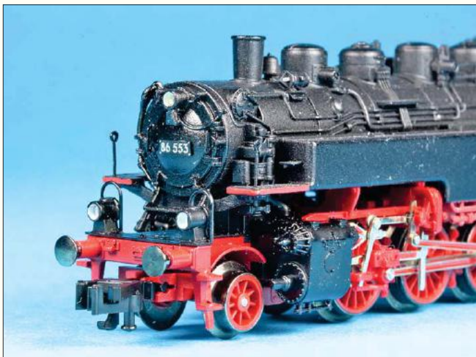
Bild 9: Nach dem Umbau zeigt sich 86 553 vorbildgetreu mit Griffstangen auf dem Laufblech und mit einem Speichenradsatz im Vorläufer.
