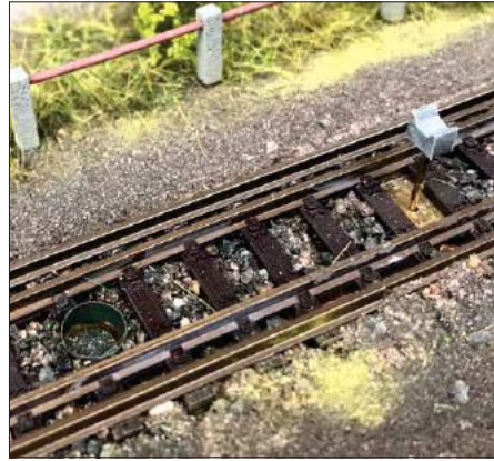
Ein Weichenmotor hebt zum Entkuppeln den Kuppelbaum an.
