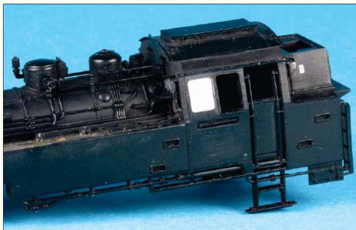
Bilder 2 und 3: Nach dem Zerlegen werden die Griffstangen in Höhe der Rauchkammertür ausgetauscht sowie die vorderen Wassereinfüllluken entfernt und verspachtelt.
