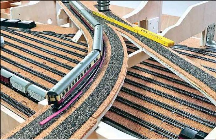
In Versuchen wurde die optimale Höhe der Streifen für eine Gleisbogenüberhöhung mit dynamischem Fahreindruck ermittelt.
