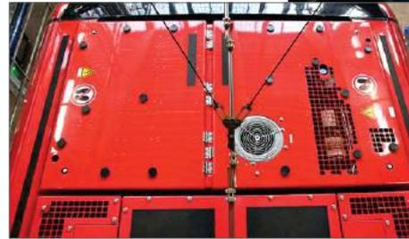
... mittig jeweils ein großes Klimagerät, welches sowohl für Heizung als auch Kühlung zuständig ist. Die Kühlleistung ist auf den Sommerbetrieb im Freien abgestimmt. Im Vordergrund die Anschlusskabel in einer Vertiefung,
