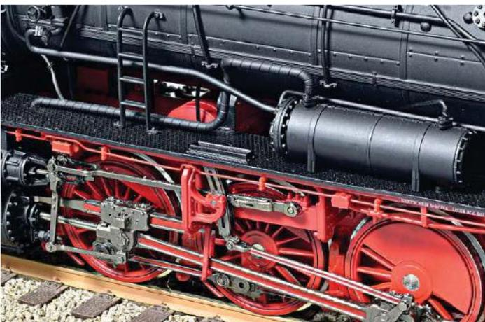
Detailreich: Oberflächenvorwärmer mit isolierter Dampfleitung, Steuerung mit Kuhnscher Schleife und Bremsluftbehälter im Rahmen
