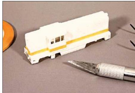
Nach der Reinigung besitzen die 3D-Druckmodelle eine weiße Oberfläche. Bei einer weißen Grundierung klebt man den Streifen für die deutsche Version der L45H ab. Der übrige Lokkasten erhält dann eine rote Farbgebung.
