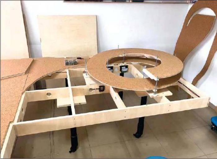
Entgegen der Empfehlung, dass das Steigungsgleis außen in der Gleiswendel liegen sollte, musste hier davon abgewichen werden.
