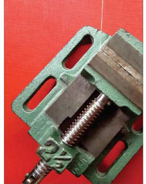
Die „Streckvorrichtung“ – primitiv aber effektiv. Die knapp 1600 g des Schraubstocks sorgen für eine konstante Streckung aller Drahtstücke.
