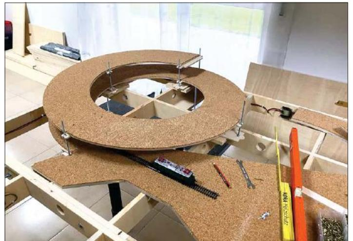
Für die Betriebssicherheit ist es wichtig, dass die Gleiswendeln eine gleichmäßige Neigung aufweisen; sie sind entsprechend zu nivellieren.
