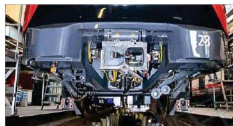
Die Scharfenbergkupplung liegt mittig zwischen den Stoßverzellern. Sie verfügt über Kupplungen für die Bremsluftleitung und Kontakte zur Übertragung von Steuersignalen. Im regulären Betrieb wird sie nicht benötigt, da die Länge der Fahrzeuge mit den Bahnsteiglängen im Untergrund korrespondiert.
