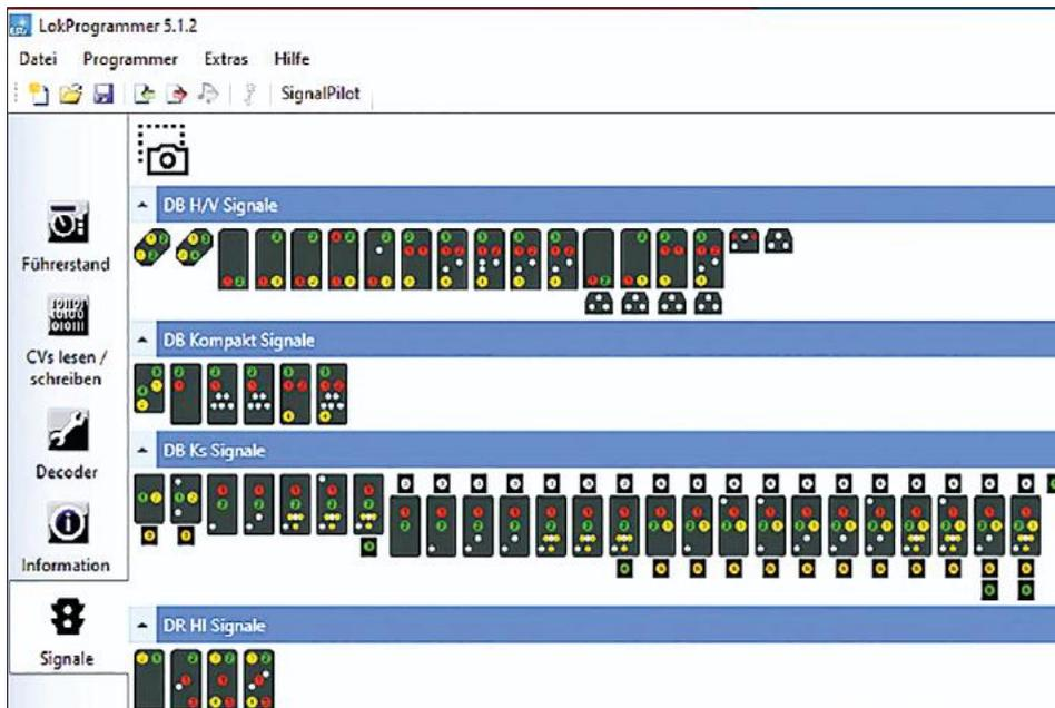
Die Anzahl der unterstützten Signalsysteme wird im Lauf der Zeit noch wachsen. Zum Auslieferungsbeginn des Signalpiloten sind alle wichtigen europäischen Signalsysteme vorhanden. Zur Konfiguration wird einfach der gewünschte Signalschirm mit der Maus angeklickt und zum Decoder gezogen.
