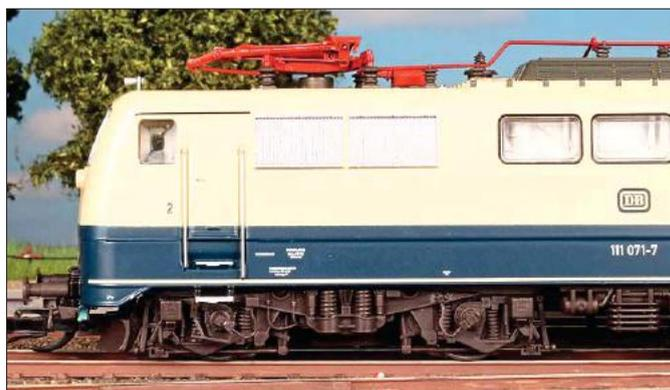
Griffstangen und Lüftungsöffnungen sind angegraviert und lackiert bzw. bedruckt. Die Anschriften sind lesbar und entsprechen dem Vorbild. An den Drehgestellblenden sind Sandkästen und Fallrohre sowie die Federung angespritzt. Die Leitungen der Drehzahlensoren sind angesetzt und freistehend.
