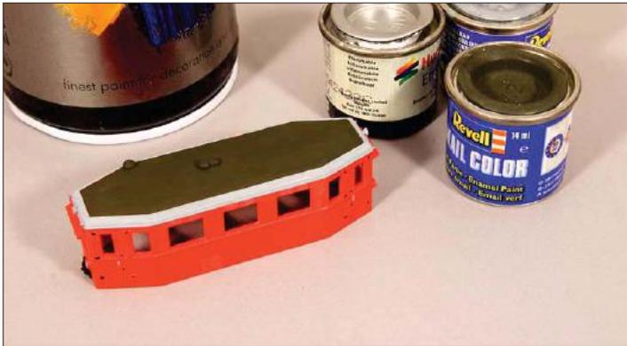
Für den Modellbau eignen sich die komplett gestalteten 3D-Gehäuse von Shapeways gut. Nach einer Farbgebung entstehen damit individuelle Fahrzeuge, so wie hier ein Triebwagen nach Vorbild der MEG. Passende Antriebe erhält man bei sb-Modellbau.
