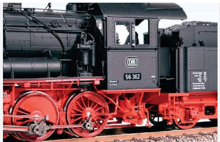
Zwischen Vorwärmer und Führerhaus ist die Verbundspeisepumpe der Bauart Knorr-Tolkin montiert. Fotos: gp
