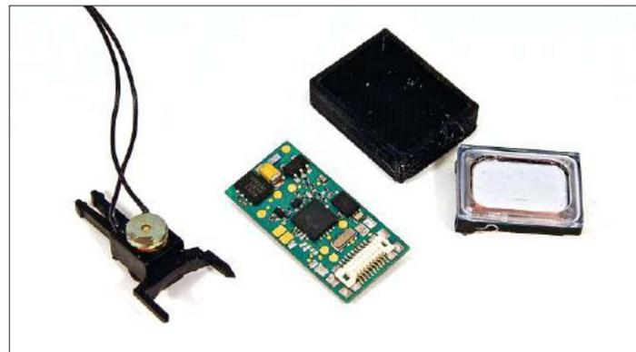
Für das Digitalisierungsprojekt der ELNA wurden die Digitalkupplungen UV1 von Krois sowie ein Sounddecoder von Uhlenbrock verwendet. Der kleine Rechteck-Lautsprecher muss von den Abmessungen her unter die Führerhausdecke passen.
