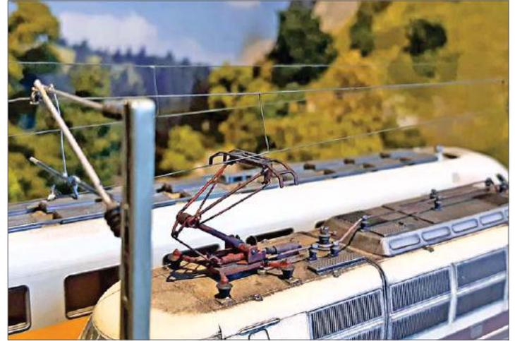
Anders als beim ersten Bau wurden die Hänger beim zweiten Mal nicht mehr stumpf verlötet, sondern an den Enden ca. 1,5 mm abgewinkelt. Durch die größere Lötfläche ist das Ganze sehr viel unempfindlicher.
