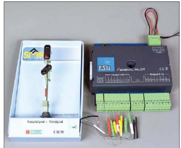
Die Dunkelschaltung des Vorsignals am Hauptsignal ist ein echter Klassiker bei Bundesbahn-Signalen. ESU hat diesen Anwendungsfall so einfach wie möglich durch Auswahl des entsprechenden Signals gelöst. „San“ ist eine etwas ungewöhnliche Abkürzung und steht für **Signalanschlussnummer**.
