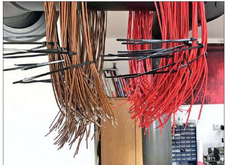
Zum Anschluss der Gleise an die Fahrstromverteiler wurden die 1-mm<sup>2</sup>-Litzen mit den notwendigen Kontaktschuhen vorkonfektioniert.
