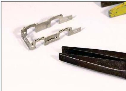
Durch Umklappen und Biegen werden die Drehgestellrahmen geformt. Die Bauteile drückt man vorsichtig mit kleinen Flachzangen zusammen.
