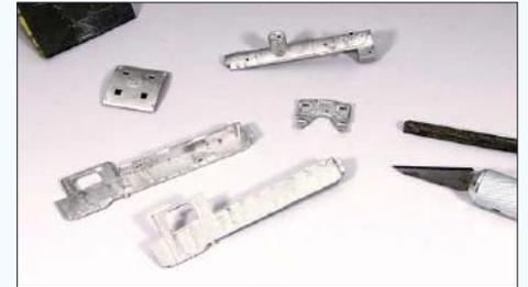
Gängig bei Dampflokbausätzen ist die Auf fertigung der Kessel, Führerhäuser und Wasserkästen aus Weißmetall. Die Bauteile säubert man vor der Montage von vorhandenen Angüssen.
