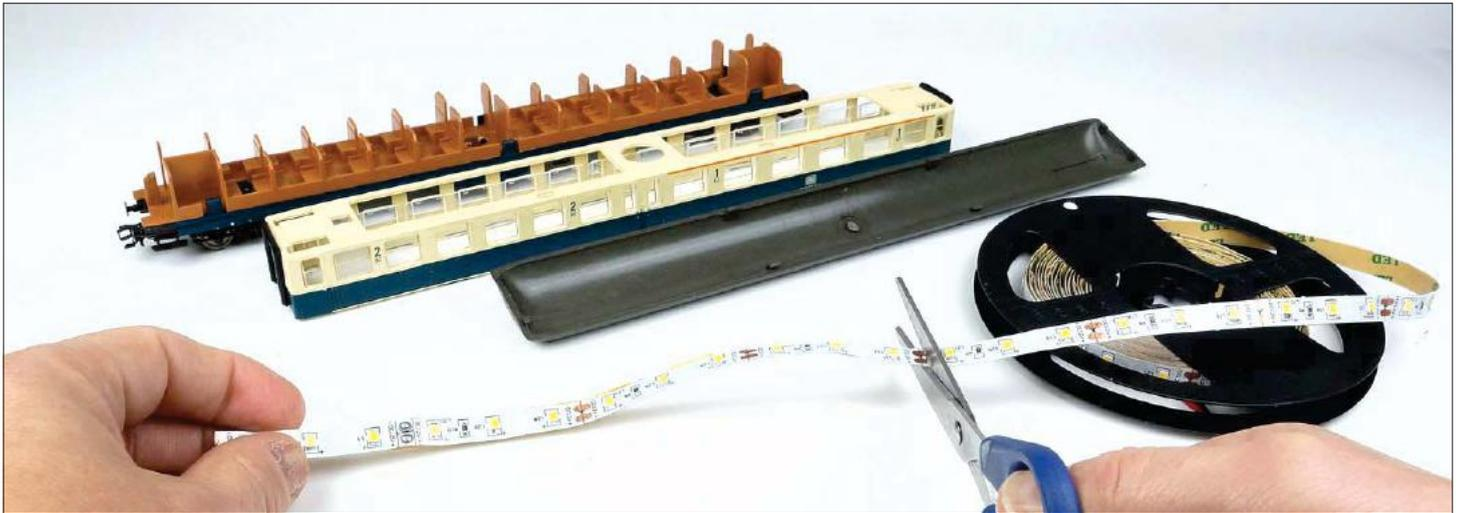
Zur Beleuchtung der Mitteleinstiegswagen setzen wir preiswerte selbstklebende warmweiße 12-V-LED-Streifen ein, die vor der Montage mit der Schere auf 20 cm Länge gekürzt werden. In der Regel sind die LED-Streifen alle 5 cm kürzbar.
