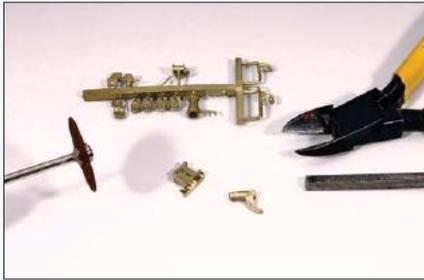
Viele Bauteile wie Armaturen des Kessels oder Tritte sind aus Messingguss gefertigt. Die Bauteile müssen vom Gussbaum getrennt und danach versäubert werden.
