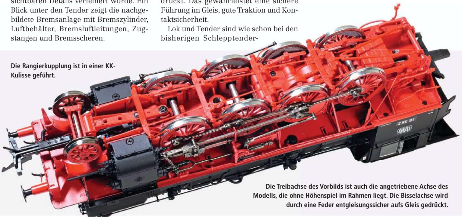
Die Treibachse des Vorbilds ist auch die angetriebene Achse des Modells, die ohne Höhenspiel im Rahmen liegt. Die Bisselachse wird durch eine Feder entgleisungssicher aufs Gleis gedrückt.
