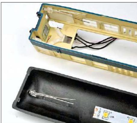
Für das Dreifachspitzenlicht werden bedrahtete warmweiße 1,8-mm-Tower-LEDs installiert.
