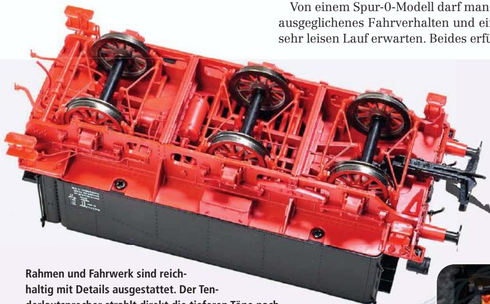
Rahmen und Fahrwerk sind reichhaltig mit Details ausgestattet. Der Tenderlautsprecher strahlt direkt die tieferen Töne nach unten ab. In der Lok ist der Hauptlautsprecher untergebracht.
