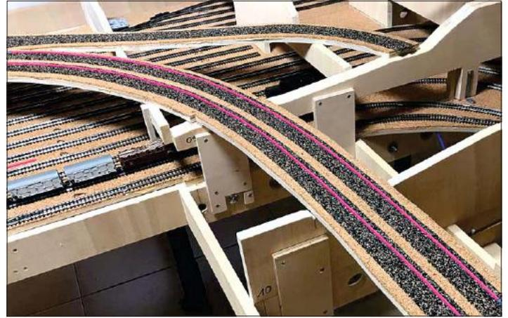
Für die Gleisüberhöhung wurden schmale Schaumgummistreifen auf die Korkbettung der Hauptstrecke geklebt.
