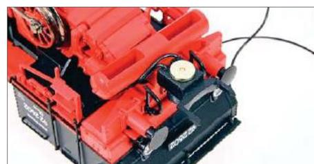
Die Litzen der Kupplungen müssen so verlegt sein, dass sich die Kupplung leichtgängig bewegen kann. Die Litzen der hinteren Kupplung fädelt man oberhalb des Luftbehälters direkt zu den Bohrungen.
