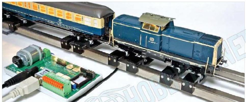
Zur Programmierung des IntelliDrive-2-Decoders wird das Test- und Programmiergerät „DigiTest“ von Uhlenbrock genutzt. Für die ersten Testläufe von Motor und Intellimatic leistet ein ausreichend langer Rollenprüfstand wertvolle Dienste.
