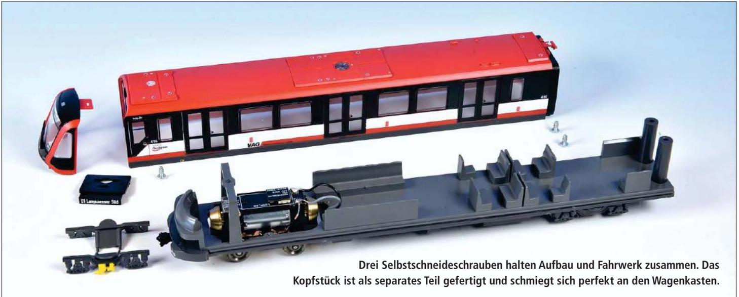
Drei Selbstschneideschrauben halten Aufbau und Fahrwerk zusammen. Das Kopfstück ist als separates Teil gefertigt und schmiegt sich perfekt an den Wagenkasten.
