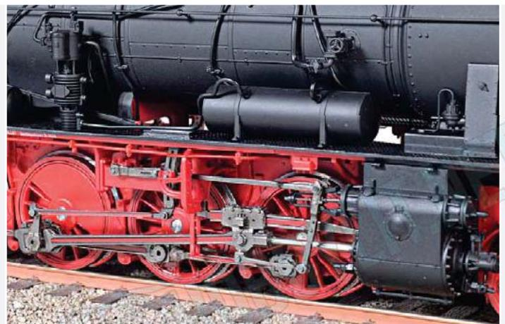
Knorr-Luftpumpe mit den notwendigen Leitungen, Luftkessel auf dem Umlauf und detailreich nachgebildeter Steuerungsträger
