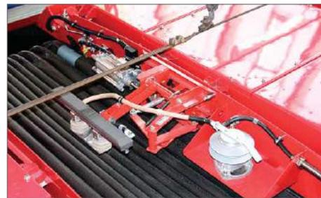
Links: Damit die Fahrzeuge auch in Werkstätten ohne seitliche Stromschiene bewegt werden können, gibt es auf dem Dach zwei Hilfsstromabnehmer. Sie werden im Bedarfsfall über einen kleinen seitlichen Druckluftantrieb angehoben.
