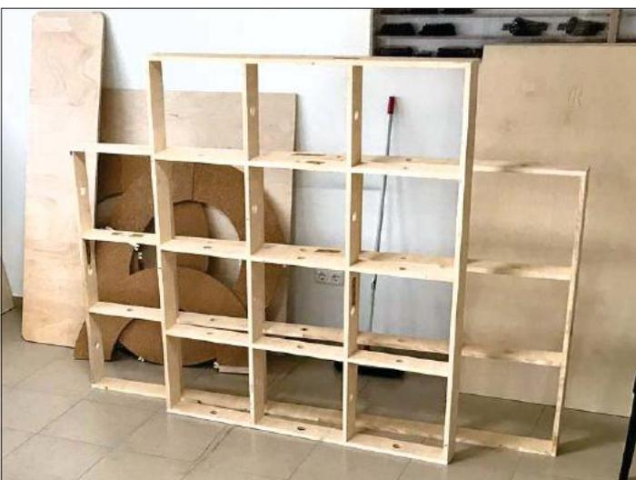
**Für Tragfähigkeit und Verzugsfreiheit sorgt der aus 19-mm-Tischlerplattenzuschnitten hergestellte Rahmen. Der Gesamtunterbau der Anlage setzt sich aus mehreren Rahmensegmenten zusammen. Die Löcher in den Rahmentraversen dienen der Kabeldurchführung.**
