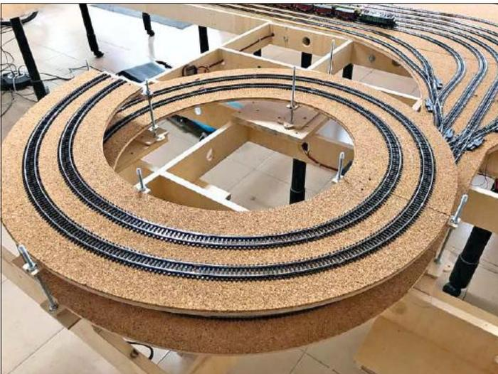
Nach der Gleisverlegung in der Wendel erfolgten Testfahrten und die Feinjustierung der Gleiswendeln über die Gewindestangen.
