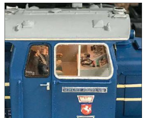
Als Vorlage für die 3D-Konstruktion der Bedienpulte dienten Fotos der Henschel-Lok DH 240. Die Pulte wurden lackiert, die Bedienelemente farblich hervorgehoben und die Instrumente mit beleuchteten Skalen ausgerüstet. Das Handrad zum Schalten der Fahrstufen ist ebenfalls ein 3D-Druckteil und muss noch installiert werden.
