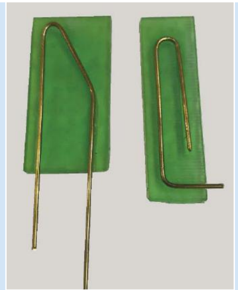
Gedruckte Biegelehren helfen bei der Herstellung identischer Griffbügel.
