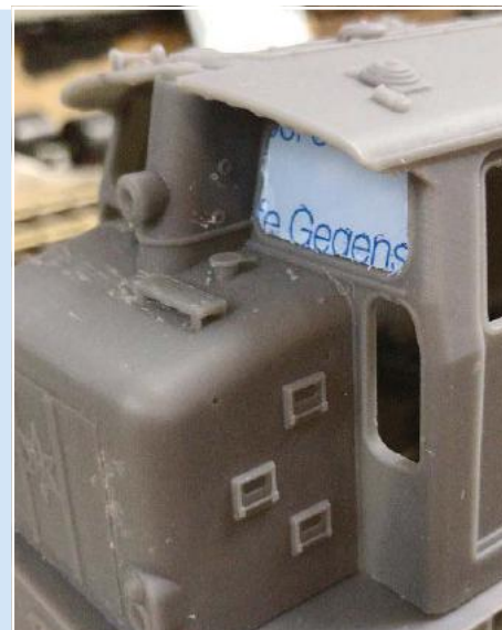
Auf Basis der 3D-Konstruktionsdatei wurden die Fenster mit der CNC-Fräse hergestellt.
