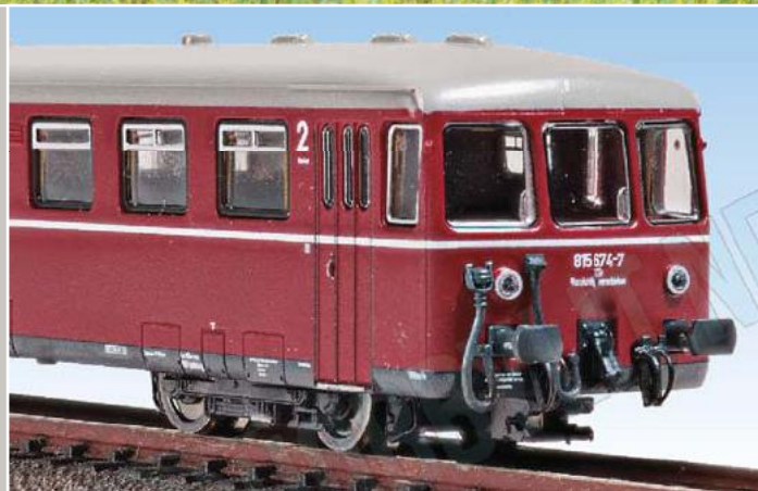
Die mit dem Motorwagen zu kuppelnde Seite des 815 hat kein drittes Spitzenlicht und verfügt über einen NEM-Normschacht.
