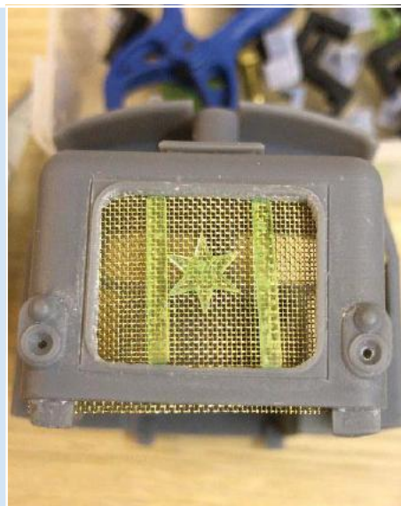
Das 3D-gedruckte Gitter wurde herausgesägt und durch ein Metallgewebe ersetzt.
