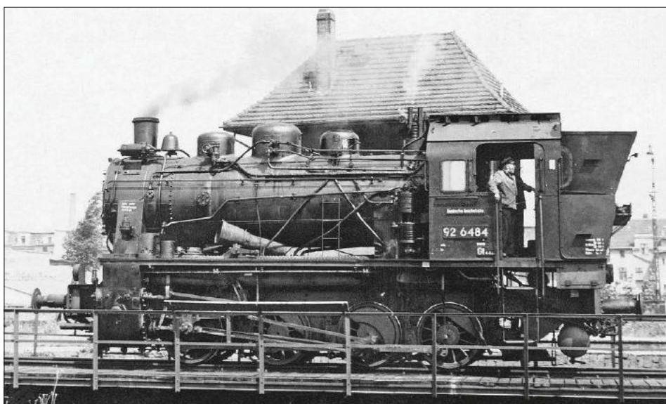
Diese ELNA 6 (Baujahr 1929) hatte es von der (damaligen) Liegnitz-Rawitscher Eisenbahn 1945 zur Niederlausitzer Eisenbahn verschlagen. Weil sie keine Riggennbach-Gegendruckbremse besaß, durfte sie, obwohl als 92 6484 der DR ab 1960/61 in Görlitz „tätig“, nicht den Steilstreckenabschnitt der einstigen Görlitzer Kreisbahn hinter Königshain-Hochstein befahren. Foto: Archiv Dirk Endisch
