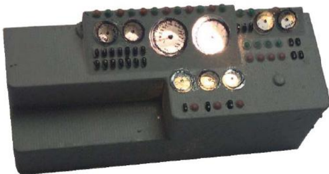
Die Bedienpulte sind abhängig von der Fahrtrichtung beleuchtet.
