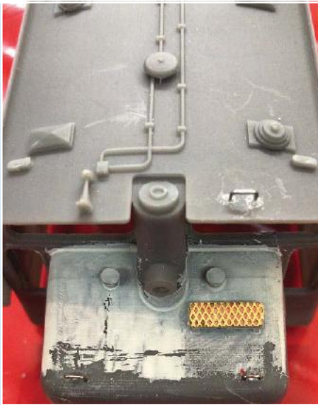
Der Tritt für den Aufstieg aufs Dach wurde ebenfalls aus Riffelblech zugesägt.
