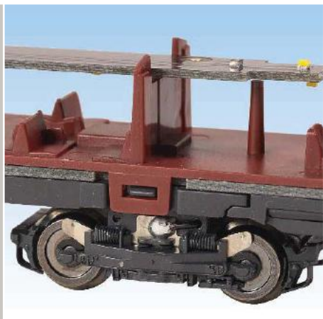
Die Stromabnahme erfolgt seitlich über die Radreifennachbildung.
