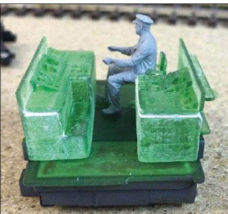
Als Vorlage für die 3D-Konstruktion der Bedienpulte dienten Fotos der Henschel-Lok DH 240. Die Pulte wurden lackiert, die Bedienelemente farblich hervorgehoben und die Instrumente mit beleuchteten Skalen ausgerüstet. Das Handrad zum Schalten der Fahrstufen ist ebenfalls ein 3D-Druckteil und muss noch installiert werden.
