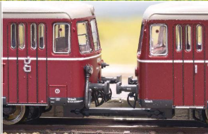
Über eine einfache Deichsel sind Motor- und Steuerwagen verbunden. Jedes Fahrzeug ist elektrischer Selbstversorgung mit eigenem Decoder.
