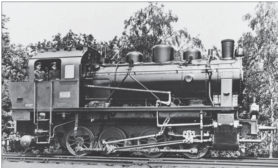
Die ELNA-Lieferungen ließen bei aller Vereinheitlichung auch konstruktive Sonderleistungen zu. Lok 182 o der Görlitzer Kreisbahn besaß (auf speziellen Wunsch) bei ihrer Indienststellung eine Riggennbach-Gegendruckbremse und einen Geschwindigkeitsmesser der Bauart Deuta. Foto: Carl Bellingrodt, Archiv Dirk Endisch
