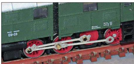
**N:** Rocos E 91 mit nachgerüsteten Treib- und Kuppelstangen von Krüger Modellbau
