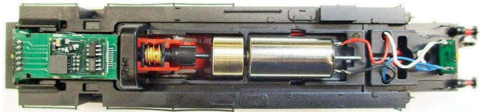
**H0:** Der Einbau des Glockenankermotors in die BR 95 von Tillig erfolgt ohne Fräsarbeit.
