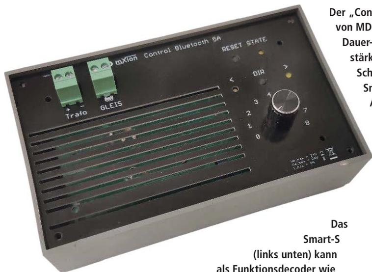
Der „Control“ genannte Fahrregler von MD-Electronics bietet 5 A Dauer- und 6 A Spitzenstromstärke. Über seine Bluetooth-Schnittstelle lassen sich Smartphones mit passender Android-App anbinden.
