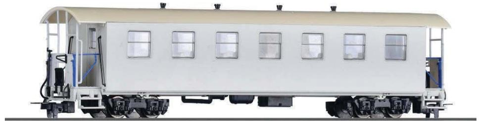
H0m/H0e: Siebenfenstriger Personenwagen der Bauart KBtr mit Traglastenabteil der HSB
