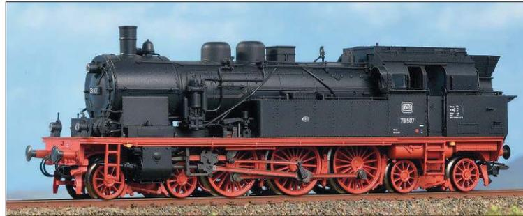
**H0:** Bereits für März angekündigt wird die DB-Baureihe 78.0–5 mit zwei Kesselkaminen und einem Sandkasten sowie genieteten Wasserkästen.
