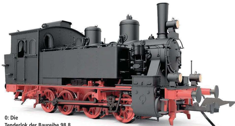
0: Die Tenderlok der Baureihe 98.8 entsteht in einer Kunststoff-/Metall-Mischbauweise.
