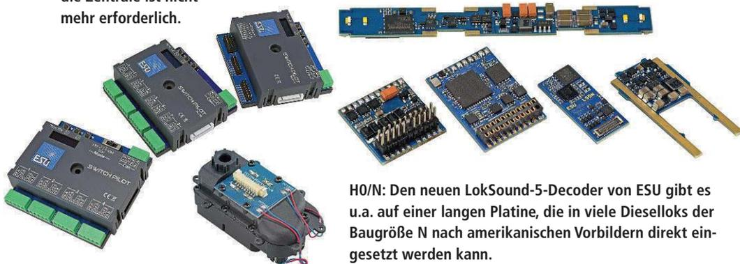
**H0/N:** Den neuen LokSound-5-Decoder von ESU gibt es u.a. auf einer langen Platine, die in viele Dieselloks der Baugröße N nach amerikanischen Vorbildern direkt eingesetzt werden kann.
