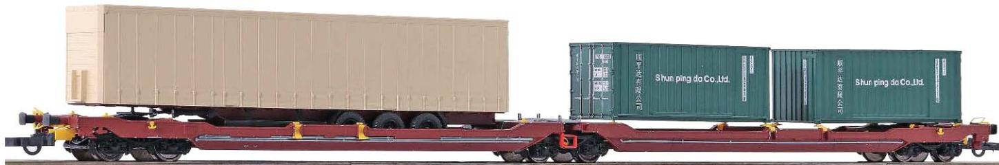
Bei den Güterwagen wird der „Kombinierte Verkehr“ weiter ausgebaut. Hier ist die Hauptneuheit der Doppeltaschen-Gelenkwagen der Bauart T 3000e. Das Modell besteht aus Zinkdruckgusswan- nen mit angesetzten Kunststoffteilen. Die Variantenvielfalt ist beim Modell fast so groß wie beim Vorbild: Der Wagen wird erhältlich sein mit verschiedenen Contain- nern – darunter auch Tankcontainer – und LKW-Aufliegern.
