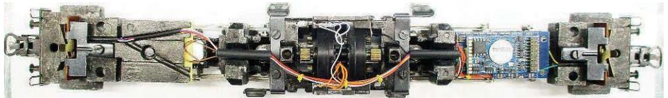
**H0:** Im Motorumbausatz für das Märklin-Krokodil sind zwei Flachläufermotoren enthalten. Das Umschaltrelais muss entweder durch eine Elektronik ersetzt werden oder gleich durch einen Decoder.
