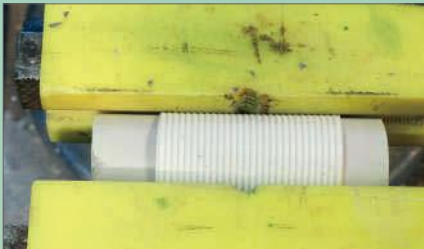
Das aus Evergreen-„Wellblech“ angefertigte Ersatzdach wird über ein passendes Rohrstück gewölbt im Schraubstock eingespannt. Durch Erwärmen mit einem starken Föhn oder besser noch mit einer Heißluftpistole wird die Wölbung langfristig stabil.
