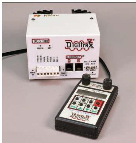
Der Chieff DCS100 zusammen mit seinem ursprünglichen Handregler DT100. In dieser Kombination war das System jahrelang im Fremo im Einsatz.
