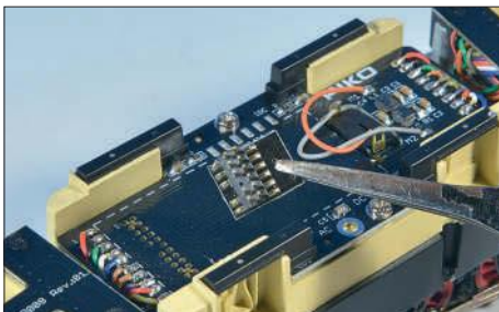
Rechts: Die Stirnbeleuchtung ist mit einer Kunststoffkappe maskiert. Über Federkontakte sind die obere Stirnlampe und die Führerstandsbeleuchtung angeschlossen.
