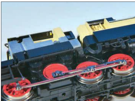
Der Motor ist zentral im mittleren Lokteil untergebracht. Der Motorhalter besteht aus Metall und sorgt so für angemessenes Reibungsgewicht. Zugleich sind hier auch Details der Maschinenraumeinrichtung angraviert. Die Schwungmassen nutzen den verfügbaren Platz voll aus.
