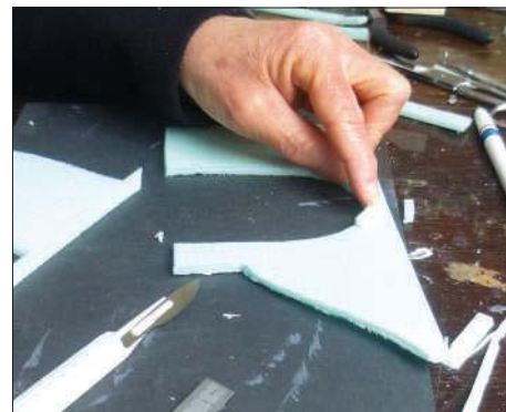
Für die Herstellung des Mauerwerks wurden 4-mm-Hartschaumplatten zugeschnitten.
