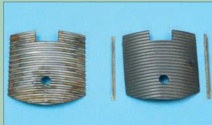
Das Originaldach aus Wellpappe (links) im Vergleich zu dem feiner gerippten Kunststoffdach, neben dem schon die seitlichen Regenrinnen aus Messingprofilen liegen. Mit dezenten Rostspuren auf einem matten Silber wird die Wirkung noch realistischer.
