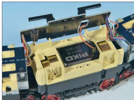
Links: Die Maschinenraumbeleuchtung erfolgt mit warmweißen LEDs, deren Licht teils direkt in die Aussparung strahlt, teils über Lichtleiterkörper mit Abdeckungen umgelenkt wird.
