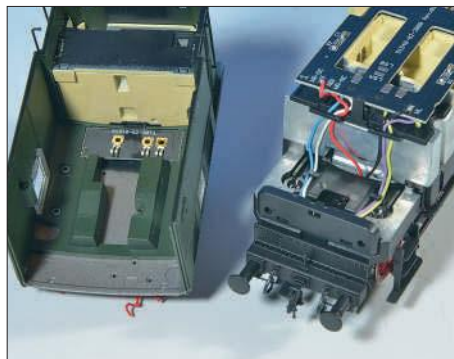
Links: Die Maschinenraumbeleuchtung erfolgt mit warmweißen LEDs, deren Licht teils direkt in die Aussparung strahlt, teils über Lichtleiterkörper mit Abdeckungen umgelenkt wird.
