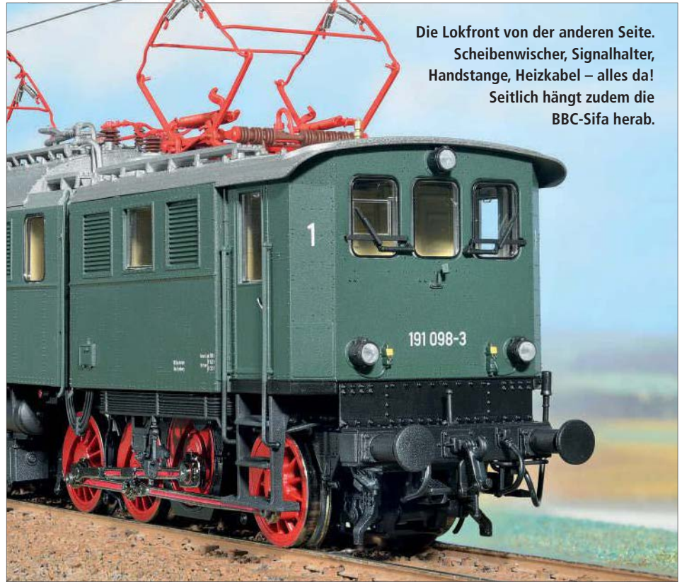
Die Kuppelstange ist aus Metall gefertigt. Die Sandkasten- deckel wurden in der glatten Bau- ausführung nach- gebildet.
