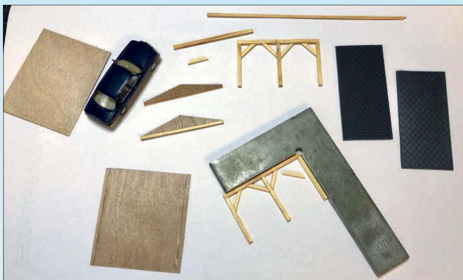
Der Bau des offenen Unterstands (Carport) ist eine klassische Küchentischbastelei. Benötigt werden ein paar Quadratleisten und Sperrholz aus dem Flugmodellbau sowie Platten für die Dacheindeckung. Geklebt wird mit Uhu Hart oder Ponal Express. Ein Winkel sorgt für Rechtwinkligkeit.
