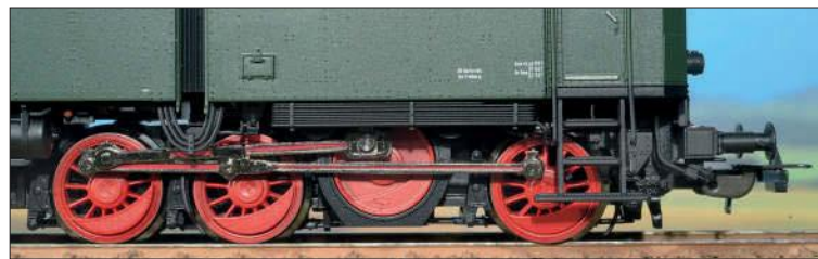
Die Kuppelstange ist aus Metall gefertigt. Die Sandkasten- deckel wurden in der glatten Bau- ausführung nach- gebildet.
