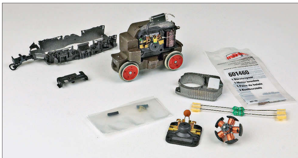
Unten: Zur Montage der Komponenten des Hochleistungsmotor-Nachrüst-Sets (hier im Vordergrund) muss das angetriebene Drehgestell der Elektrolokomotive ausgebaut werden.
