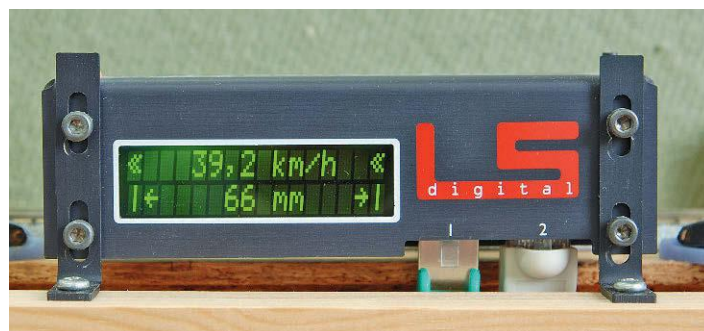
Das µCon-Railspeed-Messgerät besteht aus der µCon-Railspeed-Einheit und dem Mini-Manager. Dieser wird per LAN mit dem PC verbunden.
