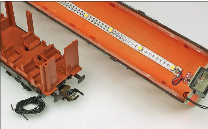
Die Zwischenwagen der 1. Klasse und 2. Klasse erhalten sechspolige stromführende Kupplungen sowie eine Wageninnenbeleuchtung in „Sunny White“ von Krois.
