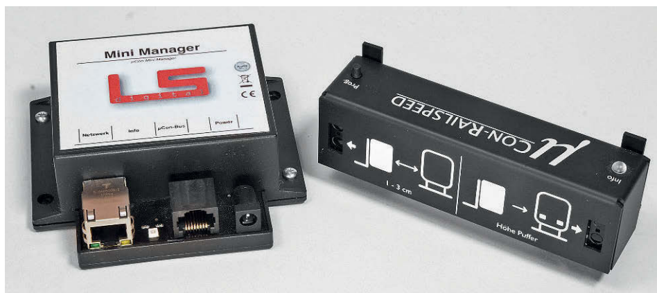
Das µCon-Railspeed-Messgerät besteht aus der µCon-Railspeed-Einheit und dem Mini-Manager. Dieser wird per LAN mit dem PC verbunden.
