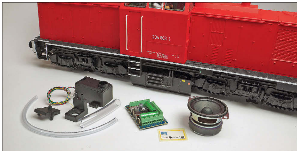
Die Komponenten für die digitale Nachrüstung kommen von ESU. Rechts der Digitaldecoder vom Typ SoundPilot 5 XL und der 50-mm-Lautsprecher. Auf der linken Seite liegt der große XL-Raucherzeuger für den Dieselrauch samt Adapterpaket für Dampf- oder Dieselbetrieb bereit.
