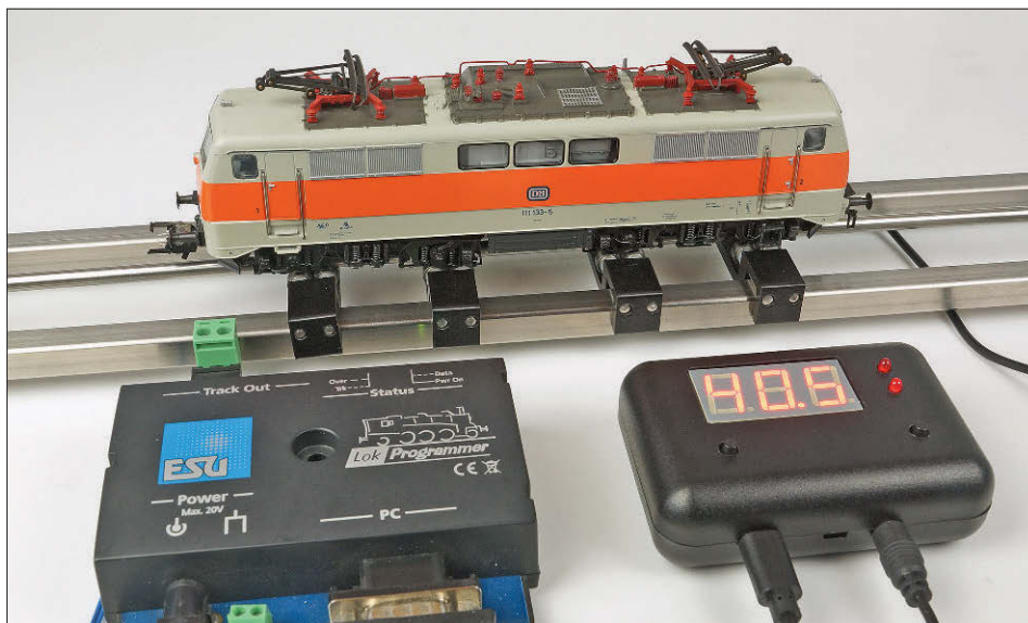
Auf einem Rollenprüfstand mit Geschwindigkeitsmessung ist es möglich, die Geschwindigkeiten der Modellbahnlok mit den Daten des großen Vorbilds abzugleichen. Für die 111 133-3 sind 160 km/h als Höchstgeschwindigkeit nach Vorbildangaben angemessen.
