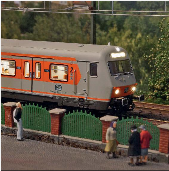
Im geschobenen Wendezugdienst ist beim Steuerwagen auch der Zugzielanzeiger beleuchtet.
