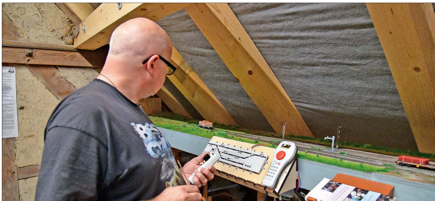
Track-Control im Einsatz am Fremo-Bahnhof Beutow. Als Digitalzentrale für das Track-Control dient eine SmartBox light von Piko. Fahren und Schalten ist beim Fremo immer getrennt. Zum Fahren kommt eine Intellibox II von Uhlenbrock zum Einsatz; Handregler sind im Fremo übliche Selbstbau-Freds.
