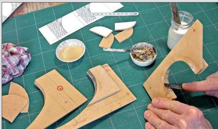
Zur Überprüfung der korrekten Anordnung und Validierung der Abmessungen des Bauwerks vor Baubeginn wird ein Kartonmodell an Ort und Stelle eingesetzt. Es ist mit einer Kopie der Entwurfzeichnung bezogen und nach den gezeichneten Linien zugeschnitten. Provisorisch wird das Kartonmodell mit dem endgültigen Gelände bestückt, um zu prüfen, ob die jeweiligen Größen übereinstimmen.
