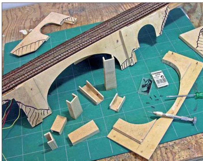
Die Komponenten der Brücke werden mit winzigen Fleischmann-Holzschrauben Nr. 6410 zusammengesraubt und können für die Endfertigung noch abgebaut werden. Nur die vier Pfeilervorlagen sind fertig verklebt und werden zum Schluss als Ganzes auf die gestalteten Giebelfelder aufgebracht.
