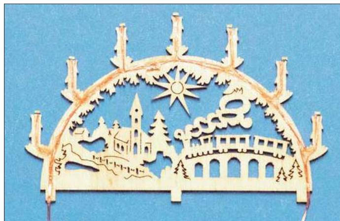
Die LEDs werden mit Kupferlackdraht angeschlossen. Dieser wird in einer Nut geführt. Links oberhalb des Sternes befindet sich die Zusammenführung aller Kathoden der LEDs in einem Löt-punkt.
