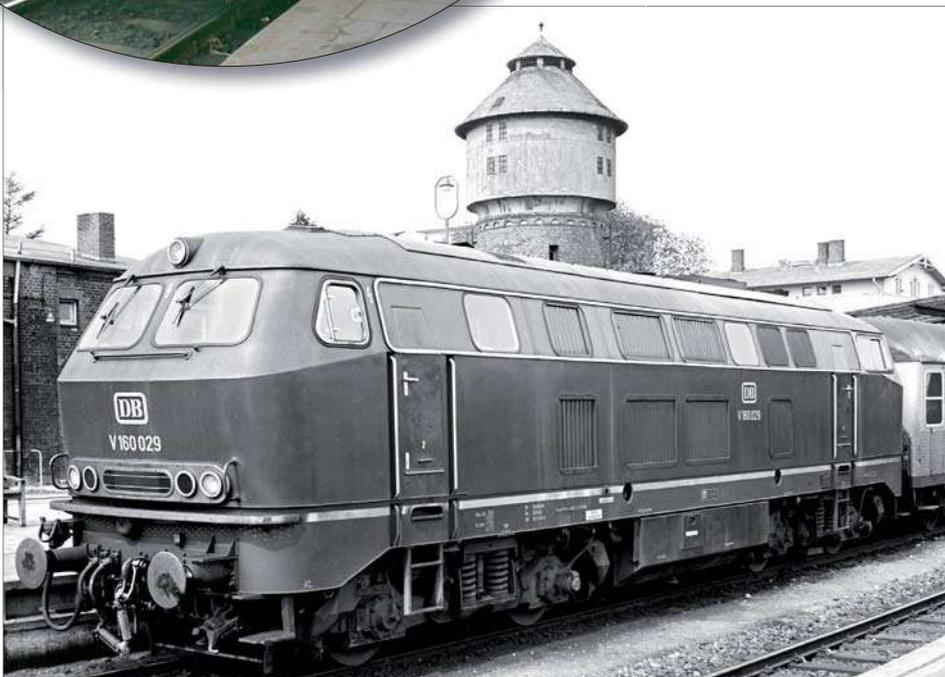
einen Schnellgang (Höchstgeschwindigkeit 120 km/h) zur Verfügung stellt. Neben dem Haupttrieb des Getriebes liegen auf beiden Seiten der Lok die Vorratsbehälter für Kraftstoff und Öl.
