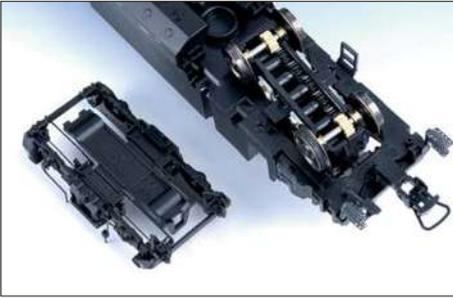
Die Radsätze sind in Messingbuchsen gelagert und tragen Metallzahnräder. Die Bodenplatte mit den Drehgestellwangen ist geklipst.
