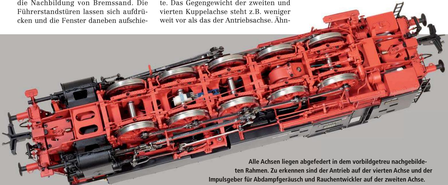
Alle Achsen liegen abgefedert in dem vorbildgetreu nachgebildeten Rahmen. Zu erkennen sind der Antrieb auf der vierten Achse und der Impulsgeber für Abdampfgeräusch und Rauchentwickler auf der zweiten Achse.
