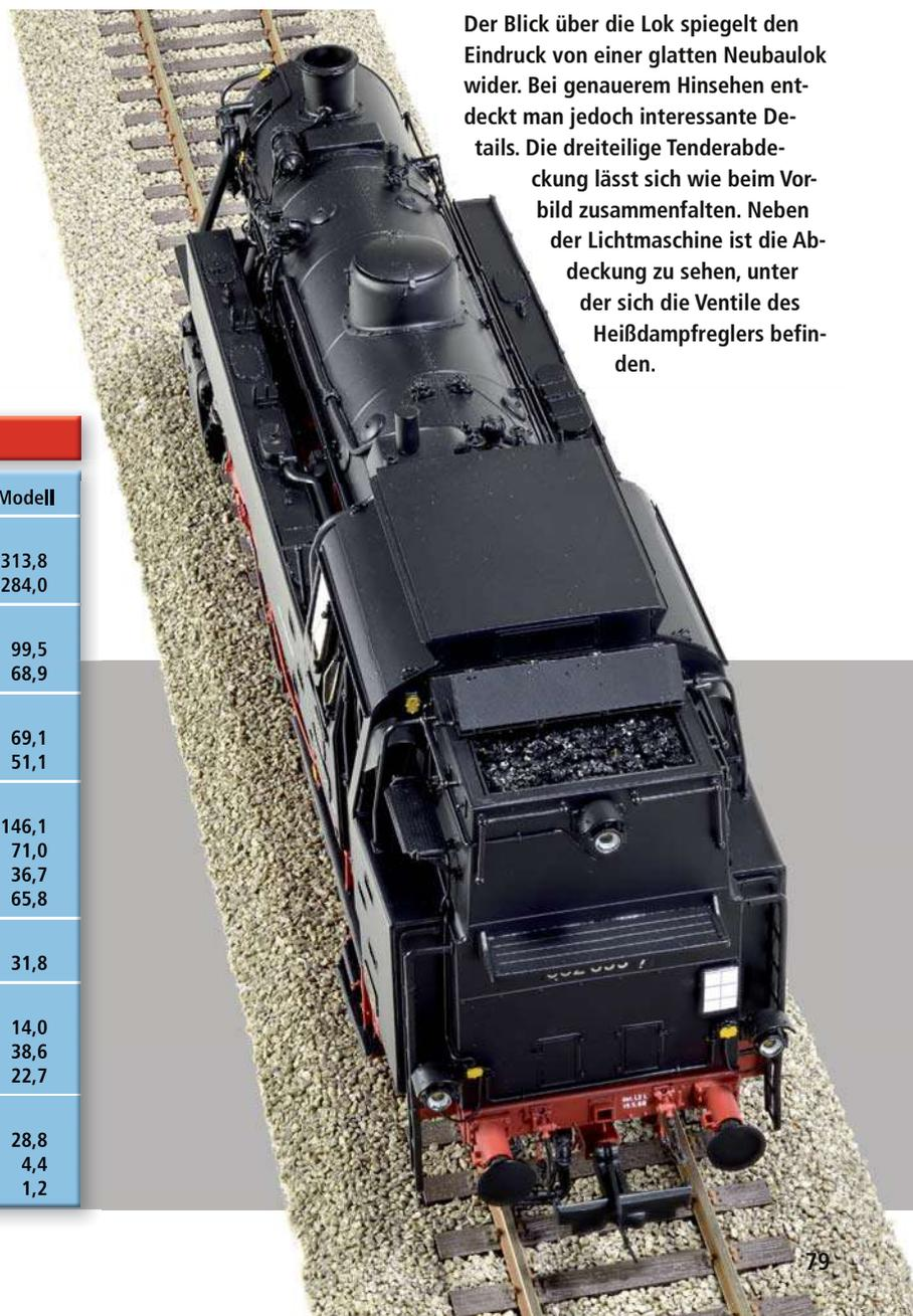
Der Blick über die Lok spiegelt den Eindruck von einer glatten Neubaulok wider. Bei genauerem Hinsehen entdeckt man jedoch interessante Details. Die dreiteilige Tenderabdeckung lässt sich wie beim Vorbild zusammenfallen. Neben der Lichtmaschine ist die Abdeckung zu sehen, unter der sich die Ventile des Heißdampfreglers befinden.
