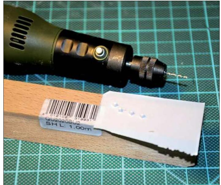
Vor dem Ankörnen werden die benötigten Kunststoffteilchen mit doppelseitigem Klebeband auf einer geeigneten Unterlage aus Holzresten befestigt.
