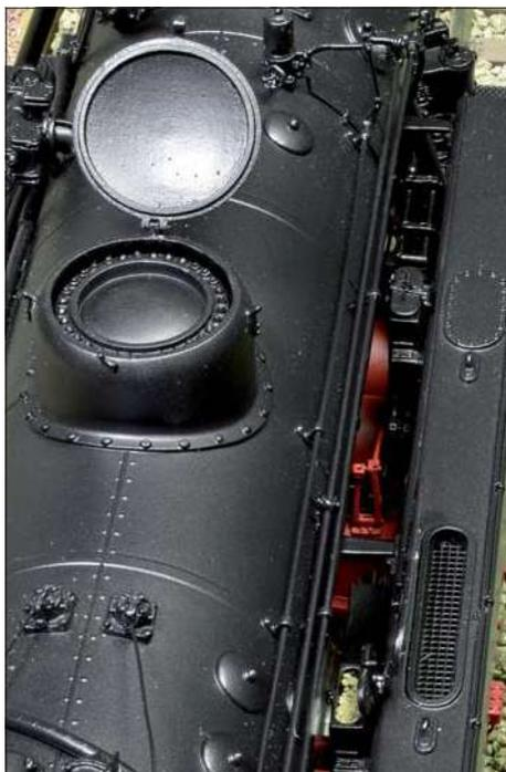
Der Domdeckel lässt sich öffnen und auch die Deckel der Wasser- und Sandkästen. Letztere zeigen sich zwischen Wasserkasten und Kessel mit Sandfüllung.
