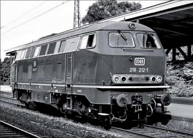
216 212 gehört zu den Lokomotiven, die nachträglich für den Einbau einer automatischen Kupplung vorbereitet wurden; erkennbar am Kupplungsflansch und an den höhenversetzten Bremsschläuchen. Foto am 8. 9.1976 in Schwerte: Matthias Maier
