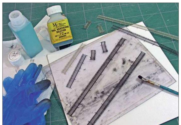
Die Färbung der Geländer aus Neusilber erfolgt durch chemische Pinselbräunung auf einer Unterlage aus Plexiglas (hier mithilfe der Brünierungslösung von Micro Engineering). Achtung, diese chemische Lösung ist hautaggressiv und es müssen Handschuhe getragen werden! Der Vorteil der Brünierung ist, dass sie bei den feinen Details nicht aufträgt.
