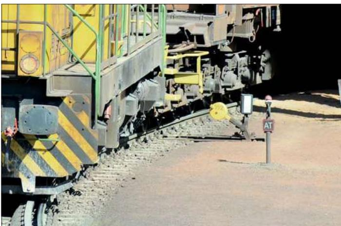
Rechts neben der Werkslokomotive befindet sich der Pfosten mit dem Ein- und Ausschalttaster zum Schließen bzw. Öffnen des Bahnübergangs durch den Lrf (Lokrangierführer).
