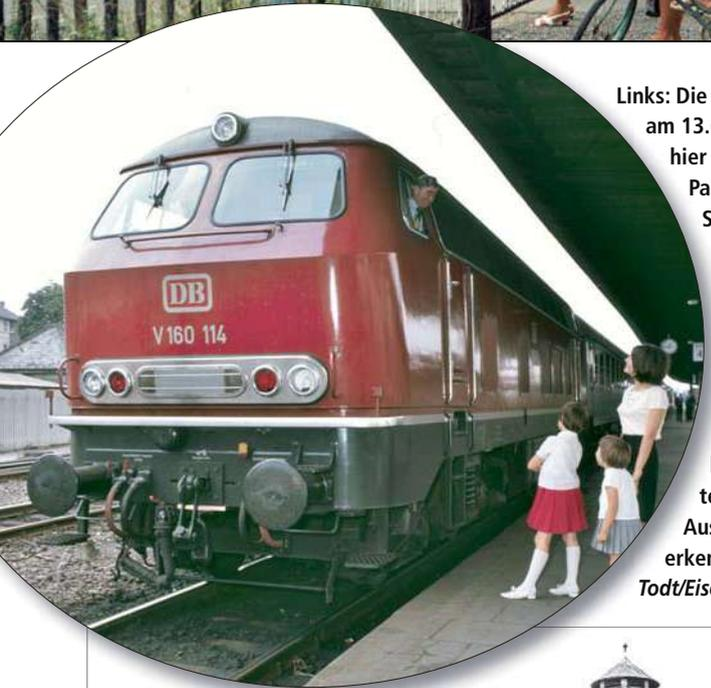
Links: Die nagelneue V 160 114 (Ablieferung am 13.6.1967 an das Bw Limburg), die hier so werbewirksam mit der Familie Palm 1967 im Bahnhof Limburg in Szene gesetzt wurde, verfügt nicht über eine Vielfachsteuerung. Foto: Reinhold Palm/ Eisenbahnstiftung
