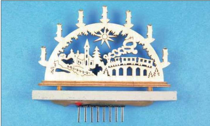
Der Kathodenanschluss ist gekennzeichnet, um den Schwibbbogen polungsrichtig in die Buchsenleiste zu stecken.
