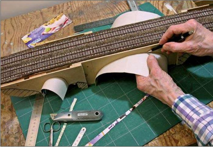
Für die Herstellung des benötigten Schnittmusters für das Gewölbe wird ein Kartonzuschnitt eingepasst und der Überstand des Kartons an beiden Stirnseiten genau markiert und anschließend abgeschnitten.
