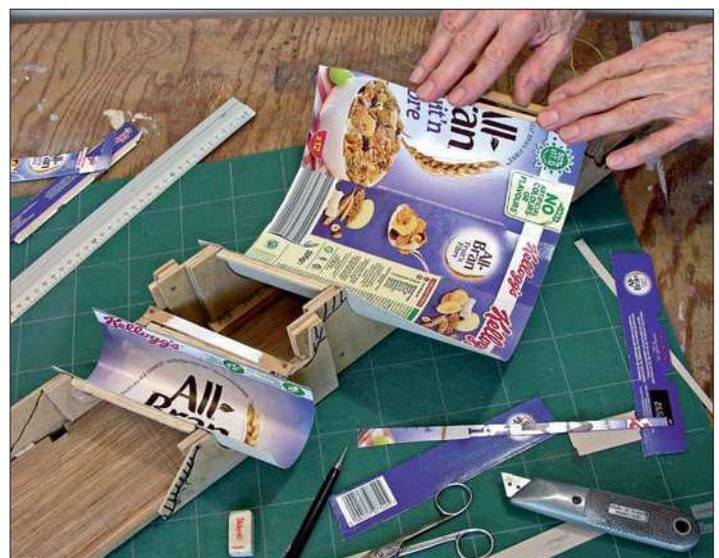
In bewährter Gewohnheit bestehen die Gewölbe aus Lebensmittelkarton zugeschnitten. Diese Zuschnitte werden gerollt und durch die schrägen Portale selbst in Form gehalten. Beachten Sie, dass der Mantel, obwohl es sich um schräge Gewölbe handelt, der Form eines Zylinders entspricht, der das Bauwerk durchdringt.
