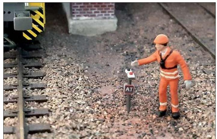
Als unauffälliges Detail stehen die Taster für den Bahnübergang zwischen den Gleisen. Zusammen mit dem betätigenden Lrf wird diese Besonderheit erkennbar.
