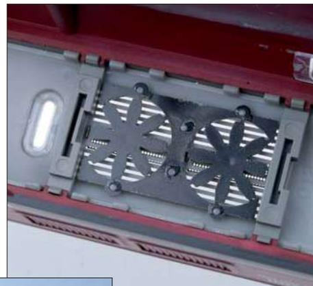
Rechts: Der Lüfterkasten ist als separates Teil ins Dach eingeklippt. Er trägt die Lüfterlamellen als Silhouette. Von außen sieht man die Lautsprecher glitzern, die ...
