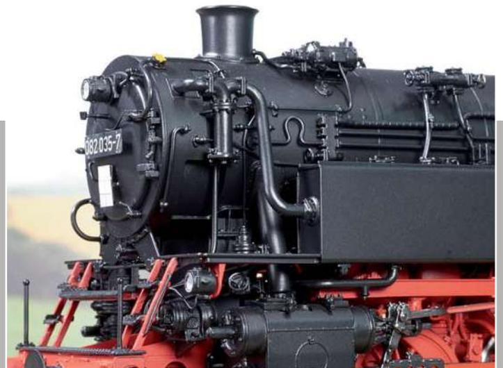
Das aus der Rauchkammer kommende Rohr führt über den Ölabscheider zum Mischvorwärmer im Wasserkasten. Die Vorreiber sind beweglich.
