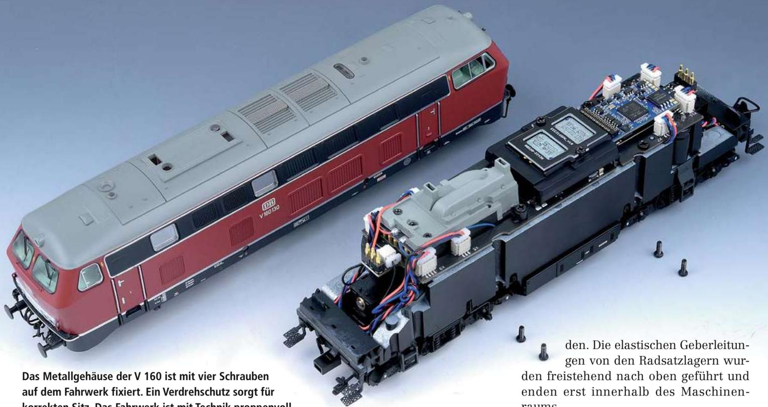
Das Metallgehäuse der V 160 ist mit vier Schrauben auf dem Fahrwerk fixiert. Ein Verdrehenschutz sorgt für korrekten Sitz. Das Fahrwerk ist mit Technik proppenvoll ...
