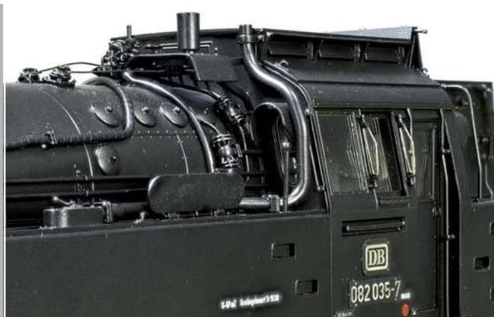
Auf einem Schutzblech ist der Topf der Rangierfunkantenne nachgebildet. Die Antenne hatten vorwiegend die im Rangierdienst eingesetzten 82er.
